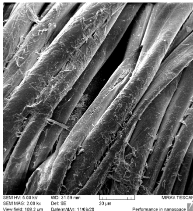
Slika P7.6 Mikrografi oprane PT tkanine u laboratorijskoj perilici s deterdžentom uz dodatak CMS, u mekoj i tvrdoj vodi na 90 °C kroz 11 ciklusa uz povećanja a. i d. 1000x, b. i e. 2000x te c. i f. 5000x
