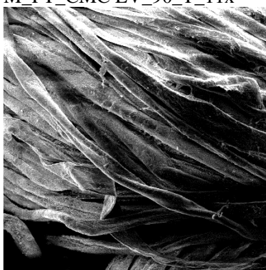
Slika P7.27 Mikrografi oprane PT tkanine u laboratorijskoj uređaju Polymat s deterđentom uz dodatak CMC LV, u mekoj i tvrdoj vodi na 90 °C kroz 11 ciklusa uz povećanja a. i d. 1000x, b. i e. 2000x te c. i f. 5000x
