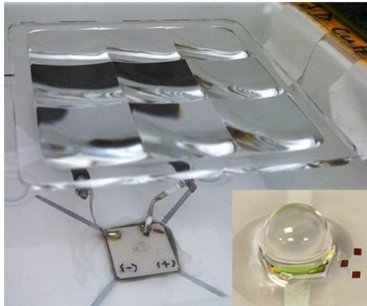
Slika 8. Minijaturna solarna čelija s dvostrukim sustavom fokusiranja svjetlosti površine 2 cm x 2 cm [Sheng et al., 2014.]
