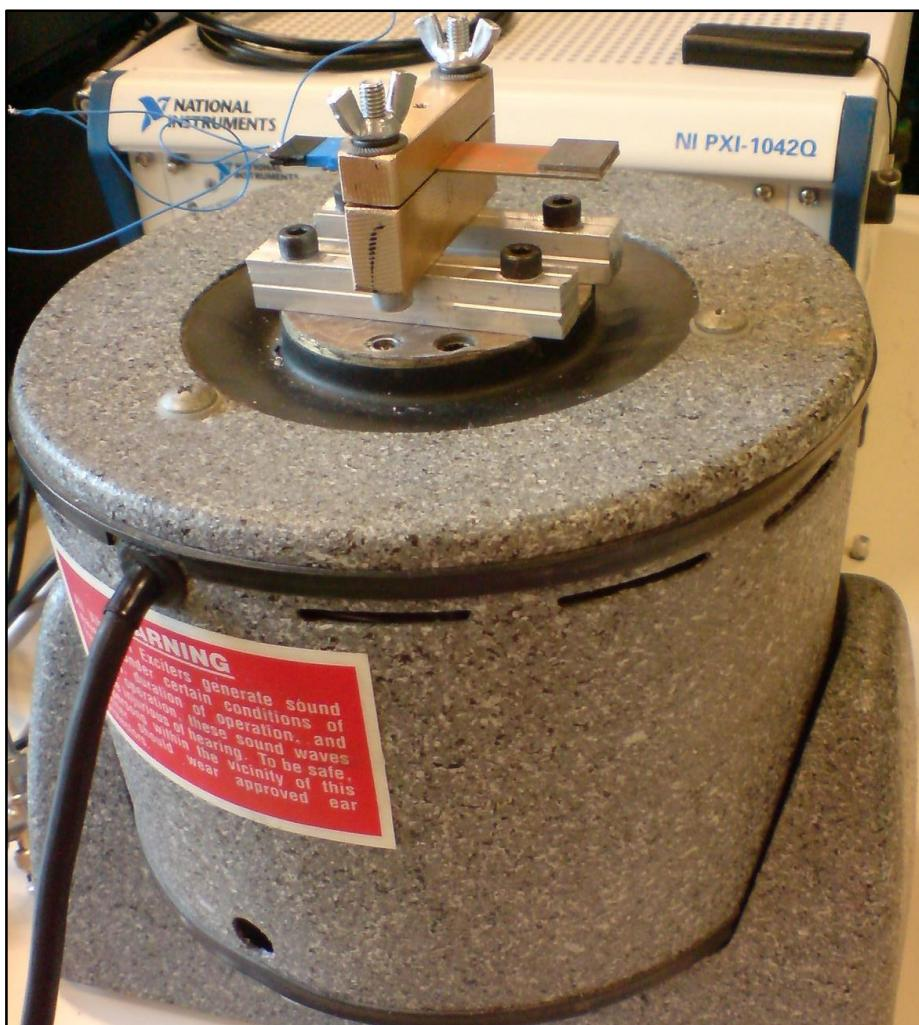
Slika 90. Uklještena piezoelektrična konzola s utegom na slobodnom kraju postavljena na elektromagnetski vibracijski uzbudnik MB Dynamics PM25A
