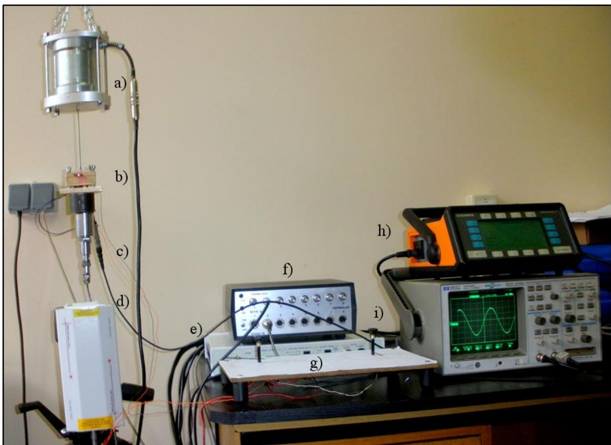
Slika 94. Eksperimentalni postav u Laboratoriju za precizno inženjerstvo: a) vibracijski uzbudnik Schenck AG Vibroexciter 41, b) uklještenje konzole, c) akcelerometar Schenk AS-020, d) laserski vibrometar MetroLaser VibroMet 500V, e) upravljačka jedinica vibrometra, f) upravljačka jedinica akcelerometra, g) potenciometri, h) upravljačka jedinica vibracijskog uzbudnika, i) osciloskop
