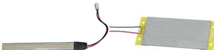
Slika 24. Piezoelektrične konzole za razvoj uređaja za prikupljanje niskorazinske energije vibracija: Advanced Cerametrics i Piezo Systems [URL: Piezo systems, URL: Advanced Ceramterics]
