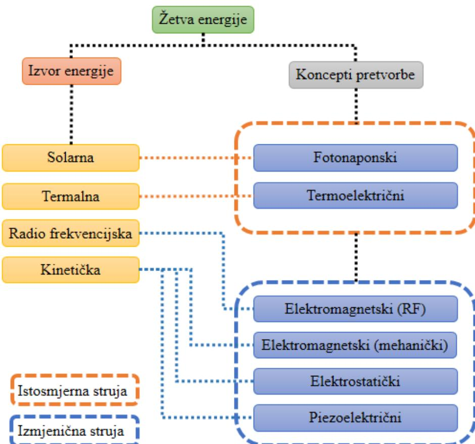
Slika 1. Prikaz najčešćih izvora energije i koncepata pretvorbe korištenih pri pretvorbi niskorazinske energije iz okoliša. Slika prilagođena prema: [Caliò et al., 2014.]
