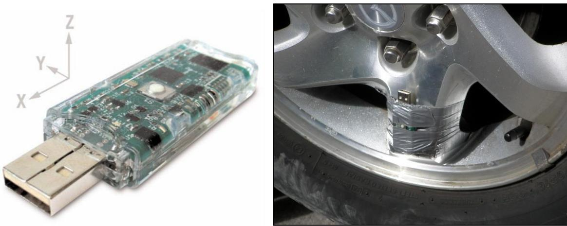
Slika 113. Midé Slam Stick recorder – troosni akcelerometar s prikazom montaže na automobilskom kotaču [URL: Mide]
