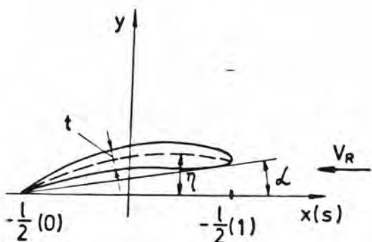
Sl. 3. Optjecanje dvodimenzijsionalnog profila
