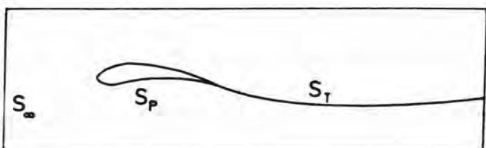
Sl. 1. Rubne površine za određivanje potencijala
