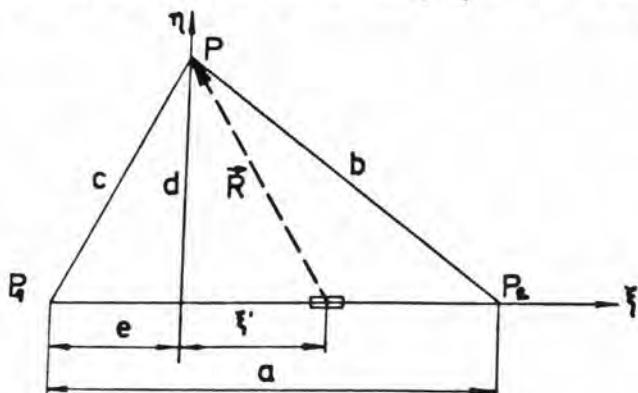
Sl. 43 Uz izvod brzine inducirane linijskim segmentom izvora
