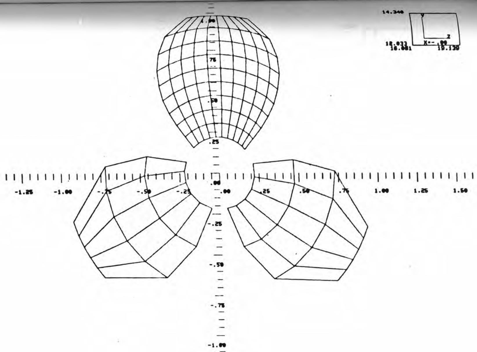
Sl. 13 Nacrt diskretiziranog modela propelera
