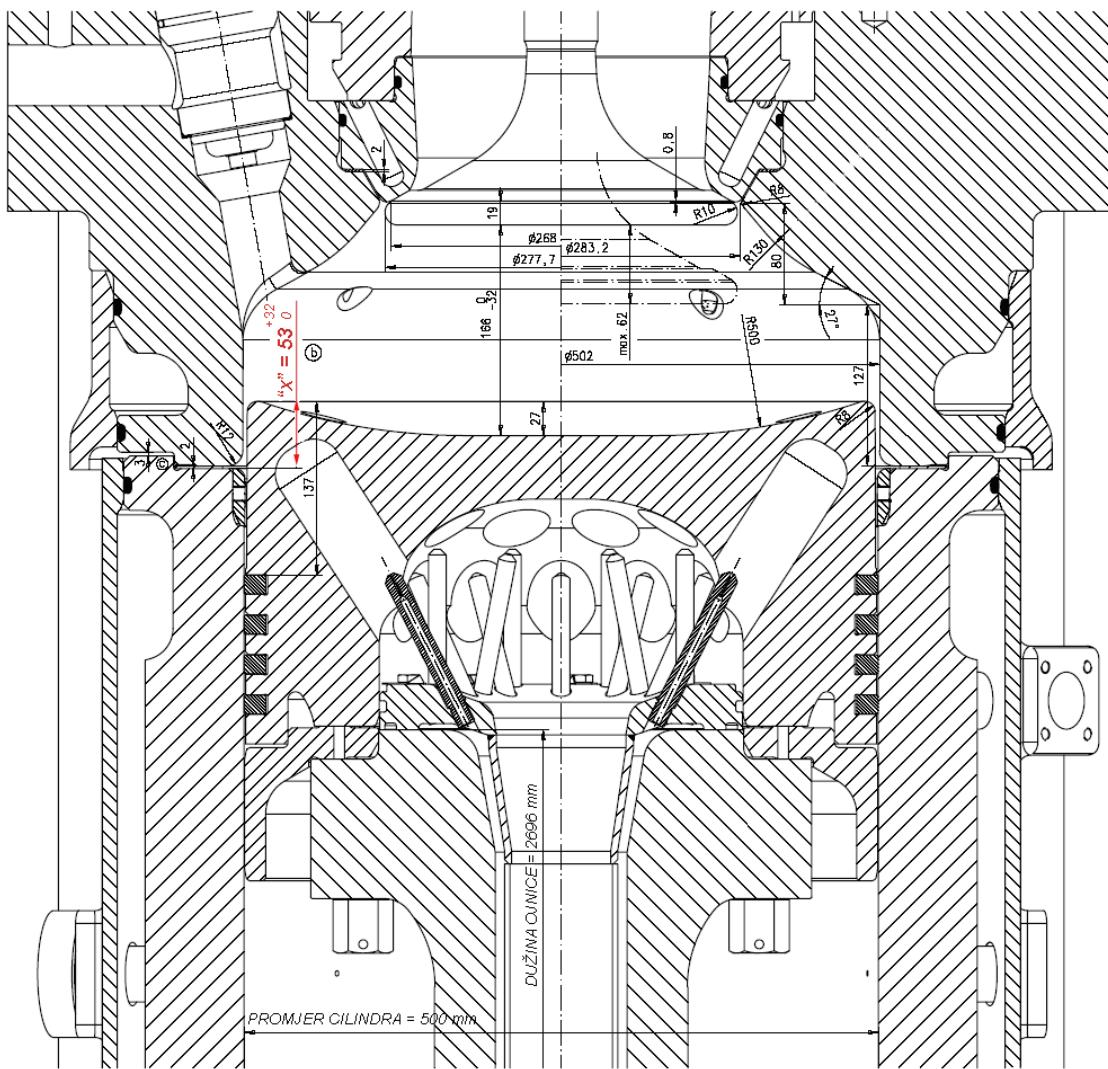
Slika 5.4: Prikaz kompresionog prostora motora tipa Wärtsilä 7 RT-Flex 50
