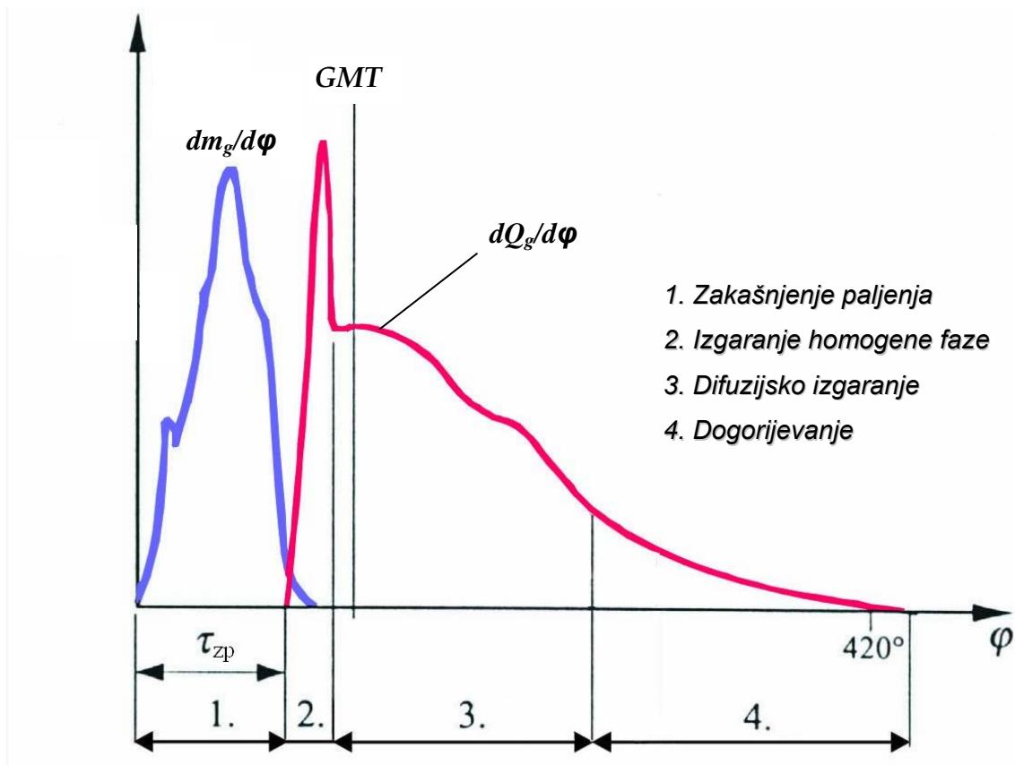
Slika 3.8: Prikaz brzine dovođenja goriva, brzine oslobođanja topline i faza izgaranja
