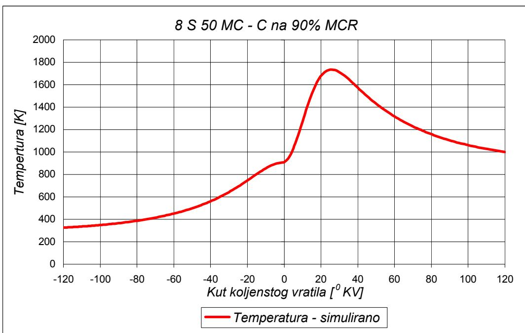
Slika 5.13: MAN B&W 8 S 50 MC-C - Dijagram promjene temperaturu ovisno o kutu koljenastog vratila na 90 % opterećenja motora – simulirano
