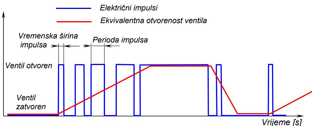
Slika 6.3: Prikaz djelovanja električnih impulsa na elektro-hidraulički ventil
