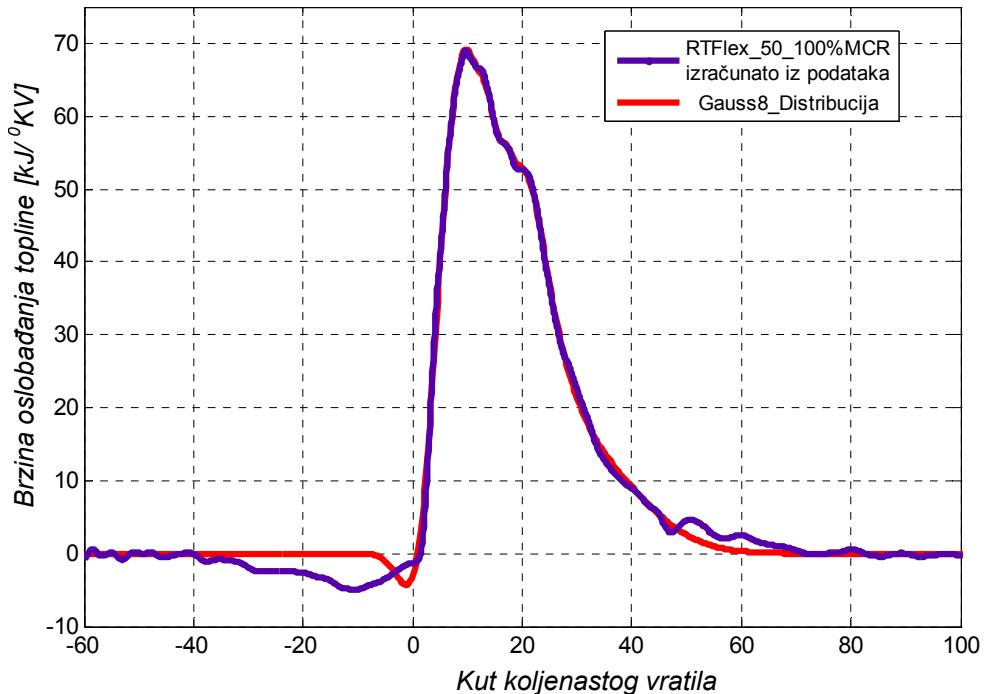
Slika 4.13: Zaglađivanje funkcije zakona oslobođanja topline ( $dQ/d\varphi$ ) za motor tipa Wärtsilä 7 RT Flex 50 na 100% MCR
