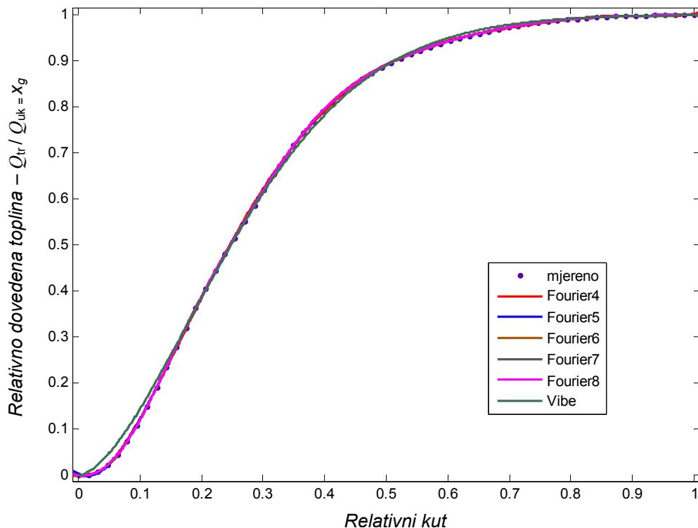
Slika 4.32: Usporedba Vibe aproksimacije i predloženih Fourierovih funkcija s izmjerenim vrijednostima za motor tipa Wärtsilä 7 RT Flex 50 na 100% MCR
