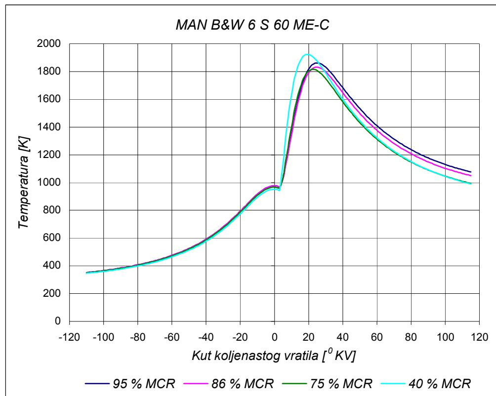
Slika 5.35: Usporedba temperatura na različitim opterećenjima kod motora tipa MAN B&W 6 S 60 ME-C – simulirano
