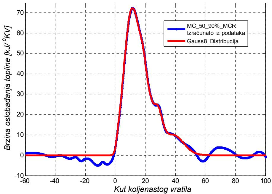
Slika 4.14: Zaglađivanje funkcije zakona oslobođanja topline ( $dQ/d\varphi$ ) za motor tipa MAN B&W 8 S 50 MC-C na 90% MCR (Gauss-8)
