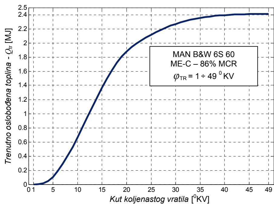
Slika 4.23: Trenutni tok oslobođene topline po absolutnom kutu koljenastog vratila  $\varphi$ , za motor tipa MAN B&W 6 S 60 ME-C na 86% MCR
