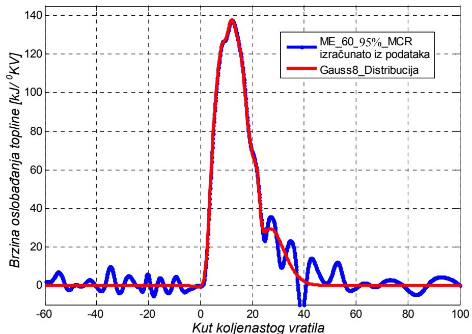
Slika 4.15: Zaglađivanje funkcije zakona oslobođanja topline ( $dQ/d\varphi$ ) za motor tipa MAN B&W 6 S 60 ME-C na 95% MCR (Gauss-8)
