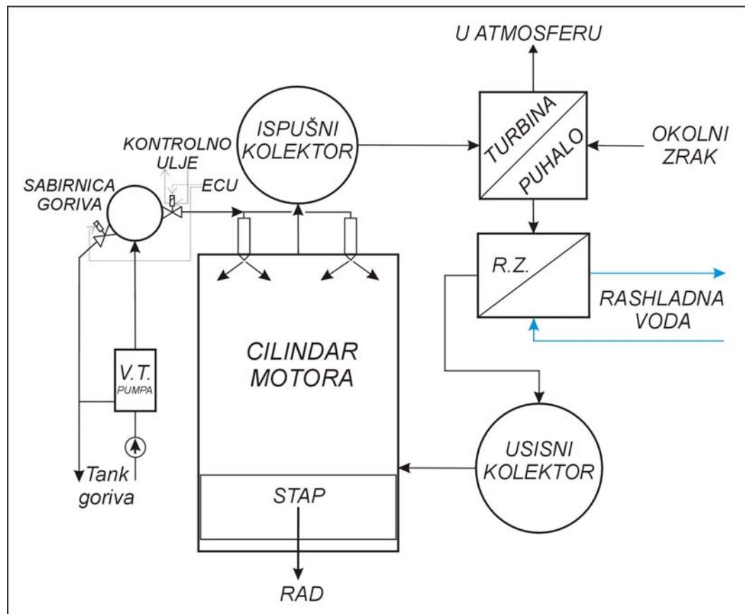
Slika 3.9: Shematski dijagram izmjene radnog medija dizelskog motora
