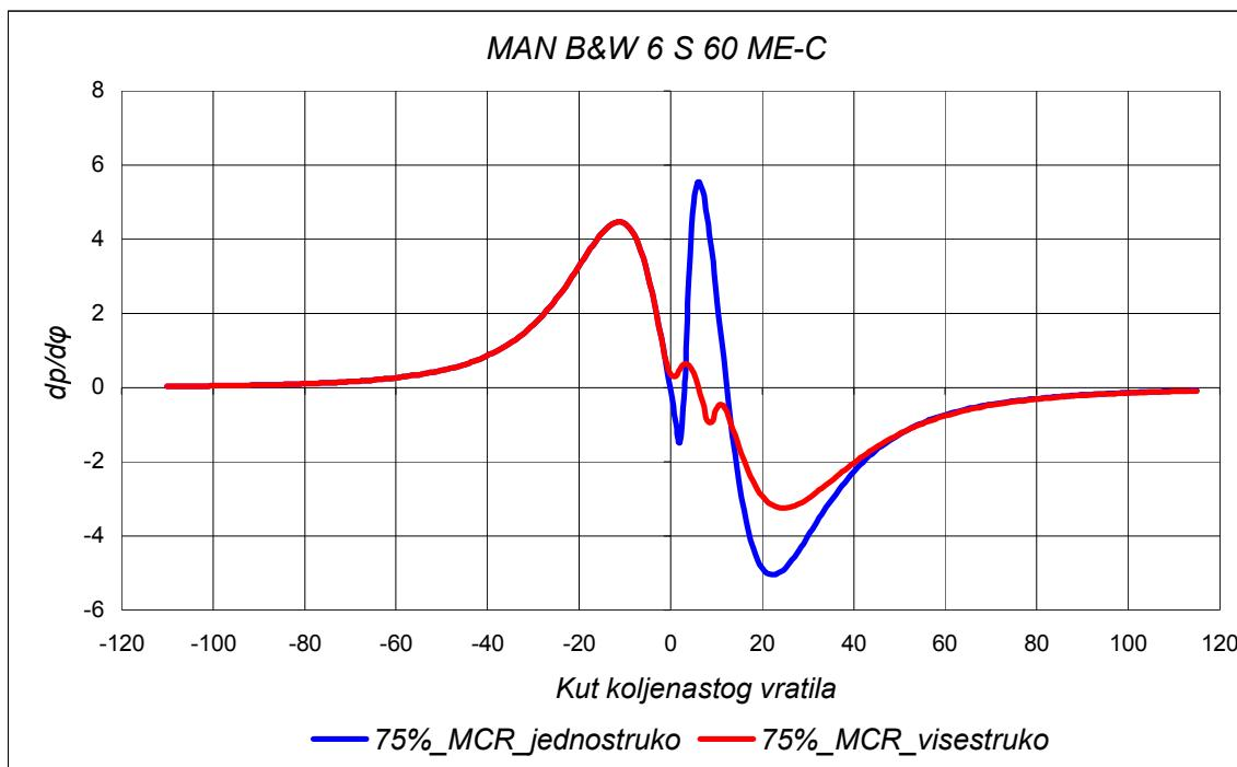
Slika 6.6. Prikaz brzine promjene tlaka po kutu koljenastog vratila za motor tipa MAN B&W 6 S 60 ME-C kod dva različita načina ubrizgavanja goriva – simulirano
