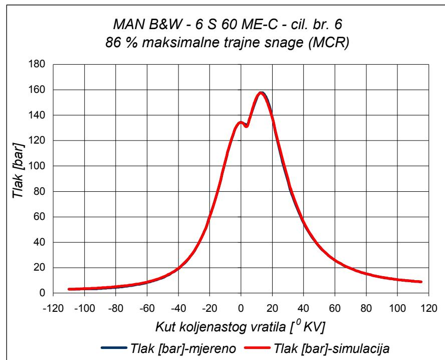
Slika 5.18: MAN B&W 6 S 60 ME-C - Usporedba otvorenih indikatorskih dijagrama na 86 % opterećenja motora ( $C=6.9 \quad m=1.62 \quad izgar. = 3 \div 49$ )
