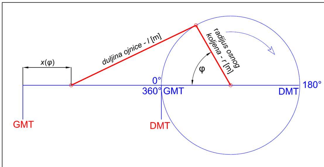
Slika 3.4: Shematski prikaz stupnog mehanizma
