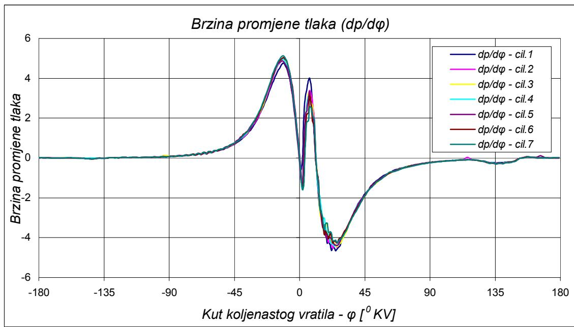
Slika 5.8: Prikaz brzine promjene tlaka po kutu koljenastog vratila na motoru tipa Wärtsilä 7 RT-Flex 50 (izračunato iz izmjerениh vrijednosti tlaka), [3. Maj M.I.D.]
