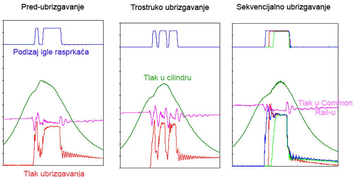
Slika 6.23: Prikaz ovisnosti podizaja igle elementa rasprškača ovisno o tlaku goriva, te usporedba raznih oblika  $p\text{-}\varphi$  dijagrama, ovisno o načinu ubrizgavanja na motorima tipa Wärtsilä RT Flex [50]
