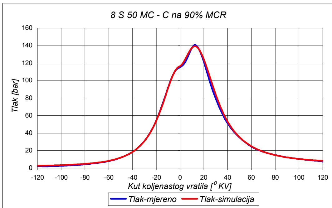
Slika 5.12: MAN B&W 8 S 50 MC-C - Usporedba otvorenih indikatorskih dijagrama na 90 % opterećenja motora ( $C=6.9 \quad m+1=2,1$  izgar. =  $-1 \div 45$ )
