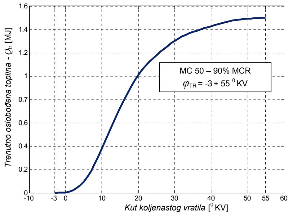
Slika 4.21: Trenutni tok oslobođene topline po absolutnom kutu koljenastog vratila  $\varphi$ , za motor tipa MAN B&W 8 S 50 MC-C na 90% MCR
