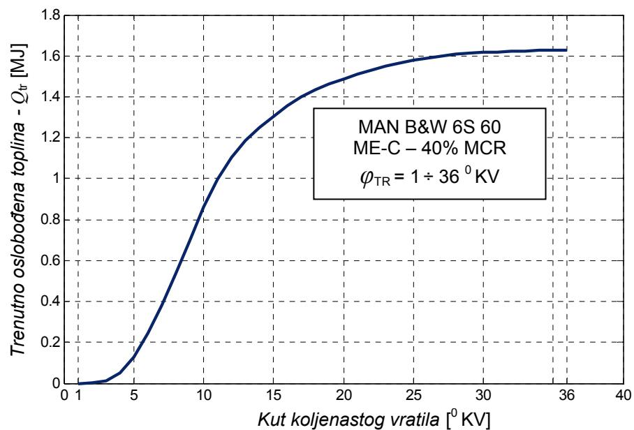
Slika 4.25: Trenutni tok oslobođene topline po absolutnom kutu koljenastog vratila  $\varphi$ , za motor tipa MAN B&W 6 S 60 ME-C na 40% MCR
