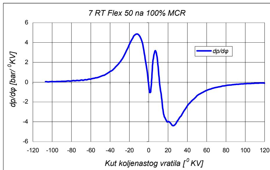
Slika 5.29: Brzina promjene tlaka na motoru tipa Wärtsilä 7 RT Flex
