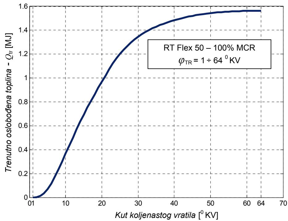
Slika 4.20: Trenutni tok oslobođene topline po absolutnom kutu koljenastog vratila  $\varphi$ , za motor tipa Wärtsilä 7 RT Flex 50 na 100% MCR
