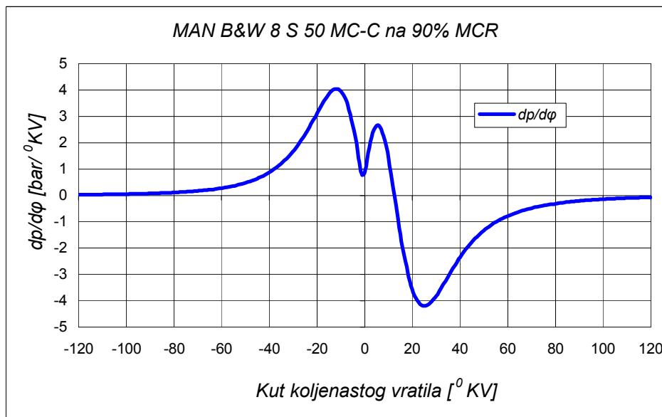
Slika 5.30: Brzina promjene tlaka na motoru tipa MAN B&W 8 S 50 MC-C
