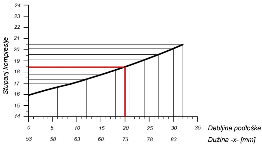
Slika 5.5: Ovisnost stupnja kompresije o debљini podloške na motoru tipa Wärtsilä 7 RT-Flex 50
