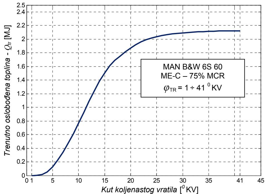
Slika 4.24: Trenutni tok oslobođene topline po absolutnom kutu koljenastog vratila  $\varphi$ , za motor tipa MAN B&W 6 S 60 ME-C na 75% MCR
