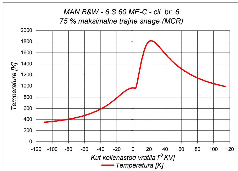
Slika 5.17: MAN B&W 6 S 60 ME-C – Dijagram temperaturu ovisno o kutu koljenastog vratila na 75 % opterećenja - simulirano
