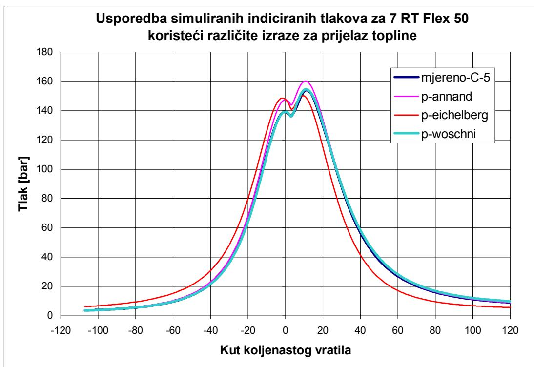
Slika 3.6: Usporedba stvarnih vrijednosti tlaka i simulacijom dobivenih tlakova koristeći različite izraze za prijelaz topline
