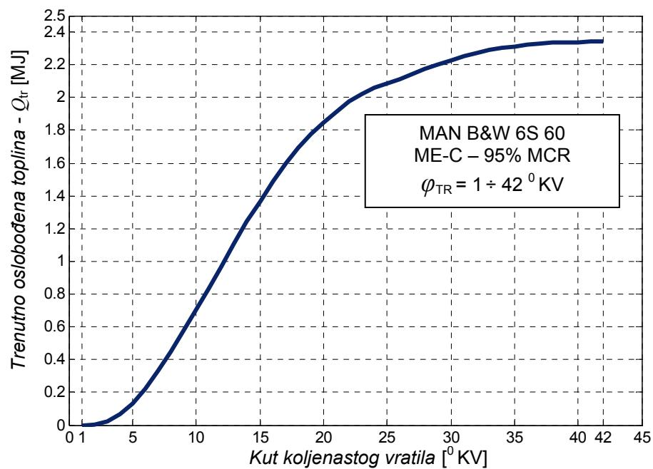
Slika 4.22: Trenutni tok oslobođene topline po absolutnom kutu koljenastog vratila  $\varphi$ , za motor tipa MAN B&W 6 S 60 ME-C na 95% MCR
