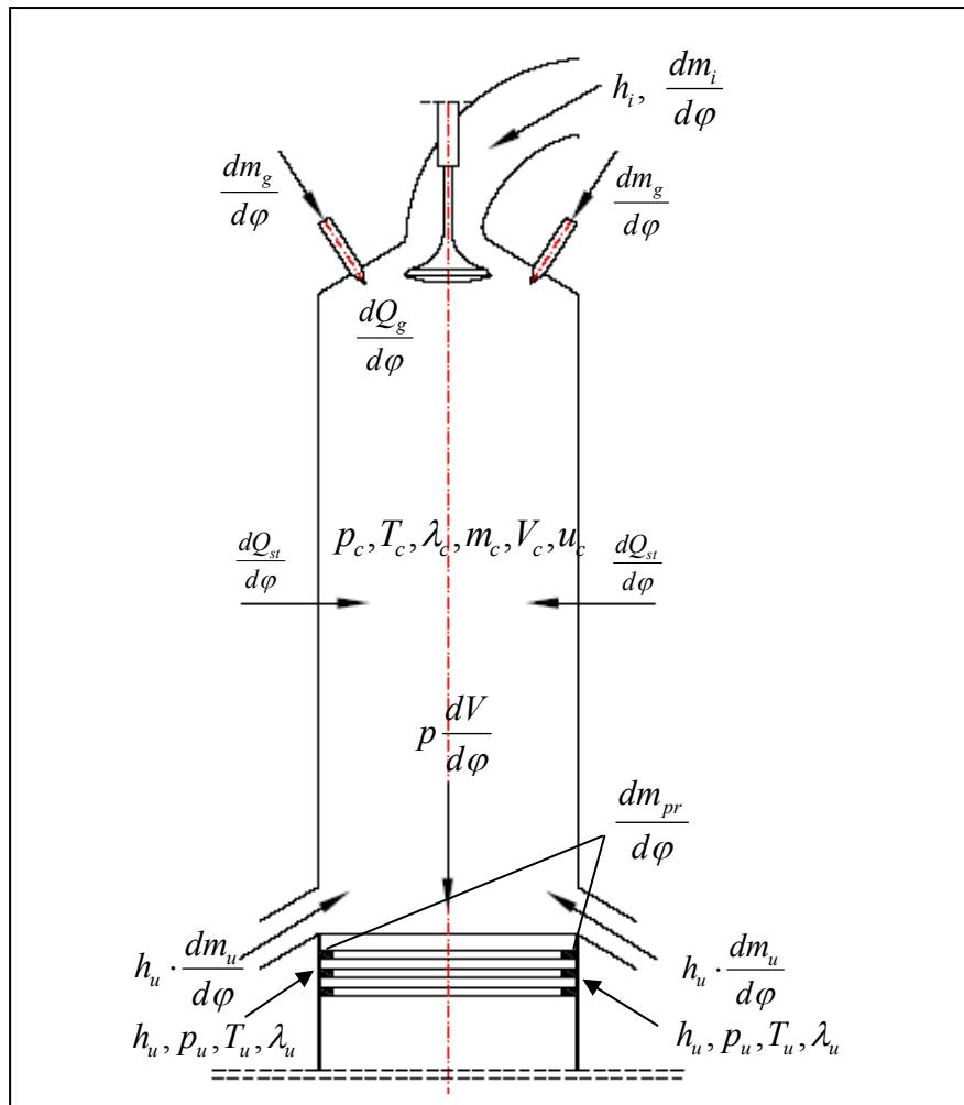
Slika 3.2: Raspodjela toplinske energije u cilindru dvotaktnog motora
