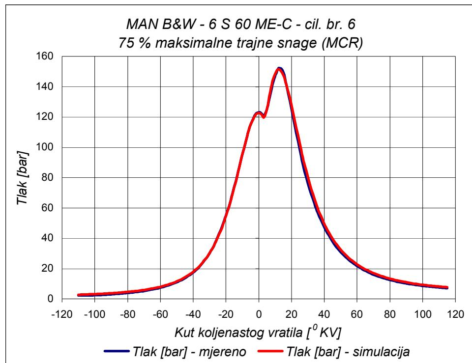
Slika 5.16: MAN B&W 6 S 60 ME-C – Usporedba otvorenih indikatorskih dijagrama na 75 % opterećenja ( $C=6.9 \quad m+1=1.55$  izgar. = 3 ÷ 46)
