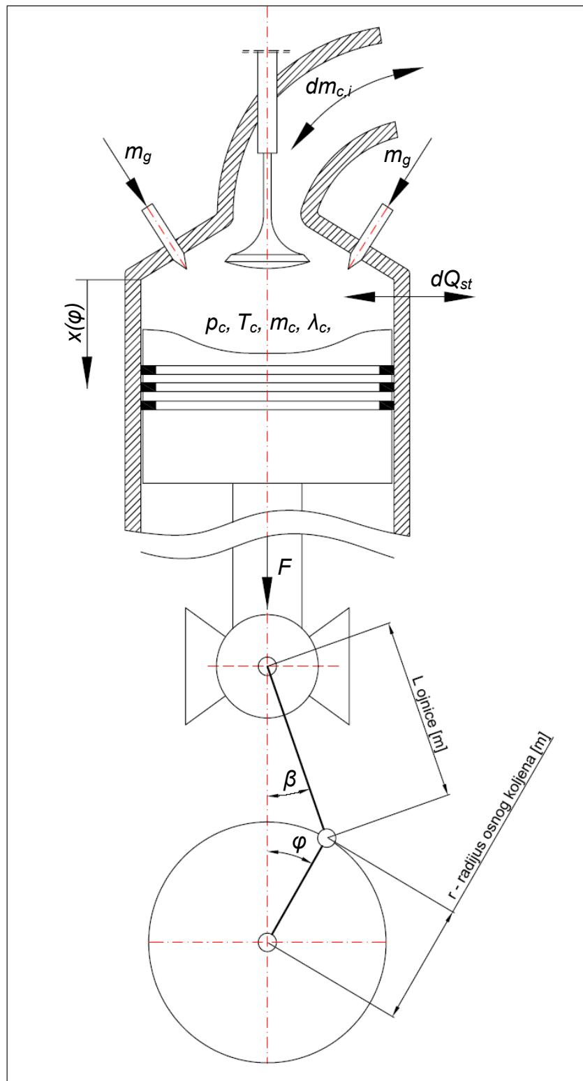
Slika 3.3: Kontrolni volumen cilindra motora s osnovnim veličinama starnog mehanizma
