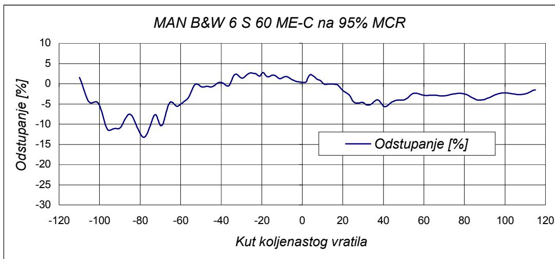
*Slika 5.27: MAN B&W ME-C 60 - odstupanja između izmjerenih i simuliranih vrijednosti tlaka ovisno o kutu koljenastog vratila na 95 % opterećenja*
