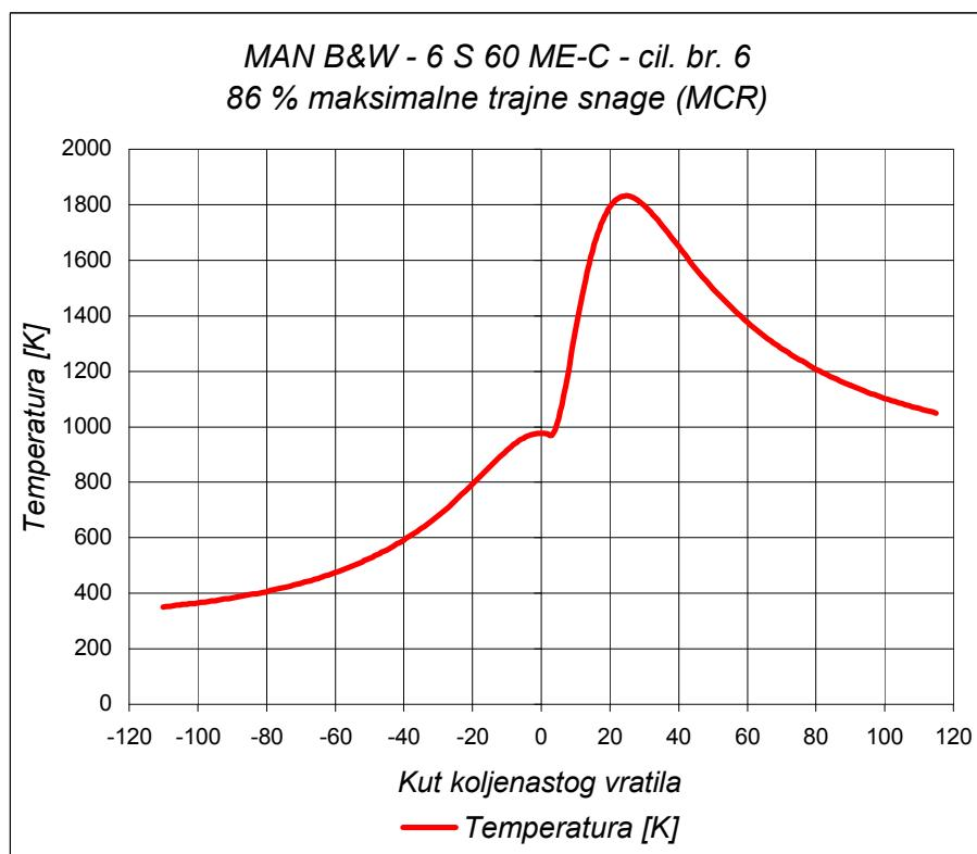
Slika 5.19: MAN B&W 6 S 60 ME-C – Dijagram temperaturu ovisno o kutu koljenastog vratila na 86 % opterećenja motora - simulirano
