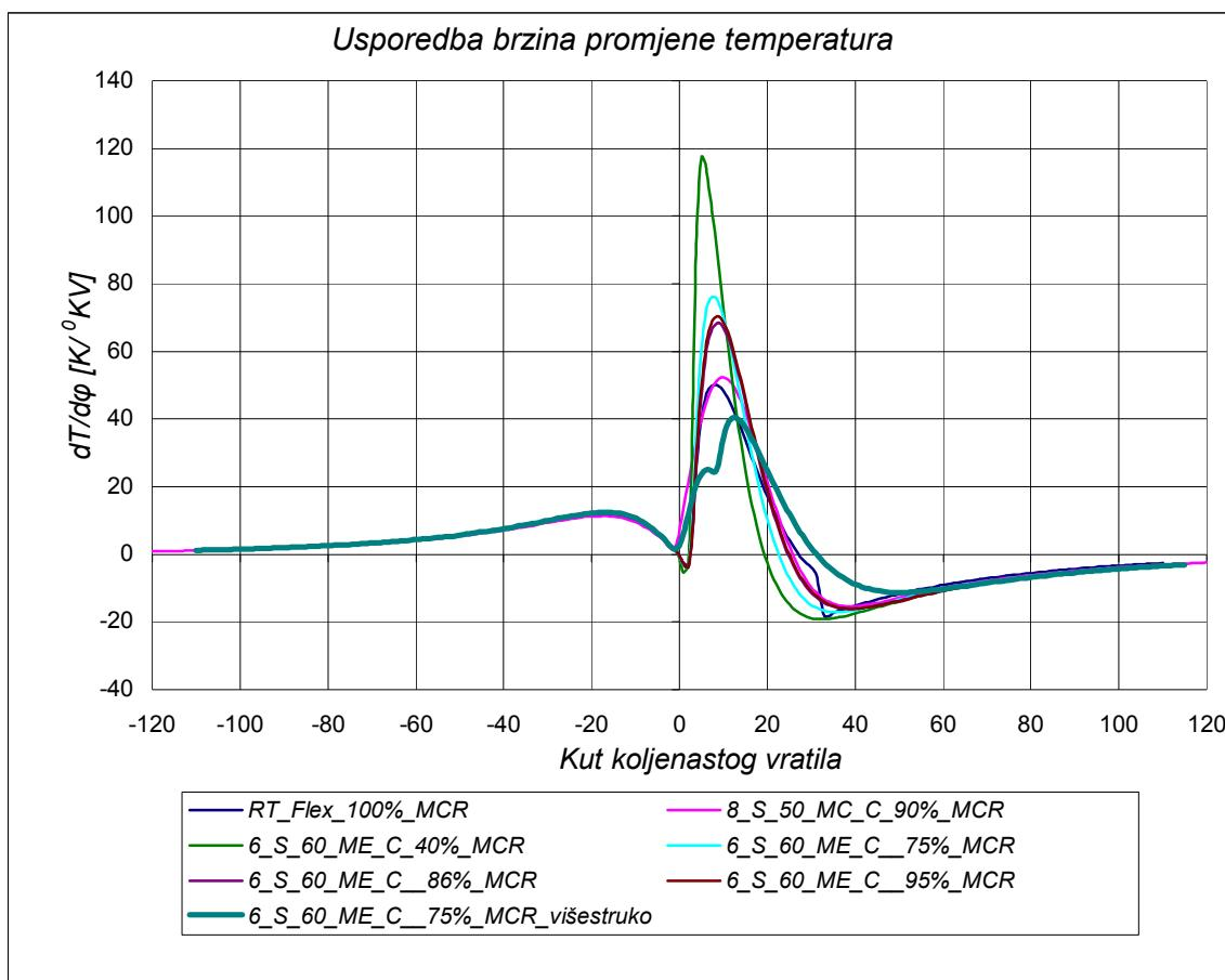
Slika 5.36: Usporedba brzina promjene temperaturu na različitim opterećenjima kod motora tipa MAN B&W 6 S 60 ME-C – simulirano
