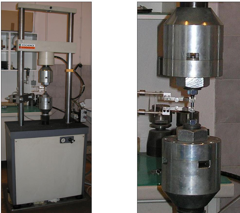
Slika 4.2 Univerzalni servo-hidraulički ispitni stroj Schenck Hydropuls PSA
