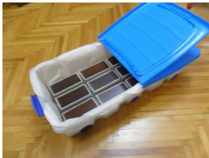
**Slika 19.** Izlaganje uzoraka vodenom pari
