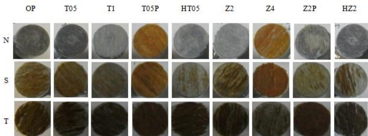
**Slika 34.** Izgled loma nakon otkidanja valjičića prilikom određivanje suhe adhezijske čvrstoće premaza na nemodificiranim (N) i toplinski modificiranim uzorcima na 190 °C (S) i 212 °C (T)
