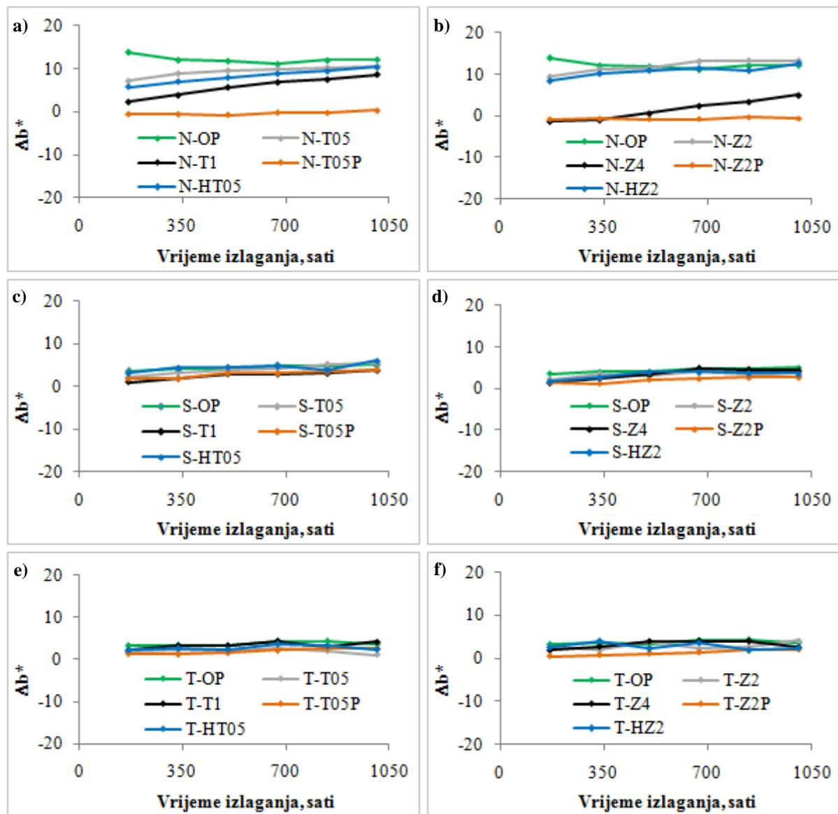
**Slika 62.** Promjena koordinate  $b^*$  ( $\Delta b^*$ ) nemodificiranih (N) i toplinski modificiranih uzoraka na  $190\text{ }^\circ\text{C}$  (S) i  $212\text{ }^\circ\text{C}$  (T) iza slobodnih filmova premaza tijekom ubrzanog izlaganja
