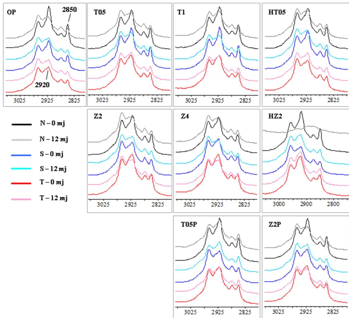
**Slika 78.** FTIR-ATR spektri u području između  $3000 - 2800\text{ cm}^{-1}$  premazanih nemodificiranih uzoraka (N) i uzoraka toplinski modificiranih na  $190\text{ }^{\circ}\text{C}$  (S) i  $212\text{ }^{\circ}\text{C}$  (T) prije izlaganja (1 mj) i na kraju prirodnog izlaganja (12 mj)
