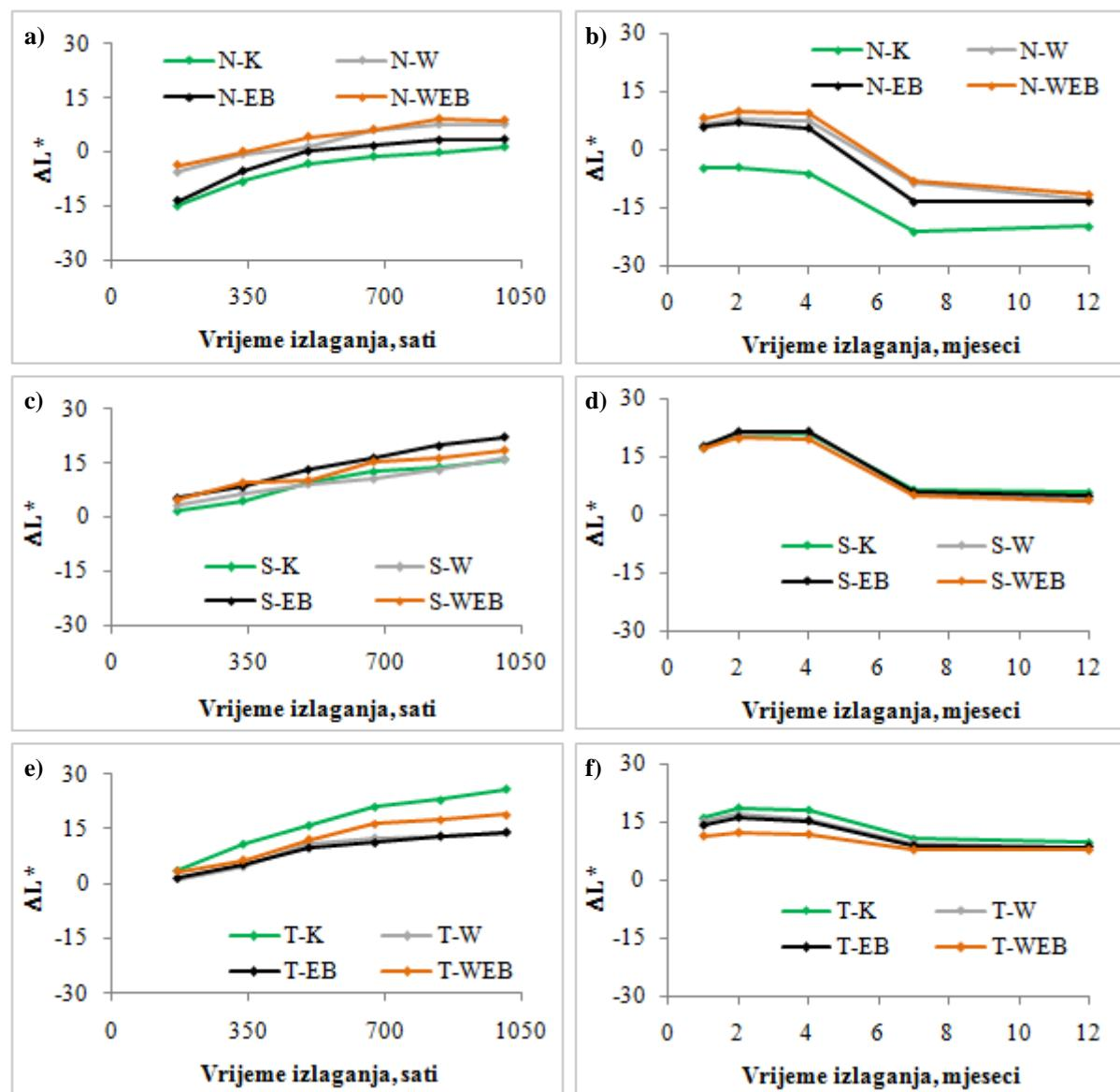
**Slika 65.** Promjena svjetline ( $\Delta L^*$ ) ekstrahiranih nemodificiranih (N) i toplinski modificiranih uzoraka na 190 °C (S) i 212 °C (T) tijekom ubrzanog (a, c i e) i prirodnog izlaganja (b, d i f)
