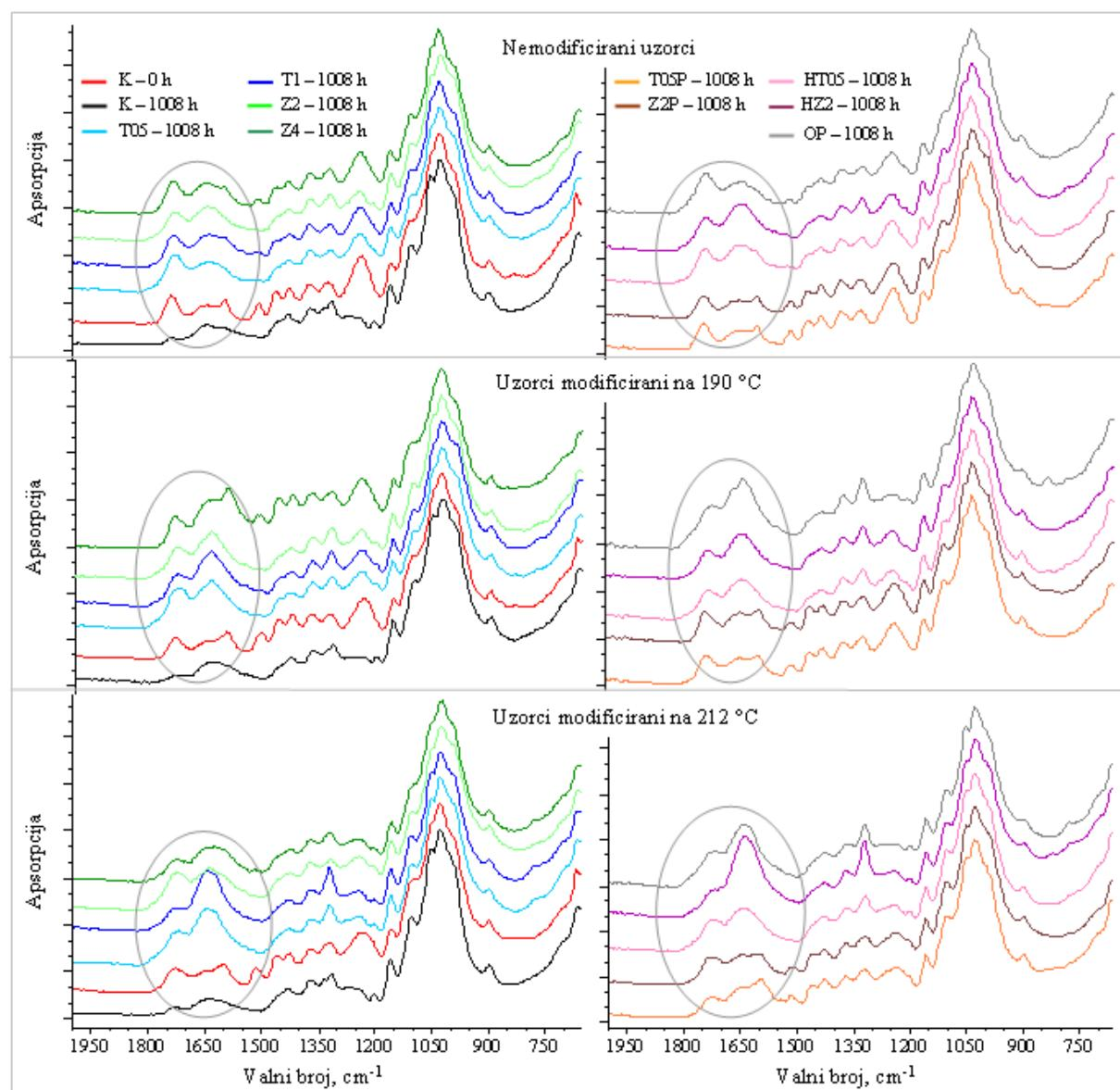
**Slika 79.** Uskorođenje FTIR spektara nemodificiranih i toplinski modificiranih uzoraka iz slobodnih filmova premaza nakon ubrzanog izlaganja
