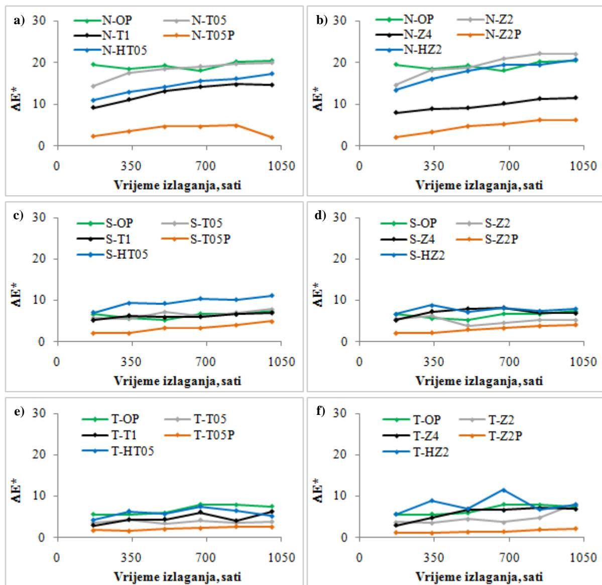
**Slika 59.** Promjena boje ( $\Delta E^*$ ) nemodificiranih (N) i toplinski modificiranih uzoraka na 190 °C (S) i 212 °C (T) iza slobodnih filmova premaza tijekom ubrzanog izlaganja
