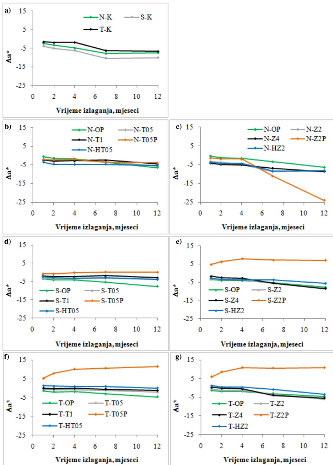
**Slika 56.** Promjena koordinate  $a^*$  ( $\Delta a^*$ ) nepremazanih i premazanih nemodificiranih (N) i toplinski modificiranih uzoraka na  $190\text{ }^\circ\text{C}$  (S) i  $212\text{ }^\circ\text{C}$  (T) tijekom prirodnog izlaganja
