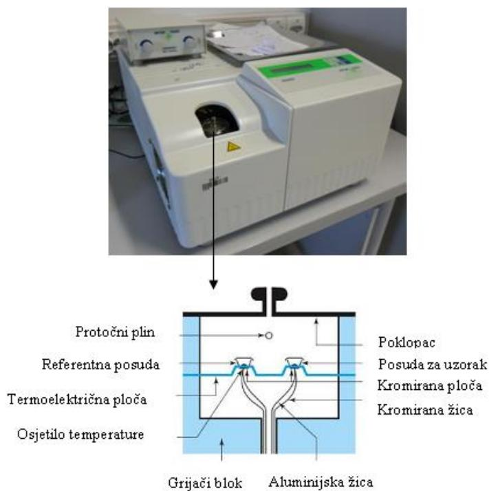
**Slika 28.** Diferencijalni pretražni kalorimetar Mettler toledo DSC 823<sup>e</sup>
