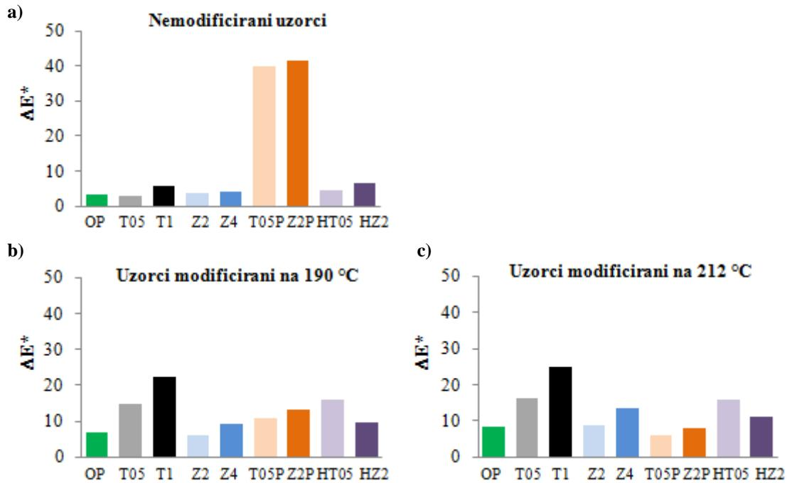
**Slika 49.** Promjena boje uzoraka drva nakon premazivanja
