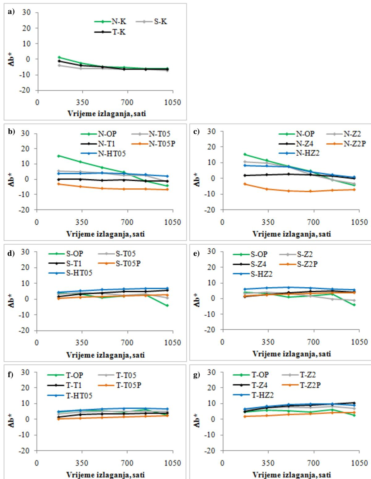
**Slika 53.** Promjena koordinate  $b^*$  ( $\Delta b^*$ ) nepremazanih i premazanih nemodificiranih (N) i toplinski modificiranih uzoraka na  $190\text{ }^\circ\text{C}$  (S) i  $212\text{ }^\circ\text{C}$  (T) tijekom ubrzanog izlaganja u QUV uređaju
