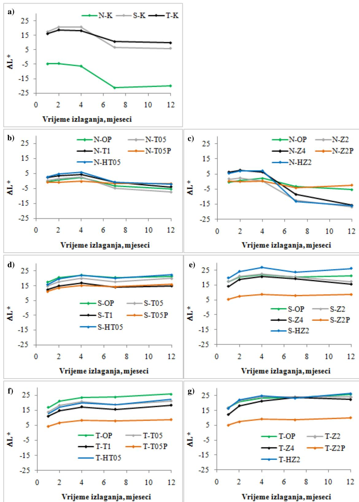
**Slika 55.** Promjena svjetline ( $\Delta L^*$ ) nepremazanih i premazanih nepromodificiranih (N) i toplinski modificiranih uzoraka na 190 °C (S) i 212 °C (T) tijekom prirodnog izlaganja
