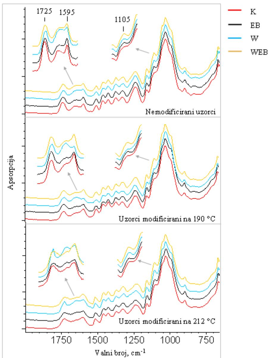
**Slika 69.** FTIR-ATR spektri nemodificiranih i toplinski modificiranih uzoraka prije ekstrakcije (K) i nakon ekstrakcije u: etanol-benzenu (EB), vodi (W) i kombinaciji vode i etanol-bentena (WEB)
