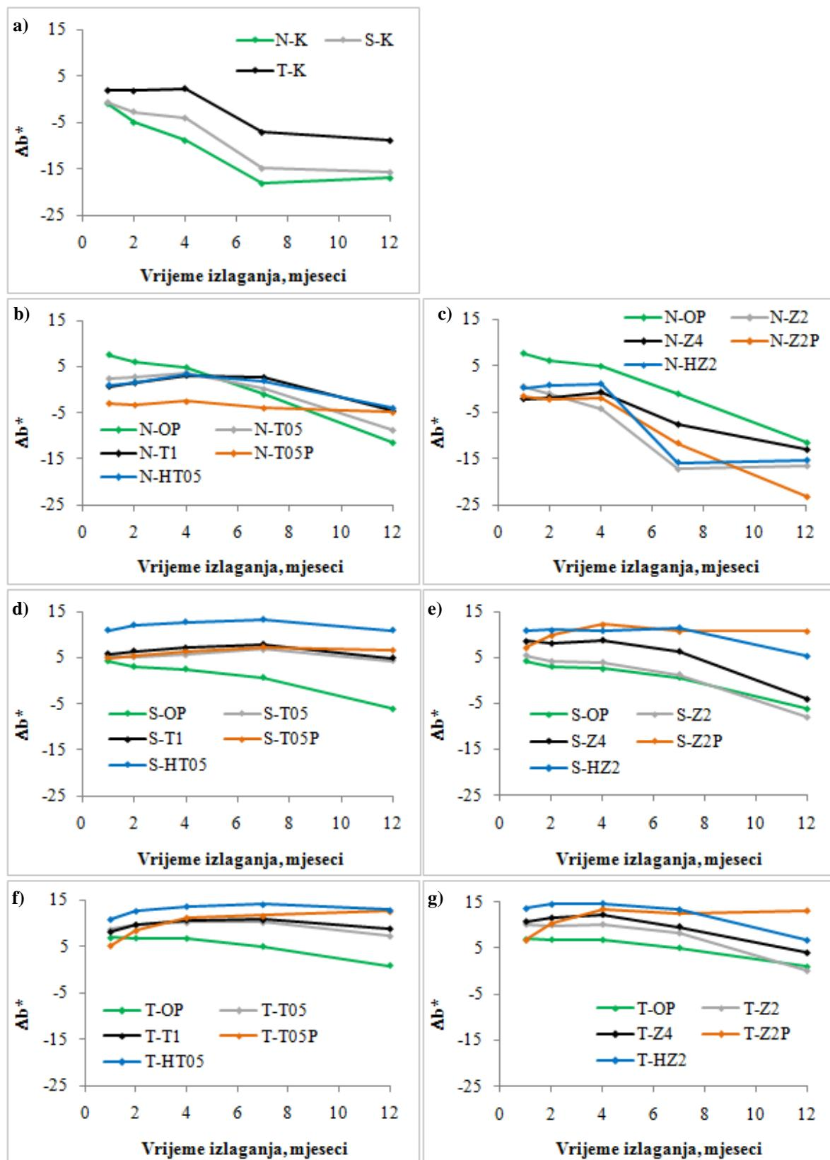
**Slika 57.** Promjena koordinate  $b^*$  ( $\Delta b^*$ ) nepremazanih i premazanih nemodificiranih (N) i toplinski modificiranih uzoraka na  $190\text{ }^\circ\text{C}$  (S) i  $212\text{ }^\circ\text{C}$  (T) tijekom prirodnog izlaganja
