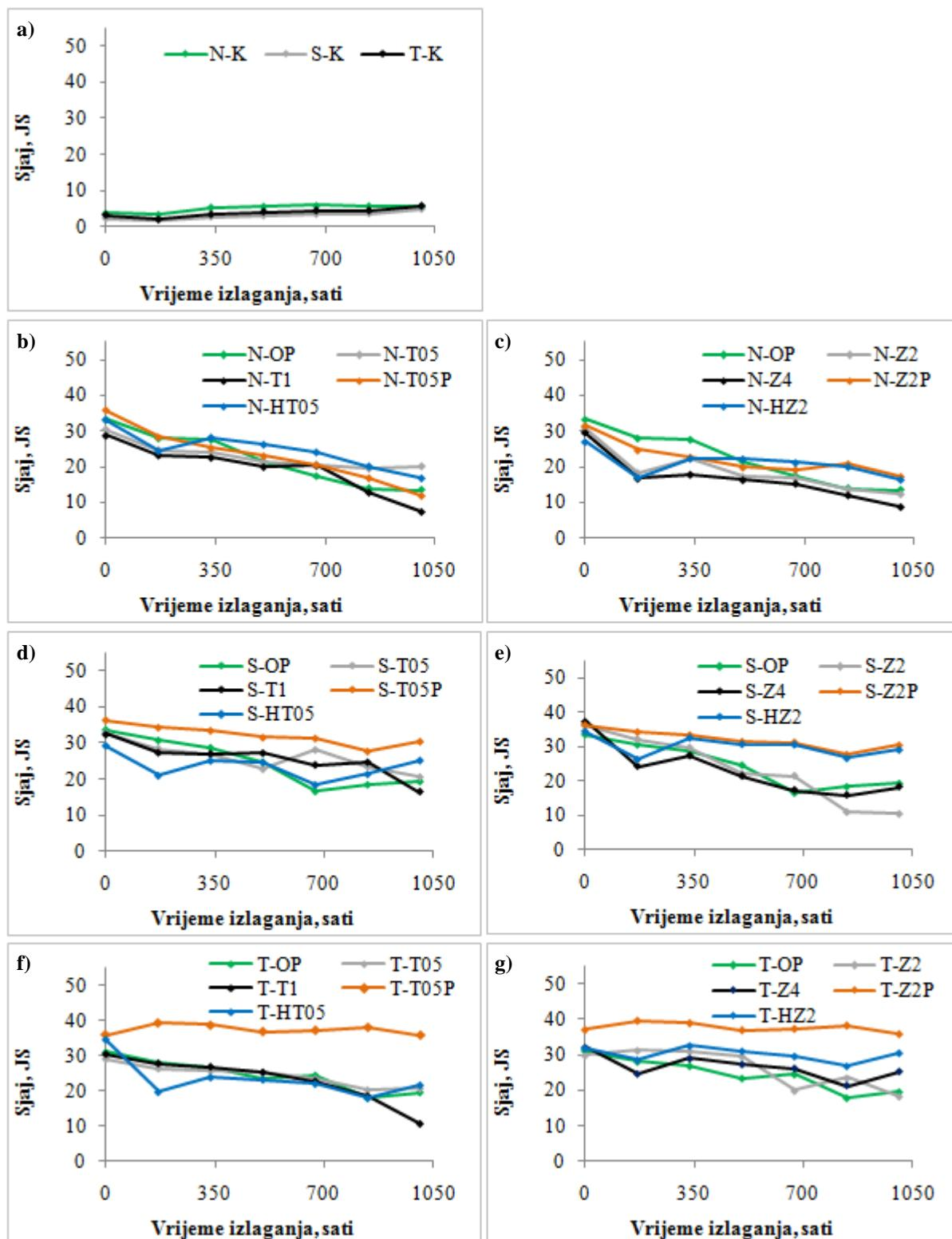
**Slika 66.** Vrijednosti sjaja pod kutom od  $60^\circ$  nepremazanih i premazanih nemodificiranih (N) i toplinski modificiranih uzoraka na  $190^\circ\text{C}$  (S) i  $212^\circ\text{C}$  (T) tijekom ubrzanog izlaganja
