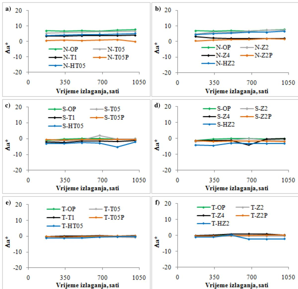
**Slika 61.** Promjena koordinate  $a^*$  ( $\Delta a^*$ ) nemodificiranih (N) i toplinski modificiranih uzoraka na  $190\text{ }^\circ\text{C}$  (S) i  $212\text{ }^\circ\text{C}$  (T) iza slobodnih filmova premaza tijekom ubrzanog izlaganja
