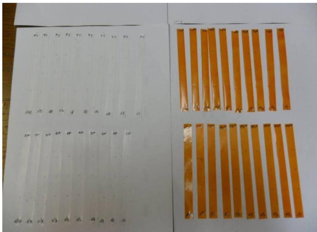
**Slika 30.** Pripremljeni slobodni filmovi za mjerjenje mehaničkih svojstava
