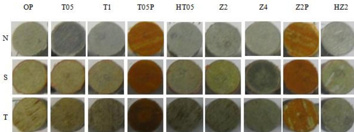
**Slika 36.** Izgled loma nakon otkidanja valjčića prilikom određivanje mokre adhezivne čvrstoće premaza na nemodificiranim (N) i toplinski modificiranim uzorcima na 190 °C (S) i 212 °C (T)
