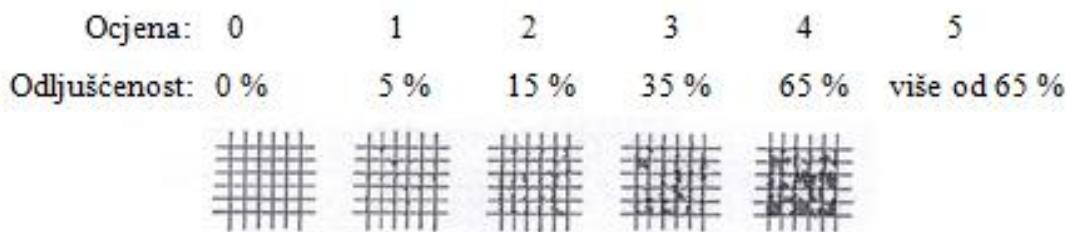
**Slika 13.** Mjerenje adhezije prema HRN EN ISO 2409
