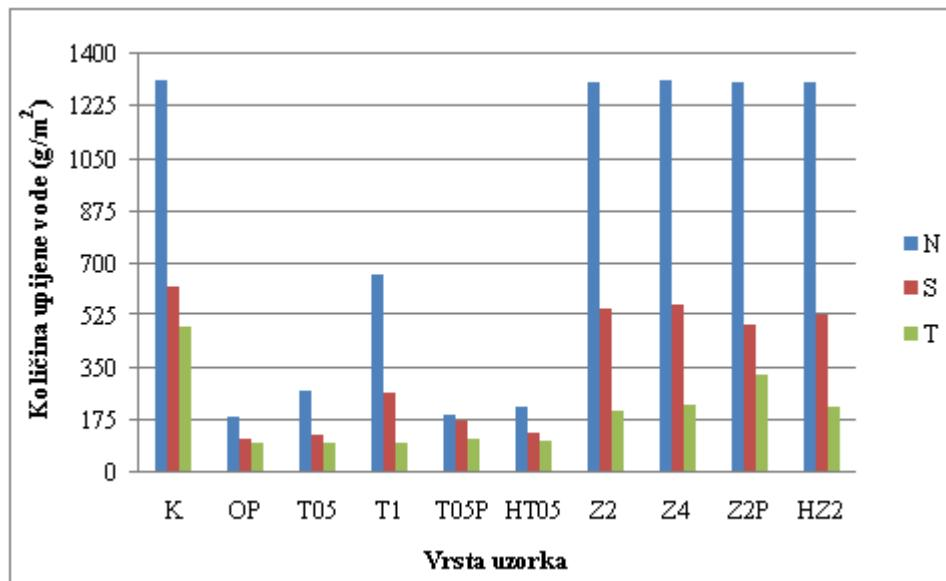
**Slika 38.** Upojnost tekuće vode nemodificiranih (N) i toplinski modificiranih uzoraka na 190 °C (S) i 212 °C (T)
