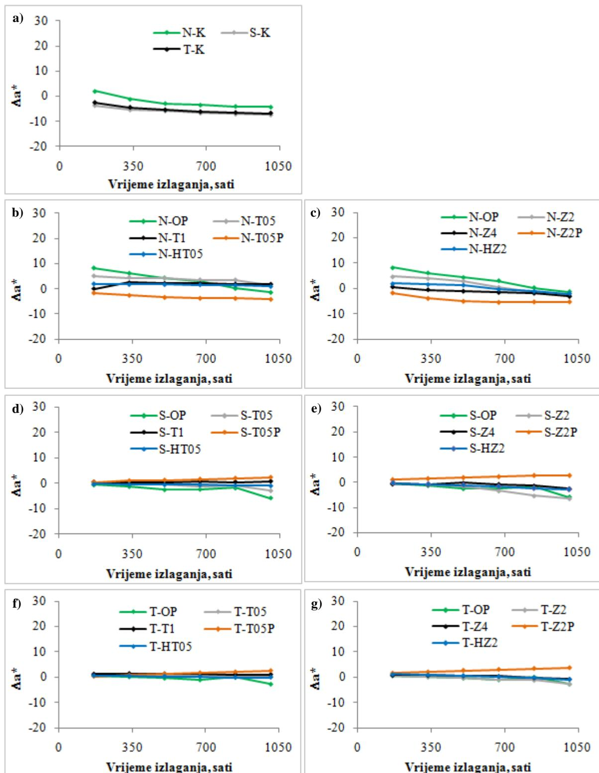
**Slika 52.** Promjena koordinate  $a^*$  ( $\Delta a^*$ ) nepremazanih i premazanih nemodificiranih (N) i toplinski modificiranih uzoraka na  $190\text{ }^\circ\text{C}$  (S) i  $212\text{ }^\circ\text{C}$  (T) tijekom ubrzanog izlaganja u QUV uređaju
