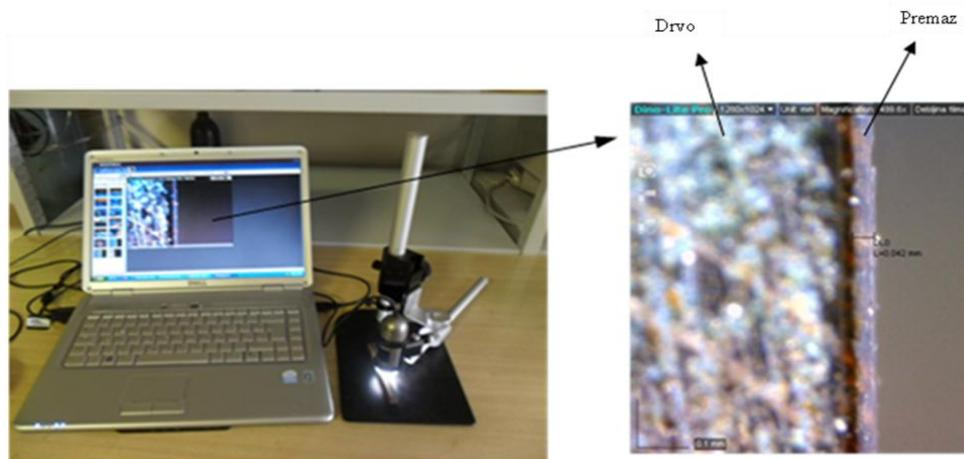
**Slika 12.** Određivanje debljine suhog filma premaza digitalnom kamerom
