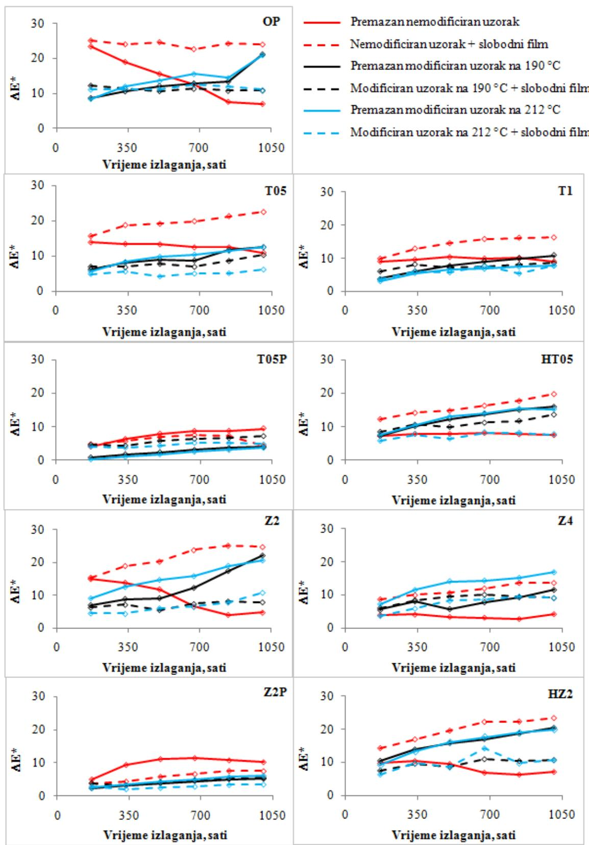
**Slika 63.** Promjena boje premazanih uzoraka i zbroj promjene boje slobodnih filmova premaza i uzoraka drva u njih tijekom ubrzanog izlaganja
