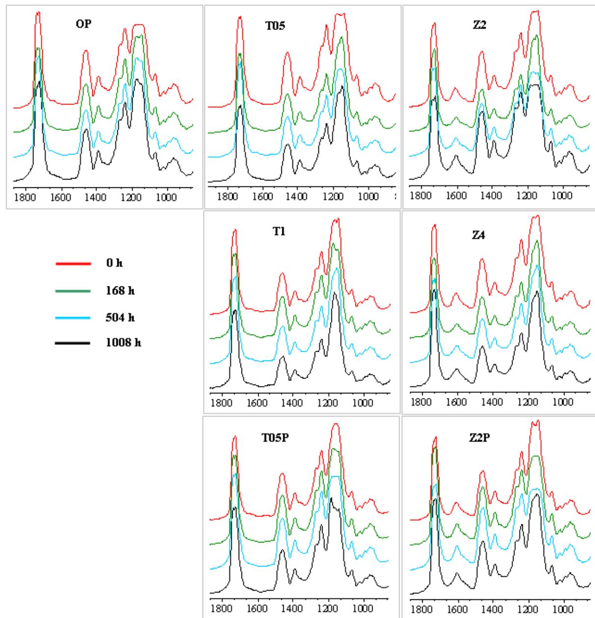
**Slika 76.** Promjene na FTIR spektrima u području između 1800 – 900 cm<sup>-1</sup> na slobodnim filmovima premaza tijekom ubrzanog izlaganja
