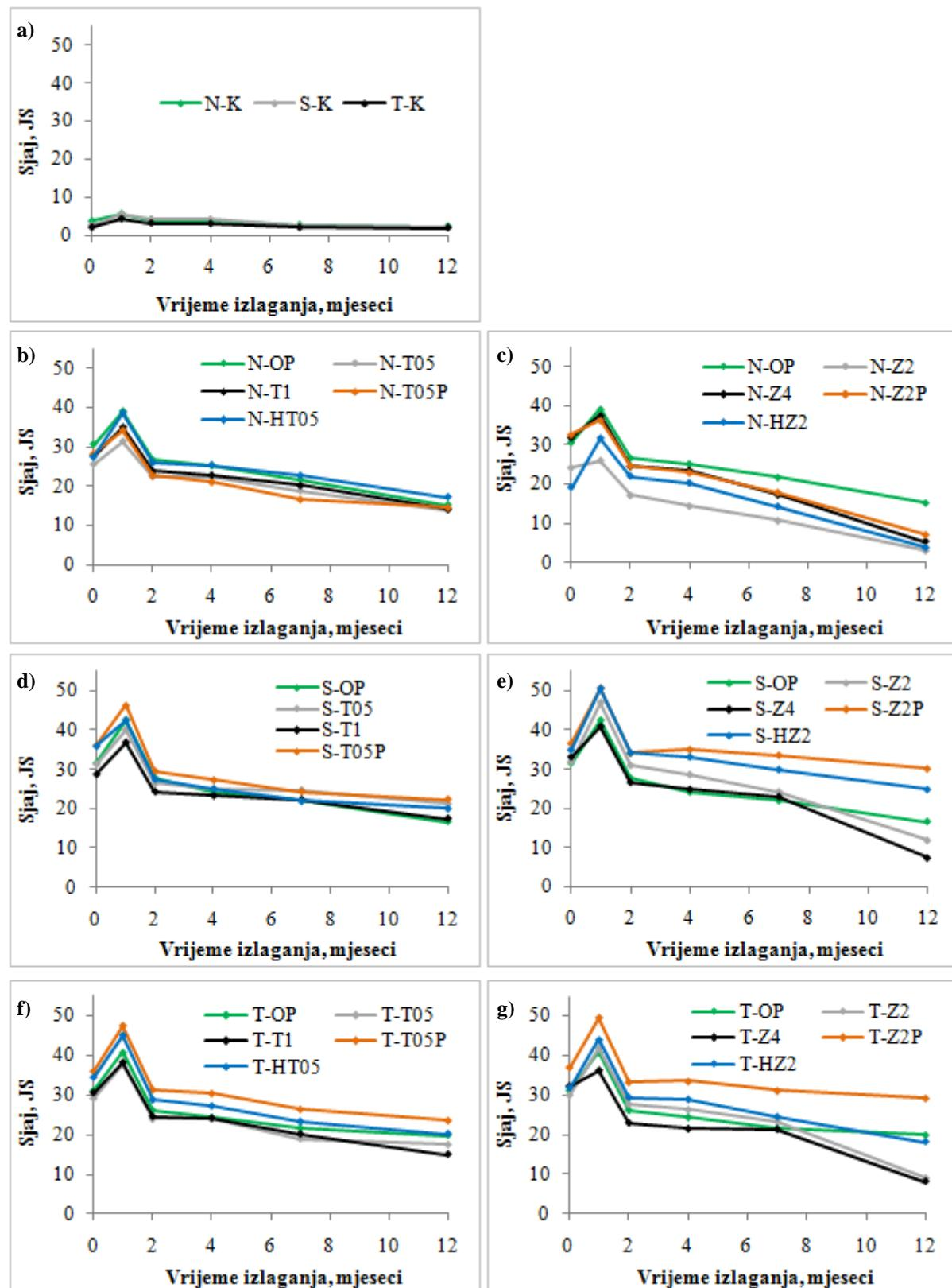
**Slika 67.** Vrijednosti sjaja pod kutom od  $60^\circ$  nepremazanih i premazanih nemodificiranih (N) i toplinski modificiranih uzoraka na  $190\text{ }^\circ\text{C}$  (S) i  $212\text{ }^\circ\text{C}$  (T) tijekom prirodnog izlaganja
