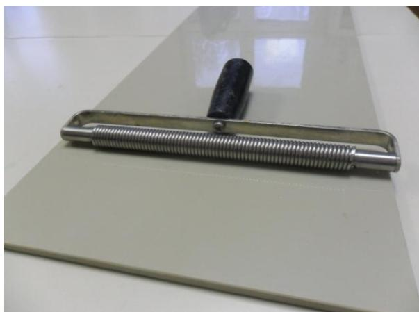
**Slika 10.** Nanošenje premaza spiralnim aplikatorom na polipropilensku ploču
