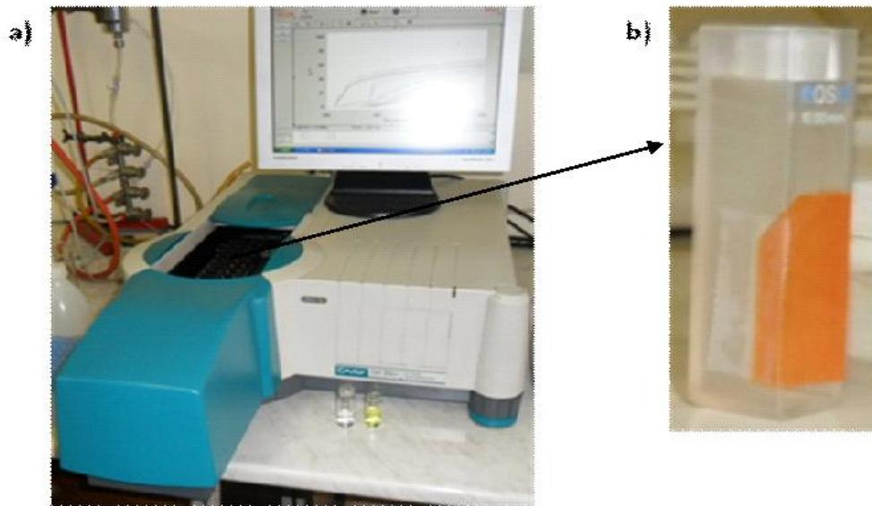
**Slika 29.** UV/VIS spektrofotometar VARIAN (a) i slobodni film premaza zalipljenog na kivetu (b)
