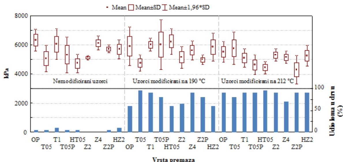
**Slika 35.** Početna suha adhezija čvrstoća premazanih nemodificiranih i toplinski modificiranih uzoraka određena metodom otkidanja valjčića s udjelom loma u drvu
