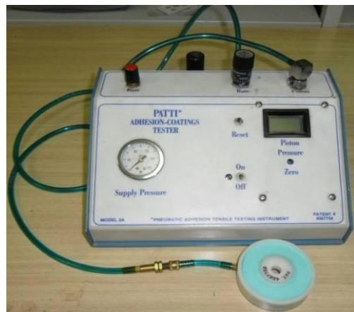
**Slika 16.** Uredaj za određivanje adhezije metodom otkidanja valjčića (Pneumatic Adhesion Tensile Testing Instrument - PATTI)
