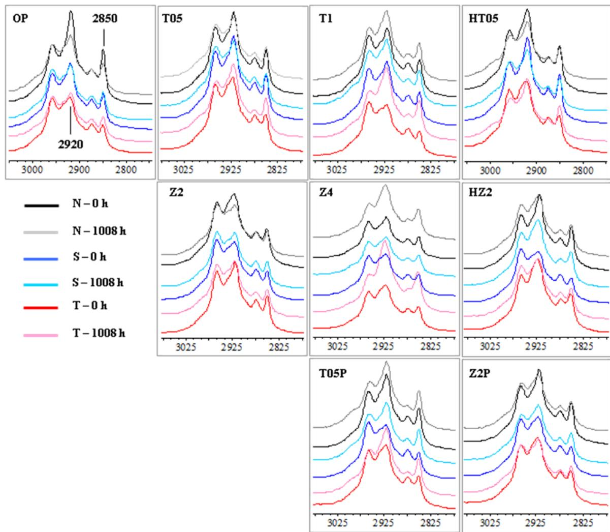
**Slika 77.** FTIR-ATR spektri u području između  $3000 - 2800 \text{ cm}^{-1}$  premazanih nemodificiranih uzoraka (N) i uzoraka toplinski modificiranih na  $190^\circ\text{C}$  (S) i  $212^\circ\text{C}$  (T) prije izlaganja (0 h) i na kraju ubrzanog izlaganja (1008 h)
