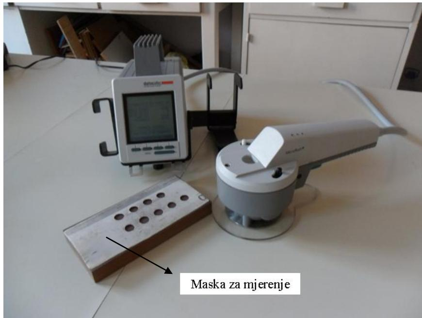
**Slika 23.** Spektralni fotometar Microflash 100d Datacolor
