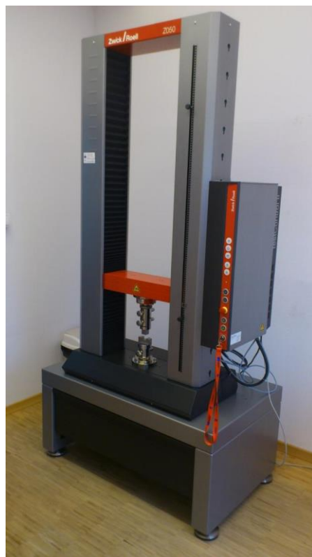
Slika 40. Fotografija kidalice Zwick/Roell Z050
