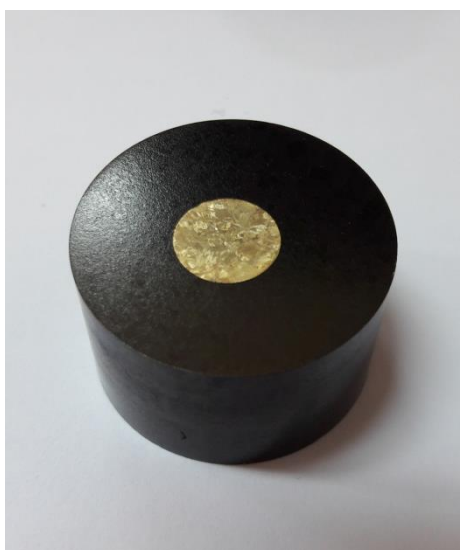
Slika 27. Fotografija uzorka pripremljenog za mikrostrukturnu analizu
