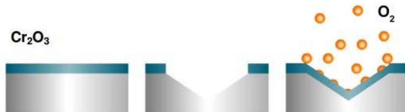
Slika 55. Prikaz mehanizma samoobnavljanja pasivnog filma kromovih oksida na površini [104]
