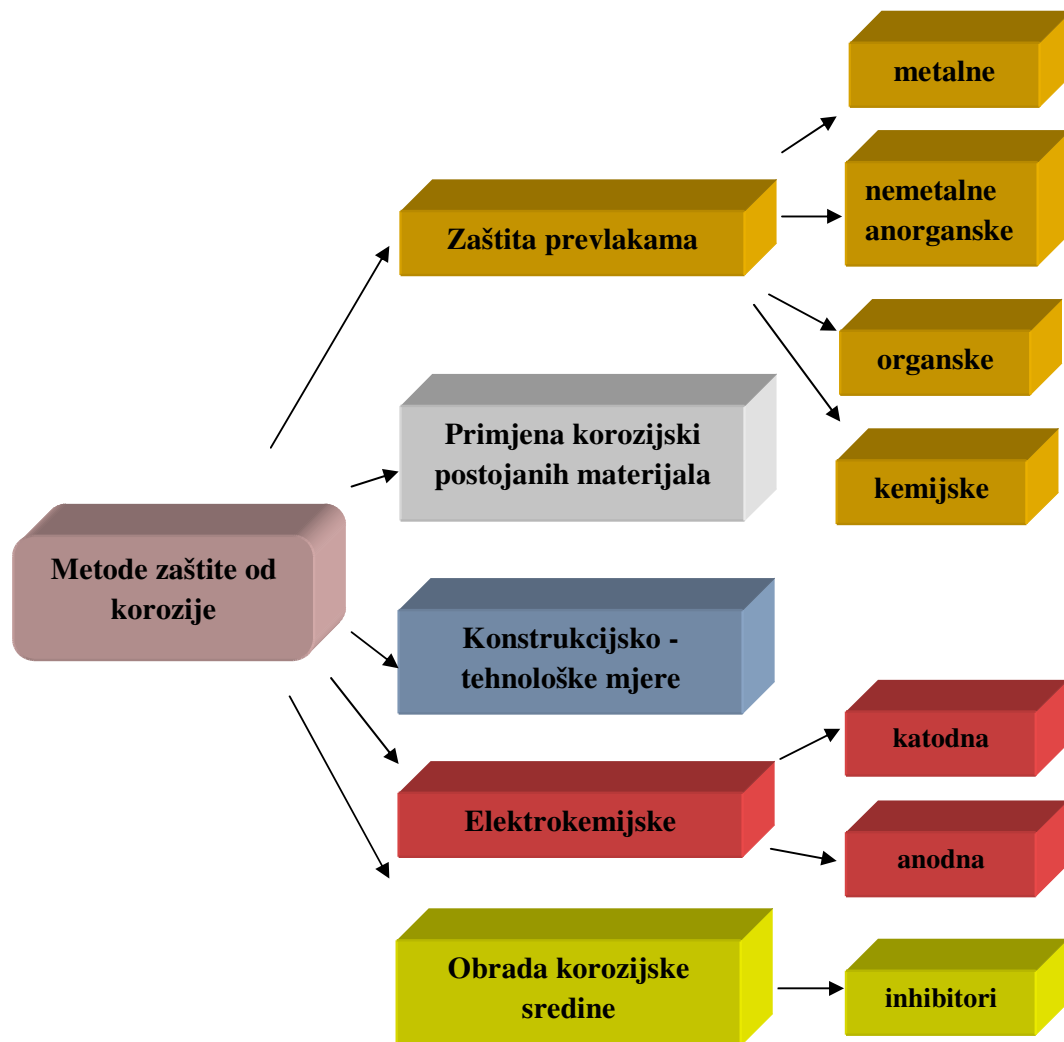
Slika 58. Shematski prikaz metoda zaštite od korozije
