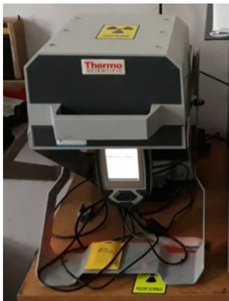
Slika 67. Uređaj XRF-Analyzer NITON XL3t za provođenje rendgenske fluorescentne analize
