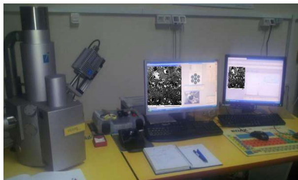
Slika 78. Pretražni elektronski mikroskop TESCAN VEGA 5136MM opremljen s energetskom disperzijskim spektrometrom
