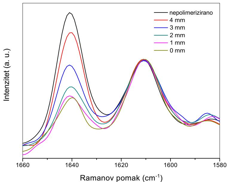
**Slika 19.** Dio Ramanovog spektra koji se koristi za mjerjenje stupnja polimerizacije kod kompozitnih materijala. Nakon normiranja spektara na referentnu vrpcu na  $1610 \text{ cm}^{-1}$ , razlike u intenzitetu vrpce na  $1640 \text{ cm}^{-1}$  ukazuju na smanjenje učinkovitosti polimerizacije s povećanom debljinom sloja kompozitnog materijala. Preuzeto i prilagođeno iz (126).
