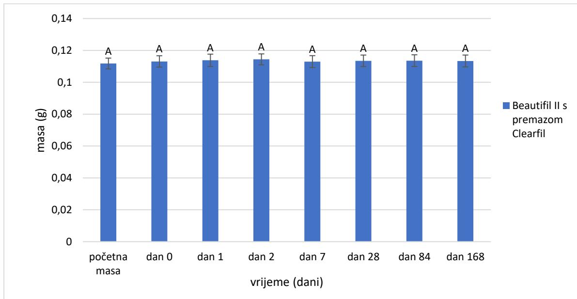
Slika 22. Promjene vrijednosti mase uzorka kod giomera Beautifil II s Clearfil Universal Bond Quick adhezijskim sustavom. Velika slova označavaju statistički homogene skupine unutar materijala. Stupci pogrešaka označavaju jednu standardnu devijaciju.
