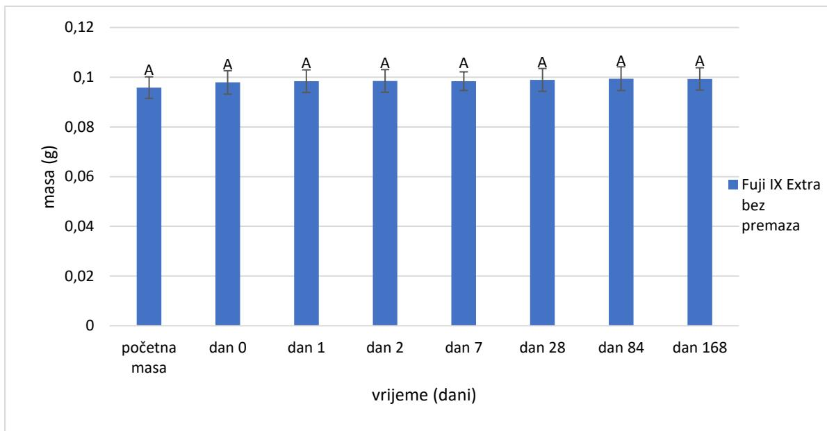
Slika 30. Promjene vrijednosti mase uzorka kod staklenoionomernog cementa Fuji IX Extra bez premaza. Velika slova označavaju statistički homogene skupine unutar materijala. Stupci pogrešaka označavaju jednu standardnu devijaciju.
