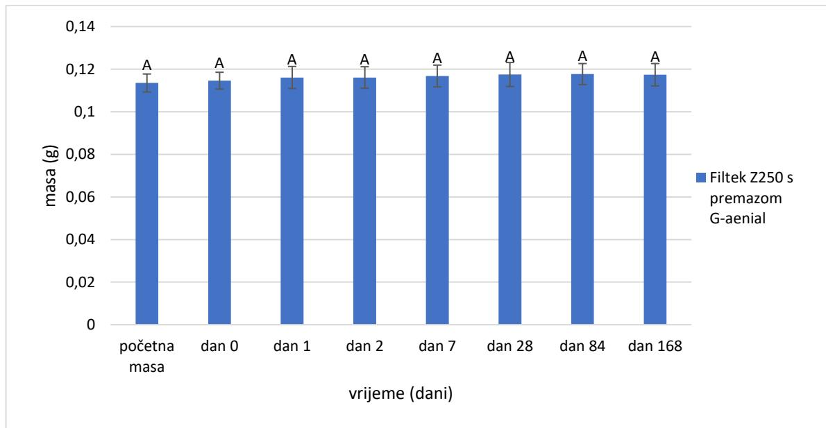
Slika 29. Promjene vrijednosti mase uzorka kod konvencionalnog kompozita Filtek Z250 s G-aenial Bond adhezijskim sustavom. Velika slova označavaju statistički homogene skupine unutar materijala. Stupci pogrešaka označavaju jednu standardnu devijaciju.
