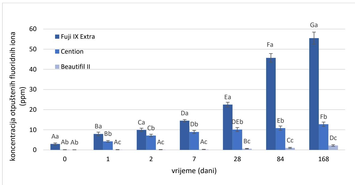
Slika 9. Koncentracija otpuštenih fluoridnih iona iz restaurativnih materijala bez premaza. Velika slova označavaju statistički homogene skupine unutar materijala. Mala slova označavaju statistički homogene skupine unutar vremenskih točaka. Stupci pogrešaka označavaju jednu standardnu devijaciju.
