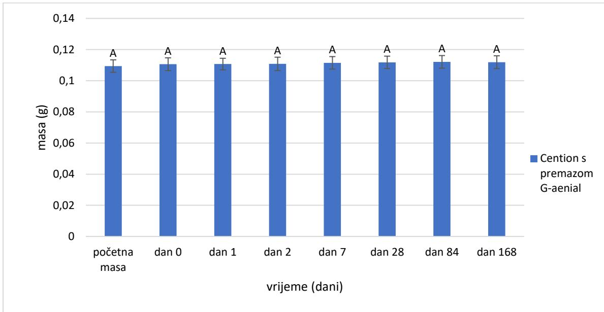
Slika 26. Promjene vrijednosti mase uzorka kod alkasitnog kompozitnog materijala Cention s G-aenial Bond adhezijskim sustavom. Velika slova označavaju statistički homogene skupine unutar materijala. Stupci pogrešaka označavaju jednu standardnu devijaciju.
