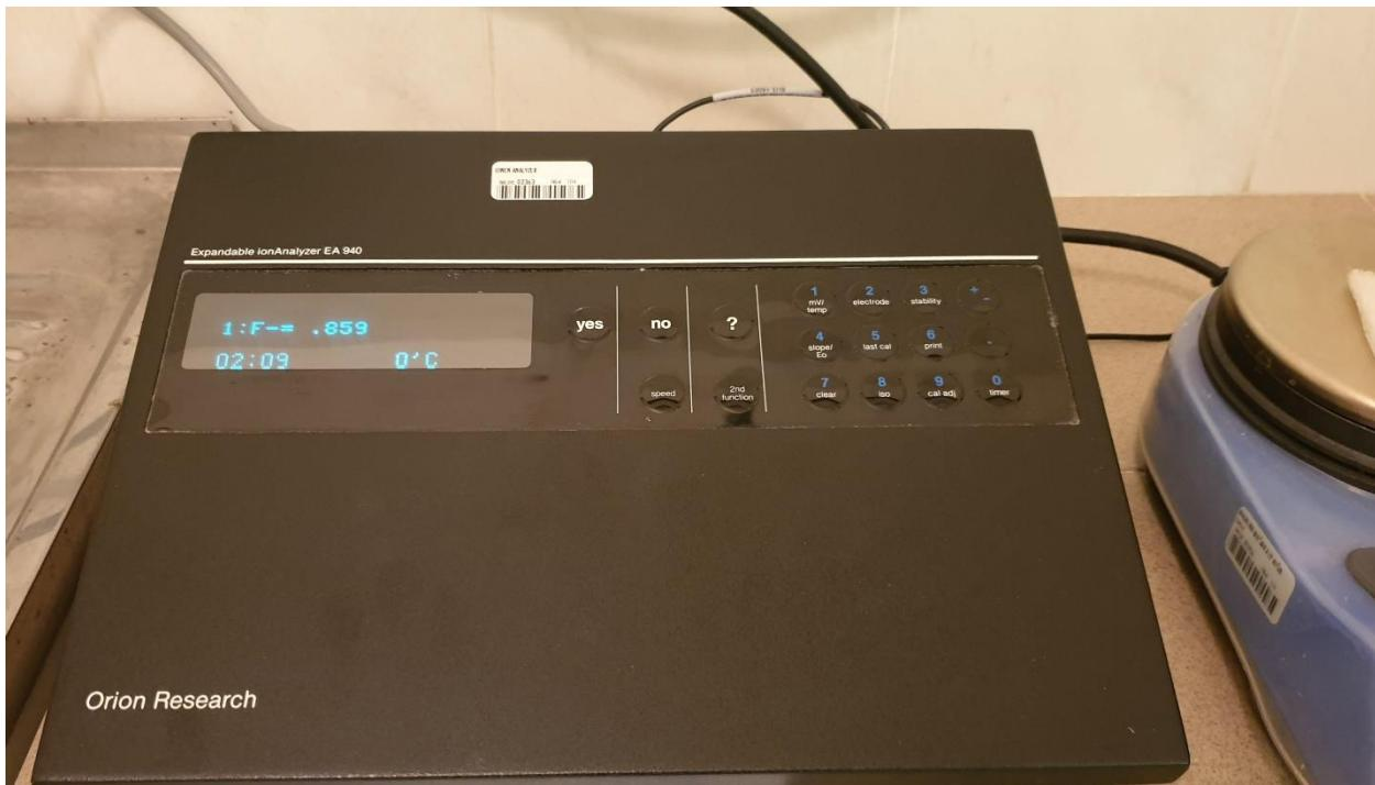
Slika 7. Čitač Expandable IonAnalyzer EA 940
