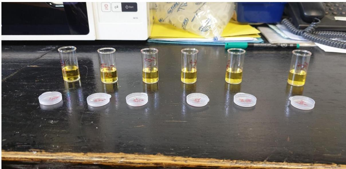
Slika 6. Priprema uzorka tekućine za mjerjenje fluoridnih iona
