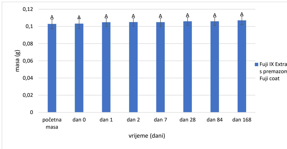
Slika 31. Promjene vrijednosti mase uzorka kod staklenoionomernog cementa Fuji IX Extra s Fuji Coat LC premazom. Velika slova označavaju statistički homogene skupine unutar materijala. Stupci pogrešaka označavaju jednu standardnu devijaciju.
