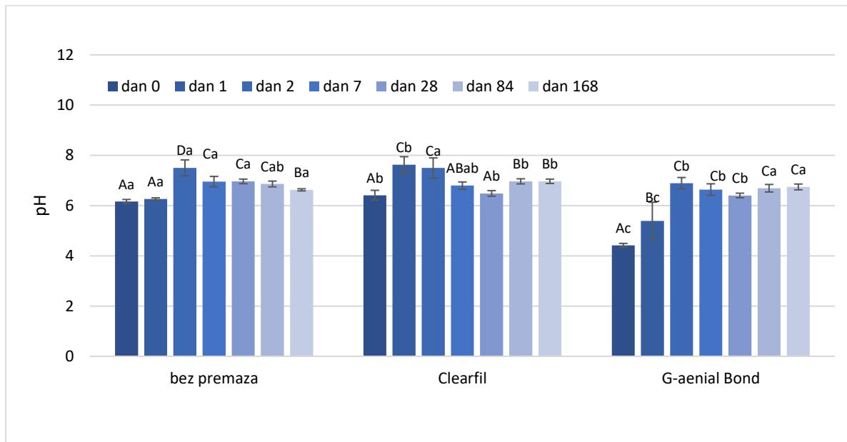
Slika 19. Promjene pH vrijednosti otopine kod konvencionalnog kompozita Filtek Z250. Velika slova označavaju statistički homogene skupine unutar materijala. Mala slova označavaju statistički homogene skupine unutar vremenskih točaka. Stupci pogrešaka označavaju jednu standardnu devijaciju.
