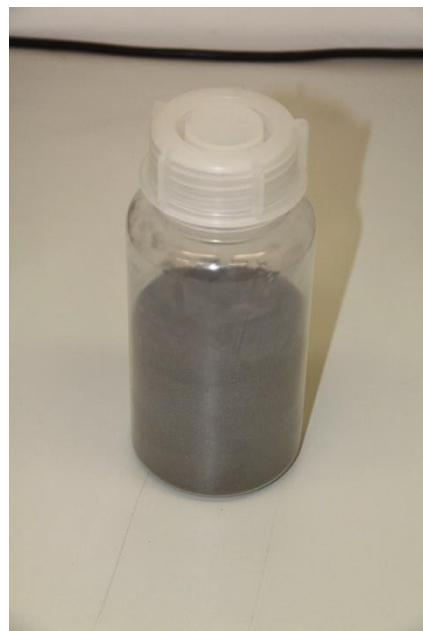
**Slika 26.** Titanov prah u posudi korišten za izradu uzorka
