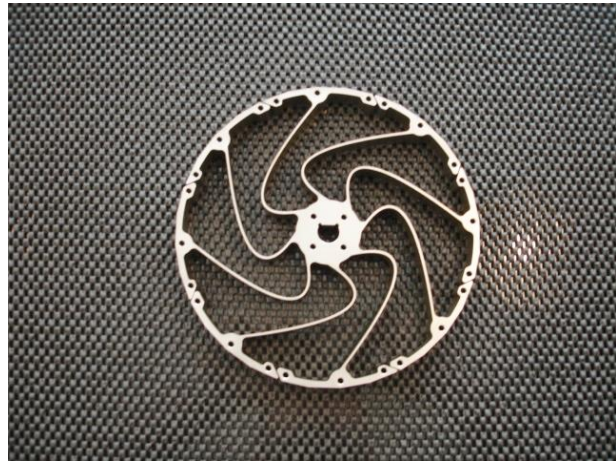
Slika 22. Složeni oblici dobiveni upotrebom EDM-a (preuzeto iz 112)
