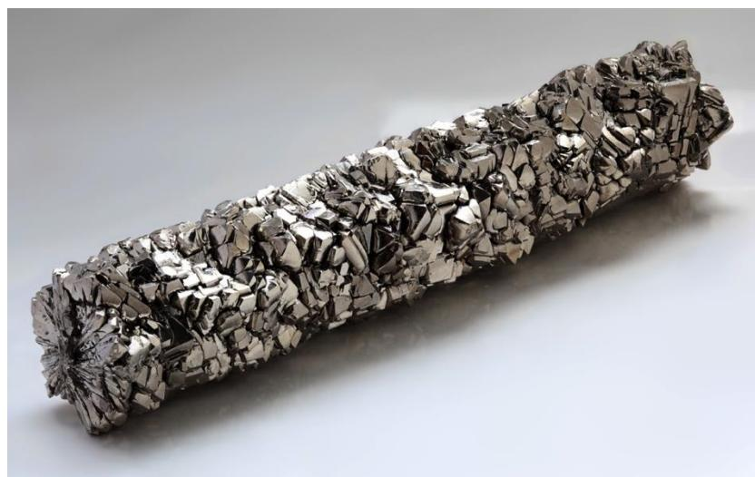
**Slika 14.** Šipka kristaliziranog titana, visoke čistoće 99.995 % (preuzeto iz 78)
