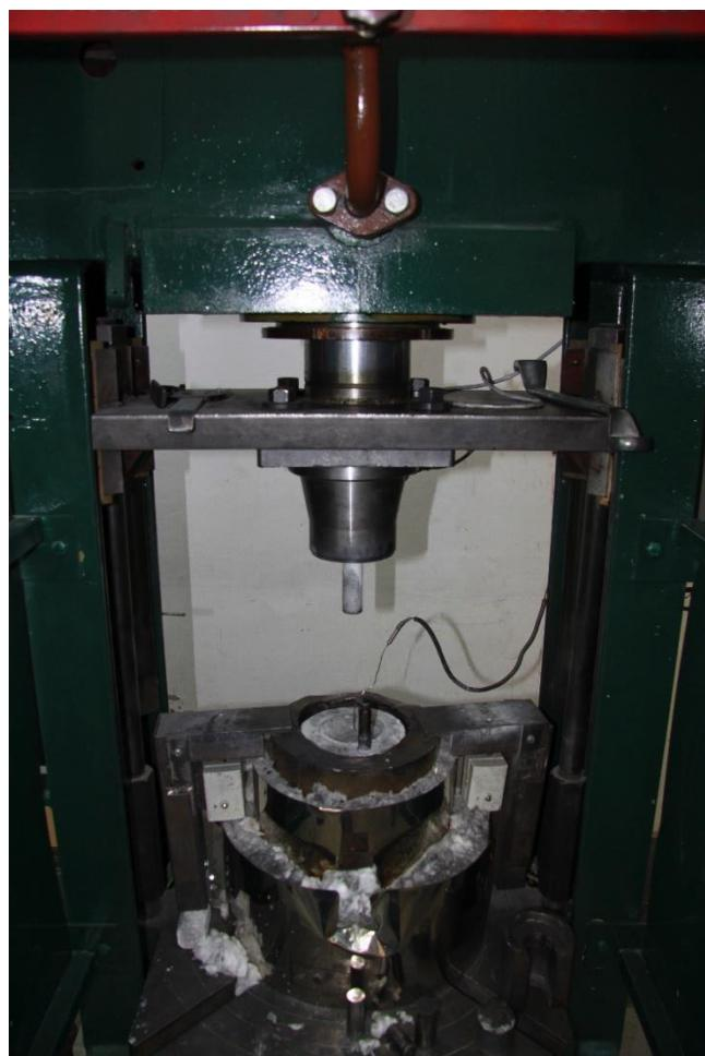
**Slika 30.** Preša za ekstruzijski postupak
