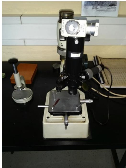
**Slika 33.** Ispitivanje tvrdoće po Vickersu
