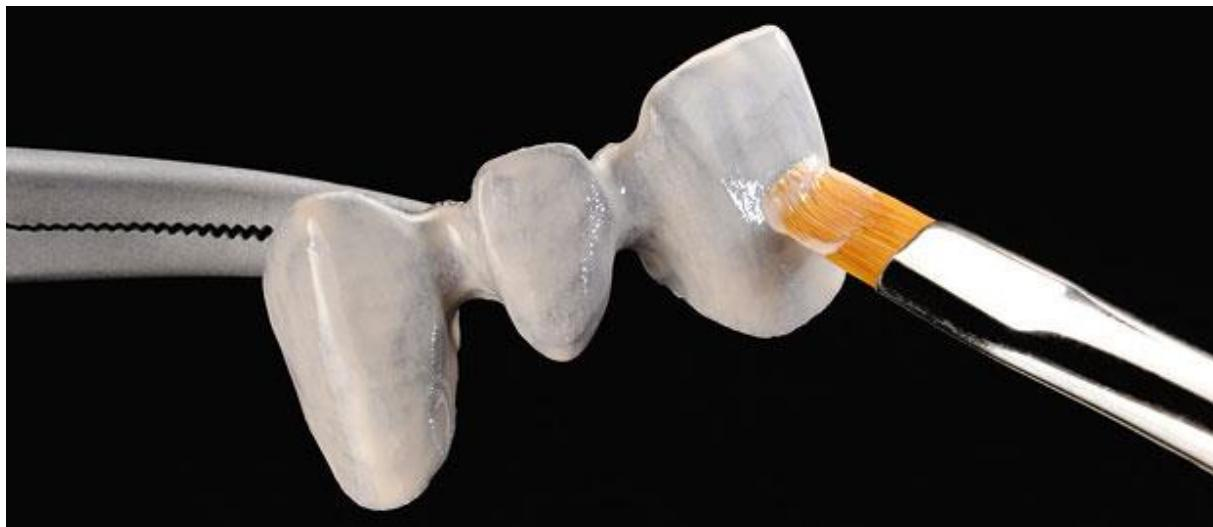
**Slika 3.** Nanošenje sloja opakera na metalnu osnovnu konstrukciju maskira boju metala i osigurava vezu između metala i keramike (preuzeto iz 29)
