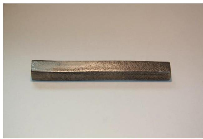
**Slika 31.** Prikaz jedne od triju šipki dobivenih postupcima metalurgije praha
