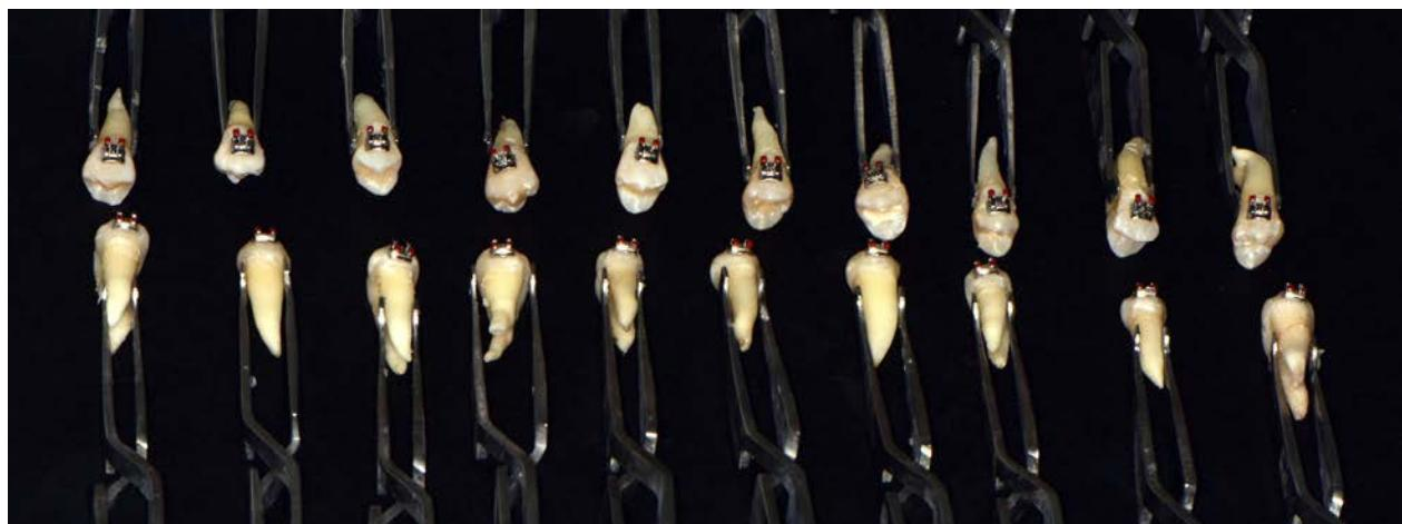
Slika 11. Uzorak pripremljen za termocikliranje
