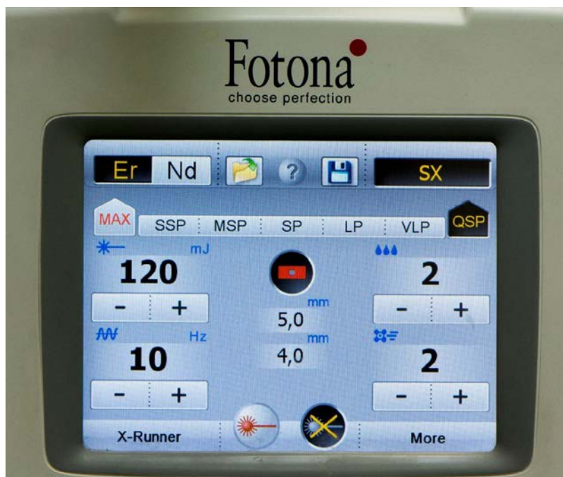
Slika 8. Prikaz zaslona pri QSP operacijskom modu lasera
