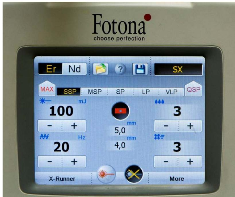
Slika 6. Prikaz zaslona pri SSP operacijskom modu lasera
