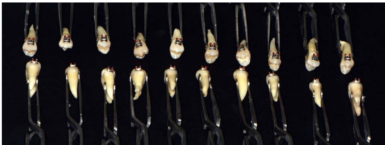
Slika 11. Uzorak pripremljen za termocikliranje
