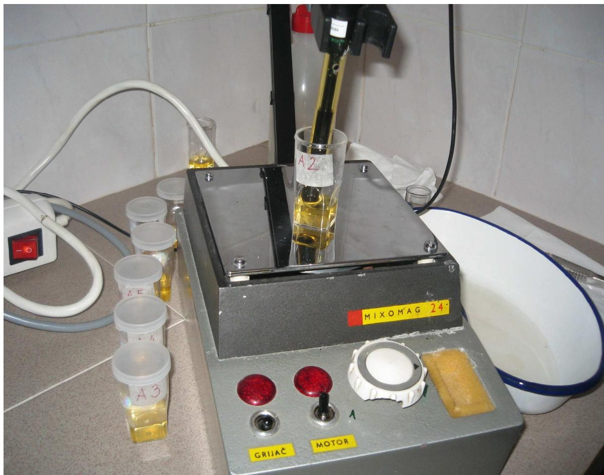
Slika 13. Mjerenje ion - selektivnom elektrodom
