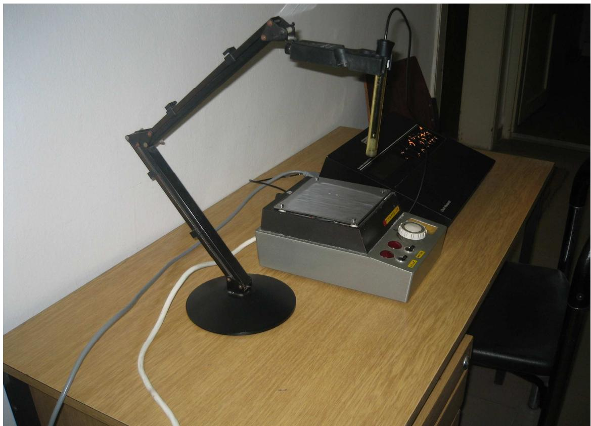
Slika 3. Ion - selektivna elektroda
