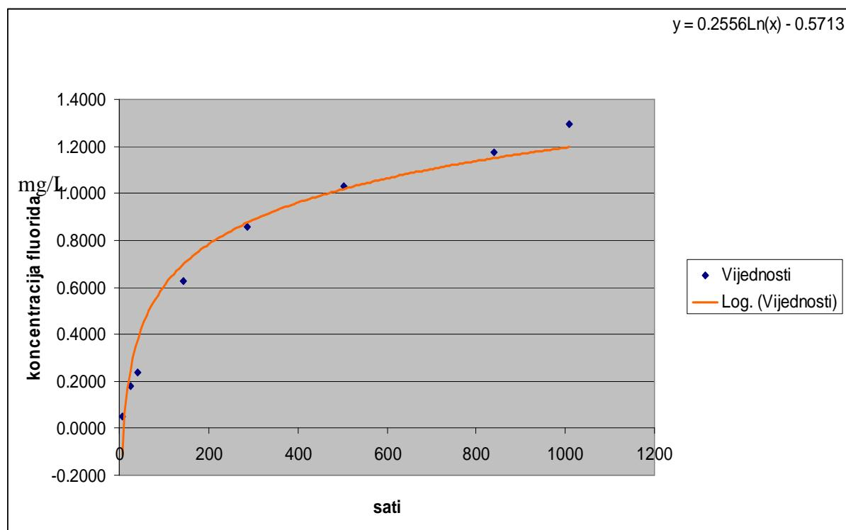
Slika 14. koncentracija otpuštenih fluoridnih iona u ovisnosti s vremenom – uzorak A
