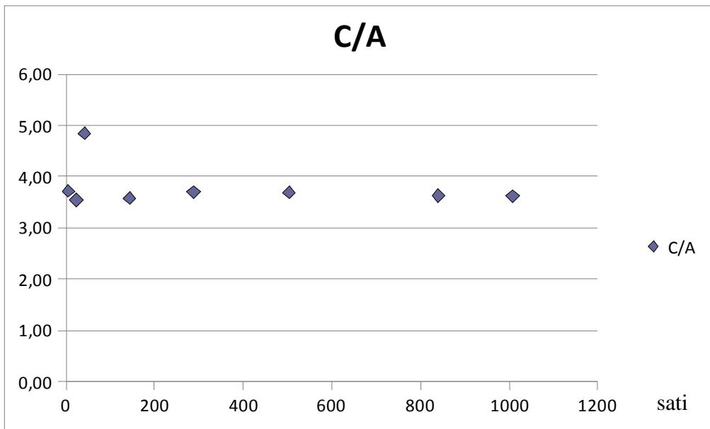
Slika 25. Usporedba uzorka C i uzorka A zavisno o otpuštenim fluoridnim ionima
