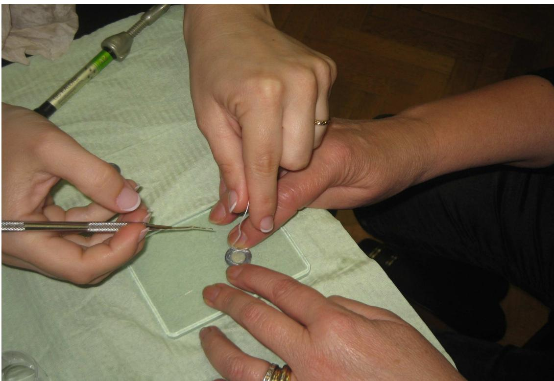
Slika 8. Izrada diskova iz kompozitnog materijala
