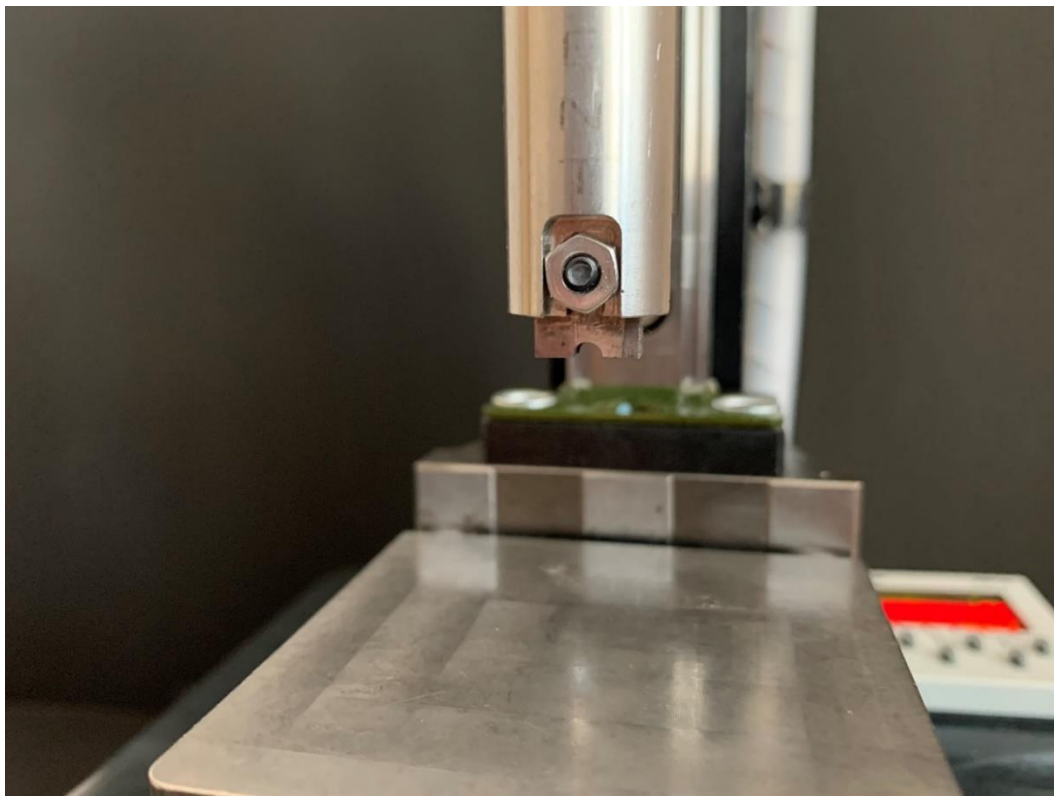
Slika 20. Ultradentova naprava za prihvata (eng. jig )
