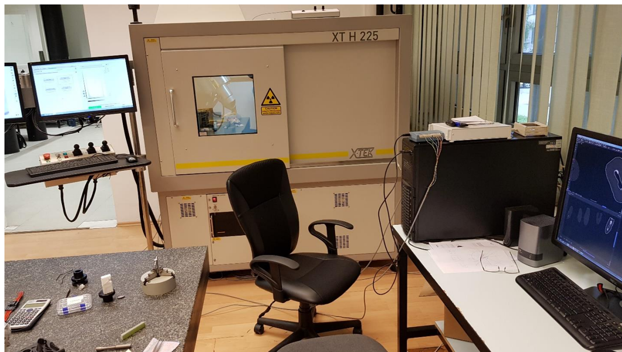
Slika 22. Mikro-CT uređaj (Nikon Metrology Europe NV, Leuven, Belgija)
