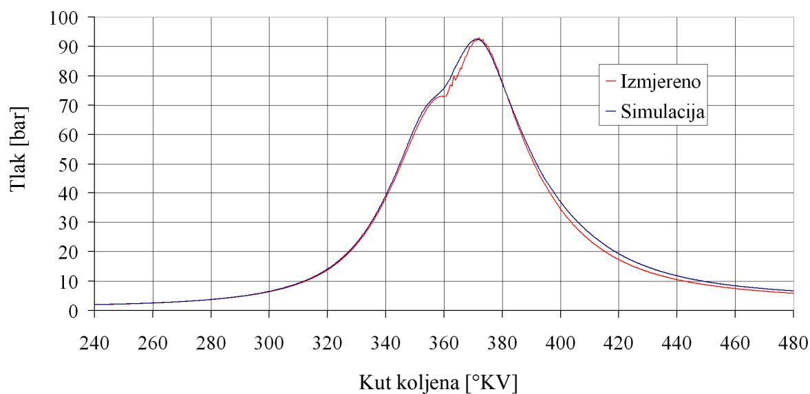
**Slika 6.9.** Usporedba izmijerenog i izračunatog tlaka u cilindru za mjernu točku D215HI20
