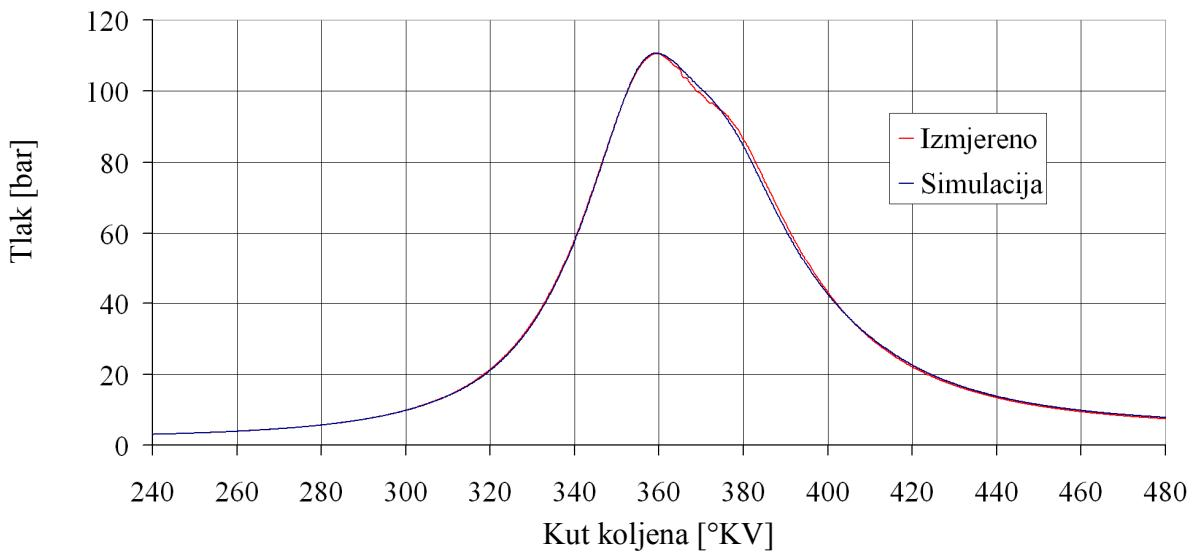
Slika 6.13. Usporedba izmjereno i izračunatog tlaka u cilindru za mjeru točku D224HI20
