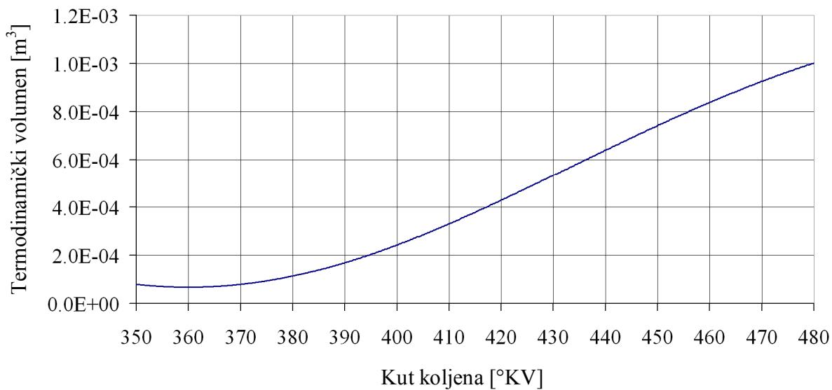
Slika 7.7. Promjena termodinamičkoga volumena cijelog cilindra
