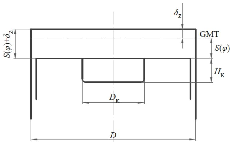
**Slika 4.17.** Geometrijske karakteristike radnoga prostora unutar cilindra
