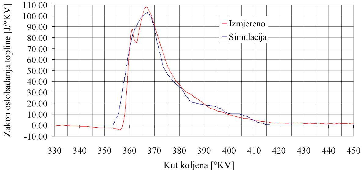
Slika 6.3. Zakon oslobođanja topline u cilindru za mjernu točku D215HI15
