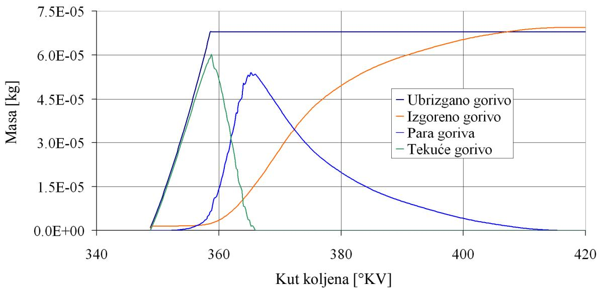
Slika 7.6. Promjene ukupnih masa različitih agregatnih stanja goriva u cilindru
