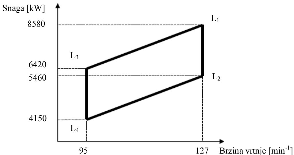
**Slika 8.9.** Područje rada motora MAN 6S50MC [107]
