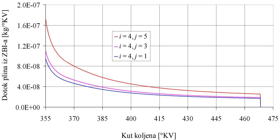
**Slika 7.41.** Dotok plina iz zone bez izgaranja za pakete iz četvrтoga aksijalnog reda
