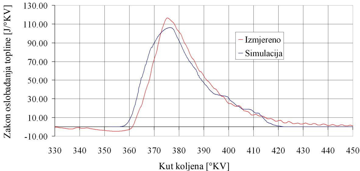
Slika 6.11. Zakon oslobođanja topline u cilindru za mjernu točku D224HI20
