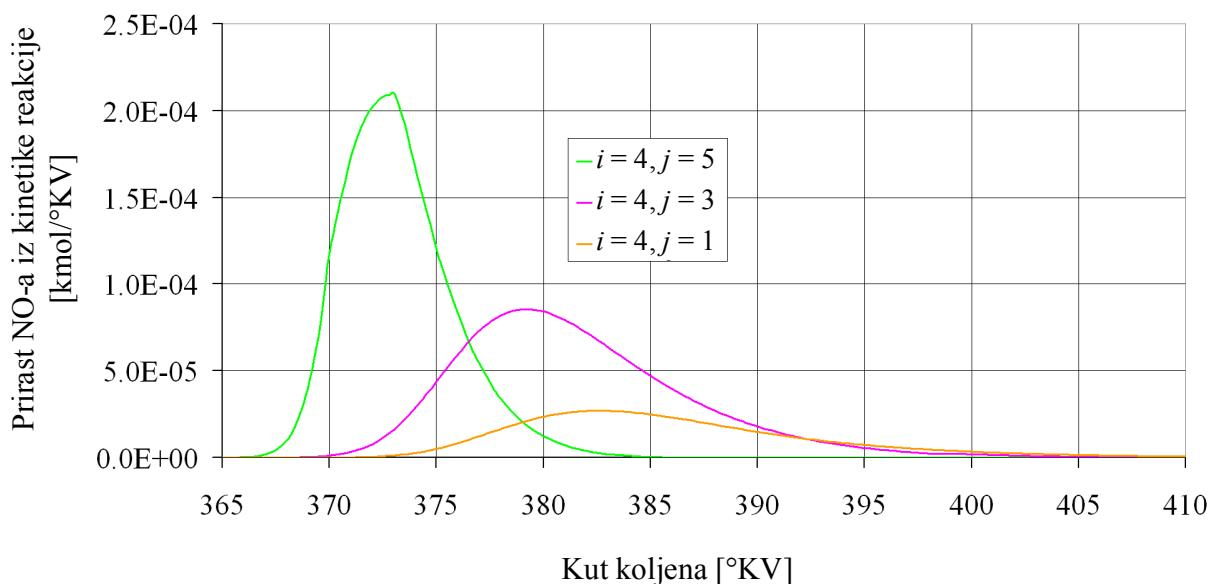
**Slika 7.55.** Prirost količine NO-a iz kinetike reakcije za pakete iz četvrtoga aksijalnog reda
