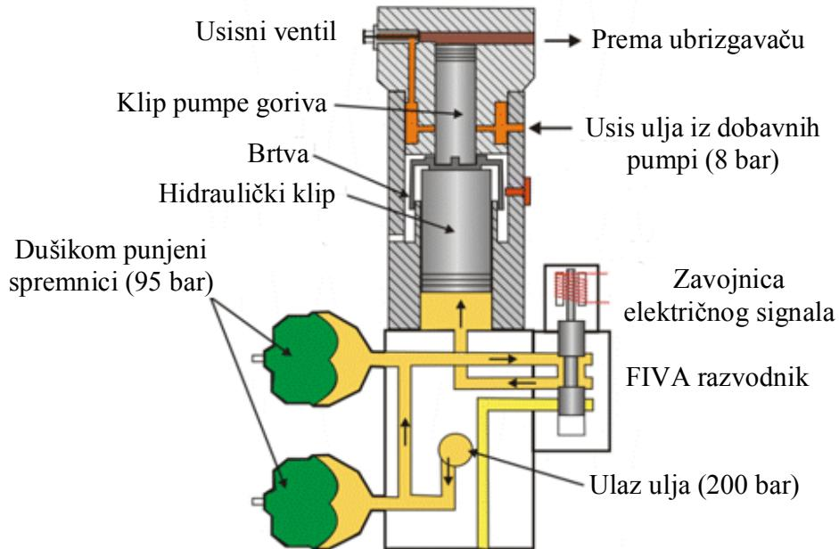
**Slika 8.7.** Visokotlačna pumpa goriva na motorima tipa MAN-ME [189]
