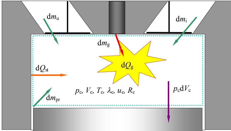
**Slika 2.1.** Prostor izgaranja jednog cilindra s granicama sustava [101]
