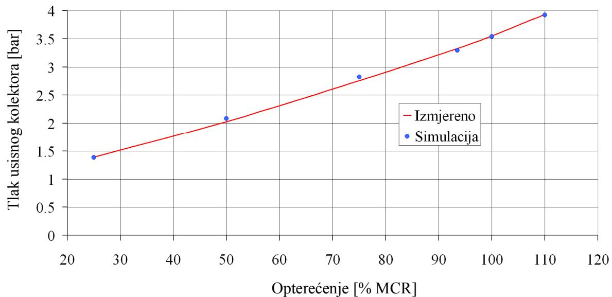
Slika 9.3. Usporedba izmjereno i simuliranoga tlaka u usisnom kolektoru na motoru MAN 6S50MC
