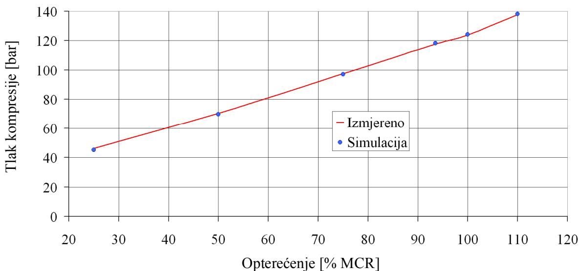
**Slika 9.1.** Usporedba izmјerenoga i simuliranoga tlaka kompresije na motoru MAN 6S50MC
