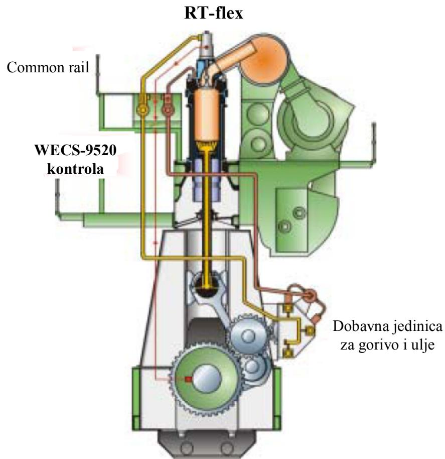
**Slika 8.4.** RT-flex serija sporohodnih dvotaktnih dizelskih motora (Wärtsilä) [187]
