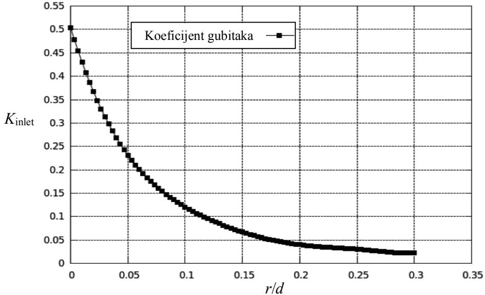
Slika 4.5. Koeficijent gubitaka prilikom turbulentnoga strujanja u mlaznici
