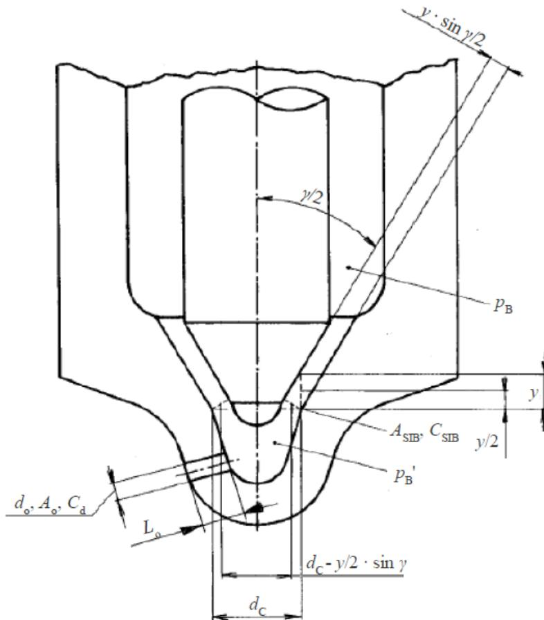
**Slika 4.1.** Glavne geometrijske dimenzije ubrizgavača i protočni presjeci [130]
