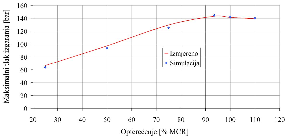
Slika 9.2. Usporedba izmjereno i simuliranoga maksimalnog tlaka izgaranja na motoru MAN 6S50MC
