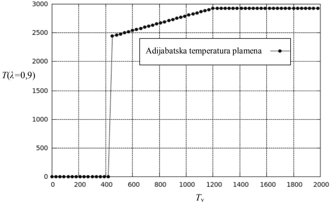
**Slika 4.18.** Promjena adijabatske temperature plamena blago bogate smjese u ovisnosti od temperature zraka  $T_v$ , uz  $p = 50 \text{ bar}$
