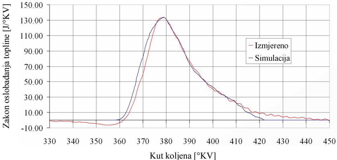
**Slika 6.15.** Zakon oslobođanja topline u cilindru za mjernu točku D224HI25
