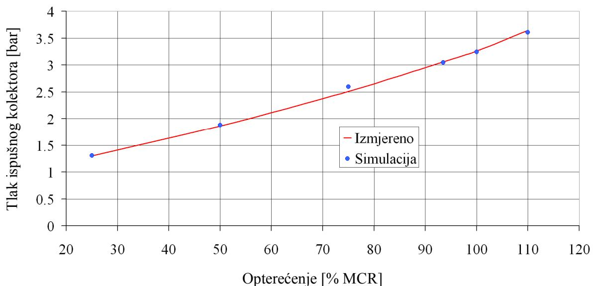
**Slika 9.5.** Usporedba izmjerenoga i simuliranoga tlaka u ispušnom kolektoru na motoru MAN 6S50MC
