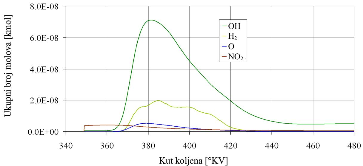
Slika 7.28. Ukupni broj molova OH-a, H<sub>2</sub>, O-a i NO<sub>2</sub> u cilindru motora
