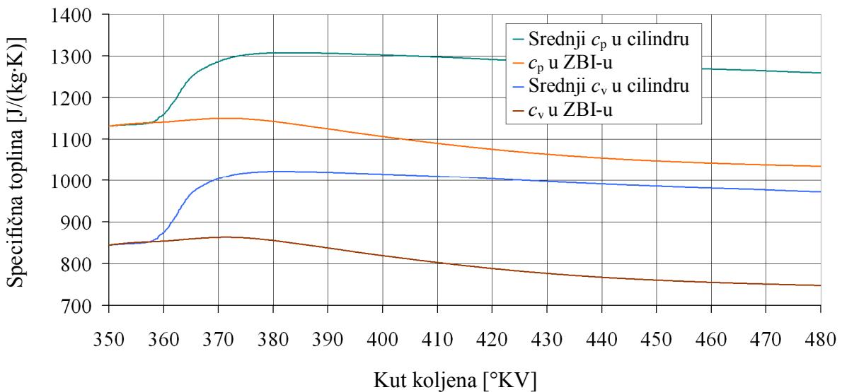
**Slika 7.15.** Specifična toplina pri konstantnom volumenu i tlaku za cijeli cilindar i ZBI
