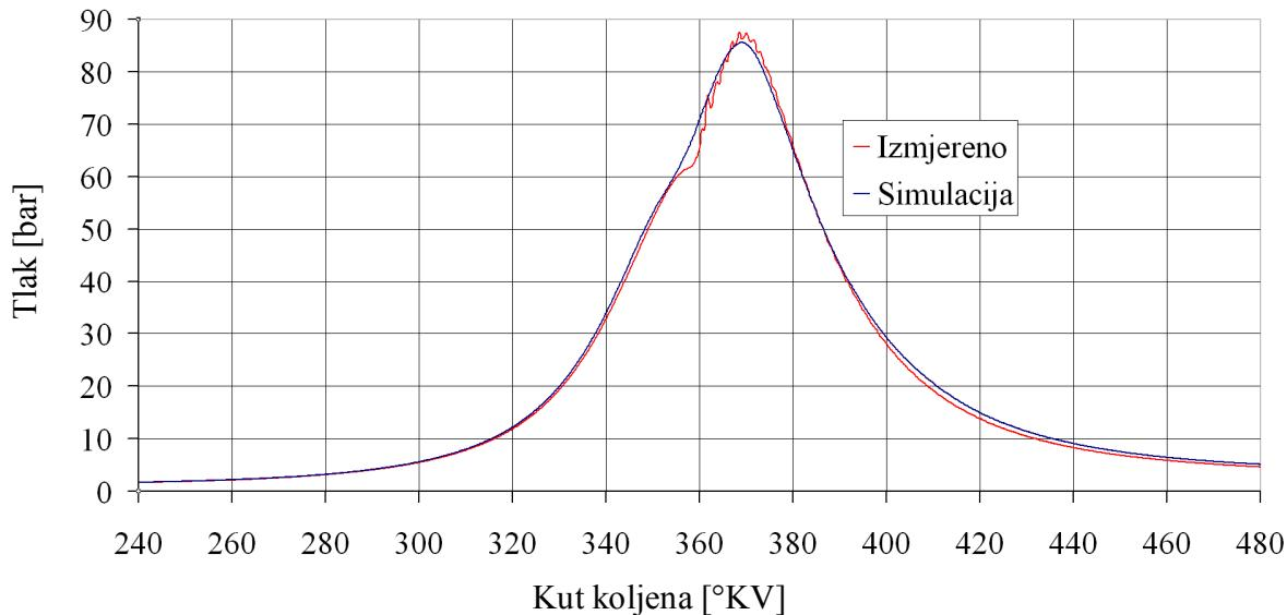
Slika 6.5. Usporedba izmjerenog i izračunatog tlaka u cilindru za mjernu točku D215HI15
