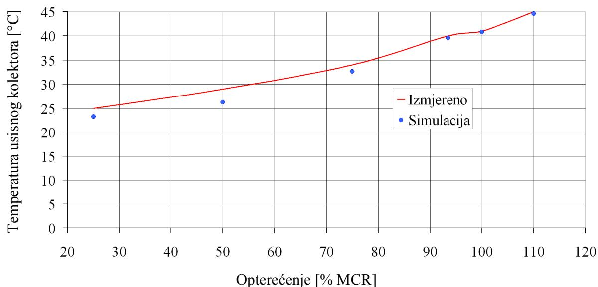
**Slika 9.4.** Usporedba izmjerene i simulirane temperature u usisnom kolektoru na motoru MAN 6S50MC
