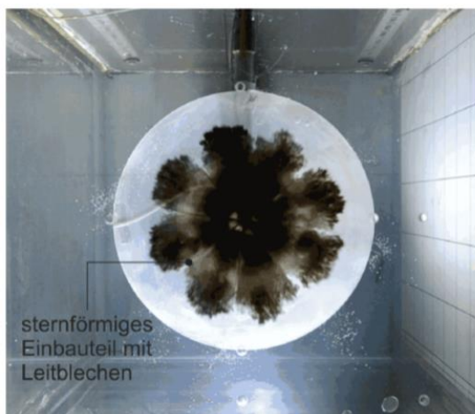
Slika 1.8. Utjecaj postavljanja uzdužnih pregrada na kvalitetu protoka u radialnom pločastom difuzoru [41]
