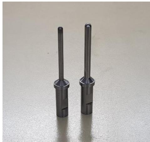
Slika 5.29 SPIF alati promjera 6 mm i 8 mm
