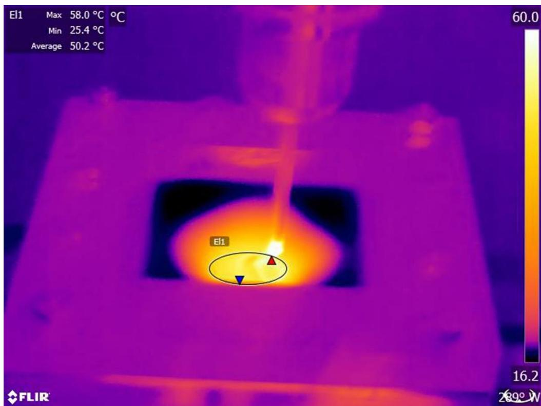
Slika 5.33 Maksimalna izmjerena temperatura za pokus broj 6 ( $d = 6 \text{ mm} / \text{PA12/Cloisite 93A-1\%} / \Delta z = 0,75 \text{ mm} / f = 2000 \text{ mm/min} / \omega = 1000 \text{ min}^{-1} / \psi = 40^\circ$ )
