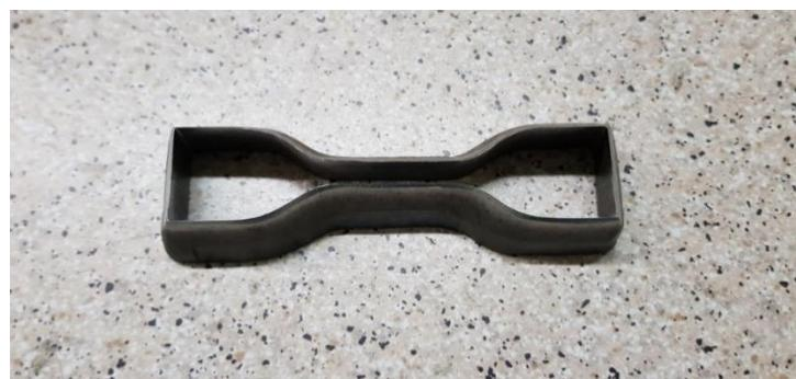
Slika 5.15 Alat za prosijecanje korišten prilikom pripreme uzoraka
