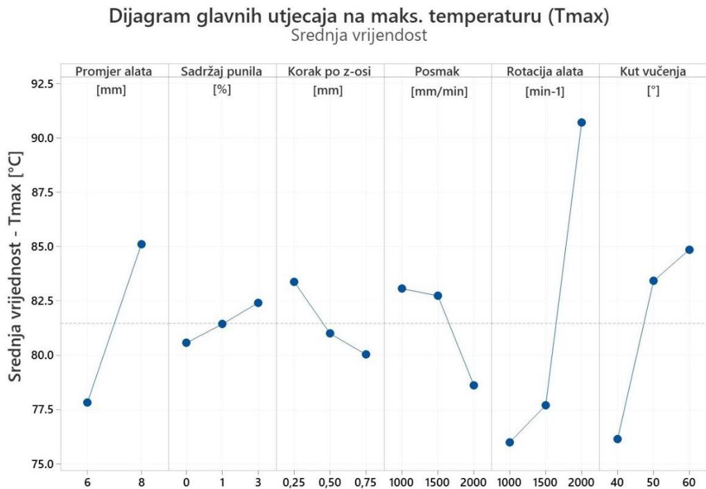
Slika 6.2 Dijagram glavnih utjecaja na temperaturu  $T_{\max}$ Tablica 6.3 Pregled optimalnih parametara sa stajališta najmanje temperature  $T_{\max}$
