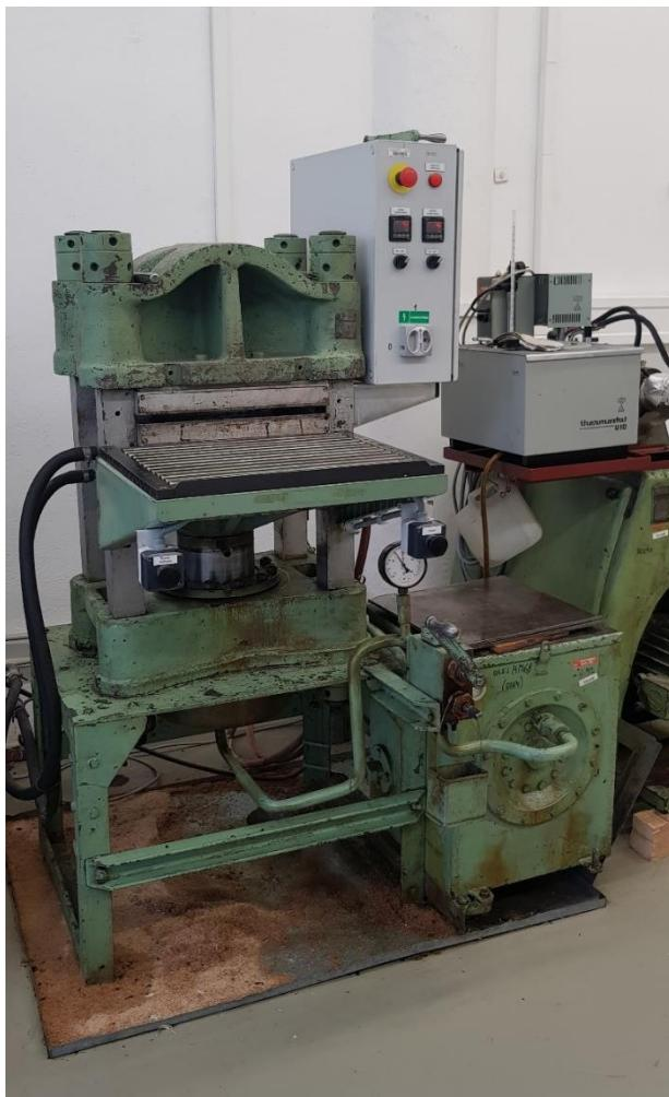
Slika 5.12 Hidraulička preša
