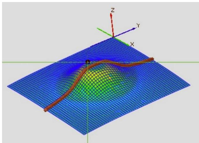
Slika 5.47 Prikaz presjeka duž koje su vršena mjerena deformacija
