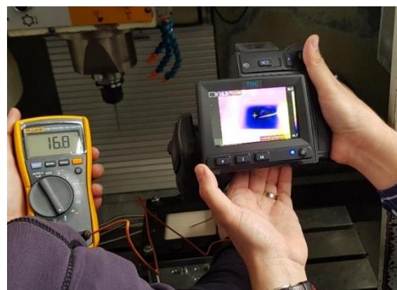
Slika 5.32 Kalibracija termokamere te određivanje faktora emisivnosti
