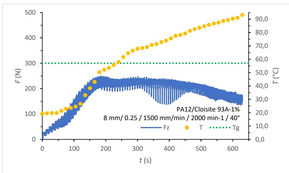
Slika 5.40 Dijagram ovisnosti sile  $F_z$  i temperature  $T$  o vremenu  $t$  za 13. pokus
