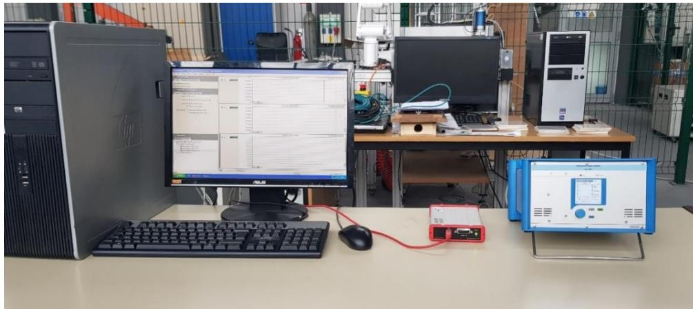
Slika 5.38 Prikaz dijela mjernog lanca prilikom mjerjenja sila (softver – akvizicijska kartica – pojačalo)
