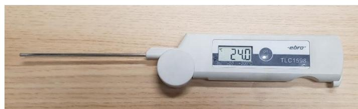
Slika 5.44 Kontaktni mjerač temperature korišten u eksperimentu
