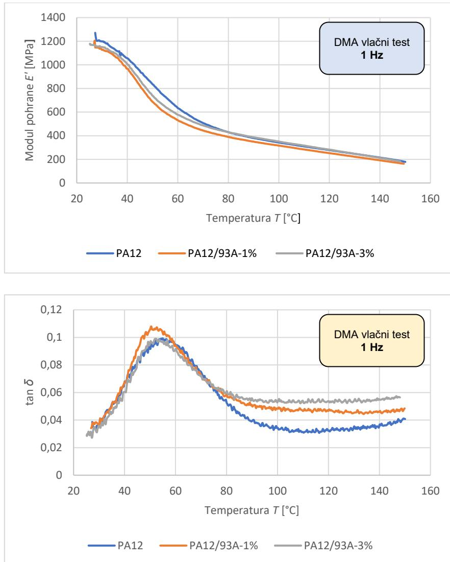
Slika 5.18 DMA - vlačni test 1 Hz: (gore) modul pohrane ( $E'$ ) u ovisnosti o temperaturi ( $T$ ) i (dolje)  $\tan \delta$  u ovisnosti o temperaturi ( $T$ ) [31]
