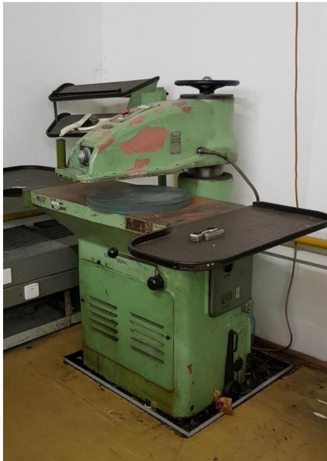
Slika 5.14 Hidraulička preša Svit za prosijecanje
