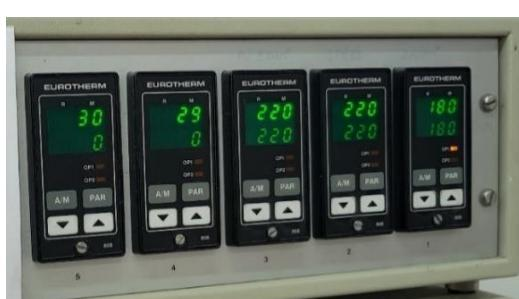
Slika 5.5. Prikaz radnih temperatura tijekom procesa ekstruzije
