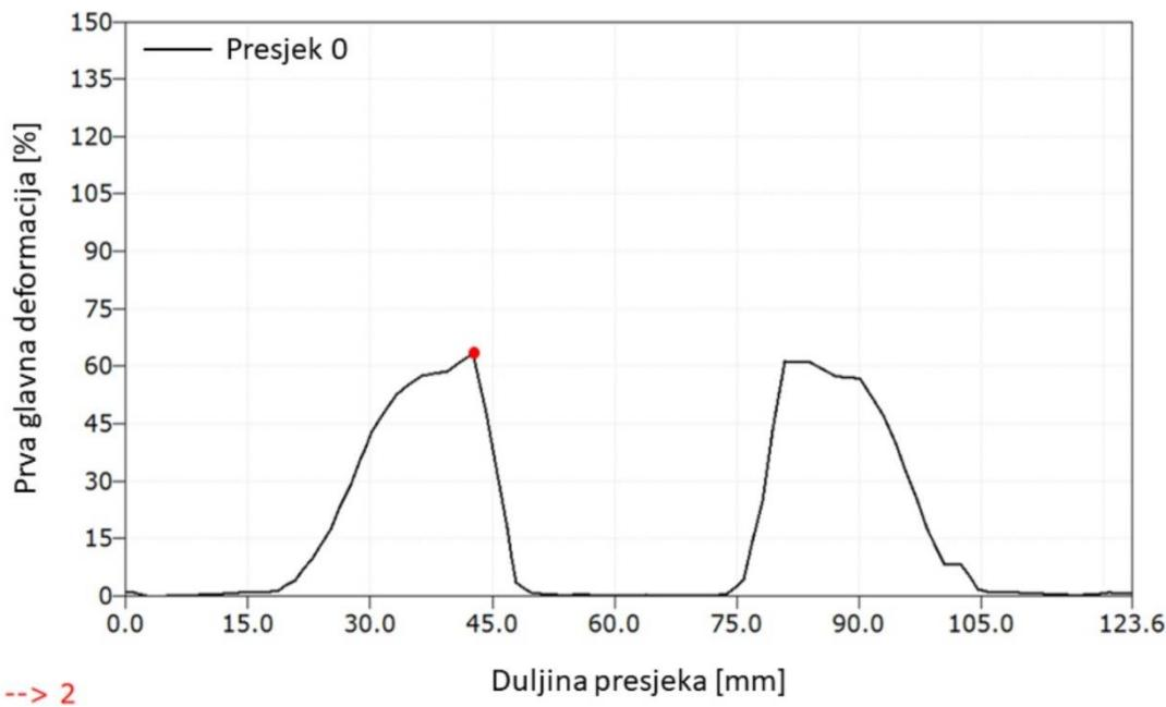
Slika 5.52 Prva glavna deformacija i duljina presjeka za 18. pokus – PA12/Cloisite 93A–3% – 50°
