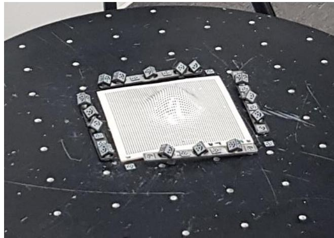
Slika 5.46 Prikaz mjerena deformiranog uzorka uz pomoć markera na rotacijskom stolu
