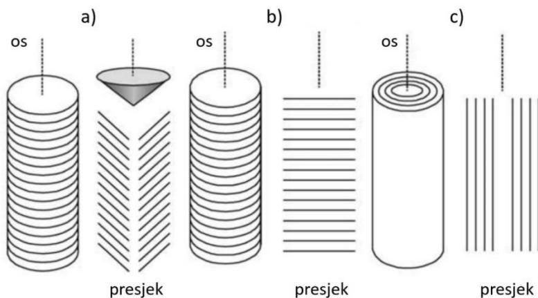
Slika 3.6 Prikaz tri tipa ugljikovih nanovlakana: a) riblja kost, b) igrače karte, c) paralelni ili cvjetasti tip [87] [98]
