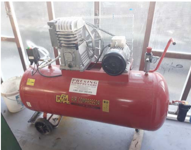
Slika 5.7. Klipni kompresor Presing B7000
