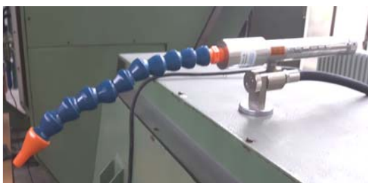
Slika 5.8. Protusmjerna vrtložna cijev Nex Flow™ Frigid-X Cooler System c/w 57025AD
