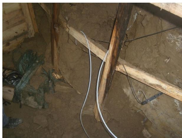
**Slika 5.15.** Urušeni pedološki profil s monitoring opremom.
