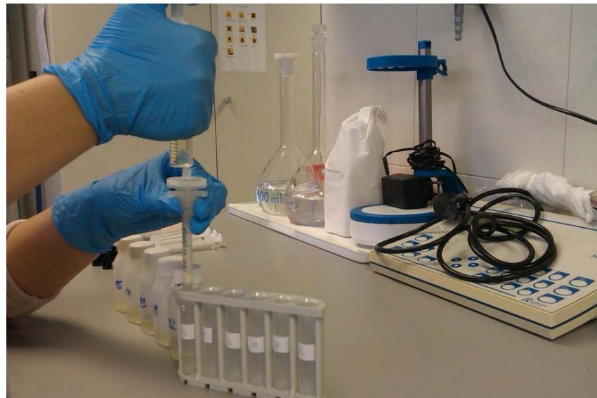
**Slika 5.21.** Filtriranje uzoraka vodene otopine tla kroz membranu.
