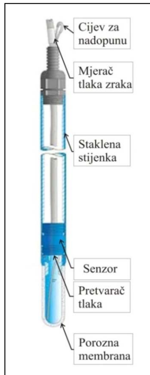
Slika 5.8. Tijelo tenziometra sa svim njegovim dijelovima.
