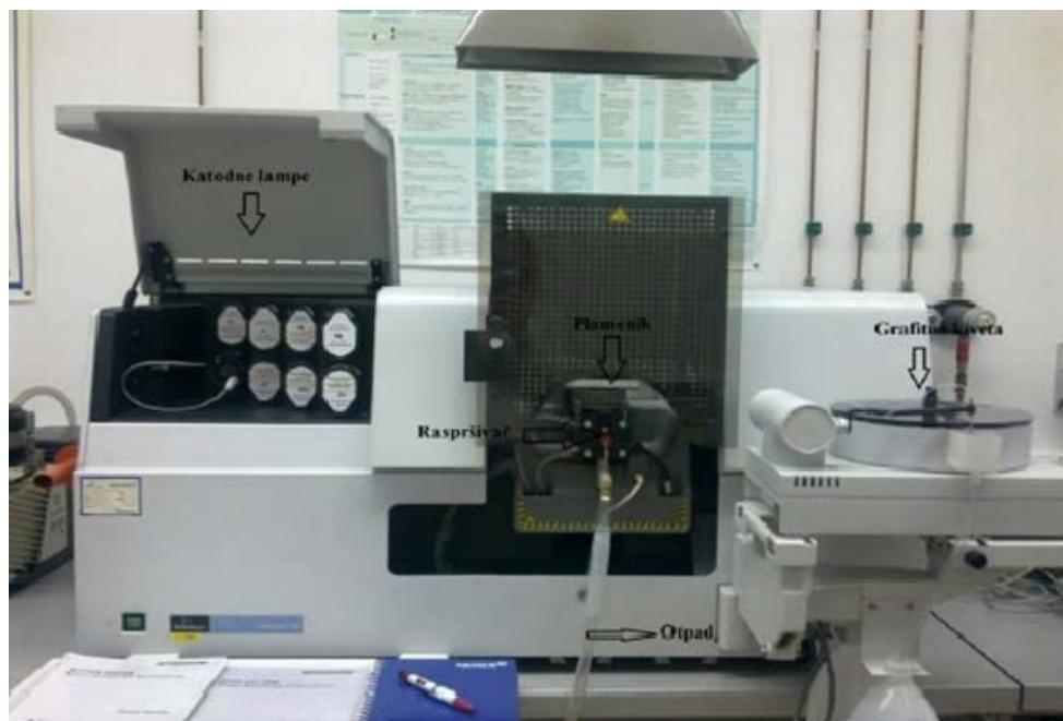
**Slika 5.19.** Atomski apsorpcijski spektrometar AAS 700 (foto: Prša, 2011).
