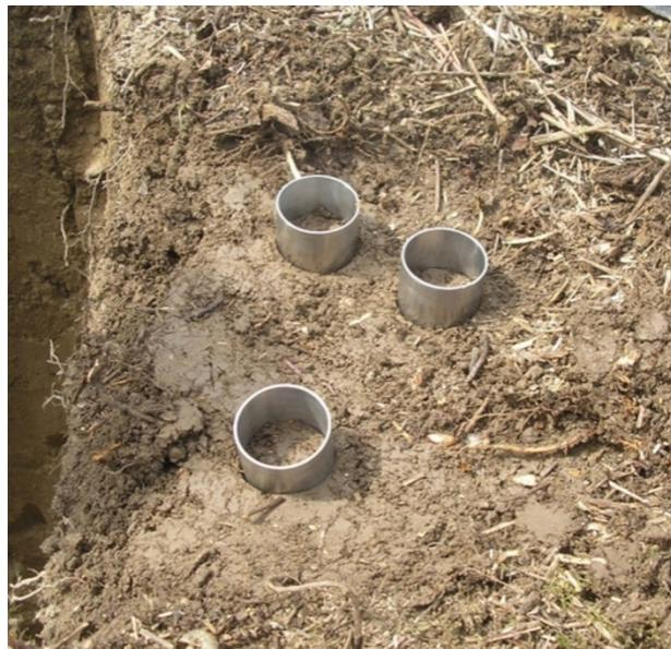
**Slika 5.5.** Cilindri za uzimanje neporušenih uzoraka tla.
