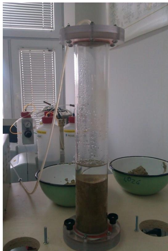
**Slika 5.17.** Saturacija uzorka s vodom.
