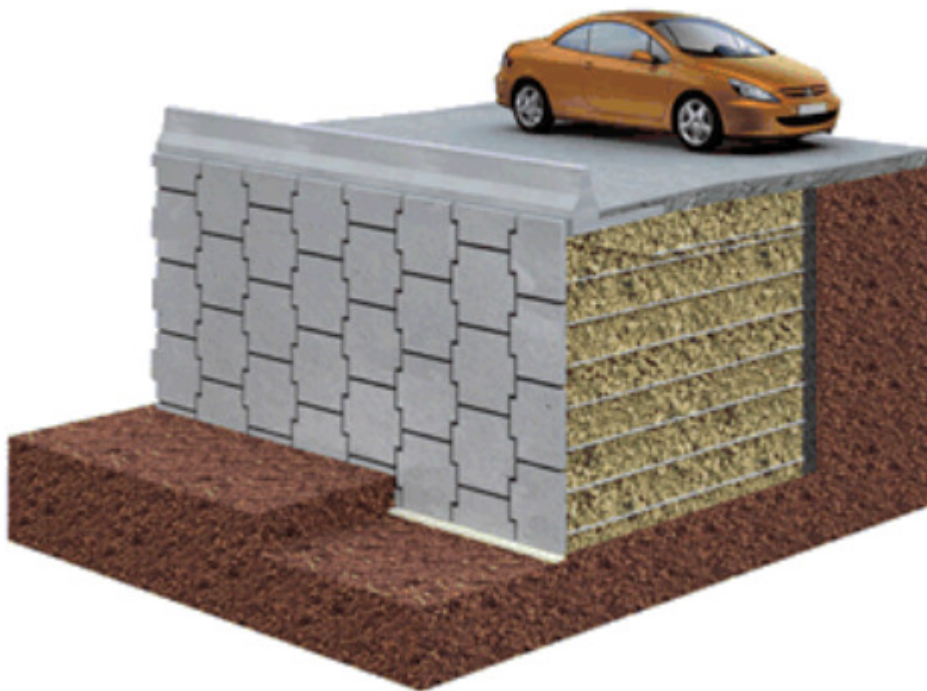
Slika 2-1 Glavni dijelovi konstrukcija od armiranog tla ( http://www.terre-armee.com/ta/wterrearmee_en.nsf )
