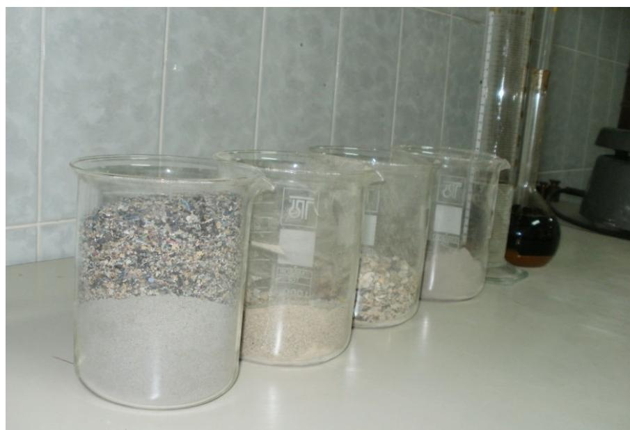
Slika 29. Sastojci betona pripremljeni za pripremu betonskih kocki
