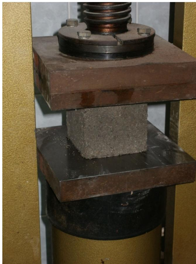
Slika 34. Ispitivanje tlačne čvrstoće u laboratorijskoj preši
