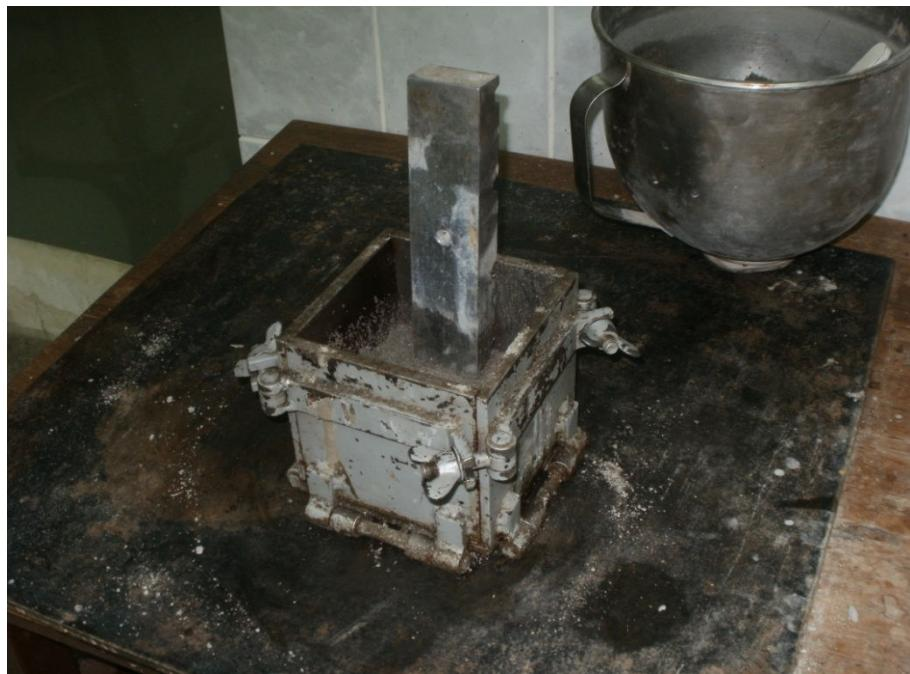
Slika 31. Ugradnja betona u kalup
