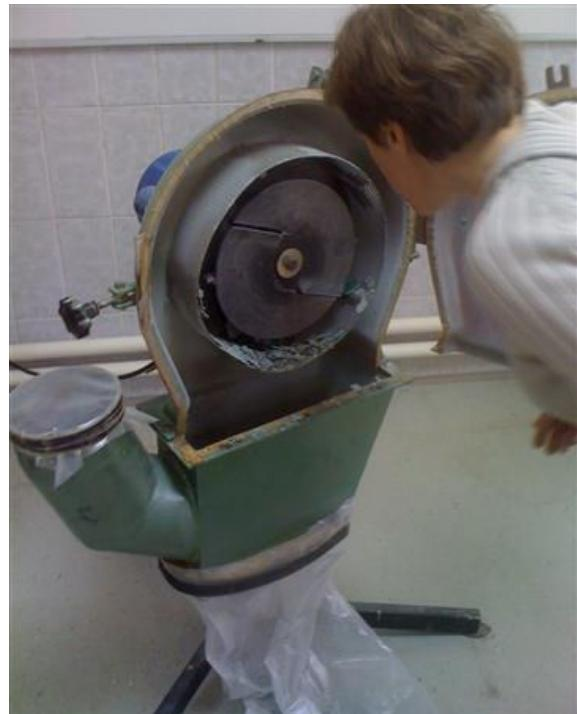
Slika 23. Mlin čekićar za II. stupanj usitnjavanja uzorka, Laboratorija za oplemenjivanje i
