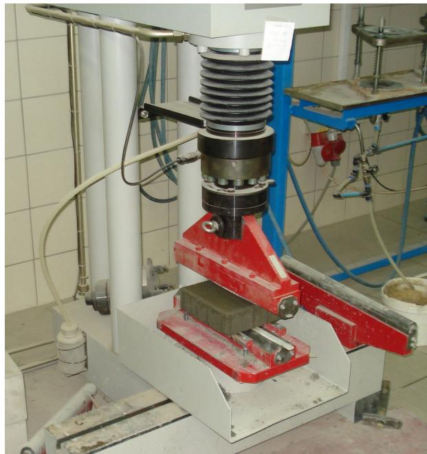
Slika 38. Ispitivanje vlačne čvrstoće cijepanjem, Zagorje Tehnobeton, d.d., pogon Varaždin
