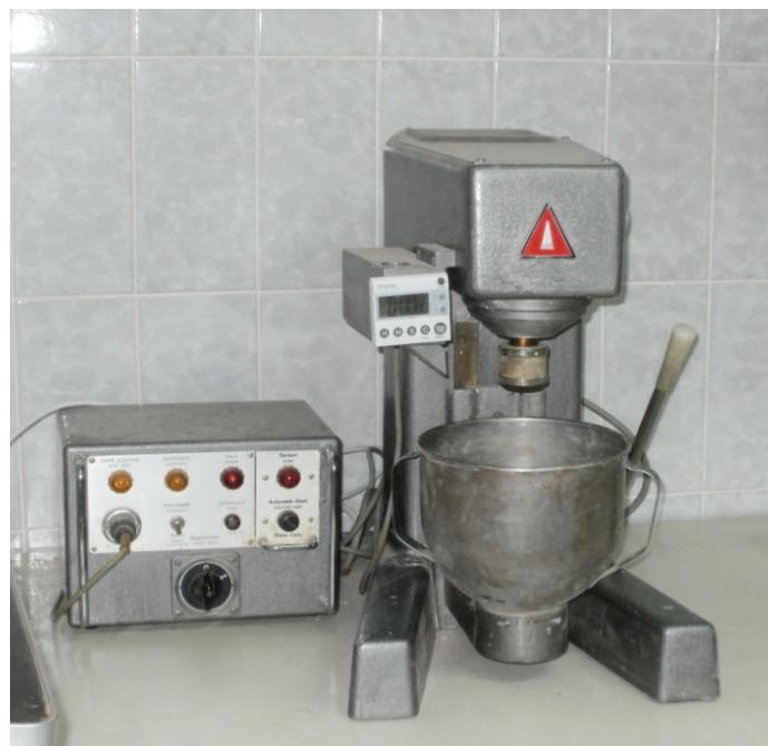
Slika 30. Mješalica za laboratorijsku pripremu betona
