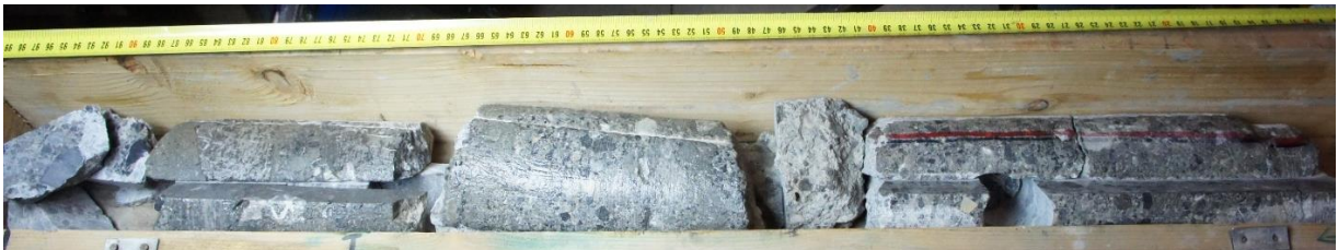
Slika 5.34: Kal-19 klastima potporni konglomerat iz J-1
