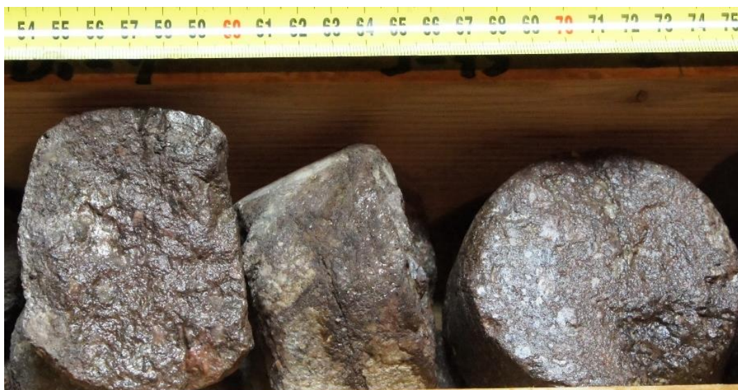
Slika 5.17: Di-1 J-15, polimiktni konglomerat s hematiziranim vezivom
