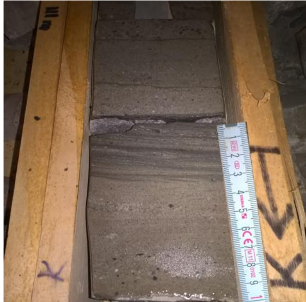
Slika 5.48: Okr- J-10 3.m, pješčenjak s pelitnim laminama
