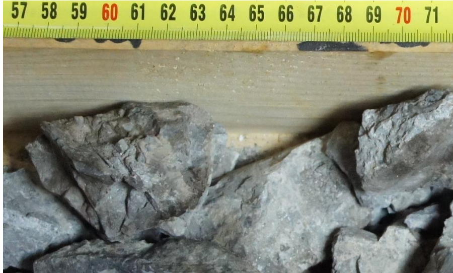
Slika 5.52: Mlj-1, fragmenti klastima potporne breče iz J-12
