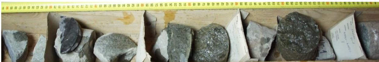
Slika 5.58: Or-1 ostaci fragmenata andezit-bazalta te lapora (vršni dio jezgre, na slici lijevo) iz J-10
