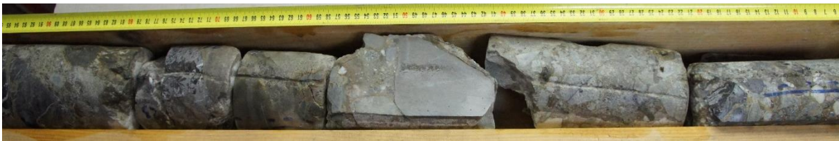
Slika 5.35: Kal-16 J-2, klastima potporni konglomerat iz 4.m
