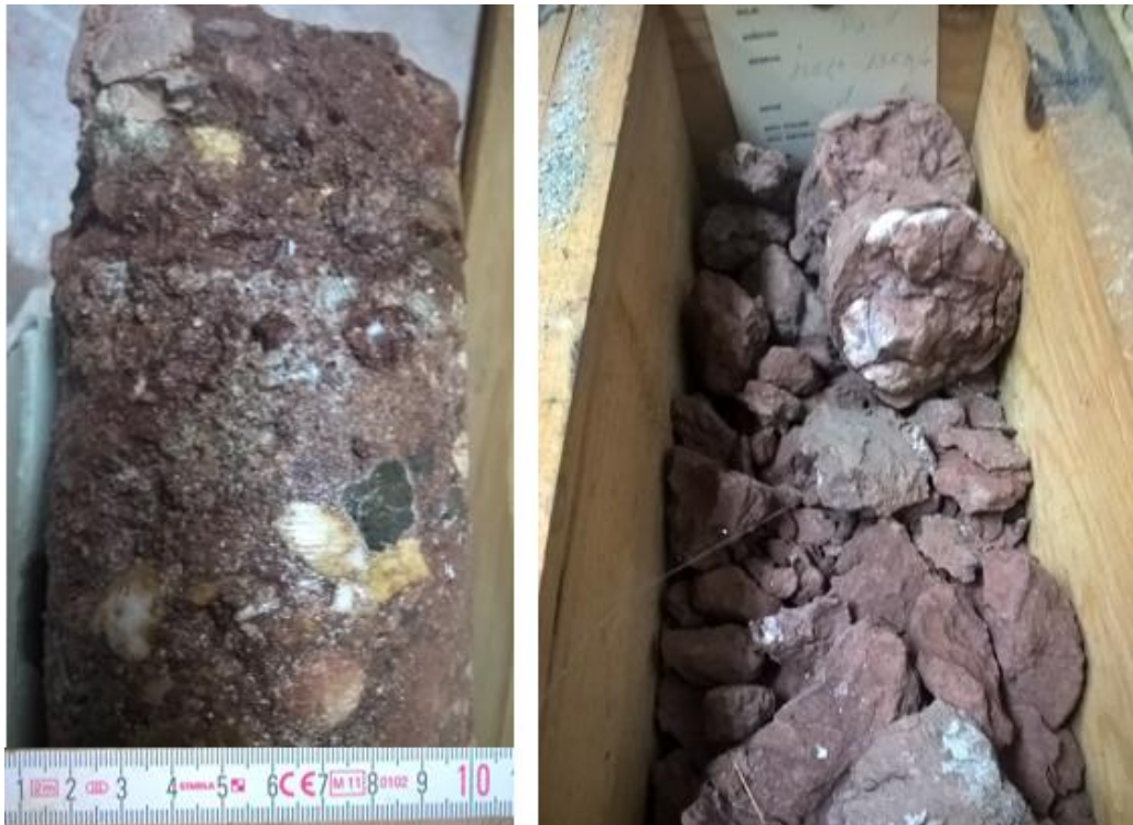
Slika 5.78: Pa-1, ostaci fragmenata matriksom potpornog konglomerata iz J-8 (lijevo) i fragmenata hematitiziranog pješčenjaka i konglomerata iz J-7 (desno)
