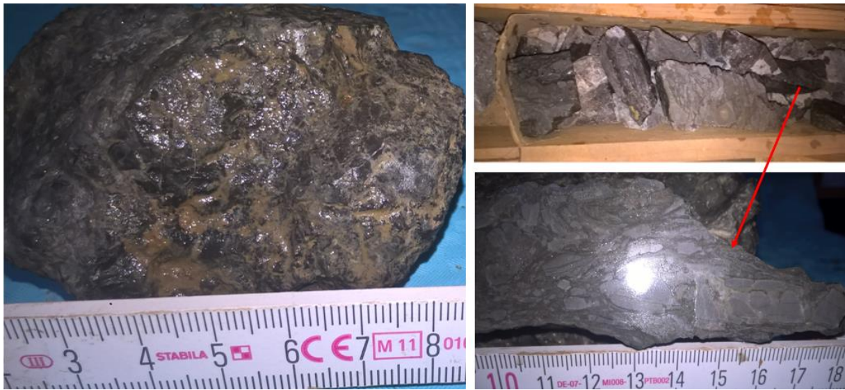
Slika 5.8: Mol-4 J-4, loše sortirana polimiktna breča; fragment fluidalne teksture (uvećani detalj dolje desno)
