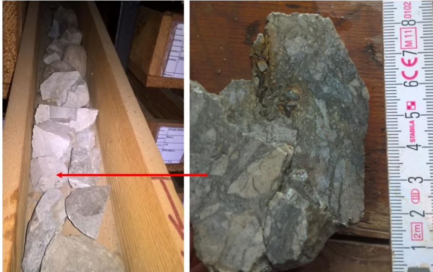
Slika 5.28: Kal-5, fragmenti matriksom do klastima potporne breče iz J-6 (lijevo) te uvećani detalj jednog od fragmenata s fluidalnom teksturom (desno)
