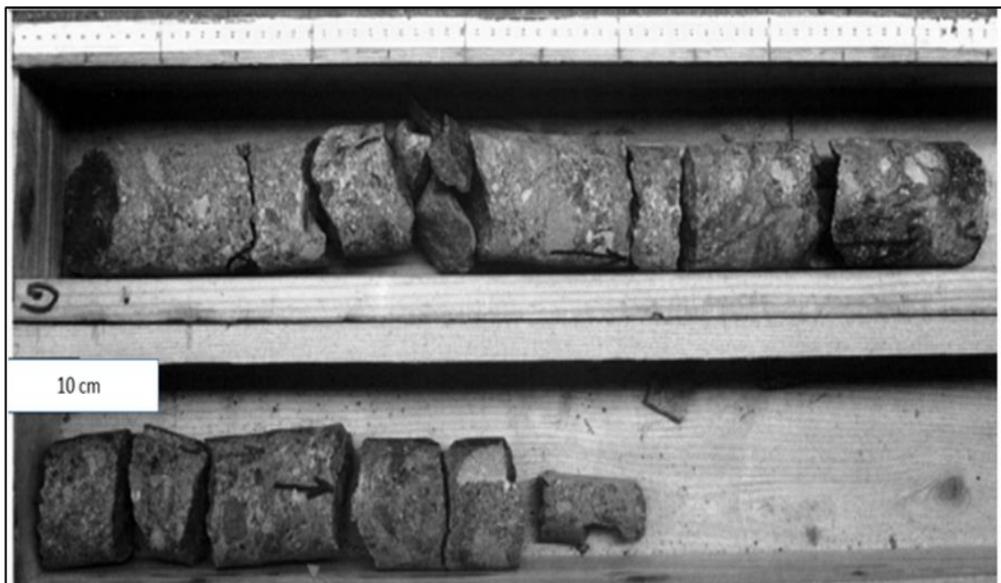
Slika 5.50: Lč-1A1 J-9, polimiktni, klastima potporan konglomerat
