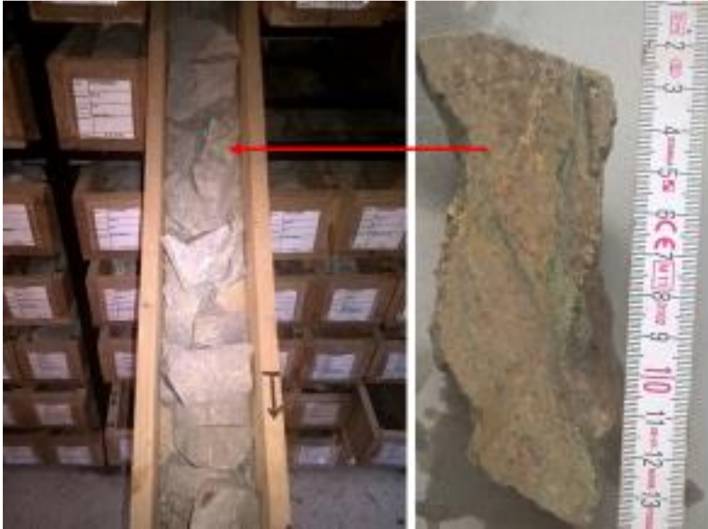
Slika 5.26: Kal-2 J-3, fragmenti tufa iz 2.m jezgre (lijevo) i uvećani detalj (desno)
