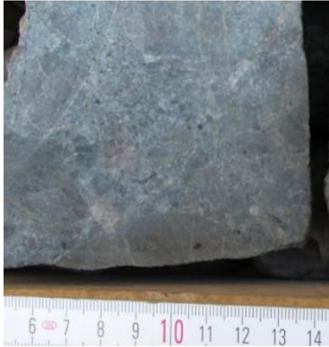
Slika 5.20: Di-1 J-8, polimiktne, klastični potporni konglomerat
