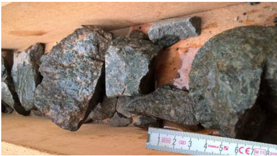
Slika 5.67: DB-1 fragmenti kristalolitoklastičnog tufa iz J-10
