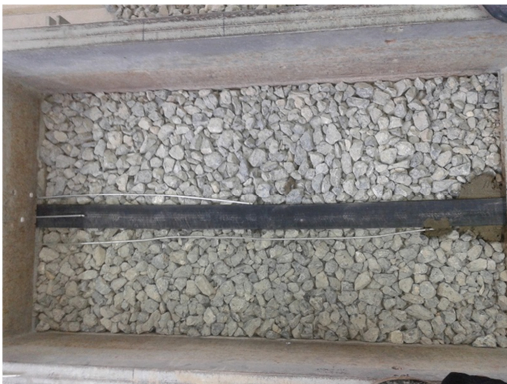
Slika 5-8 Postavljanje ekstenzometara na traku
