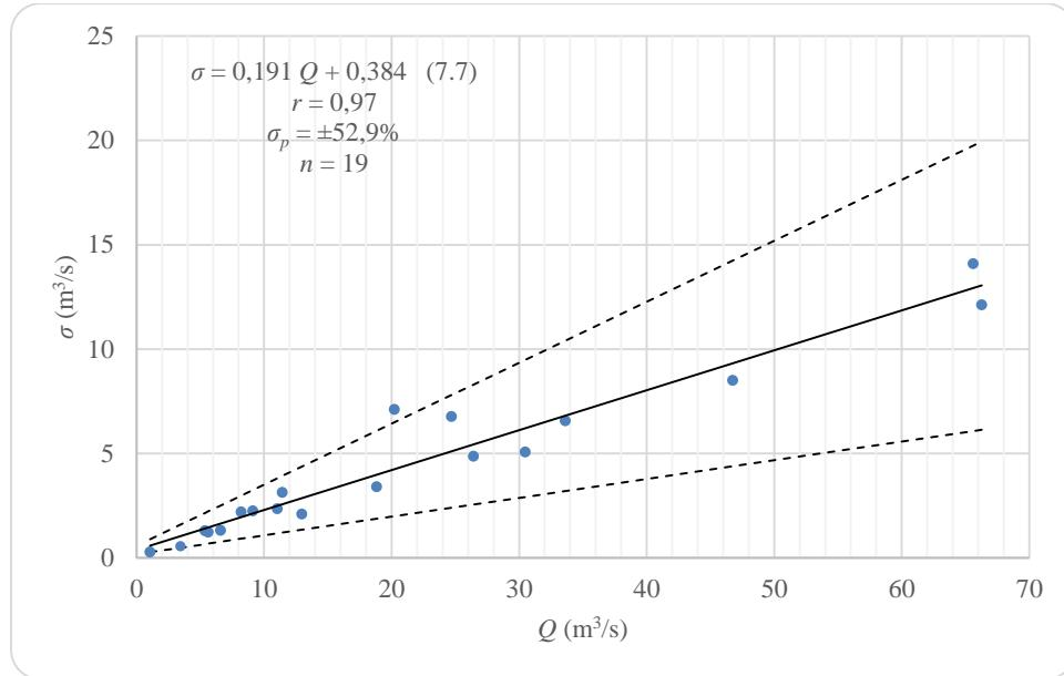
Slika 7.6 Linearna ovisnost standardne devijacije srednjih godišnjih protoka  $\sigma$  o srednjim godišnjim protocima  $Q$  s intervalom pouzdanosti  $\sigma_p$  izvedene s 19 podatka
