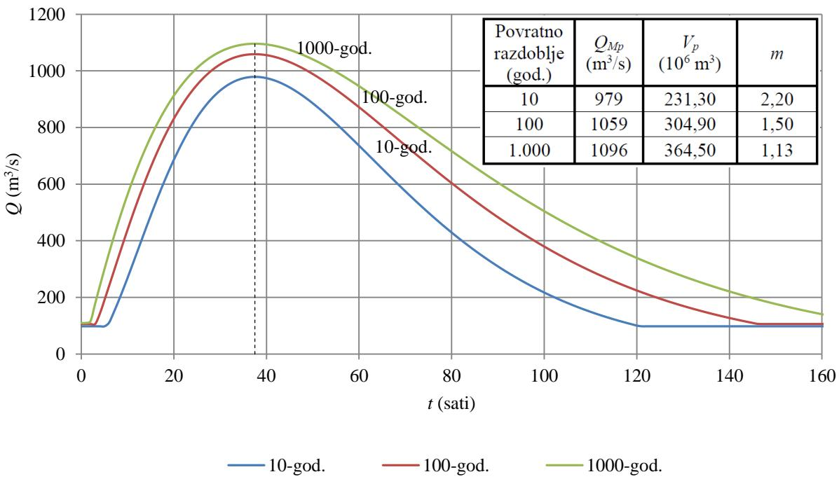
**Slika 7.23** Vodni valovi 10-, 100- i 1000-godišnjeg povratnog razdoblja na profilu Metlika na rijeci Kupi.
