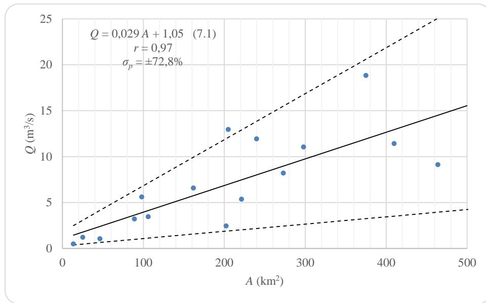
**Slika 7.3** Linearna ovisnost srednjih godišnjih protoka  $Q$  o površini slivova  $A$  s intervalom pouzdanosti  $\sigma_p$  u području slivnih površina do  $A = 500$  km $^2$
