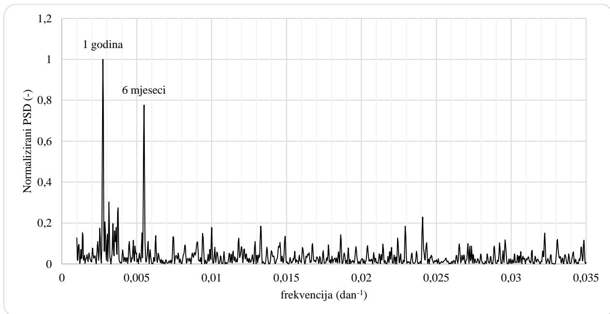
**Slika 9.1** Normalizirana gustoća snage spektra srednjih dnevnih protoka  $Q$  na stanicu Zamost 2 na Čabranki u razdoblju (1951.-1980.)
