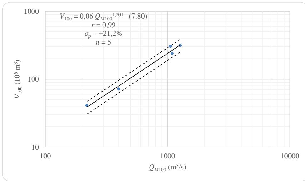
**Slika 7.19** Nelinearna ovisnost volumena vodnih valova 100-godišnjeg povratnog razdoblja  $V_{100}$  o maksimalnim godišnjim protocima 100-godišnjeg povratnog razdoblja  $Q_{M100}$  s intervalom pouzdanosti  $\sigma_p$  izvedena za Kupu
