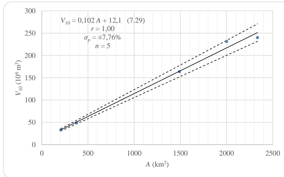
**Slika 7.14** Linearna ovisnost volumena vodnih valova 10-godišnjeg povratnog razdoblja  $V_{10}$  o veličinama sliva  $A$  s intervalom pouzdanosti  $\sigma_p$  na profilima rijeke Kupe bez profila pritoka
