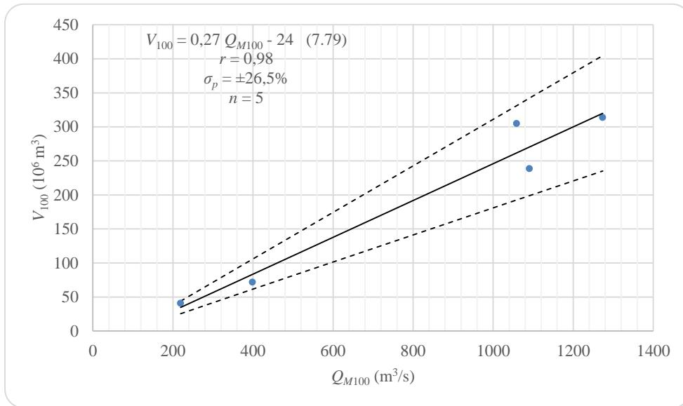
**Slika 7.18** Linearna ovisnost volumena vodnih valova 100-godišnjeg povratnog razdoblja  $V_{100}$  o maksimalnim godišnjim protocima 100-godišnjeg povratnog razdoblja  $Q_{M100}$  s intervalom pouzdanosti  $\sigma_p$  izvedena za Kupu
