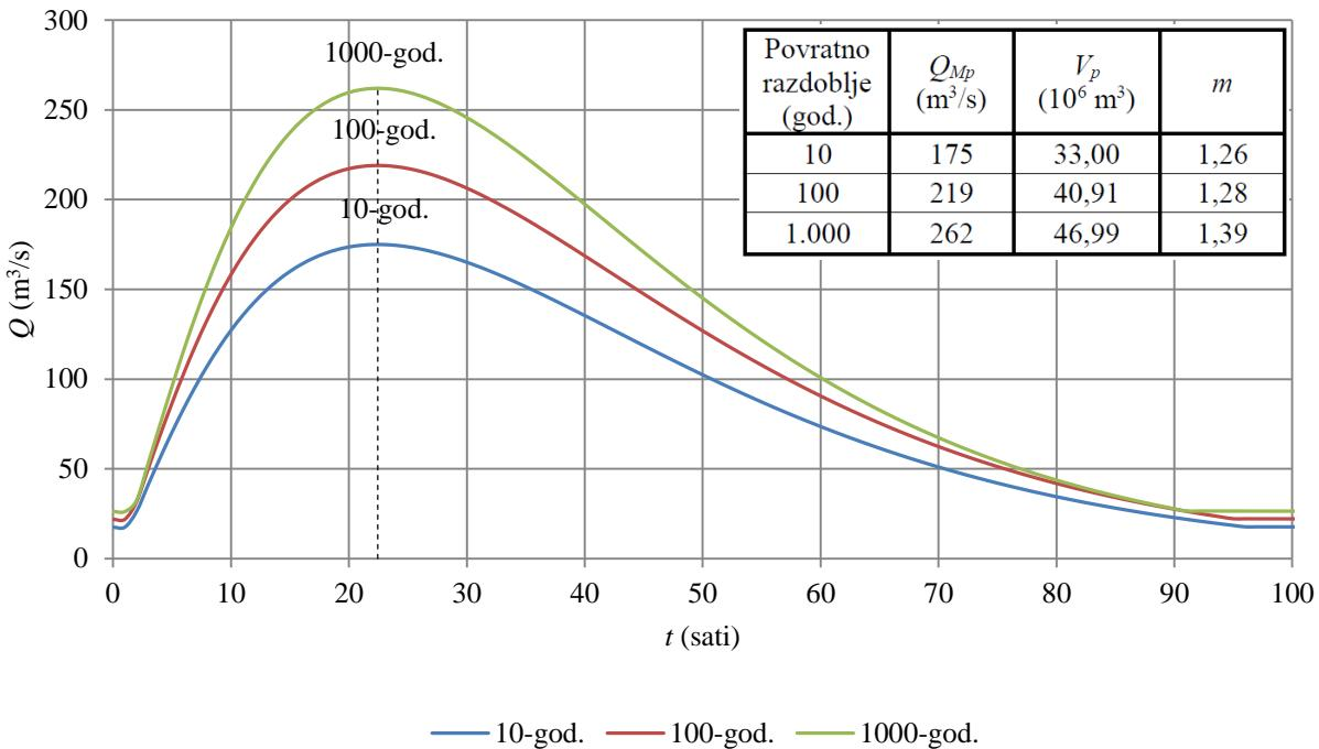
**Slika 7.20** Vodni valovi 10-, 100- i 1000-godišnjeg povratnog razdoblja na profilu Kupari na rijeci Kupi.
