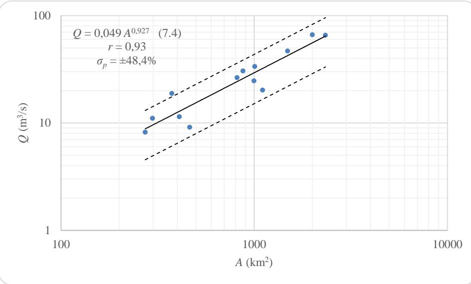
**Slika 7.5** Nelinearna ovisnost srednjih godišnjih protoka  $Q$  o površini slivova  $A$  s intervalom pouzdanosti  $\sigma_p$  izvedene s 13 podataka za slivove  $A > 250 \text{ km}^2$
