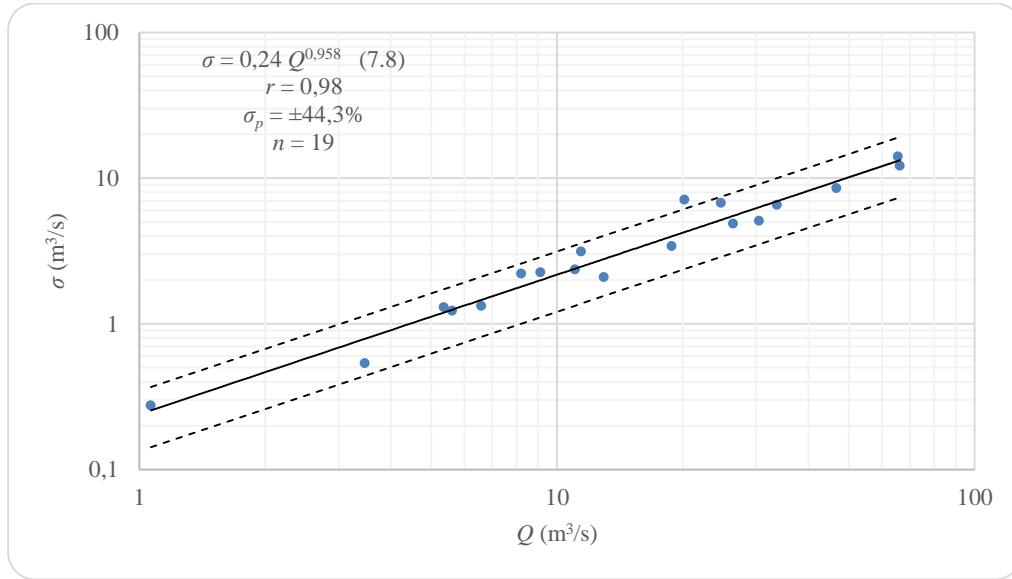
Slika 7.7 Nelinearna ovisnost standardne devijacije srednjih godišnjih protoka  $\sigma$  o srednjim godišnjim protocima  $Q$  s intervalom pouzdanosti  $\sigma_p$  izvedene s 19 podatka
