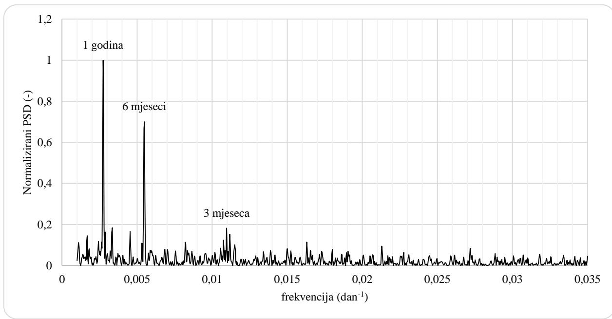
**Slika 9.2** Normalizirana gustoća snage spektra srednjih dnevnih protoka  $Q$  na stanicu Zamost 2 na Čabranki u razdoblju (1981.-2012.)
