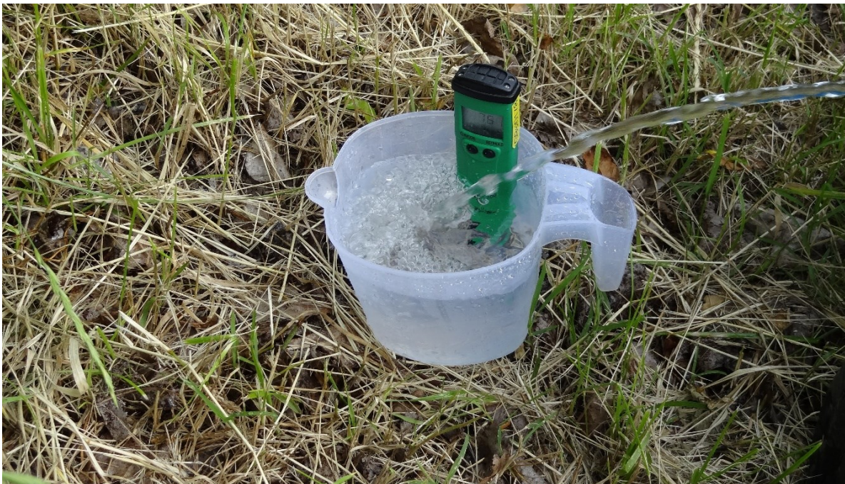
Slika 4.22. Mjerenje pH prije uzorkovanja na piezometru Mm-325
