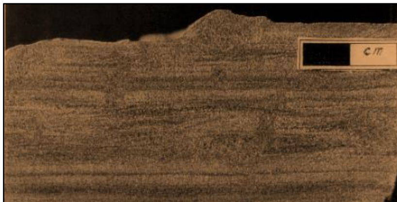
Slika 5.74: muljnjak do siltit u izmjeni sa sitnozrnastim litoarenitom, laminacija i bioturbacije, Ant-1, J-3, 3.m
