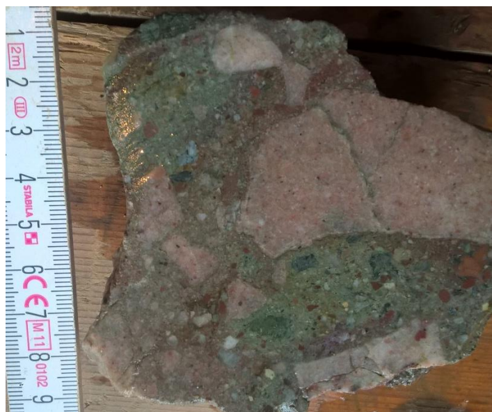
Slika 5.29: Kal-5 J-5, fragment matriksom potpornog konglomerata iz 1.m jezgre
