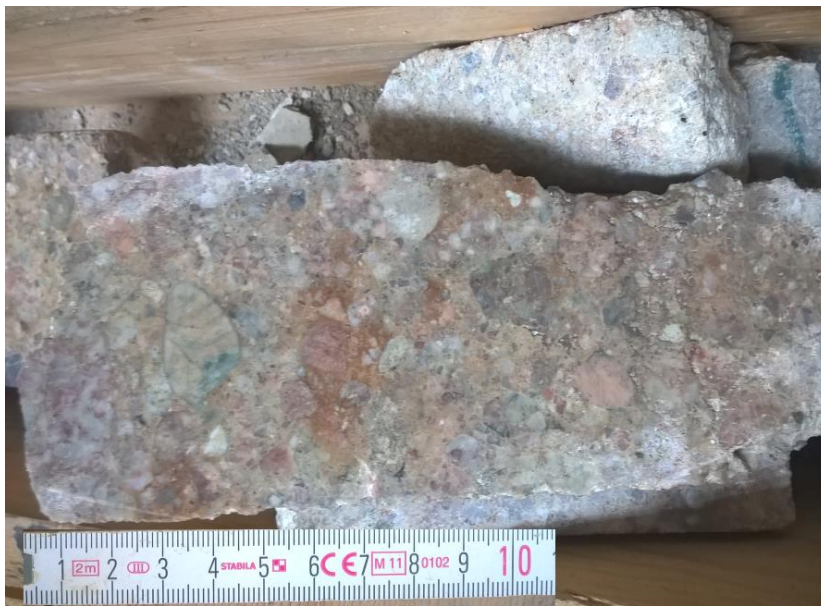
Slika 5.80: Grd-1 J-3, fragmenti klastima potpornog polimiktnog konglomerata iz 1. m jezgre
