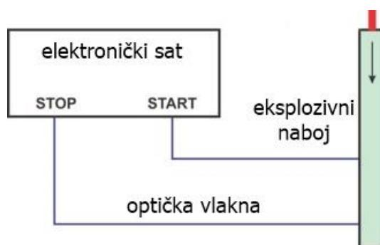
Slika 34. Shematski prikaz principa određivanja brzine detonacije
