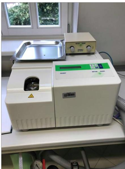
Slika 32. Diferencijski pretražni kalorimetar, Mettler Toledo DSC 823e
