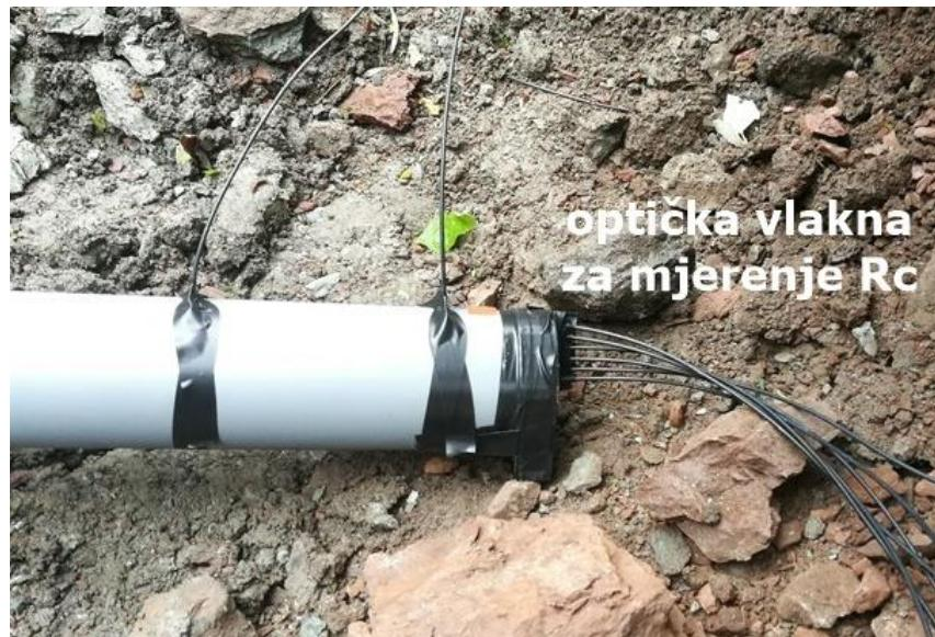
*Slika 49. Primjer postava za određivanje radijusa zakrivljenosti fronte detonacijskog vala u terenskim uvjetima*
