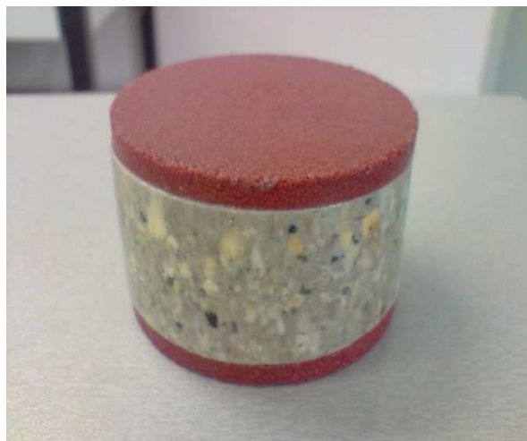
Slika 4-2 Uzorak pripremljen za ugradnju u troosnu ćeliju
