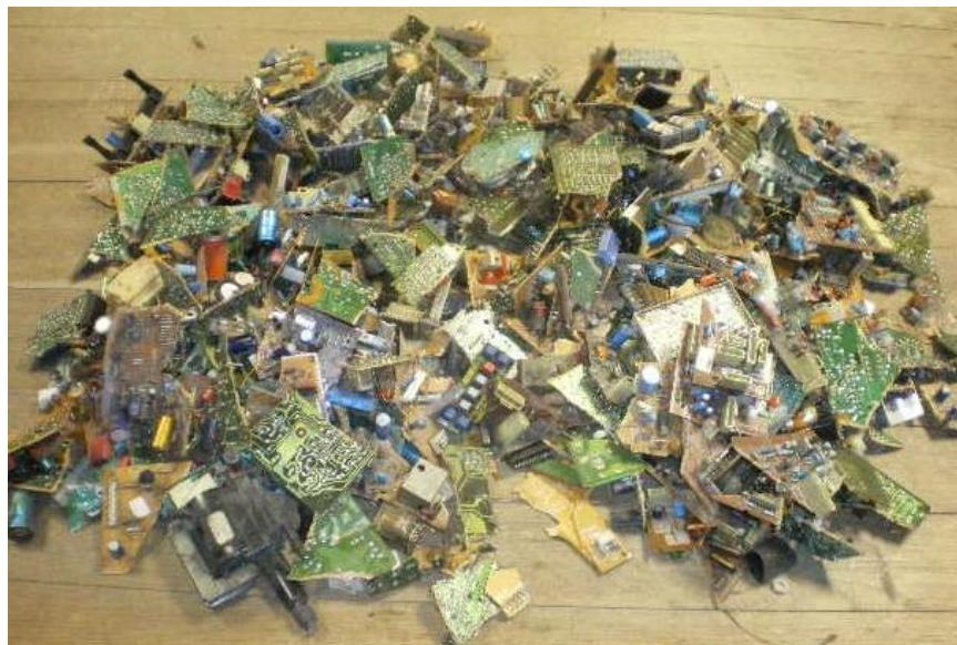
Slika 4 – 180 Tiskane pločice iz televizijskog aparata
