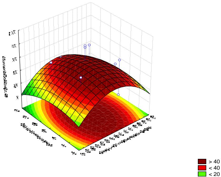
Slika 4 – 165 Regresijska ploha ovisnosti masenog iskorištenja klase 1/0,5 mm o naponu na elektrodi i brzini okretanja bubenja – grupa „OSKKŽ“
