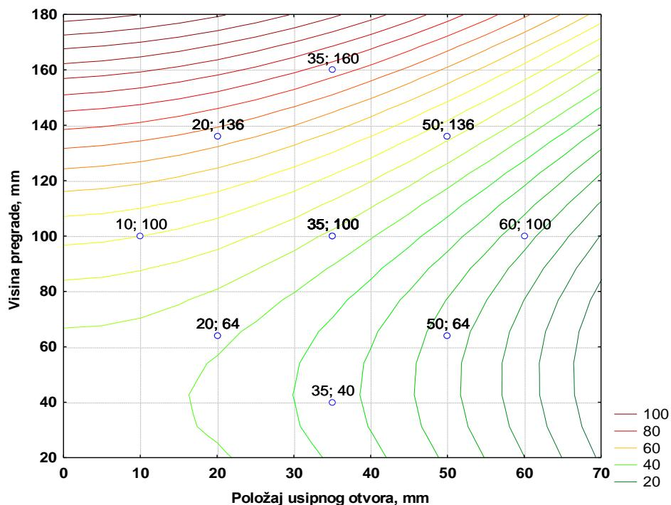
Slika 4 – 39 Nivo-linije regresijske plohe ovisnosti masenog iskorištenja klase 3,15/2 mm o visini pregrade i položaju usipnog otvora – grupa „Z“
