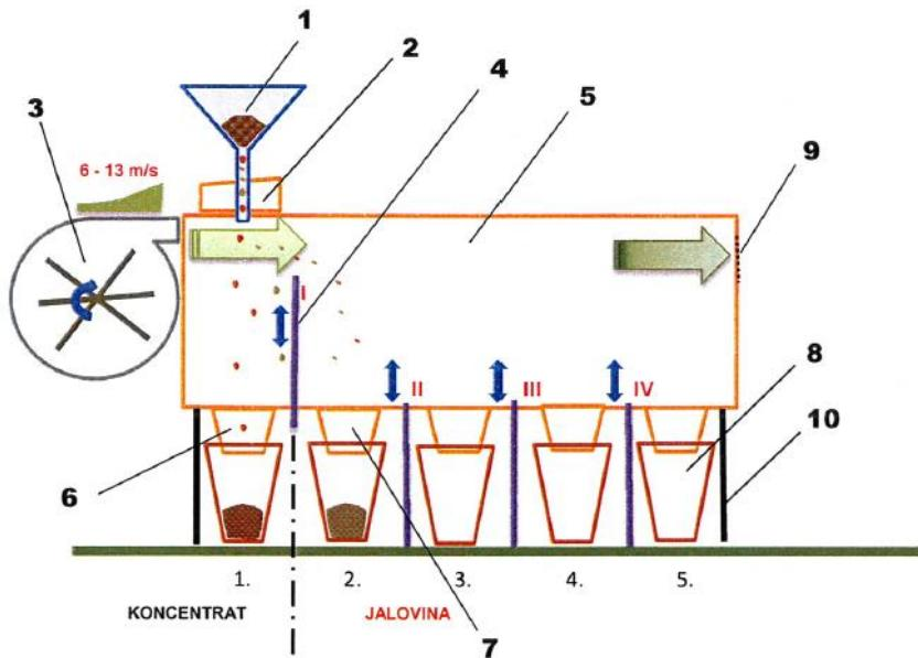
Slika 4 – 14 Shematski prikaz laboratorijskog zračnog separatora
