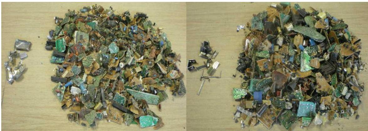
Slika 4 – 182 Ručnim probiranjem izdvojeni limovi i pojedini veći komadi metala koji se izdvajaju iz dalnjih postupaka sitnjenja
