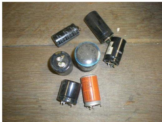
Slika 4 – 241 Elektrolitski kondenzatori  $\varnothing + 25$  mm i visine  $+ 25$  mm
