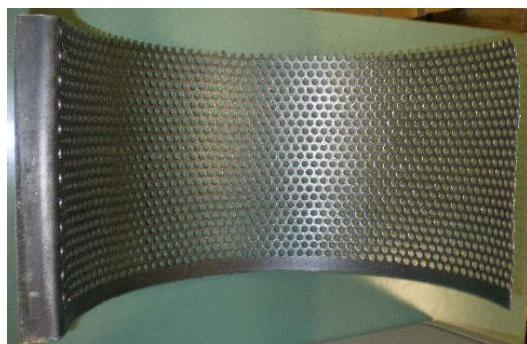
Slika 4 – 7 Rešetka s veličinom otvora  $\varnothing$  5 mm
