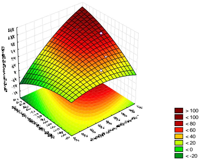
Slika 4 - 167 Regresijska ploha ovisnosti kvalitete koncentrata klase -0,5 mm o brzini okretanja bubenja i položaju separacijskog noža – grupa „OSKKŽ“
