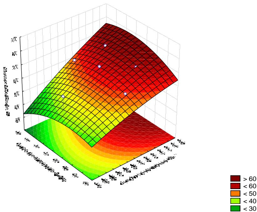
Slika 4 – 218 Regresijska ploha ovisnosti masenog iskorištenja klase 2/1 mm o brzini okretanja bubenja i položaju separacijskog noža – grupa „TP“
