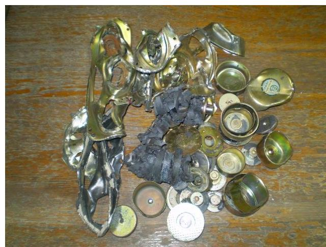
Slika 4 – 28 Ručno izdvojeno željezo nakon primarno sitnjenja u udarnoj drobilici
