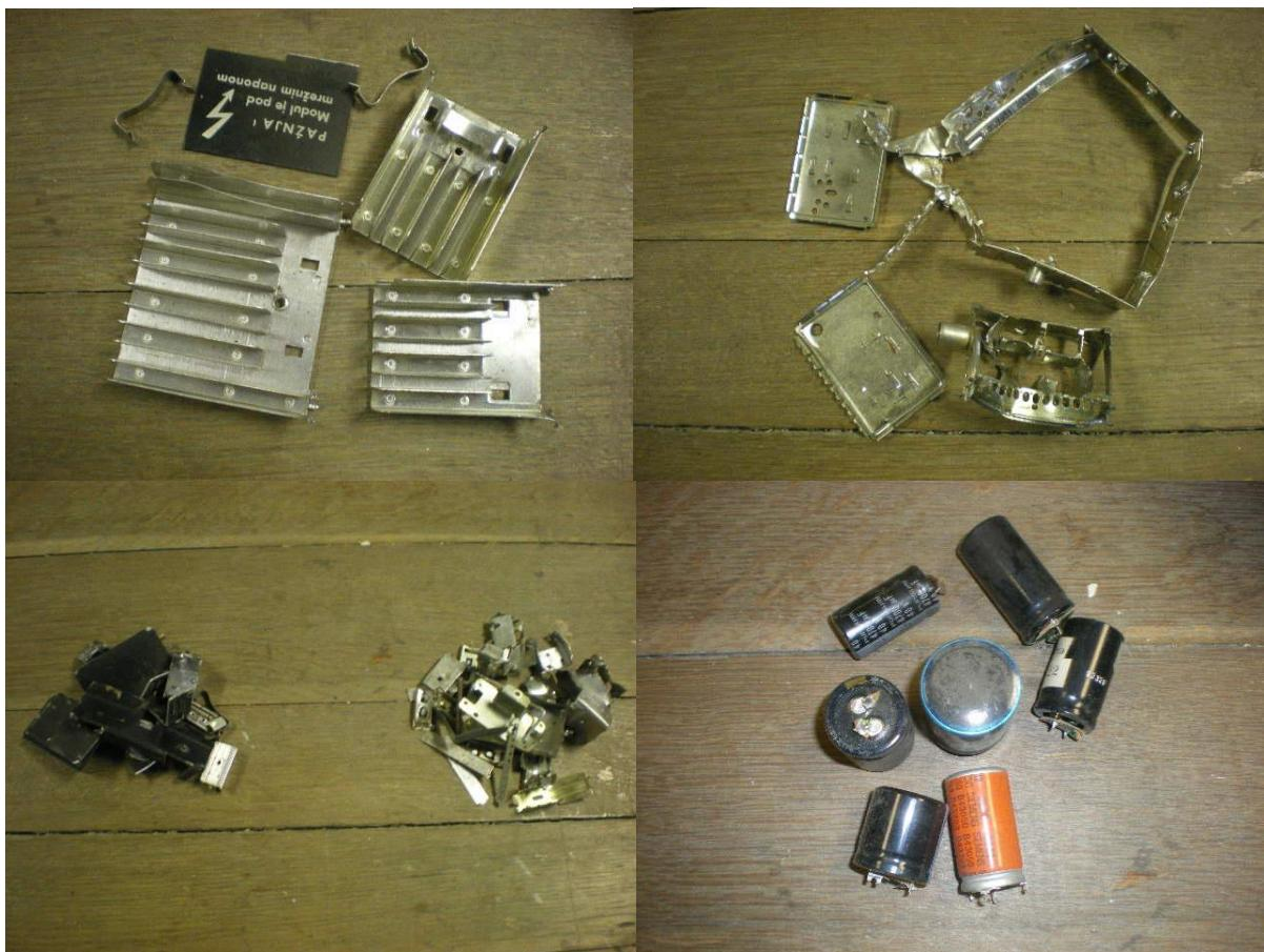
Slika 4 – 183 Materijali odvojeni nakon primarnog sitnjenja u udarnoj drobilici – željezo, aluminij i kondenzatori klase + 25 mm
