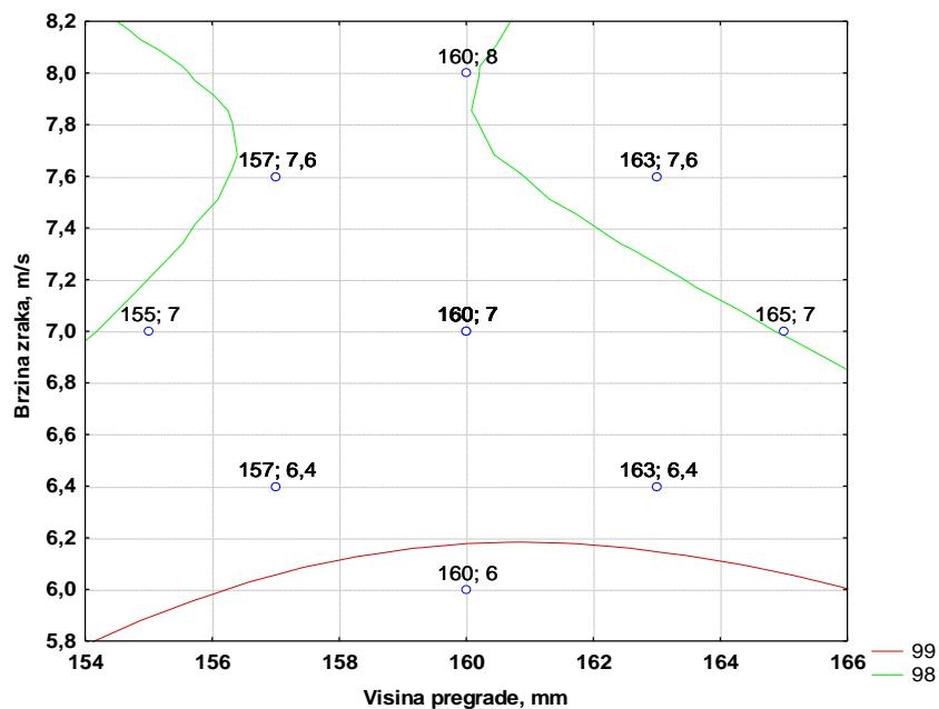
Slika 4 – 207 Nivo-linije regresijske plohe ovisnosti masenog iskorištenja klase 1/0,5 mm o brzini zraka i visini pregrade – grupa „TP“
