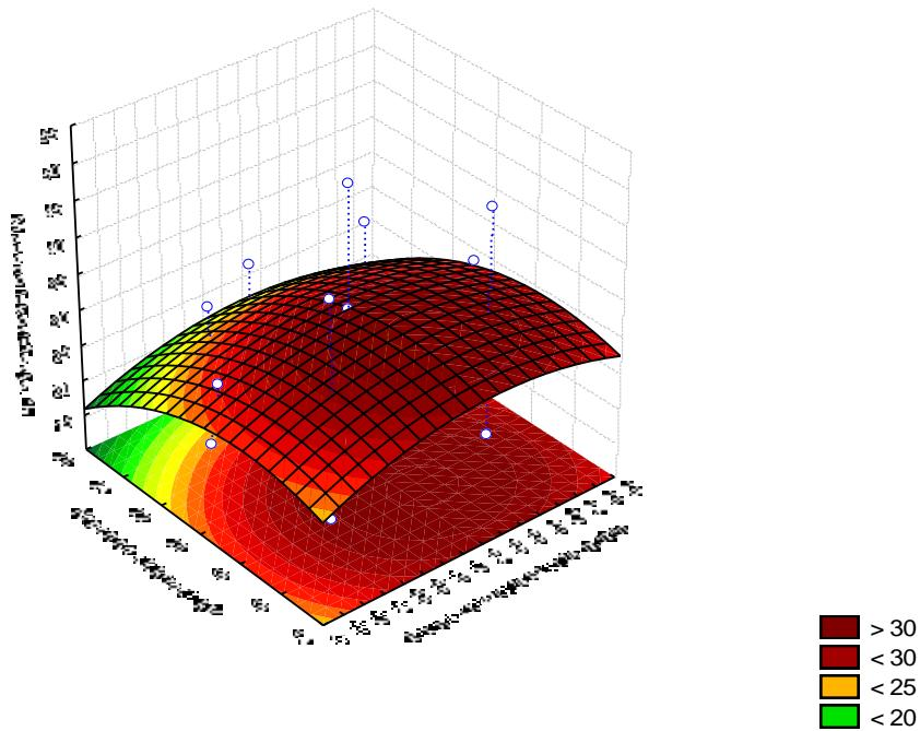
Slika 4 – 151 Regresijska ploha ovisnosti masenog iskorištenja klase 2/1 mm o naponu na elektrodi i brzini okretanja bubenja – grupa „OSKKŽ“
