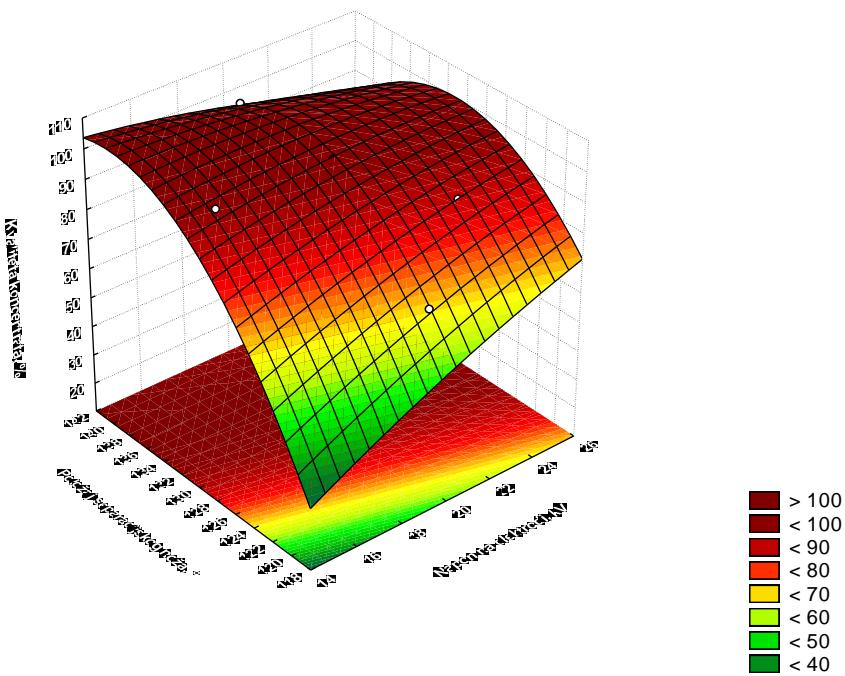
Slika 4 – 226 Regresijska ploha ovisnosti kvalitete koncentrata klase 1/0,5 mm o položaju separacijskog noža i napona na elektrodi – grupa „TP“
