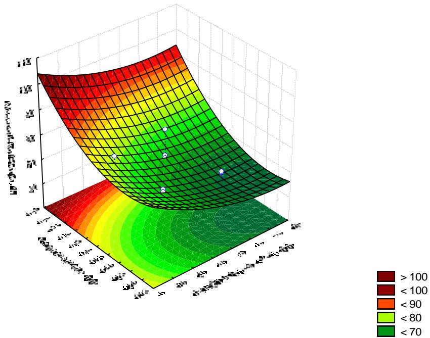
Slika 4 – 127 Regresijska ploha ovisnosti masenog iskorištenja klase -0,5 mm o visini pregrade i položaju usipnog otvora – grupa „OSKKŽ“
