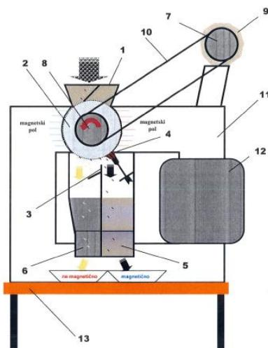
Slika 4 – 16 Shematski prikaz visokointenzivnog suhog magnetskog separatora
