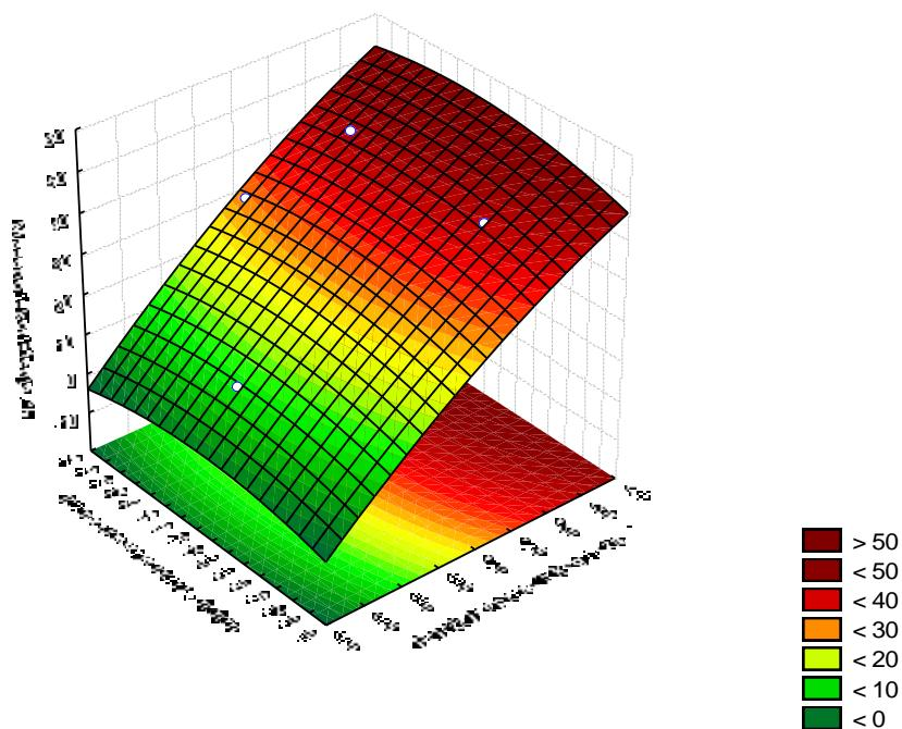
Slika 4 – 149 Regresijska ploha ovisnosti masenog iskorištenja klase 2/1 mm o brzini okretanja bubenja i položaju separacijskog noža – grupa „OSKKŽ“
