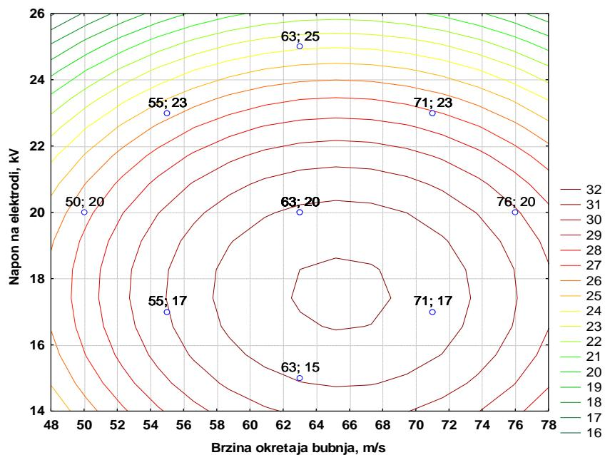
Slika 4 – 152 Nivo-linije regresijske plohe ovisnosti masenog iskorištenja klase 2/1 mm o naponu na elektrodi i brzini okretanja bubenja – grupa „OSKKŽ“
