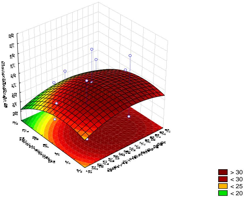
Slika 4 - 177 Regresijska ploha ovisnosti masenog iskorištenja klase -0,5 mm o naponu na elektrodi i brzini okretanja bubenja – grupa „OSKKŽ“
