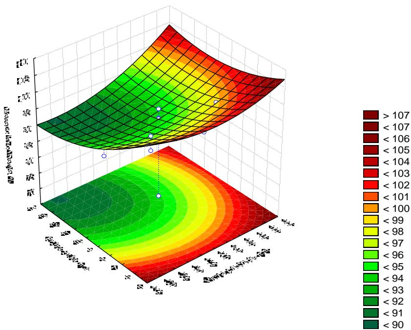
Slika 4 – 113 Regresijska ploha ovisnosti masenog iskorištenja klase 1/0,5 mm o brzini zraka i visini pregrade – grupa „OSKKŽ“
