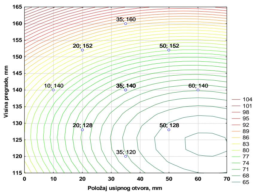
Slika 4 – 128 Nivo-linije regresijske plohe ovisnosti masenog iskorištenja klase -0,5 mm o visini pregrade i položaju usipnog otvora – grupa „OSKKŽ“
