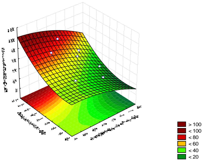
Slika 4 – 38 Regresijska ploha ovisnosti masenog iskorištenja klase 3,15/2 mm o visini pregrade i položaju usipnog otvora – grupa „Z“
