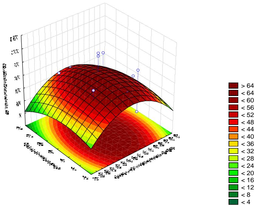
Slika 4 – 159 Regresijska ploha ovisnosti kvalitete koncentrata klase 1/0,5 mm o naponu na elektrodi i brzini okretanja bubenja – grupa „OSKKŽ“
