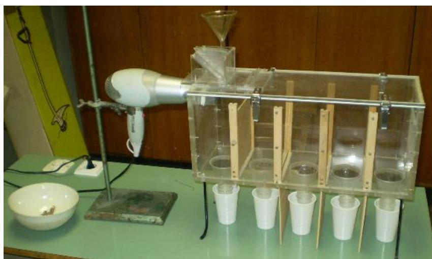
Slika 4 – 15 Model horizontalnog zračnog separatora
