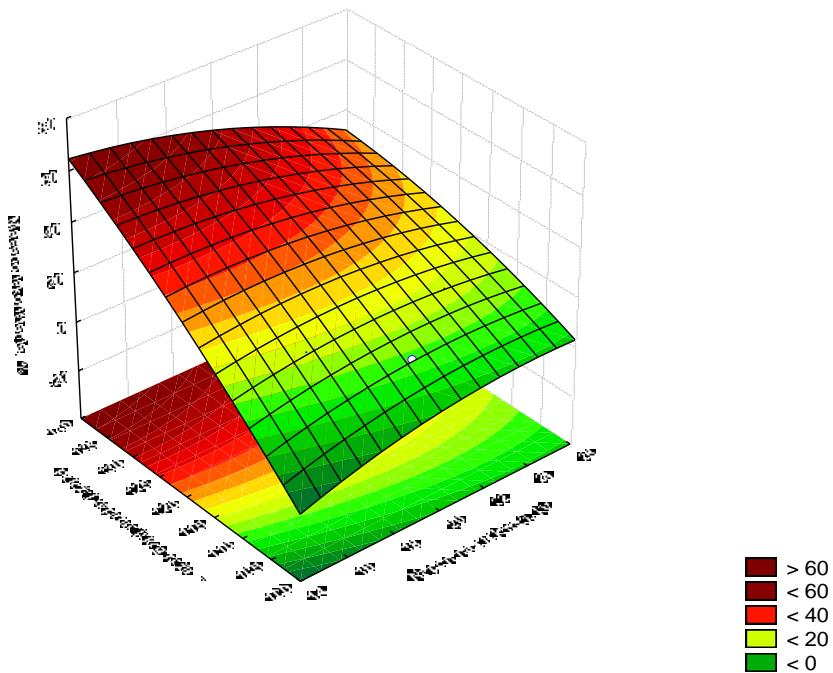
Slika 4 – 153 Regresijska ploha ovisnosti masenog iskorištenja klase 2/1 mm o položaju separacijskog noža i naponu na elektrodi – grupa „OSKKŽ“
