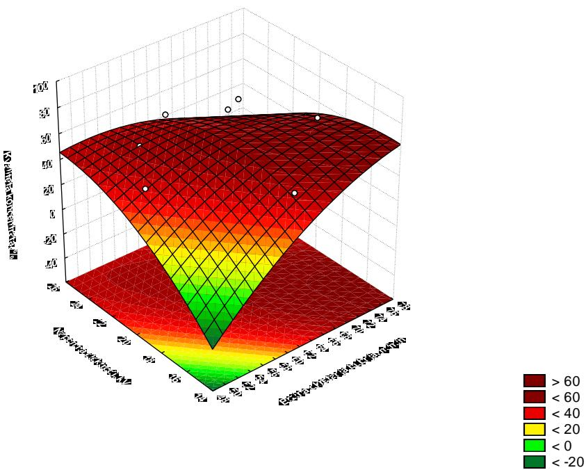
Slika 4 - 171 Regresijska ploha ovisnosti kvalitete koncentrata klase -0,5 mm o naponu na elektrodi i brzini okretanja bubenja – grupa „OSKKŽ“
