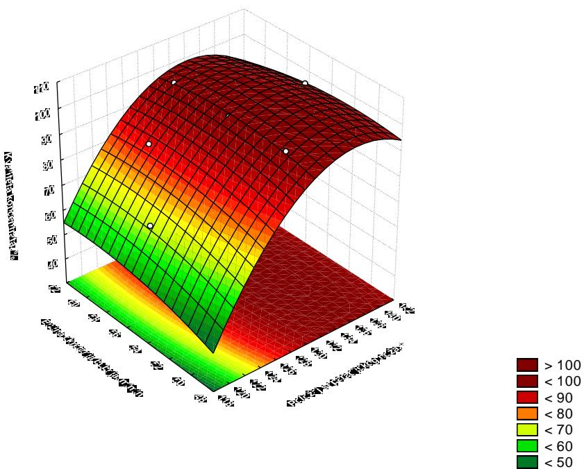
Slika 4 – 224 Regresijska ploha ovisnosti kvalitete koncentrata klase 1/0,5 mm o brzini okretanja bubenja i položaju separacijskog noža – grupa „TP“
