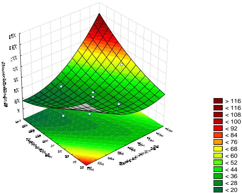
Slika 4 – 48 Regresijska ploha ovisnosti masenog iskorištenja klase 2/1 mm o brzini zraka i visini pregrade – grupa „Z“
