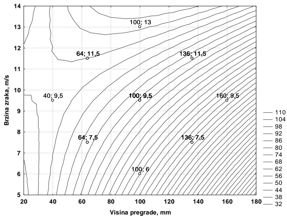
Slika 4 – 73 Nivo-linije regresijske plohe ovisnosti masenog iskorištenja klase -0,5 mm o brzini zraka i visini pregrade – grupa „Z“
