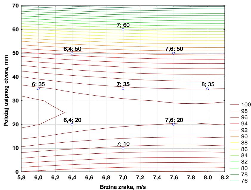
Slika 4 – 211 Nivo-linije regresijske plohe ovisnosti masenog iskorištenja klase 1/0,5 mm o položaju usipnog otvora i brzini – grupa „TP“
