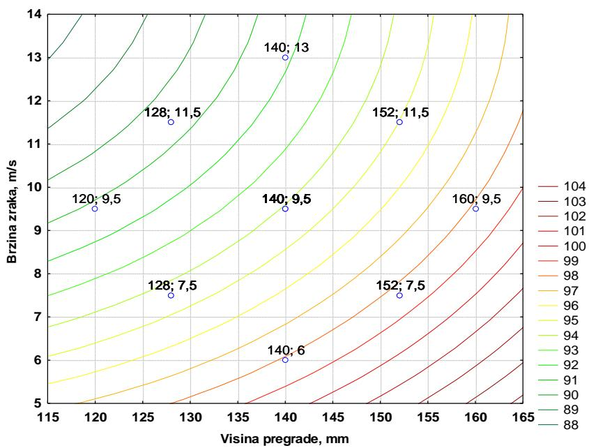
Slika 4 – 102 Nivo-linije regresijske plohe ovisnosti masenog iskorištenja klase 2/1 mm o brzini zraka i visini pregrade – grupa „OSKKŽ“
