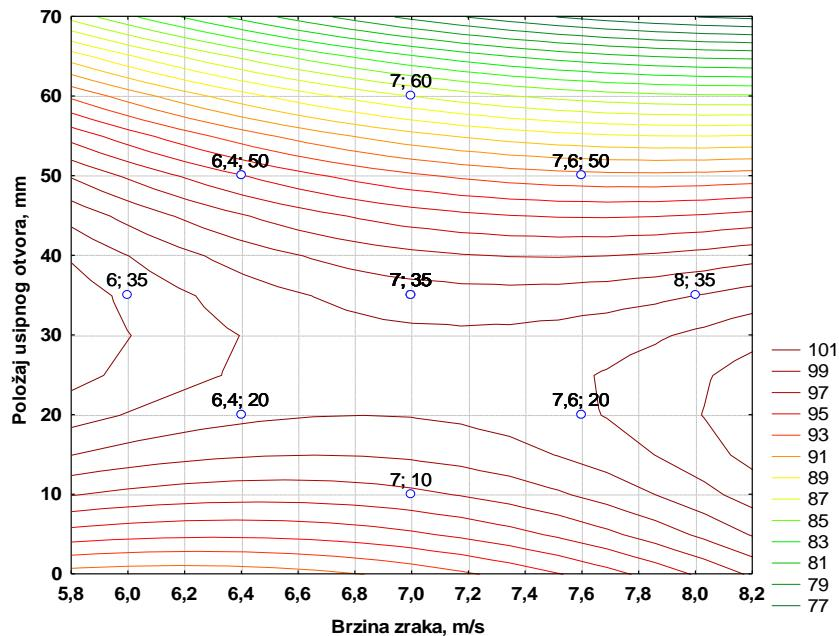
Slika 4 – 199 Nivo-linije regresijske plohe ovisnosti masenog iskorištenja klase 2/1 mm o položaju usipnog otvora i brzini zraka – grupa „TP“
