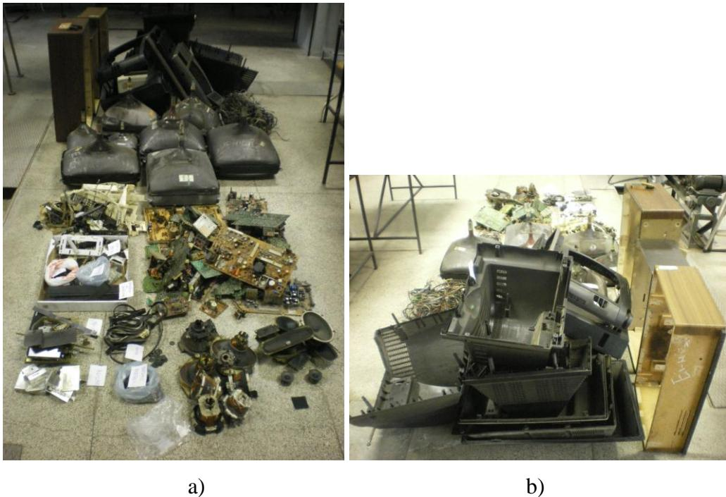
Slika 4 – 1 a) i b) Komponente potpuno demontiranih televizijskih aparata pripremljenih za ispitivanje
