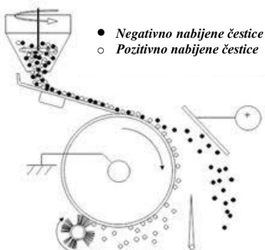
Slika 3 – 5 Prikaz separiranja na elektrostatičkom separatoru
