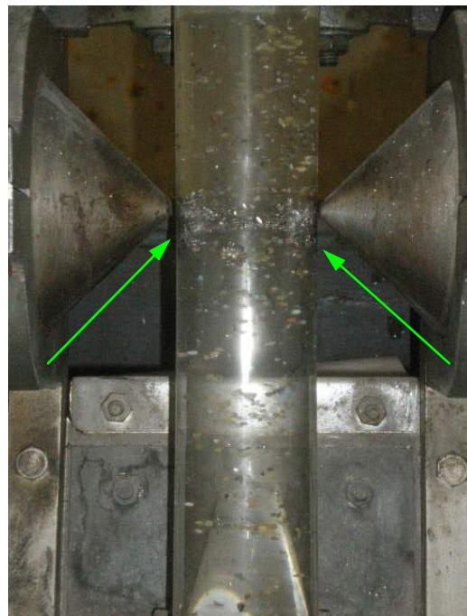
Slika 4 – 20 Pogled na Davis-ovu cijev sa zadržanim magnetičnim materijalom na staklenim stijenkama uz magnetske polove i nemagnetični materijal koji tone
