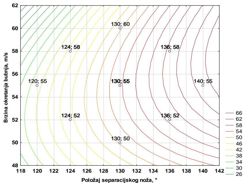
Slika 4 – 219 Nivo-linije regresijske plohe ovisnosti masenog iskorištenja klase 2/1 mm o brzini okretanja bubenja i položaju separacijskog noža – grupa „TP“
