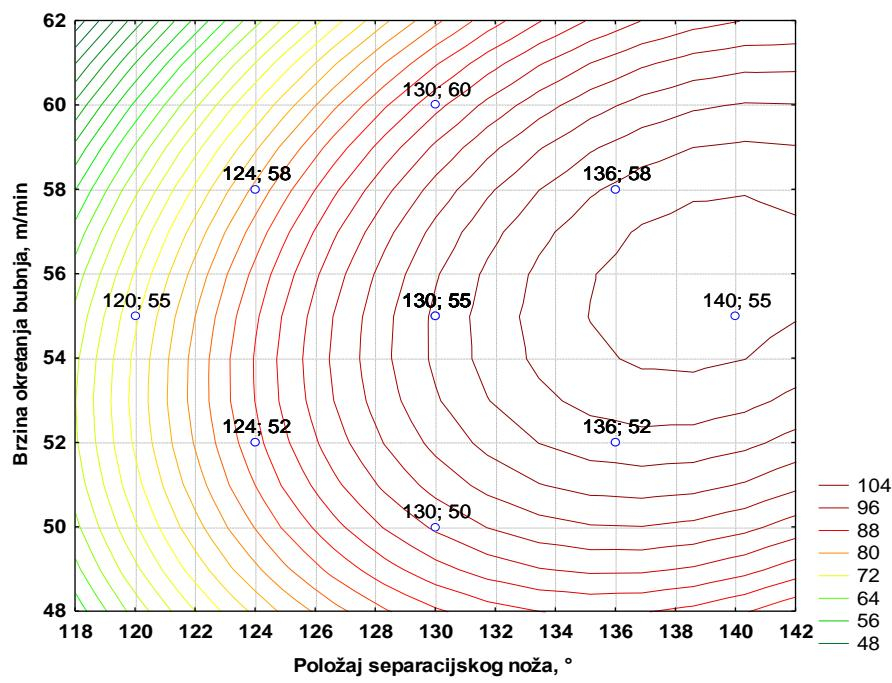
Slika 4 – 213 Nivo-linije regresijske plohe ovisnosti kvalitete koncentrata klase 2/1 mm o brzini okretanja bubenja i položaju separacijskog noža – grupa „TP“
