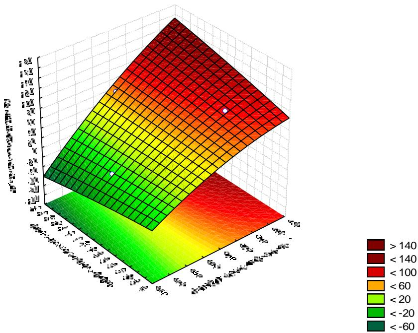
Slika 4 – 131 Regresijska ploha ovisnosti kvalitete koncentrata klase 4/2 mm o brzini okretanja bubnja i položaju separacijskog noža – grupa „OSKKŽ“
