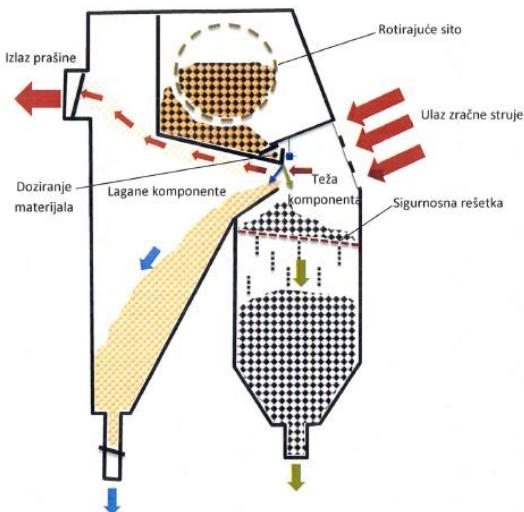
Slika 3 – 3 Primjer zračnog separatora – CFS separator
