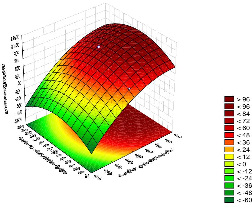
Slika 4 – 155 Regresijska ploha ovisnosti kvalitete koncentrata klase 1/0,5 mm o brzini okretanja bubenja i položaju separacijskog noža – grupa „OSKKŽ“
