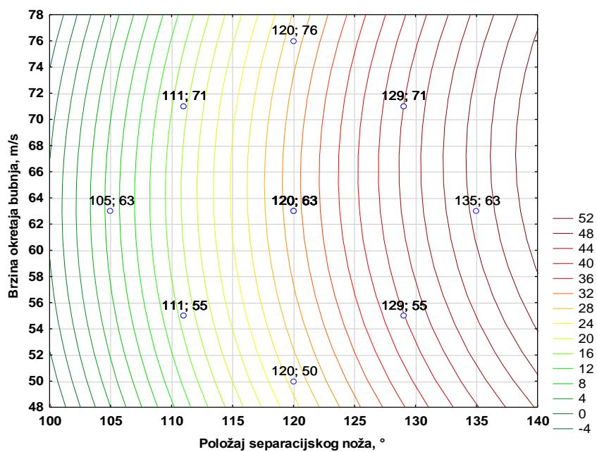
Slika 4 -150 Nivo-linije regresijske plohe ovisnosti masenog iskorištenja klase 2/1 mm o brzini okretanja bubenja i položaju separacijskog noža – grupa „OSKKŽ“
