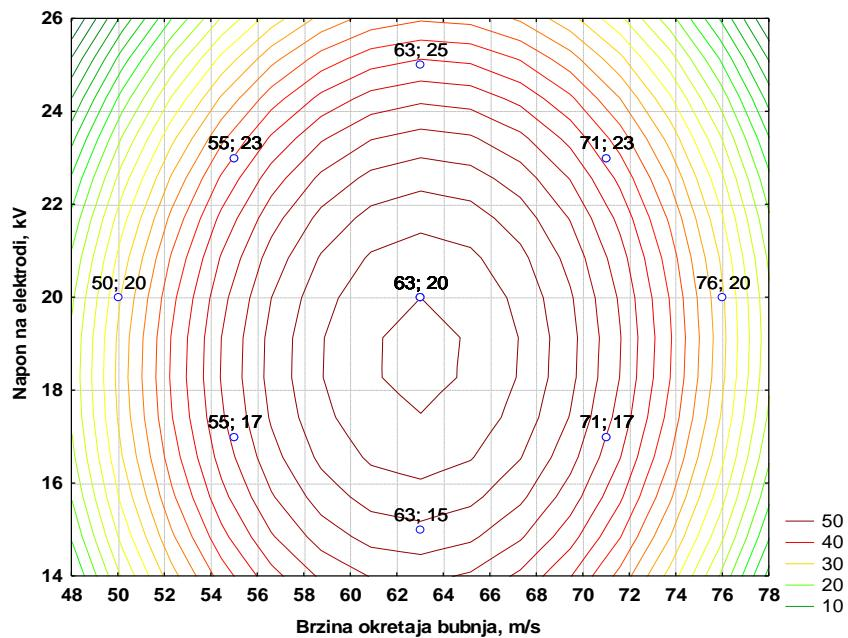
Slika 4 – 166 Nivo-linije regresijske plohe ovisnosti masenog iskorištenja klase 1/0,5 mm o naponu na elektrodi i brzini okretanja bubenja – grupa „OSKKŽ“
