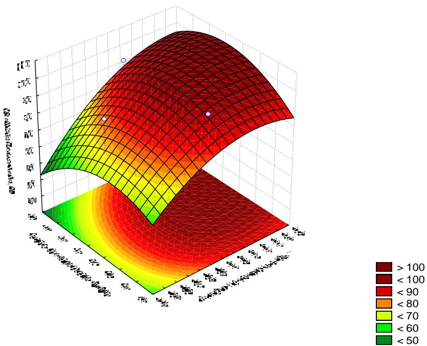
Slika 4 – 212 Regresijska ploha ovisnosti kvalitete koncentrata klase 2/1 mm o brzini okretanja bubenja i položaju separacijskog noža – grupa „TP“
