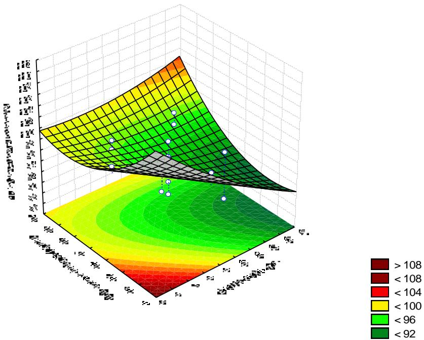
Slika 4 – 105 Regresijska ploha ovisnosti masenog iskorištenja klase 2/1 mm o položaju usipnog otvora i brzini zraka – grupa „OSKKŽ“
