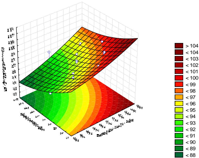
Slika 4 – 101 Regresijska ploha ovisnosti masenog iskorištenja klase 2/1 mm o brzini zraka i visini pregrade – grupa „OSKKŽ“
