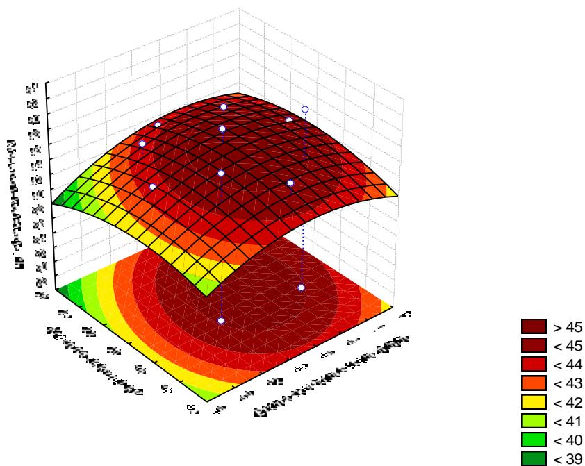
Slika 4 – 234 Regresijska ploha ovisnosti masenog iskorištenja klase 1/0,5 mm o naponu na elektrodi i brzini okretanja bubenja – grupa „TP“
