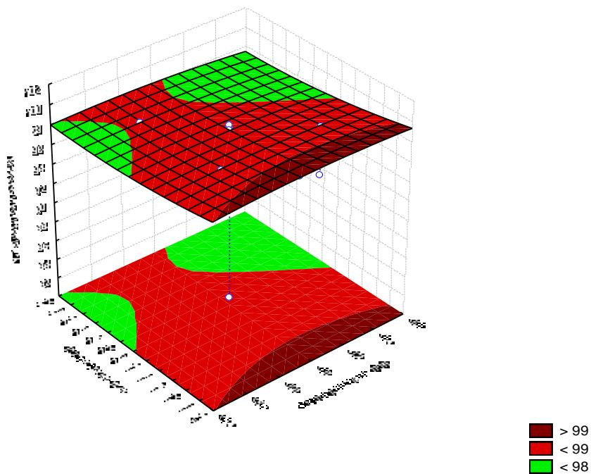
Slika 4 – 206 Regresijska ploha ovisnosti masenog iskorištenja klase 1/0,5 mm o brzini zraka i visini pregrade – grupa „TP“
