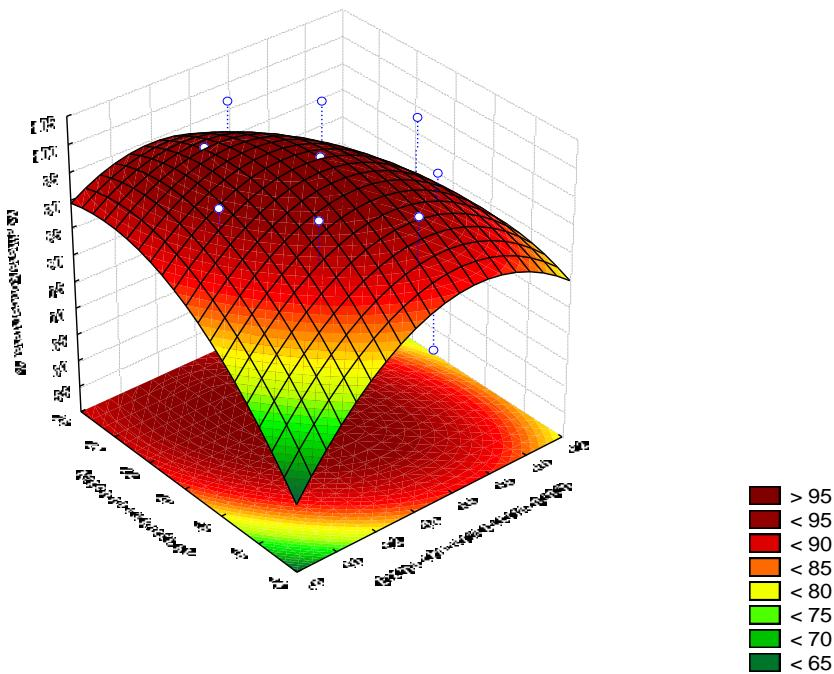
Slika 4 – 216 Regresijska ploha ovisnosti kvalitete koncentrata klase 2/1 mm o naponu na elektrodi i brzini okretanja bubenja – grupa „TP“
