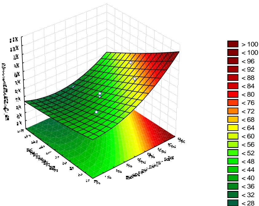
Slika 4 – 60 Regresijska ploha ovisnosti masenog iskorištenja klase 1/0,5 mm o brzini zraka i visini pregrade – grupa „Z“
