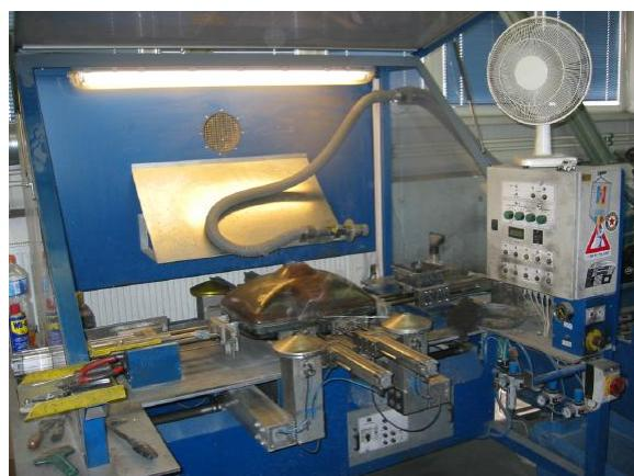
Slika 4 – 237 Prikaz posebnog dijela pogona za recikliranje katodnih cijevi
