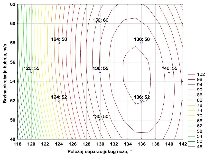
Slika 4 – 225 Nivo-linije regresijske plohe ovisnosti kvalitete koncentrata klase 1/0,5 mm o brzini okretanja bubenja i položaju separacijskog noža – grupa „TP“
