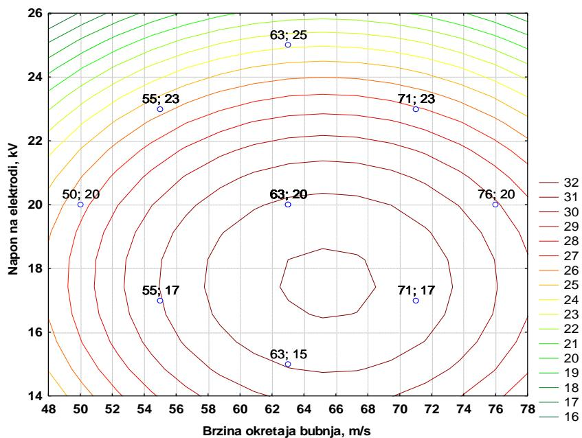
Slika 4 - 178 Nivo-linije regresijske plohe ovisnosti masenog iskorištenja klase -0,5 mm o naponu na elektrodi i brzini okretanja bubenja – grupa „OSKKŽ“
