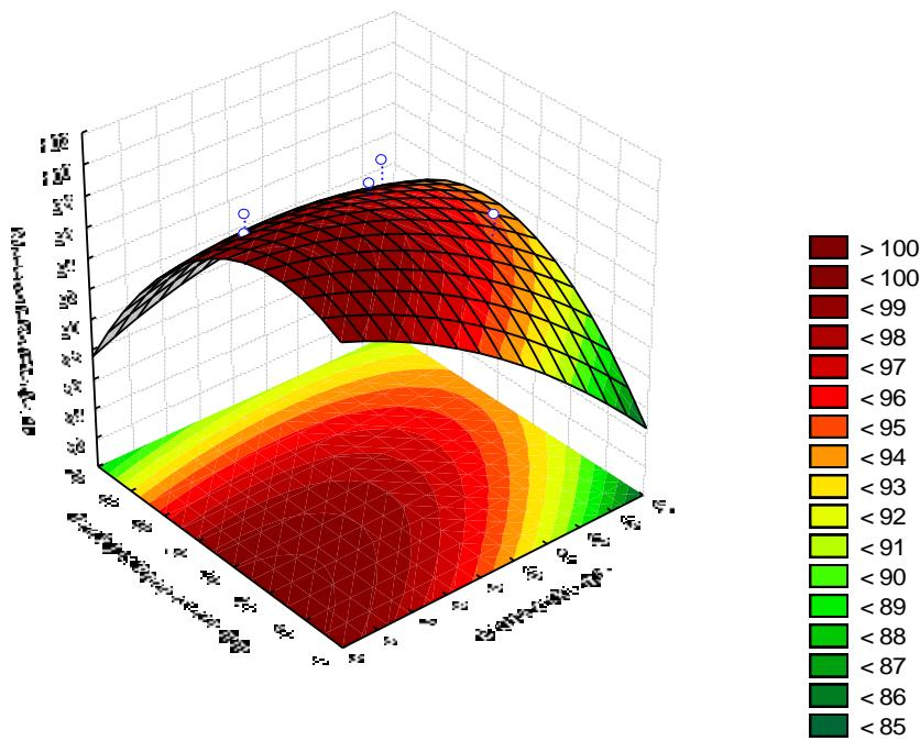
Slika 4 – 93 Regresijska ploha ovisnosti masenog iskorištenja klase 4/2 mm o položaju usipnog otvora i brzini zraka – grupa „OSKKŽ“
