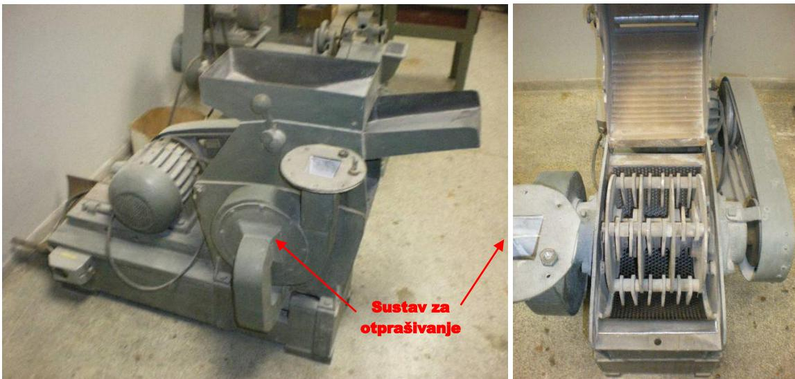
Slika 4 – 6 Udarna drobilica s rotirajućim pločicama
