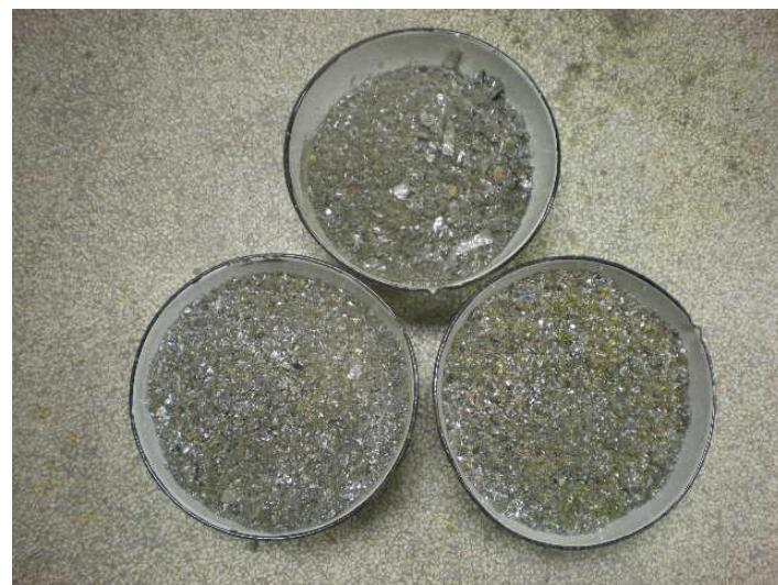
Slika 4 - 185 Tiskane pločice nakon sekundarnog sitnjenja
