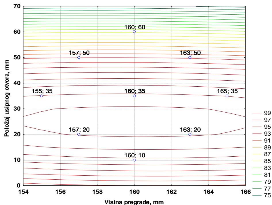
Slika 4 – 209 Nivo-linije regresijske plohe ovisnosti masenog iskorištenja klase 1/0,5 mm o visini pregrade i položaju usipnog otvora - grupa „TP“
