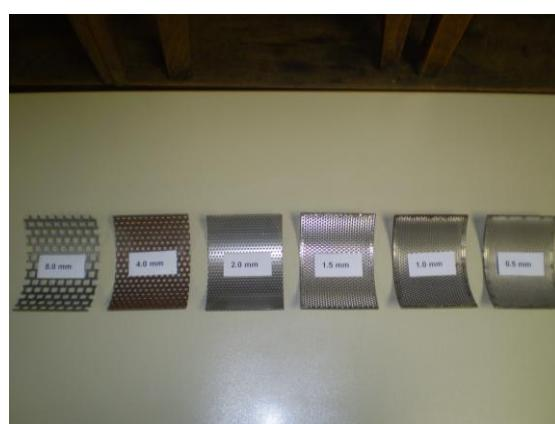
Slika 4 – 10 Rešetke za rezni mlin s veličinama otvora od 0,5 do 8,0 mm
