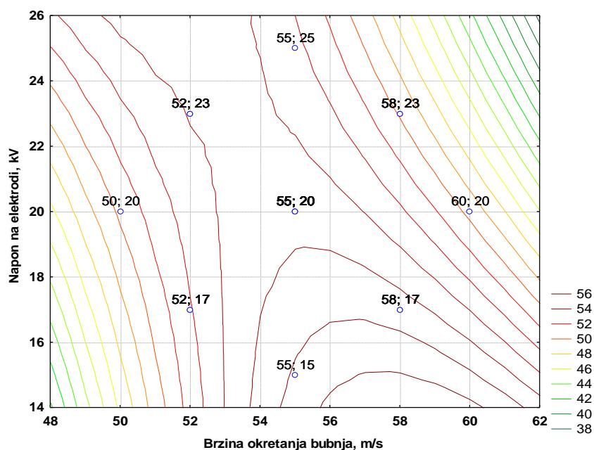
Slika 4 – 221 Nivo-linije regresijske plohe ovisnosti masenog iskorištenja klase 2/1 mm o naponu na elektrodi i brzini okretanja bubenja – grupa „TP“
