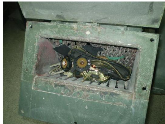
Slika 4 – 27 Sitnjenje zvučnika u udarnoj drobilici IZ-0
