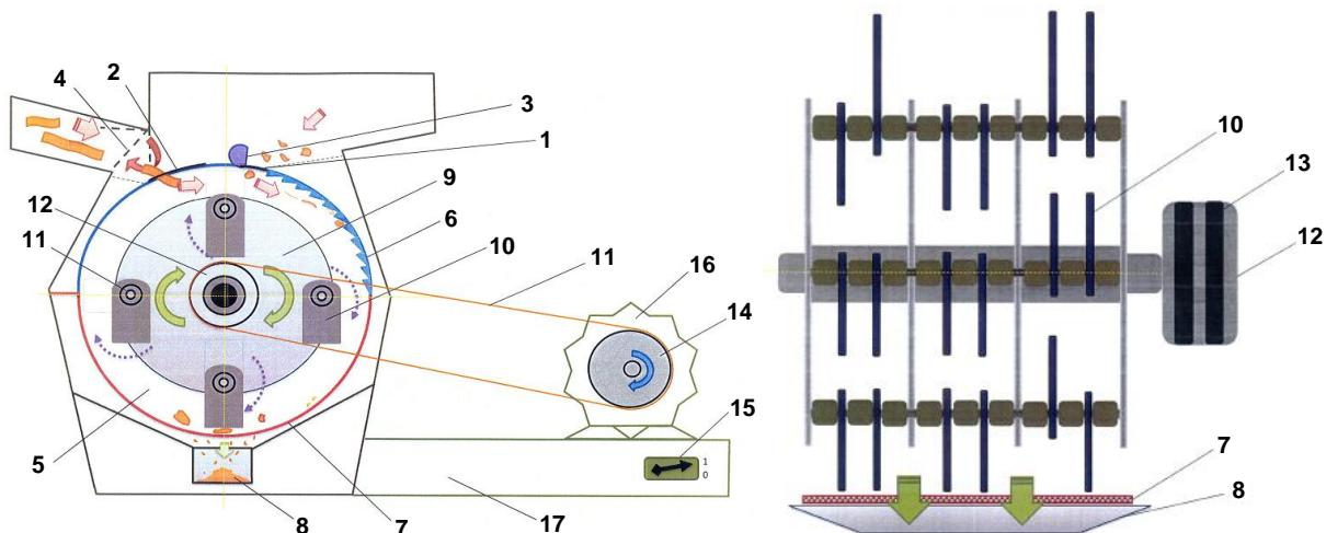
Slika 4 – 5 Shematski prikaz udarne drobilice sa rotirajućim pločicama
