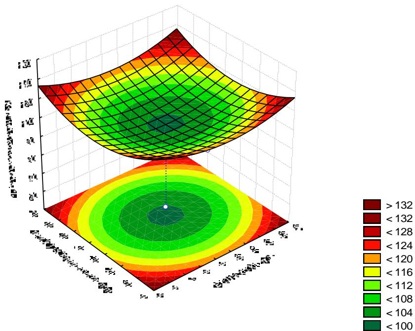
Slika 4 – 87 Regresijska ploha ovisnosti kvalitete koncentrata klase 4/2 mm o položaju usipnog otvora i brzini zraka – gupa „OSKKŽ“
