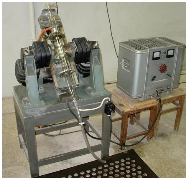
Slika 4 – 19 Laboratorijski mokri niskointenzivni magnetski separator 25T-СЭМ
