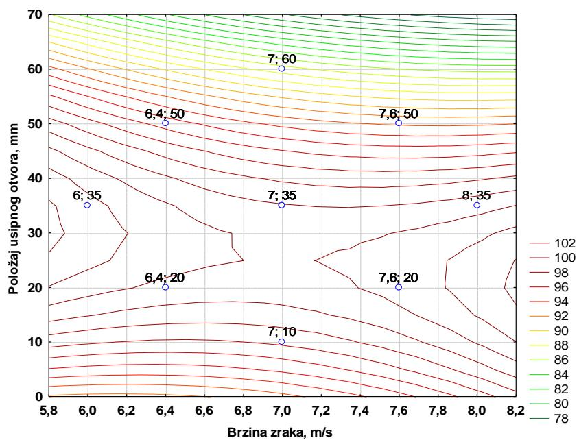
Slika 4 – 193 Nivo-linije regresijske plohe ovisnosti kvalitete koncentrata klase 2/1 mm o položaju usipnog otvora i brzini zraka – grupa „TP“
