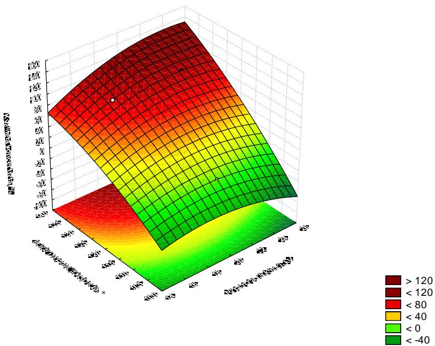
Slika 4 – 133 Regresijska ploha ovisnosti kvalitete koncentrata klase 4/2 mm o položaju separacijskog noža i napona na elektrodi – grupa „OSKKŽ“
