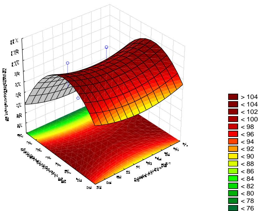
Slika 4 – 111 Regresijska ploha ovisnosti kvalitete koncentrata klase 1/0,5 mm o položaju usipnog otvora i brzini zraka – grupa „OSKKŽ“
