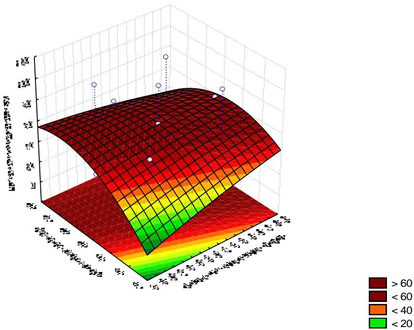
Slika 4 – 135 Regresijska ploha ovisnosti kvalitete koncentrata klase 4/2 mm o naponu na elektrodi i brzini okretanja bubenja – grupa „OSKKŽ“
