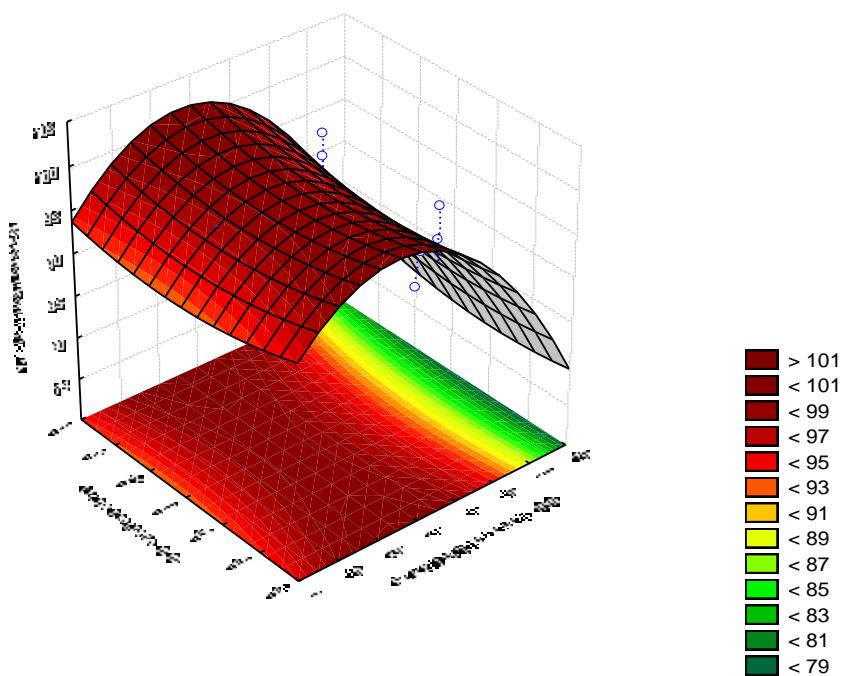
Slika 4 – 196 Regresijska ploha ovisnosti masenog iskorištenja klase 2/1 mm o visini pregrade i položaju usipnog otvora – grupa „TP“
