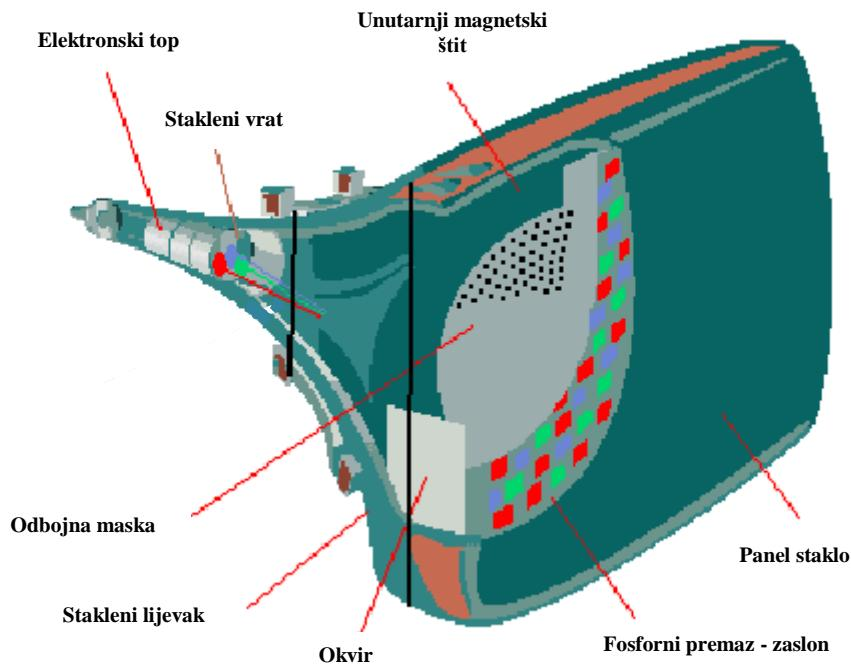
Slika 4 – 236 Sastavni dijelovi katodne cijevi – *CRT* televizijskog aparata
