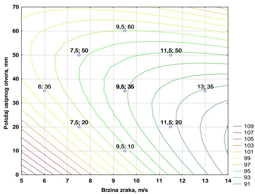
Slika 4 – 106 Nivo-linije regresijske plohe ovisnosti masenog iskorištenja klase 2/1 mm o položaju usipnog otvora i brzini zraka – grupa „OSKKŽ“
