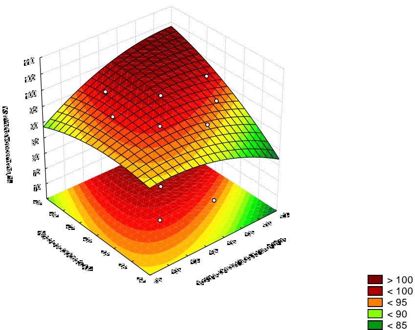
Slika 4 – 228 Regresijska ploha ovisnosti kvalitete koncentrata klase 1/0,5 mm o naponu na elektrodi i brzini okretanja bubenja – grupa „TP“
