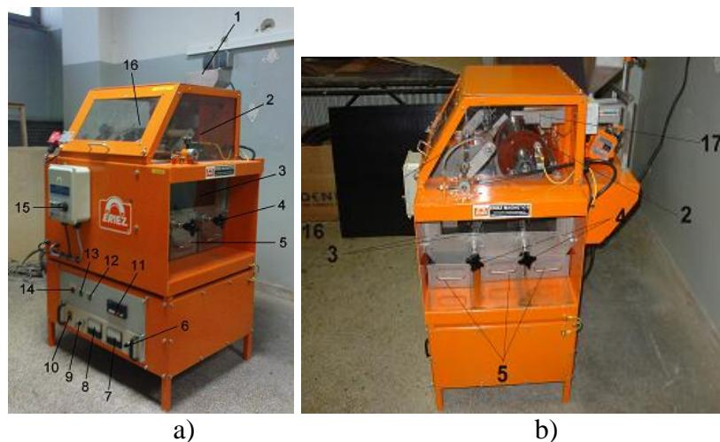
Slika 4 – 22 Elektrostatički separator Eriez Magnetics HT – 150
