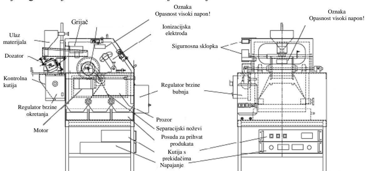
Slika 4 – 21 Shematski prikaz elektrostatičkog separatora Eriez Magnetics HT – 150
