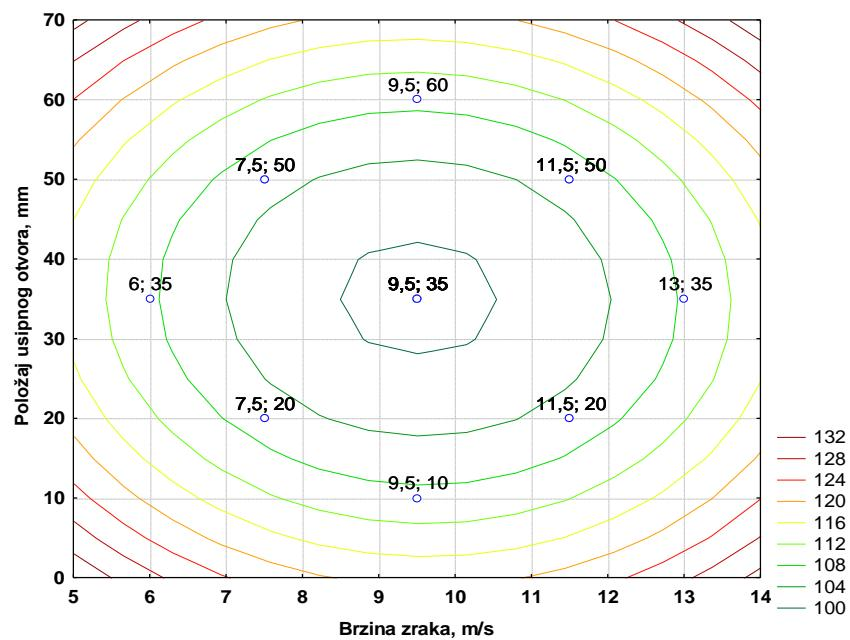
Slika 4 – 88 Nivo-linije regresijske plohe ovisnosti kvalitete koncentrata klase 4/2 mm o položaju usipnog otvora i brzini zraka – grupa „OSKKŽ“
