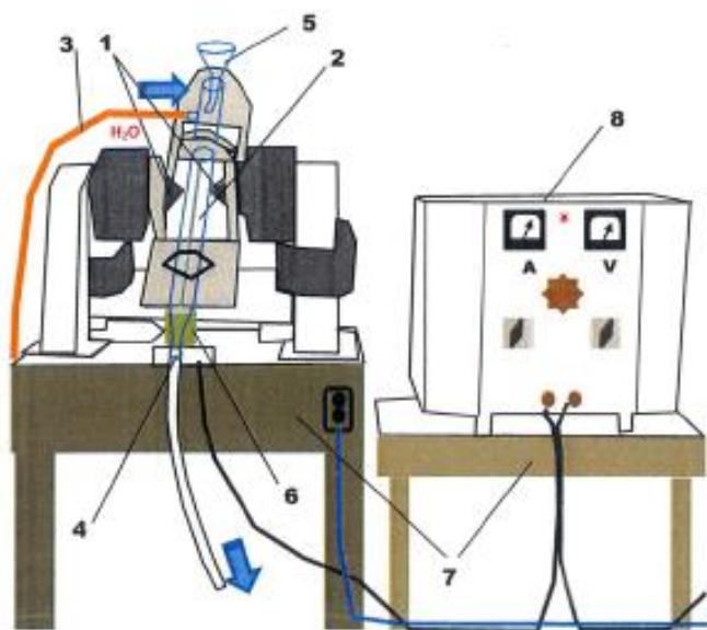
Slika 4 – 18 Shematski prikaz mokrog niskointenzivnog magnetskog separatora
