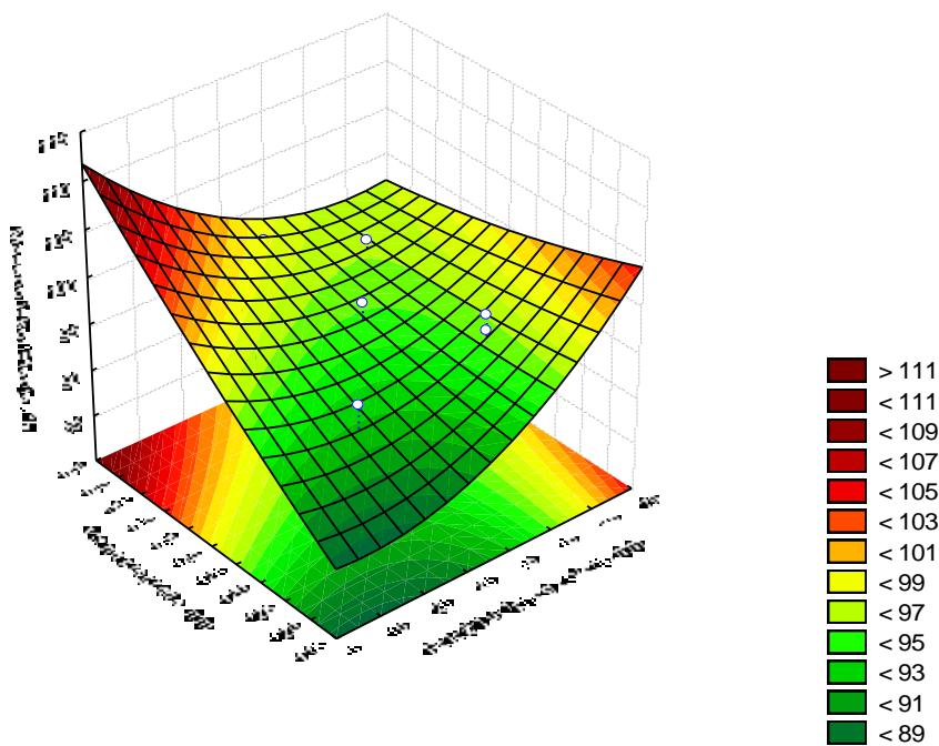
Slika 4 – 103 Regresijska ploha ovisnosti masenog iskorištenja klase 2/1 mm o visini pregrade i položaju usipnog otvora – grupa „OSKKŽ“
