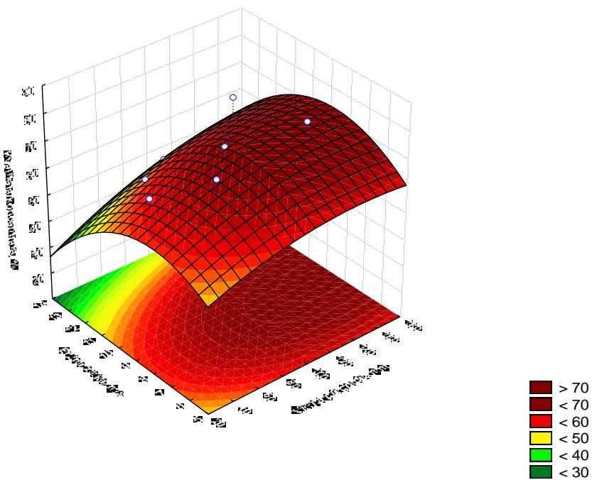
Slika 4 – 66 Regresijska ploha ovisnosti kvalitete koncentrata klase  $-0,5\text{ mm}$  o brzini zraka i visini pregrade – grupa „Z“
