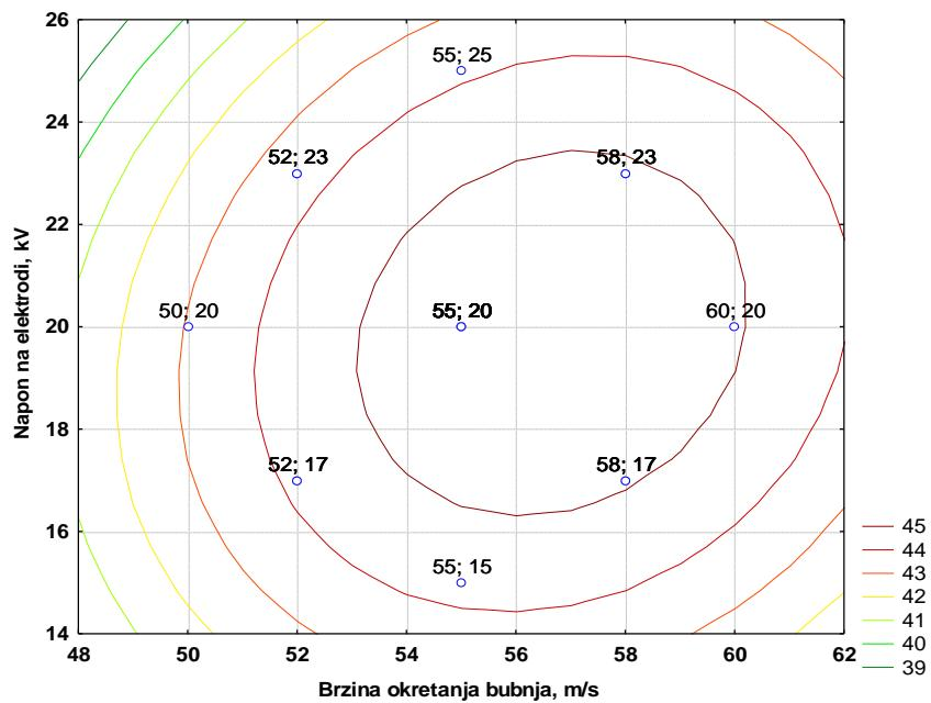
Slika 4 – 235 Nivo-linije regresijske plohe ovisnosti masenog iskorištenja klase 1/0,5 mm o naponu na elektrodi i brzini okretanja bubenja – grupa „TP“
