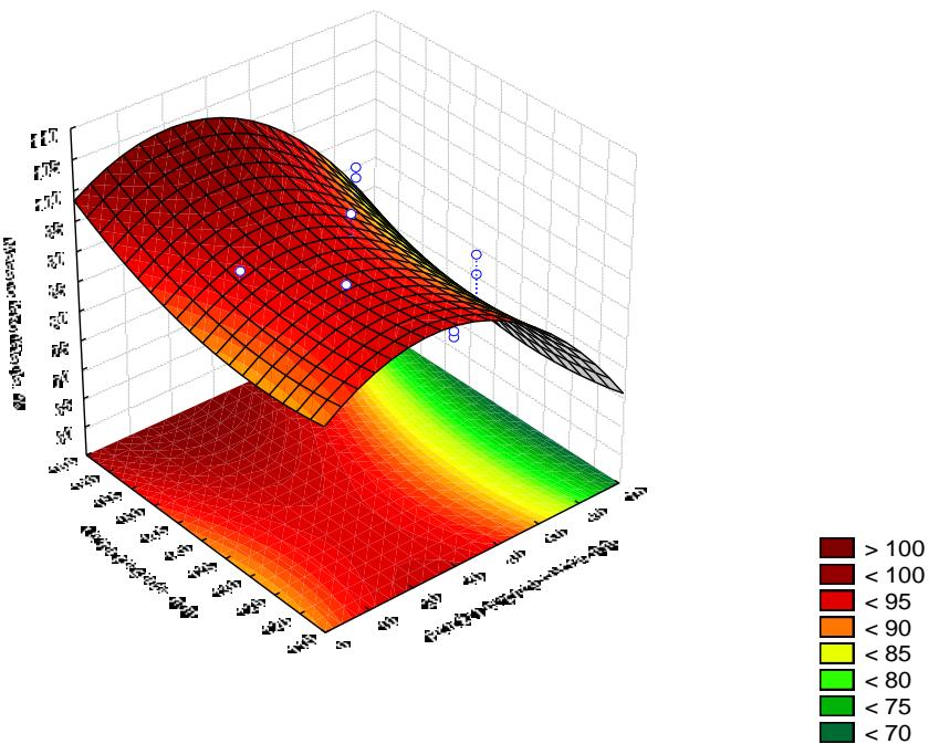
Slika 4 – 115 Regresijska ploha ovisnosti masenog iskorištenja klase 1/0,5 mm o visini pregrade i položaju usipnog otvora – grupa „OSKKŽ“
