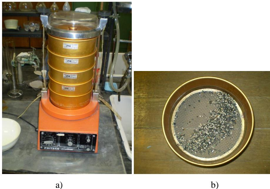
Slika 4 – 13 a) Elektromagnetsko laboratorijsko sito *FRITSCH "Analysette 3"*
