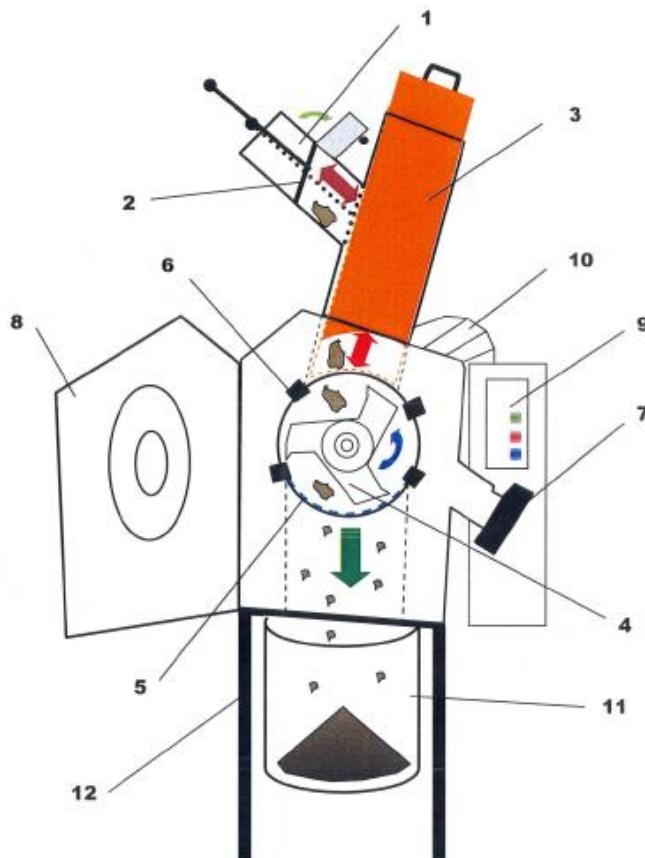
Slika 4 – 8 Shematski prikaz reznog mlina
