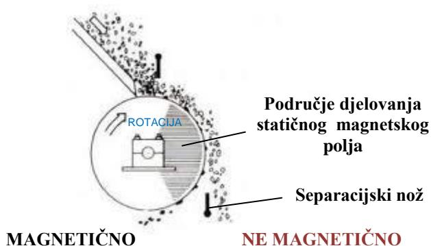
Slika 3 – 4 Princip rada bubenjastog suhog magnetskog separatora
