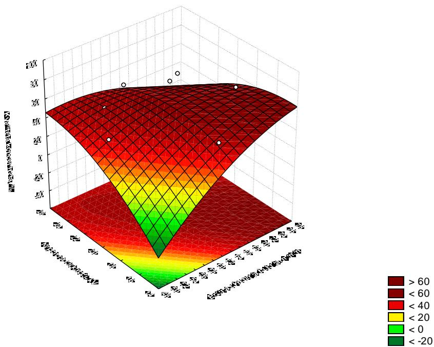
Slika 4 – 147 Regresijska ploha ovisnosti kvalitete koncentrata klase 2/1 mm o naponu na elektrodi i brzini okretanja bubenja – grupa „OSKKŽ“
