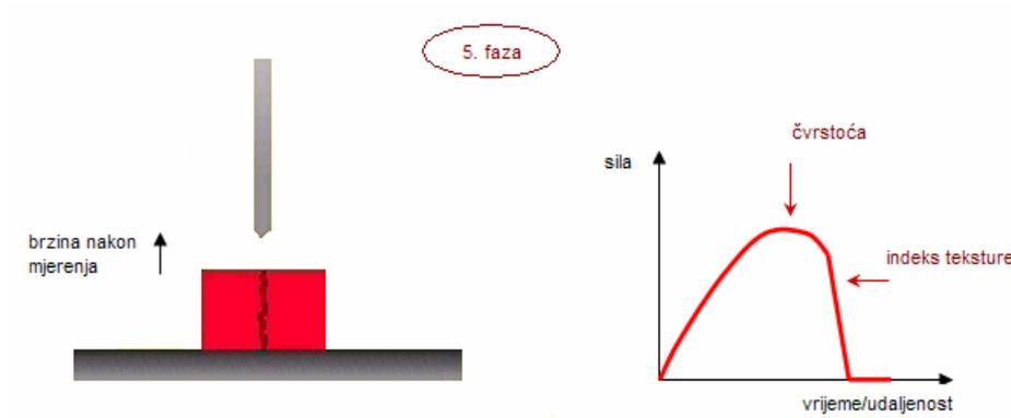
**Slika 17.** Prikaz mjerenja čvrstoće uzorka pomoću Kramer-ovog nastavka po fazama.
