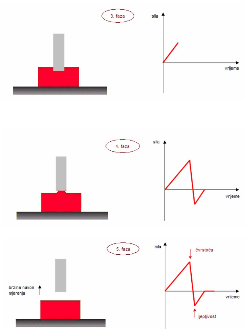
**Slika 18.** Prikaz mjerenja čvrstoće uzorka pomoću cilindričnog nastavka.
