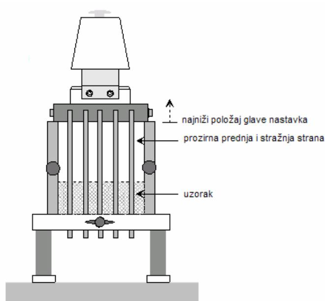
**Slika 16.** Prikaz Kramerovog nastavka za mjerenje čvrstoće uzoraka.
