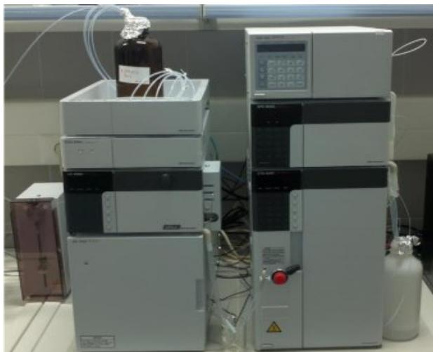
**Slika 16** Shimadzu sustav za RP-HPLC
