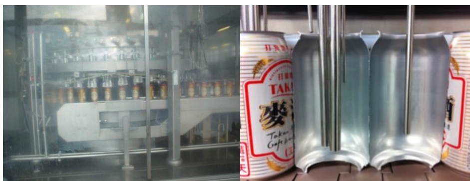
Slika 26 Punjač limenki u radu i presjek limenki na punjaču (Cask Brewing Systems Inc., 2013.)
