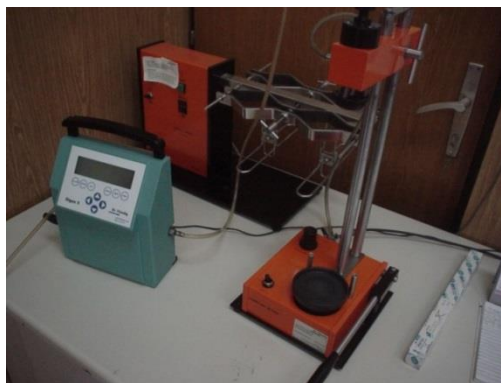
Slika 45 Okretač boca BT-002, LG-automatic aps., Oksimetar Digox 5
