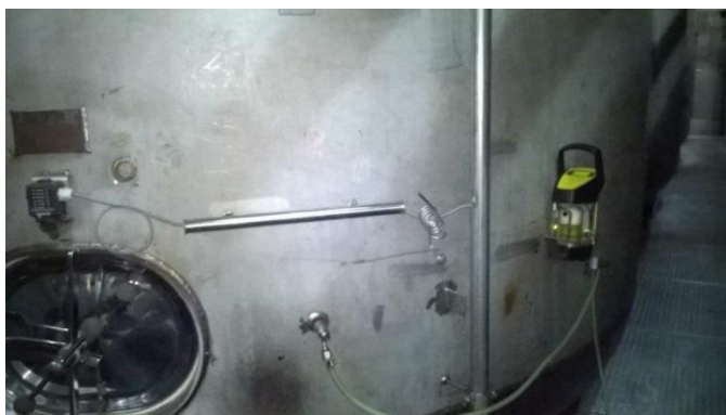
Slika 31 Pivo u tlačnom tanku (mjerenje na Norit Haffmans c-DGM-om)
