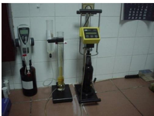
Slika 42 Ukupni sadržaj zraka u boci (limenci), Inpack 2000 Air Meter IAM, CO 2 senzor kalkulatr ICC 2000
