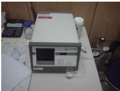
Slika 34 Analizator piva DMA 5000 + SH1
