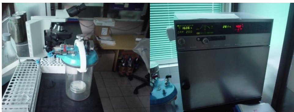
Slika 49 Anaerobni lonac s mikrobiološkim podlogama i inkubator Memmert
