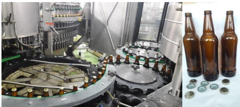
Slika 19 Punjač staklenih boca u radu i staklene boce s krunskim zatvaračima
