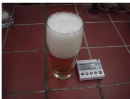
Slika 41 Mjerenje trajnosti pjene prema Ullmann i Pfenningeru
