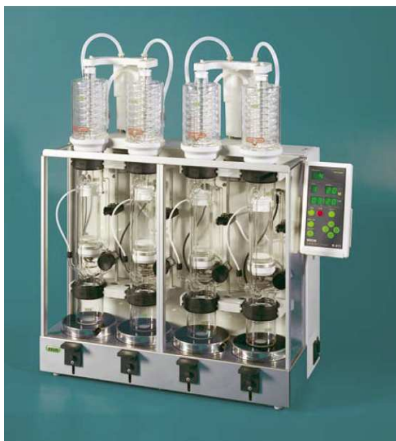
Slika 3.2. Univerzalni sustav za ekstrakciju (Büchi B-811_LSV)
