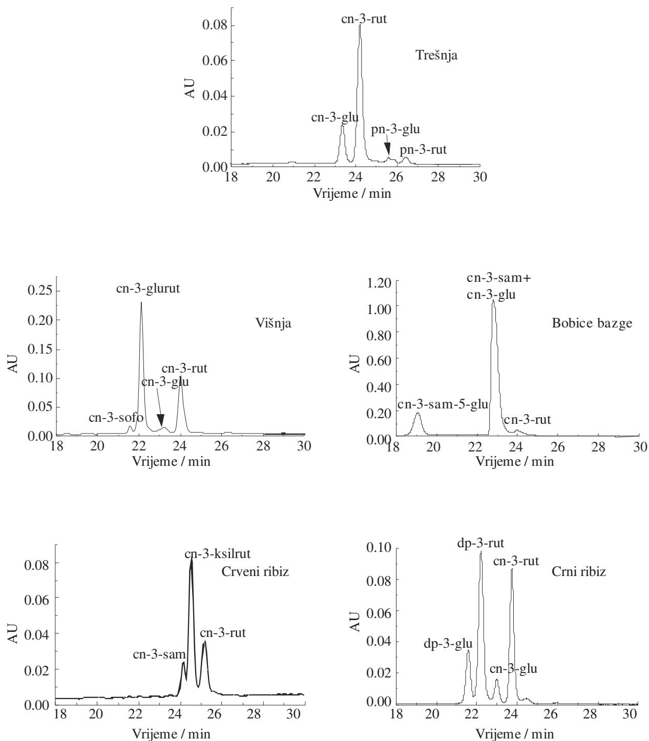
Nastavak slike 22. HPLC kromatogrami voća snimljeni na 520 nm s prikazom identificiranih antocijanina Cn, cijanidin; pn, peonidin; dp, delfnidin; pg, pelargonidin; pt, petunidin; m malvidin; glu, glukozid, rut, rutinozid, gal, galaktozid; ara, arabinozid; sam, sambubiozid; sof soforozid; ksil, ksilozid; ksilrut, ksilozilrutinozid
