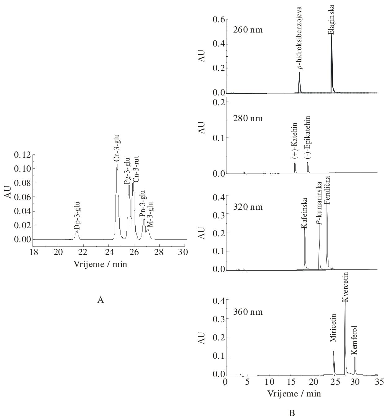
Slika 17. Kromatogrami A) standarda antocijanina (520 nm) te B) standarda flavonola, flavanola i fenolnih kiselina snimljeni na 260, 280, 320 i 360 nm.
