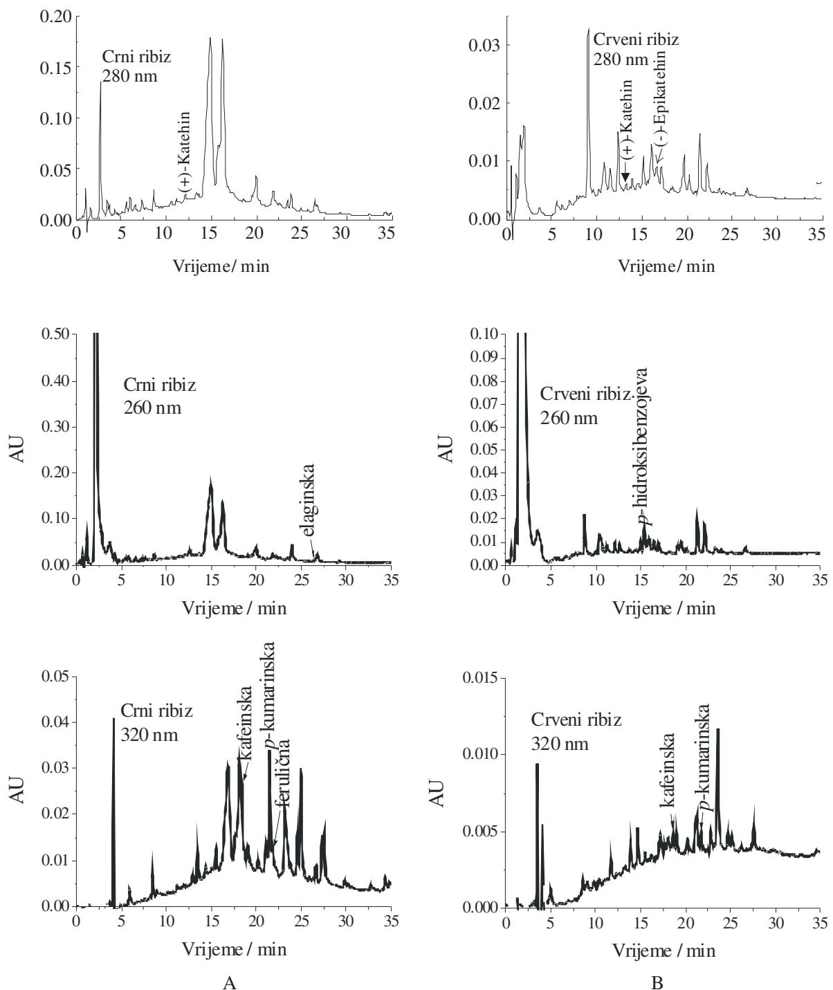
Slika 27. HPLC kromatogrami A) crnog ribizla i B) crvenog ribizla snimljeni na 260, 280 i 320 nm s prikazom hidroksibenzojevih kiselina, flavanola i hidroksicimetnih kiselina.
