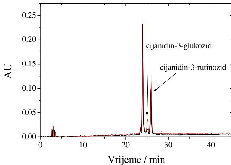
Slika 18. Preklopjeni kromatogrami uzorka višnje i uzorka višnje u koji su dodani standardi cijanidin-3-glukozid i cijanidin-3-rutinozid (520 nm)
