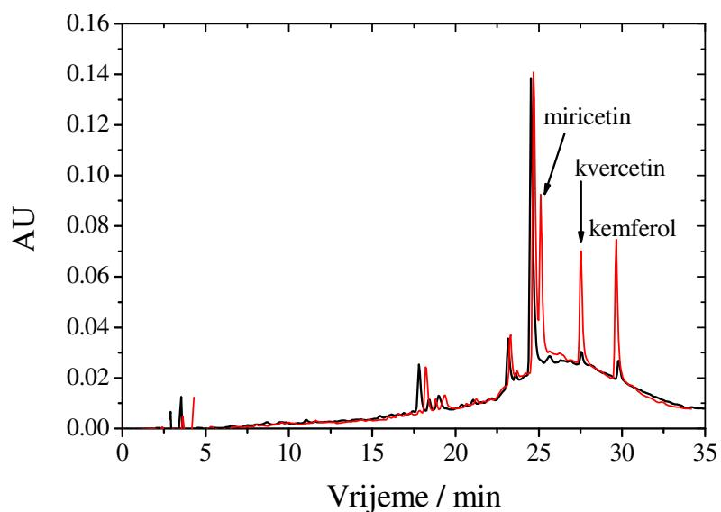
Slika 19. Preklopjeni kromatogrami uzorka jagode i uzorka jagode u koji su dodani standardi miricetin, kvercetin i kemferol (360 nm)
