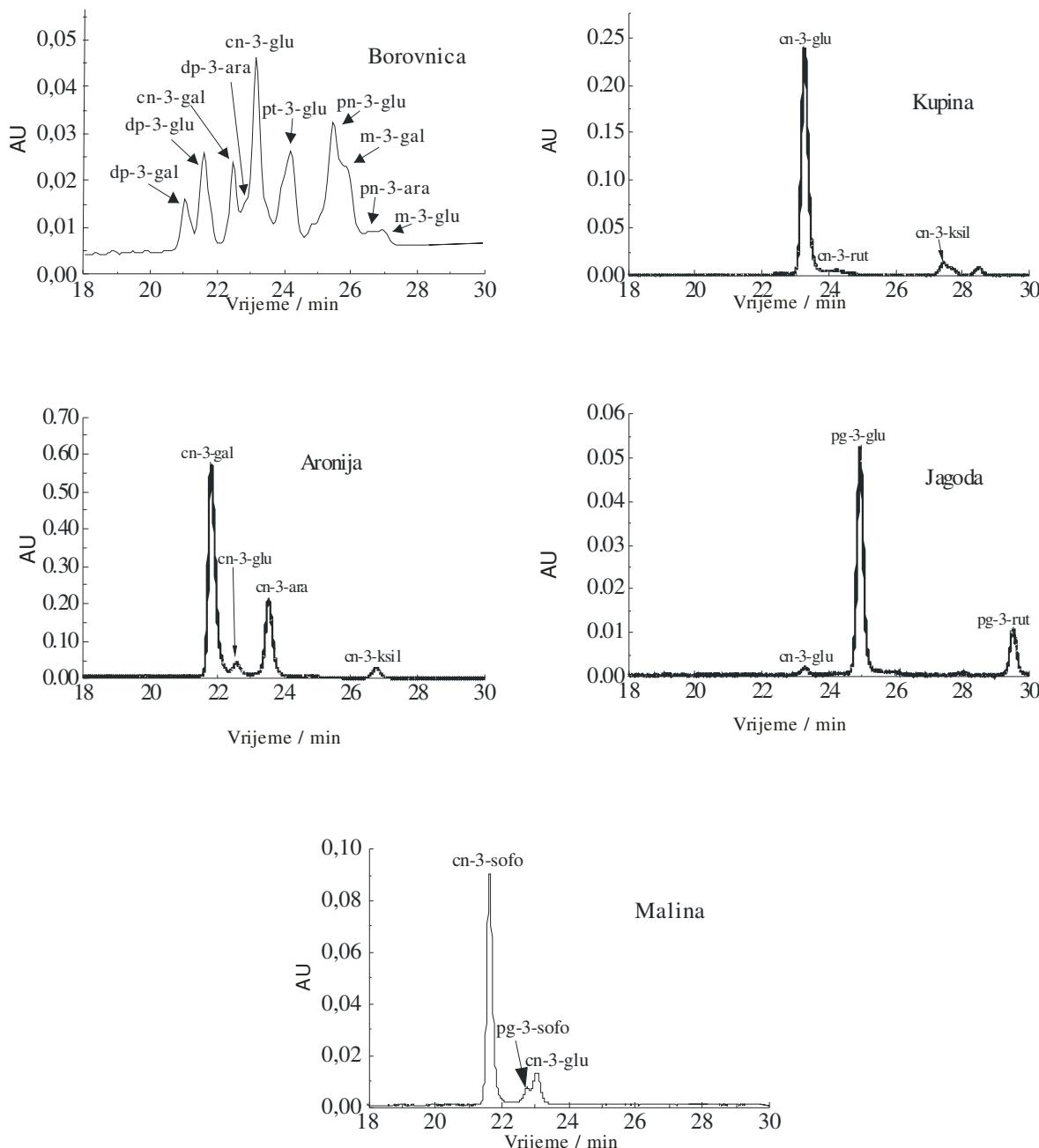
Slika 22. HPLC kromatogrami voća snimljeni na 520nm s prikazom identificiranih antocijanina. Cn, cijanidin; pn, peonidin; dp, delfinidin; pg, pelargonidin; pt, petunidin; m, malvidin; glu, glukozid; rut, rutinozid; gal, galaktozid; ara, arabinozid; sam, sambubiozid; sofo, soforozid; ksil, ksilosid; ksilrut, ksilosilrutinozid
