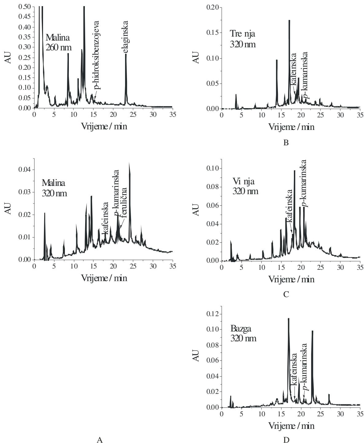
Slika 26. HPLC kromatogrami A) maline, B) tršnje, C) vrućine i D) bazge snimljeni na 260, 280 i 320 nm s prikazom hidroksibenzojevih kiselina, flavanola i hidroksicimetnih kiselina.
