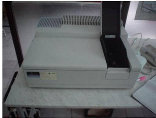
**Slika 37** Spektrofotometar Lambda 25
