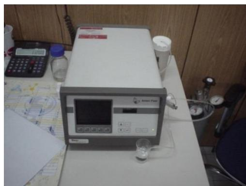
**Slika 34** Analizator piva DMA 5000 + SH1
