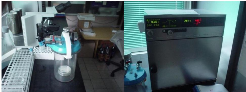
**Slika 49** Anaerobni ionac s mikrobiološkim podlogama i inkubator Memmert
