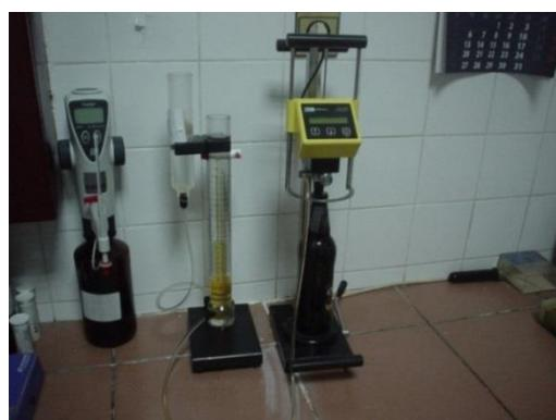
**Slika 42** Ukupni sadržaj zraka u boci (limenci), Inpack 2000 Air Meter IAM,  $\text{CO}_2$  senzor kalkulator ICC 2000
