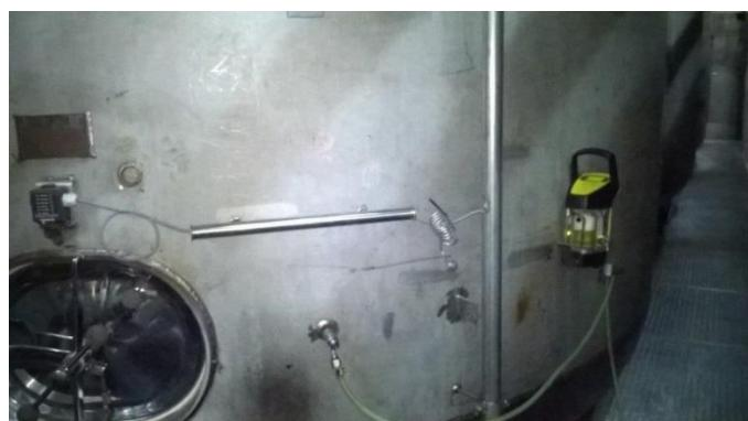
**Slika 31** Pivo u tlačnom tanku (mjerjenje na Norit Haffmans c-DGM-om)
