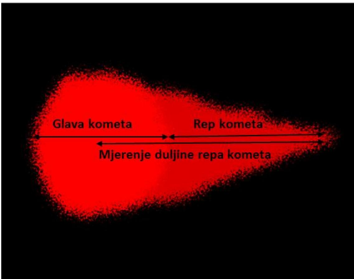
Slika 8. Shematski prikaz osnovnih parametara komet testa.
