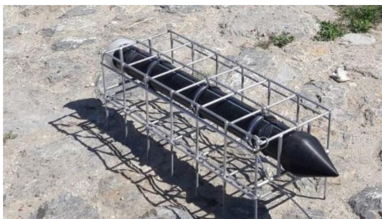
Slika 9. Pasivno uzorkovalo korišteno na lokaciji Prisavlje (TMPB)
