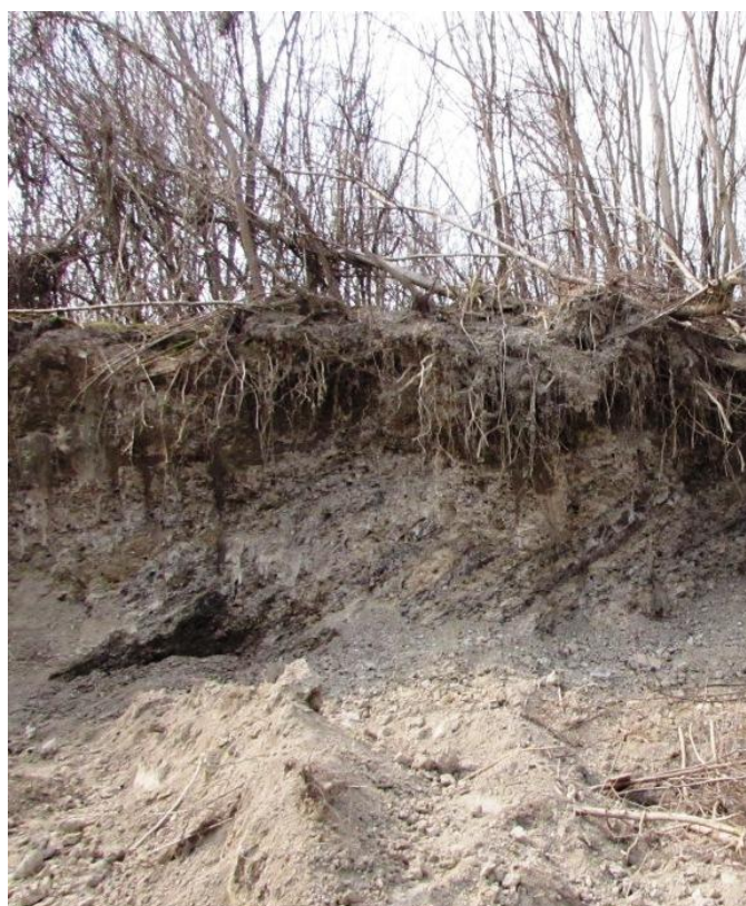
Sl. 36 Prikaz procesa osipanja na haldi 21 (22. 03. 2015.)
