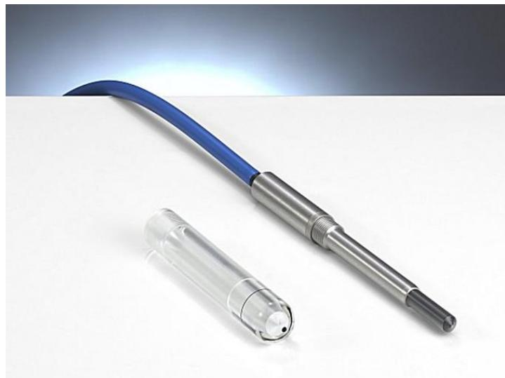
**Slika 4.1.2.** Ionizacijska komora tipa Farmer, TW 30013, nacionalni umjerni standard Sekundarnog standardnog dozimetrijskog laboratorija Institut-a Ruđer Bošković, HMI/IRB-SSDL.
