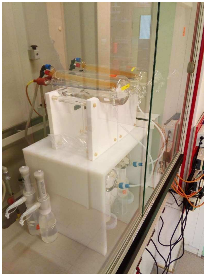
Slika 4.6.2. Dvostruka destilacija klorovodične i dušične kiseline korištenih za raščinjavanje uzoraka sedimenta (institut Helmholtz-Zentrum Geestacht , Njemačka).
