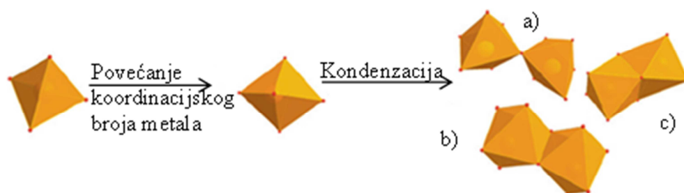
Slika 1. Shematski prikaz nastajanja polioksometalatih vrsta: povezivanje \{MO_x\} jedinica preko a) vrha oktaedra (eng. corner sharing ), b) brida (eng. edge sharing ) i c) plohe (eng. face sharing ). Atomi kisika prikazani su crveno, dok se atomi metala nalaze u središtu koordinacijske sfere. 11
