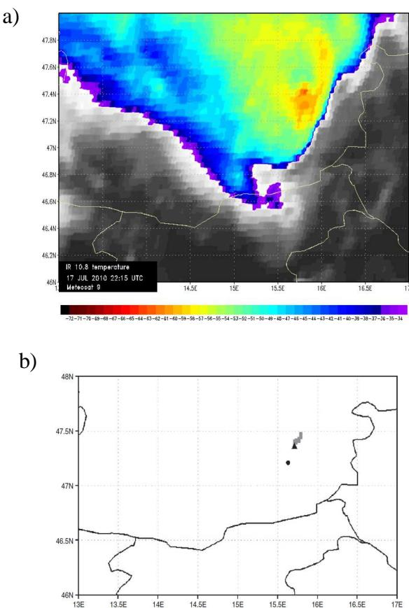
**Slika 4.5:** 17.07.2010., 22:15 UTC: a) Meteosat 9 IR10.8 satelitska snimka gdje boje označavaju određene vrijednosti temperature. Skala boja je u rasponu od  $-33^{\circ}\text{C}$  (ljubičasta) do  $-72^{\circ}\text{C}$  (tamno crvena). b) Lokacija objektivno detektiranog OT-a koristeći COMB metodu (sivi pikseli). Položaj automatske postaje Weiz, Austrija u blizini detektiranog OT-a (točka) i položaj postaje pomaknut prema sjeveroistoku za vrijednost korekcije paralakse (trokutić).
