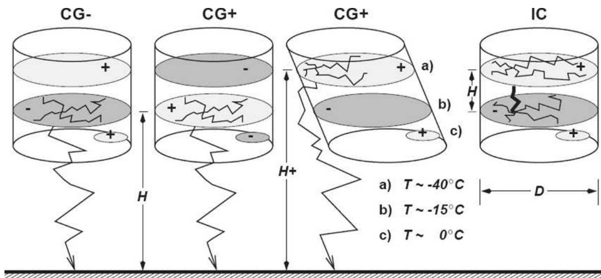
**Slika 2.5:** Konceptualni modeli tipova i polariteta munja (CG od eng. cloud-to-ground, IC od eng. intra-cloud), te raspodjele glavnih slojeva naboјa s naznačenim tipičnim temperaturama pojedinih slojeva. (Betz i sur., 2008).
