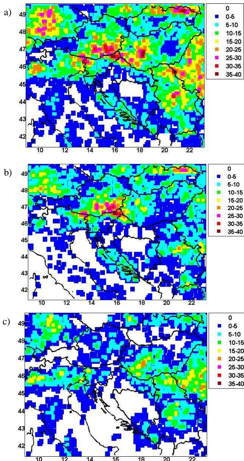
**Slika 4.3:** Broj OT-a izračunat korištenjem COMB satelitske metode na prostornoj mreži rezolucije  $0.2^\circ \times 0.2^\circ$  za razdoblje od svibnja do rujna 2009. i 2010. godine. a) Svi detektirani OT-ovi, b) broj detektiranih OT-ova od 09:00 do 21:00 LST (UTC + 2) i c) broj detektiranih OT-ova od 21:00 do 09:00 LST (UTC + 2).
