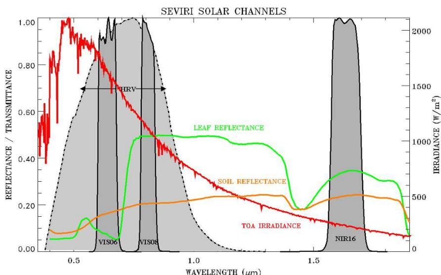
**Slika 3.3:** Područje valnih duljina HRV kanala (svijetlo sivo) i valnih duljina VIS0.6, VIS0.8 i NIR1.6 kanala (tamno sivo), te raspodjela valnih duljina reflektiranog zračenja od tla (narančasta linija) i vegetacije (zelena linija). Solarno zračenje na vrhu atmosfere prikazano je crvenom linijom. Na x osi nalaze se vrijednosti valnih duljina, dok su na y osi reflektirano zračenje (lijevo) i zračenje (desno) (prilagođeno iz *MSG Interpretation Guide*).
