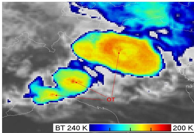
**Slika 3.6:** Satelitska snimka IR10.8 (Meteosat 9, 28.08.2007, 17:15 UTC, sjeverna Italija) na kojoj različite boje označavaju intervale vrijednosti temperature na vrhovima konvektivnih oblaka. Skala boja prilagođena je za detekciju karakterističnih struktura (OT, hladni prsten, hladni U/V) na vrhovima konvektivnih oblaka na području Europe (prilagođeno iz ppt prezentacije Martina Setváka, 2012).
