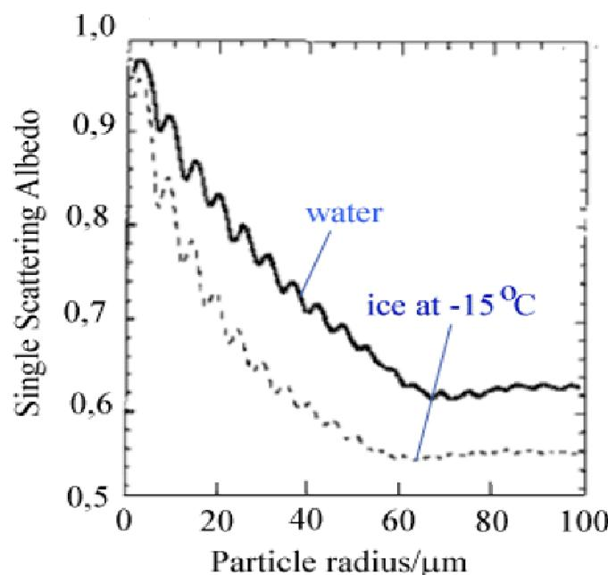
**Slika 3.10:** Refleksivnost u IR3.9 u ovisnosti o efektivnom radijusu čestica za led na  $-15^{\circ}\text{C}$  (isprekidana linija) i vodu (puna linija) (preuzeto s *Eumetrain Training Module: Icing*<sup>4</sup>).
