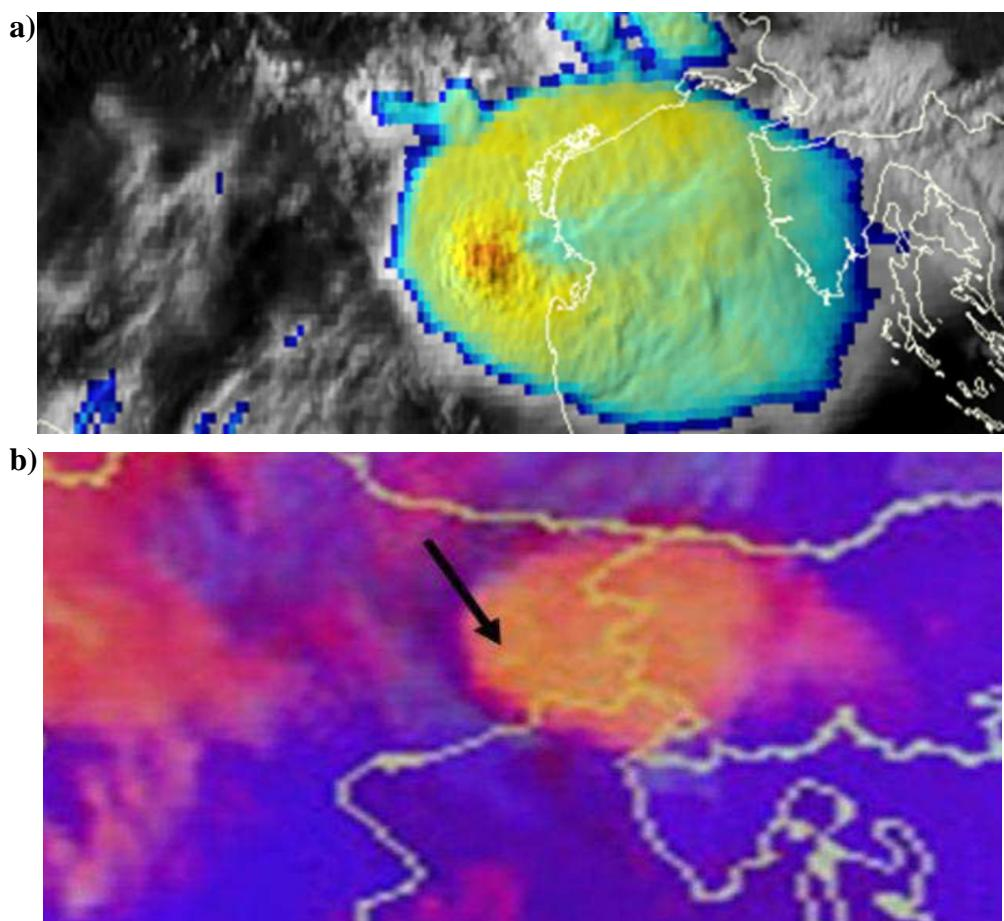
**Slika 3.7:** a) "Sandwich" produkt (Meteosat 8, 06.07.2010., 17:05 UTC, sjeverni Jadran) koji daje informaciju o 3D strukturi vrhova promatrane konvektivne ćelije te o razdiobi temperature na vrhovima iste. b) "Convective storm" RGB produkt (Meteosat 9, 12.09.2012., 08:50 UTC, sjeverna Italija i Slovenija); konvektivna ćelija je narančasto žučkaste boje, a područje OT-a označeno je strelicom.
