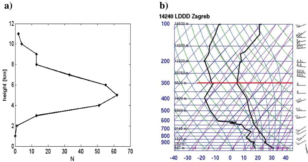
**Slika 4.24:** a) Raspodjela broja IC munja po visini za tučnosnu oluju 11.07.2012. godine i b) termodinamički dijagram (eng. skew-T log-P) za podatke radiosondaže postaje Zagreb u 12:00 UTC 11.07.2012. godine. Nivo tropopauze označen je crvenom linijom.
