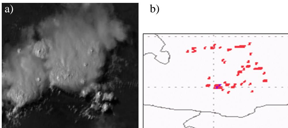
**Slika 4.2:** a) Meteosat 9 (26.05.2009, 15:00 UTC, Austrija) HRV satelitska snimka i b) WV-IRW objektivna satelitska metoda za detekciju OT-a (crveni pikseli predstavljaju detektirano područje OT-a). Vidljive su pogrešne detekcije iznad nakovnja Cb-a u području hladnih cirusnih perjanica.
