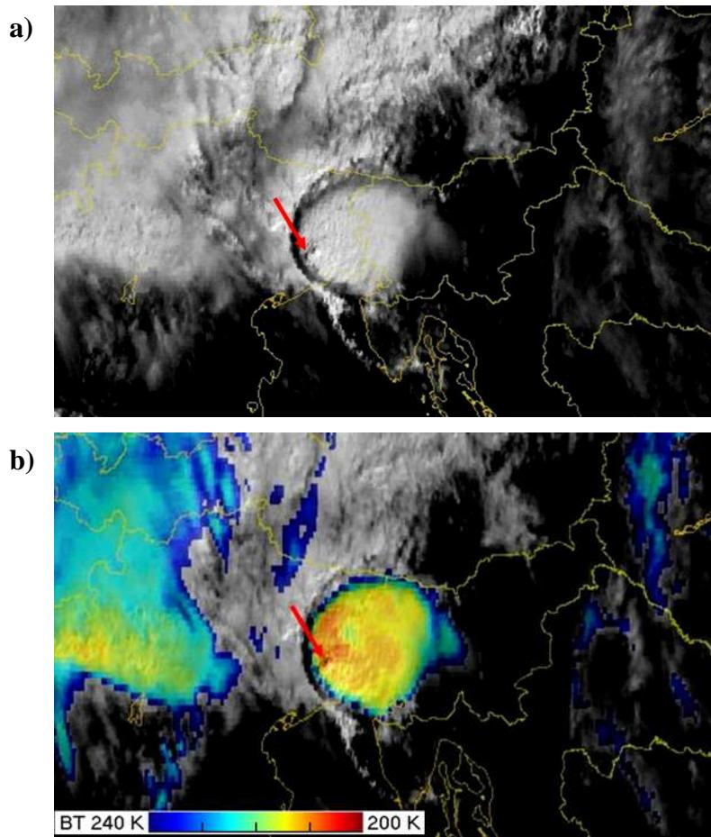
**Slika 2.3:** Meteosat 9, 12.09.2012, 08:50 UTC, Slovenija i Italija **a)** Satelitska snimka u vidljivom dijelu spektra prostorne rezolucije 1 km. **b)** "Sandwich" produkt - satelitska snimka u vidljivom dijelu spektra prostorne rezolucije 1 km iznad koje je prikazana poluprozirna IR10.8 snimka. Crvenom strelicom označen je položaj OT-a na obje slike.
