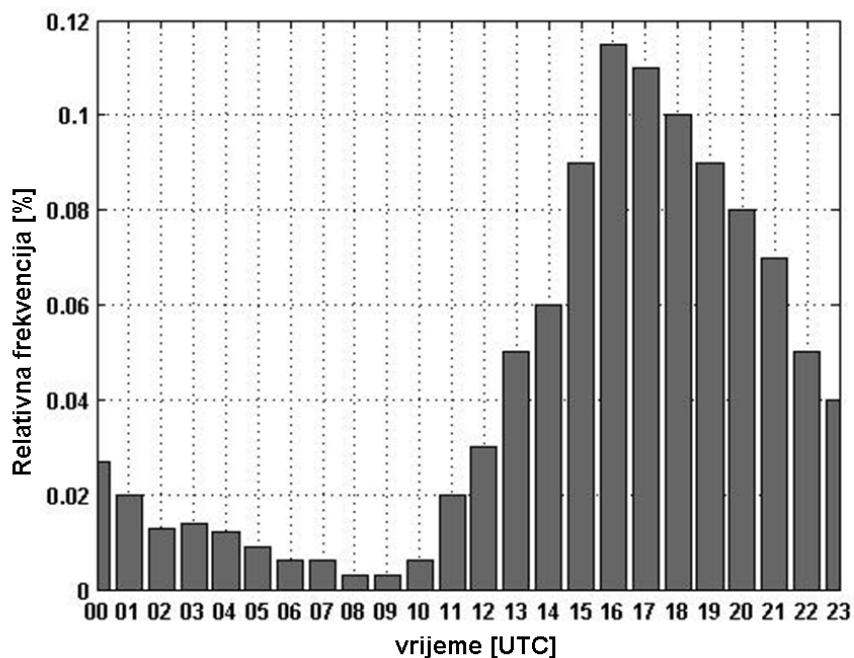
**Slika 4.4:** Vremenska raspodjela OT-ova detektiranih COMB objektivnom satelitskom metodom. Broj OT-ova u hh UTC je suma svih OT-ova detektiranih u intervalu od hh UTC do hh:45 UTC (podaci iz četiri SEVIRI snimke).
