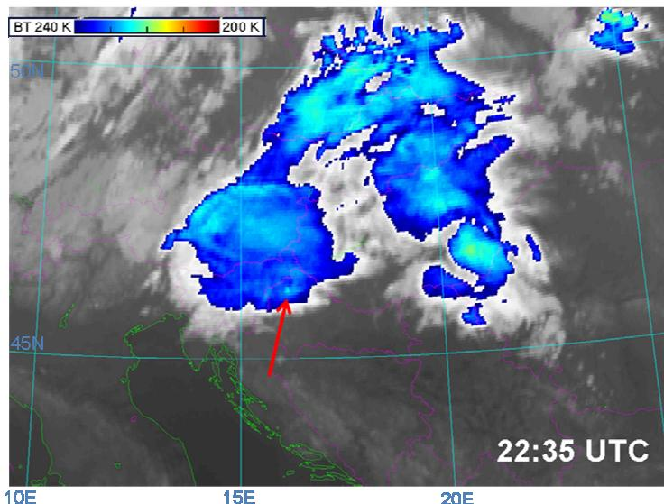
**Slika 4.21:** Meteosat 8 IR10.8 satelitska snimka gdje boje predstavljaju vrijednosti temperature 11.07.2012. godine u 22:40 UTC. Crvena strelica označava područje hladnije od okolnih piksela koje predstavlja potencijalni OT iznad područja poligona tučomjera.
