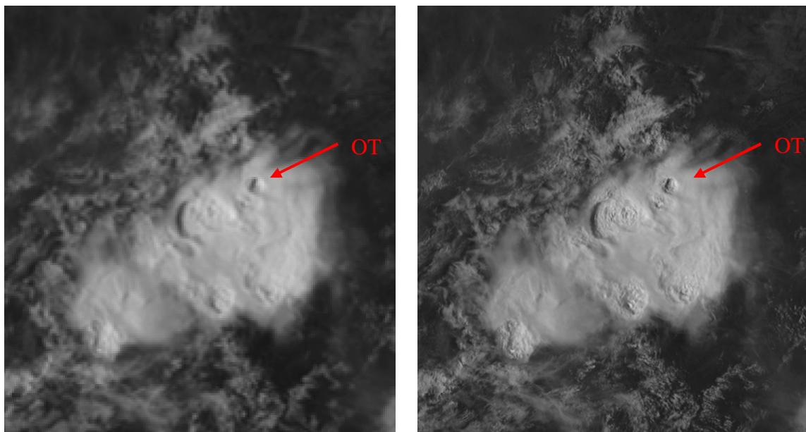
**Slika 3.4:** Usporedba karakteristika vrhova konvektivnih oblaka na snimci u kanalu VIS0.6 (Meteosat 8, 24.04.2003., 08:00 UTC, Nigerija), koji ima prostornu razlučivost od 3 km u nadiru (lijeva slika) i kanalu HRV prostorne razlučivosti 1 km (desna slika). Na HRV satelitskoj snimci 3D struktura vrhova je jasnija i pokazuje znatno više detalja (crvenom strelicom označen je položaj OT-a) (prilagođeno iz *MSG Interpretation Guide*).
