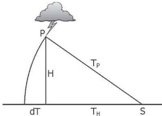
**Slika 3.15:** Princip prepoznavanja IC munja koristeći VLF/LF senzore. Elektromagnetsko zračenje od IC i CG munja s određene lokacije u dvodimenzionalnom polju dolazi do senzora u različitom vremenskom intervalu, tj. signal od IC munja putuje malo duže:  $dT = T_P - T_H$ , pri čemu je P središte VLF zračenja, S lokacija senzora i H visina s koje dolazi VLF zračenje kod IC munja (preuzeto iz Betz i sur., 2008).
