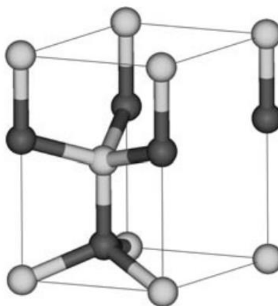
Slika 6 (preuzeto iz [142]): Jedinična ćelija kristalne strukture vurtita. Svjetle kuglice: kisik, tamne kuglice: cink
