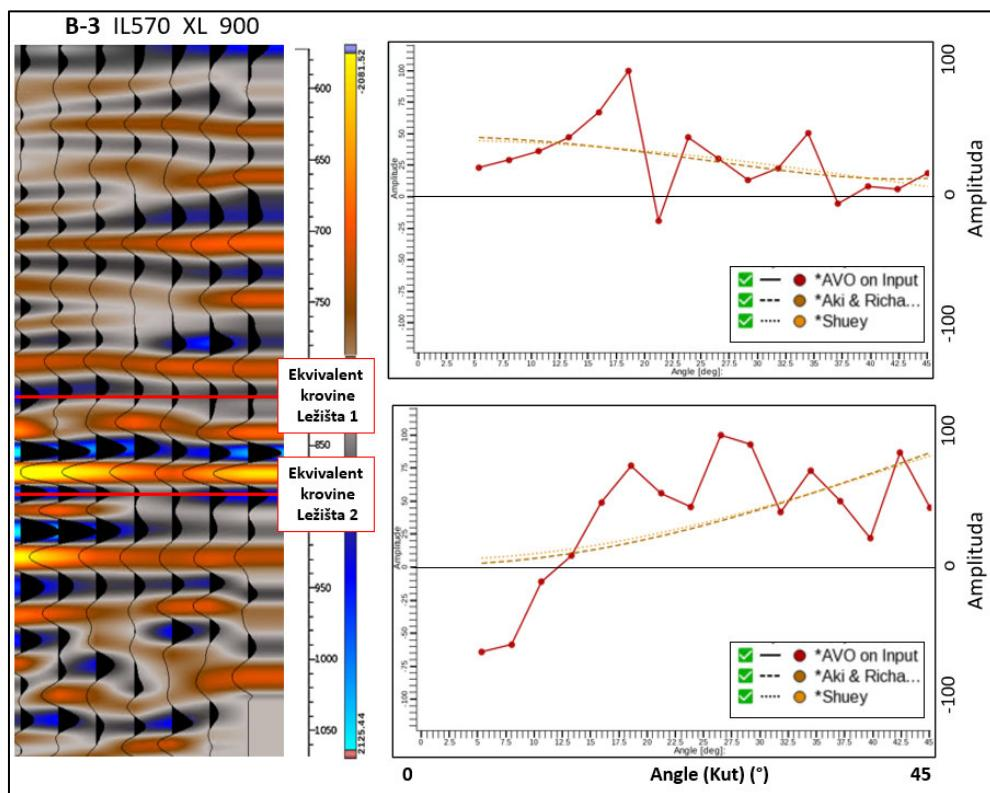
Slika 8.4.4.6. Angle gather na bušotini B-3 te pripadajući dijagrami ponašanja amplitude u odnosu na kut od  $45^\circ$  za ekvivalente krovina Ležišta 1 i Ležišta 2
