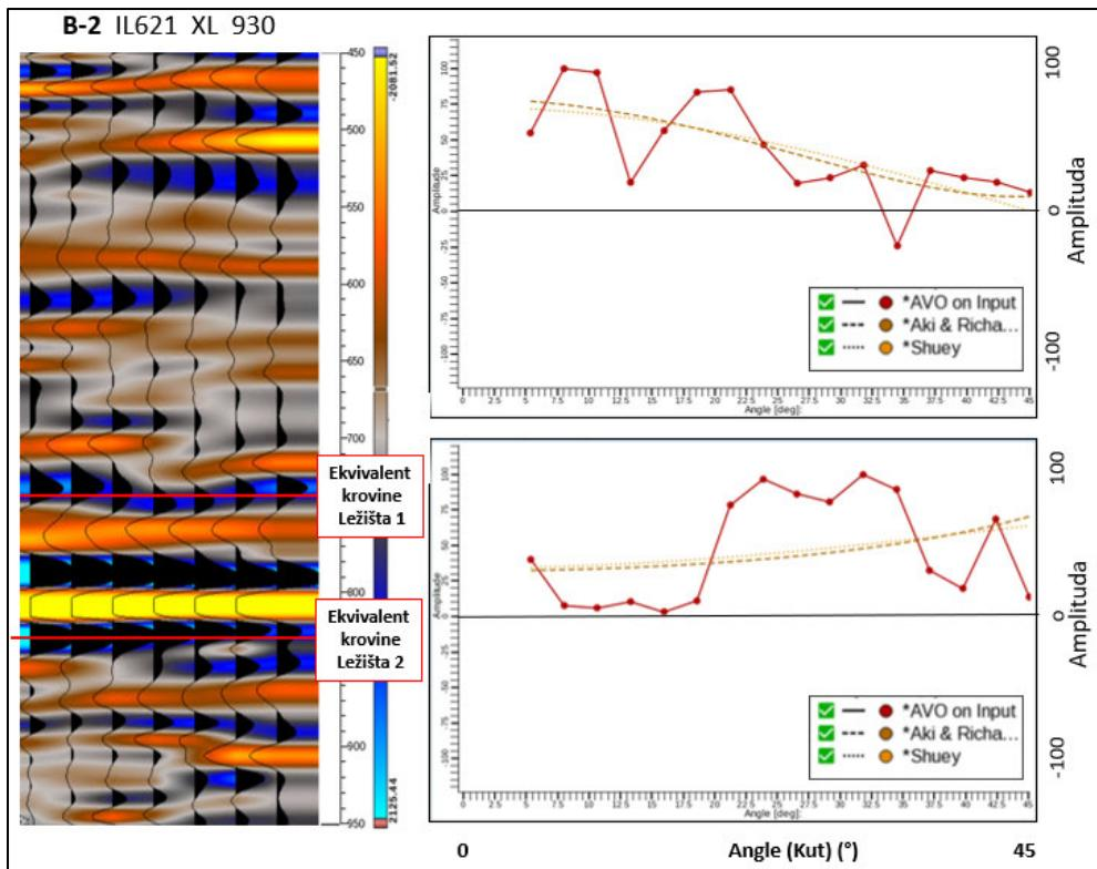
Slika 8.4.4.5. Angle gather na bušotini B-2 te pripadajući dijagrami ponašanja amplitude u odnosu na kut od  $45^\circ$  za ekvivalente krovina Ležišta 1 i Ležišta 2
