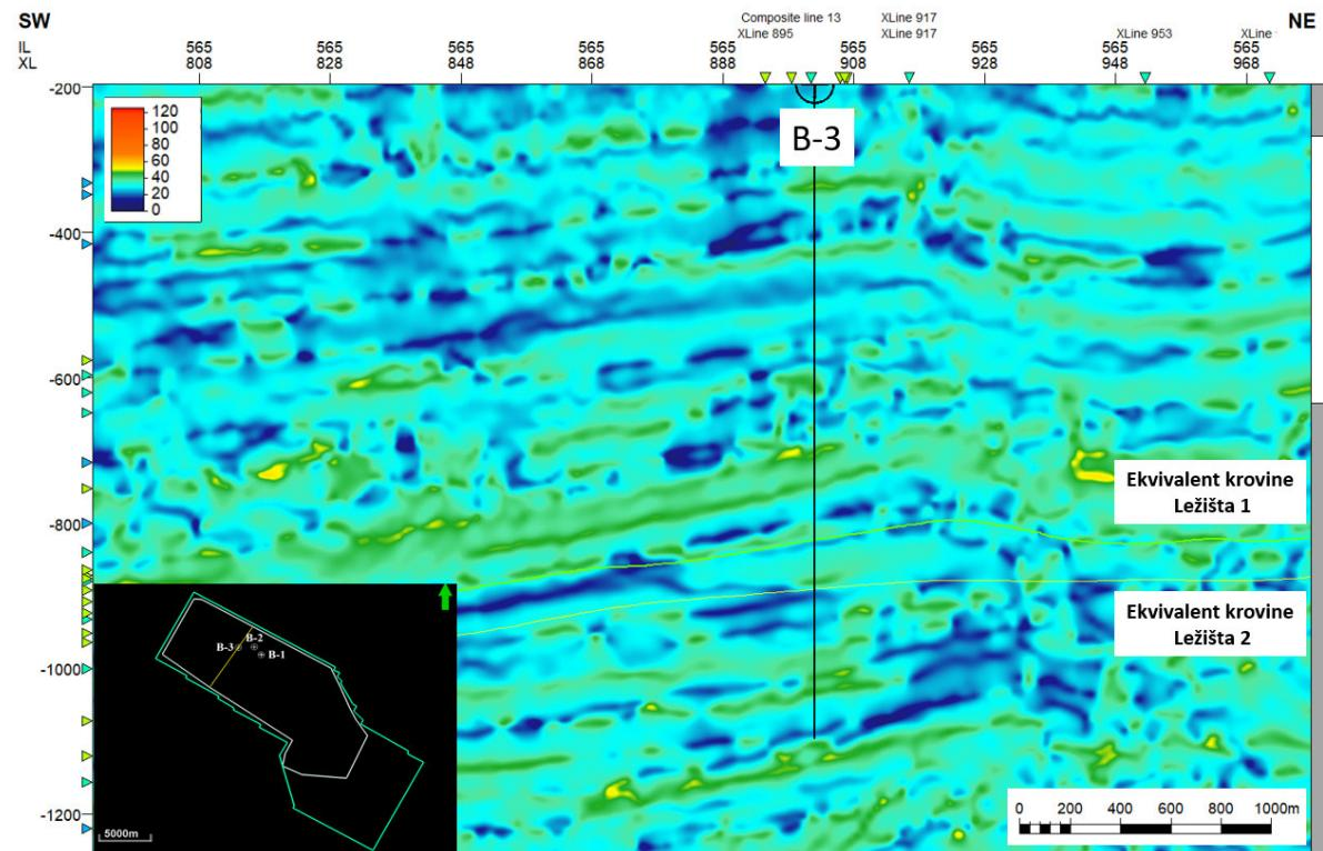
Slika 8.2.2.3: Atribut trenutne frekvencije – profil kroz bušotinu B-3 (plava boja prikazuje područja niskih frekvencija koja mogu ukazivati na razlomljene zone ili ili niskofrekveničku sjenu)
