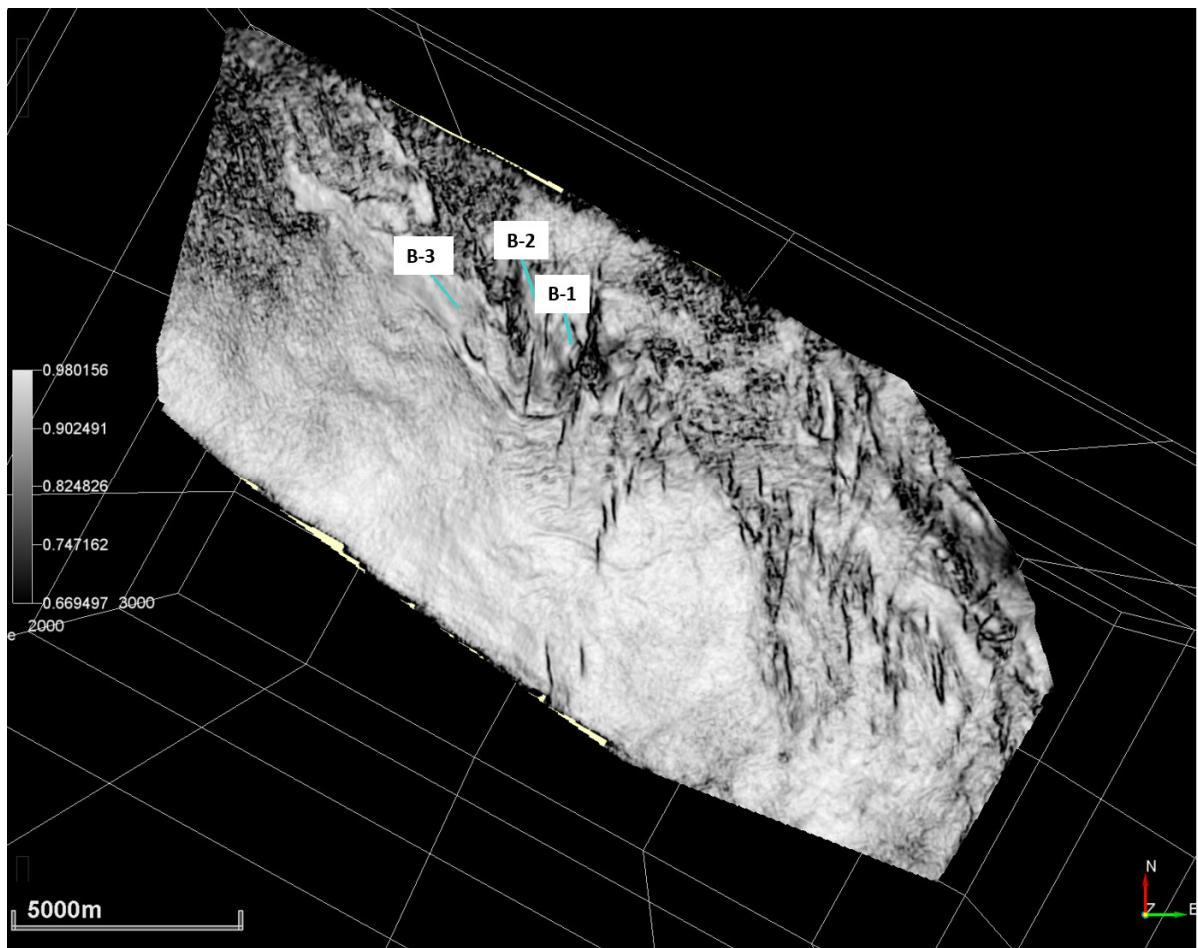
*Slika 8.2.4.2.: Atribut koherencije po horizontu krovine Ležišta 2 i njihovih ekvivalenta (Visoka razina sličnosti u bijeloj i sivoj boji prikazuje značajke kao što su kanali, a niska razina u tamnim nijansama sive i crnoj boji razlomljene zone i rasjede).*
