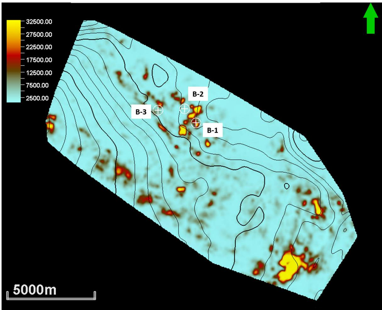
Slika 8.3.3.2. Ekstrahirana RMS amplituda na kombiniranom AVO atributu (Far -Near) \* Far po krovini Ležišta 2 (područja povišenih vrijednosti amplituda u rasponu od crvene do žute boje na prikazanoj skali ističu AVO anomalije klase II & III i mogu ukazivati na eventualno zasićenje ugljikovodicima)
