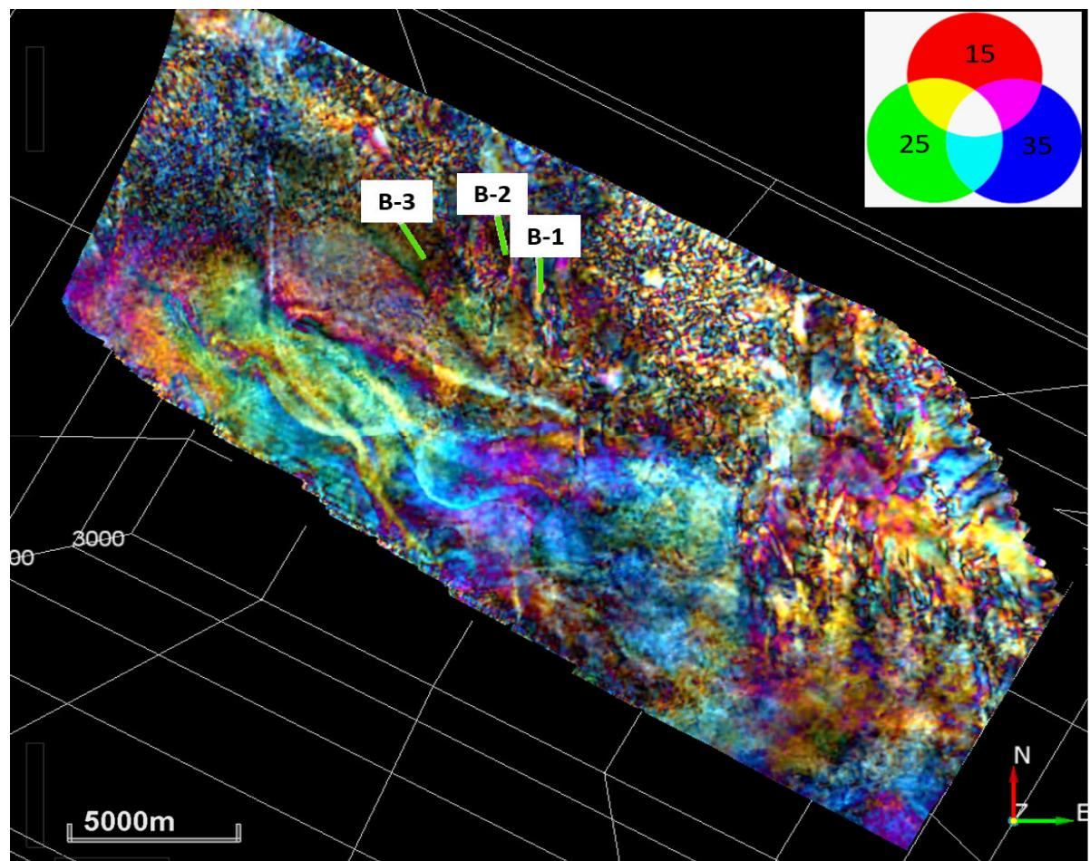
*Slika 8.3.5.1.: Spektralna dekompozicija po horizontu krovine Ležišta 1 (preklapanja boja prikazana su kao najniži frekvencijski raspon u seizmičkom skupu podataka u crvenoj boji-15 Hz, dominantna frekvencija u zelenoj boji-25 Hz i najviše frekvencije u plavoj boji- 35 Hz, a predstavljaju bolju predodžbu kontinuiteta kanalnih tijela i moguću kvalitetu rezervoara).*
