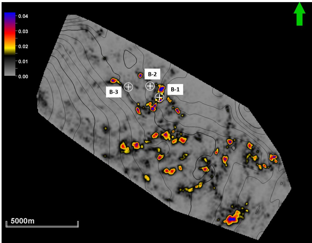
*Slika 8.3.2.4.: RMS amplituda na volumenu Intercept \* Gradient po krovini Ležišta 2(područja povišenih vrijednosti amplituda u rasponu od crvene do plave boje na prikazanoj skali mogu ukazivati na eventualno zasićenje ugljikovodicima)*
