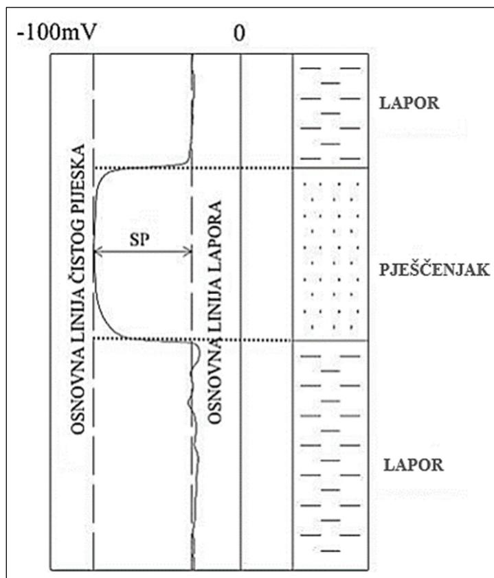
*Slika 6.7.1.1.1. Izgled krivulje spontanoga potencijala s pripadajućim osnovnim linijama te probušenim litološkim sastavom. Niže vrijednosti ukazuju na propusne stijene (preuzeto iz Balic, 1993)*
