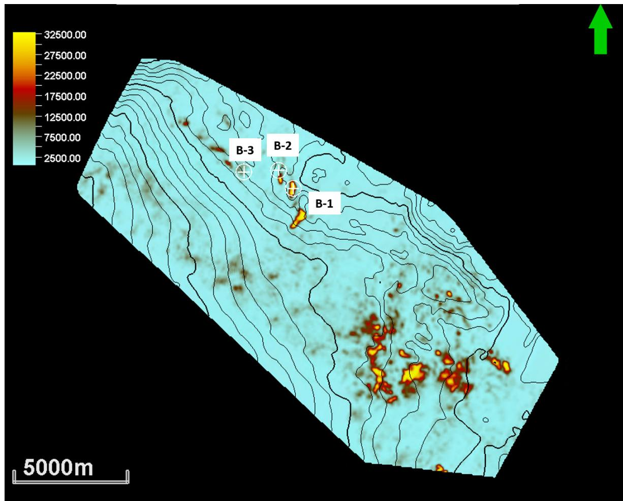
*Slika 8.3.3.1. Ekstrahirana RMS amplituda na kombiniranom AVO atributu (Far -Near) \* Far po krovini Ležišta 1 (područja povišenih vrijednosti amplituda u rasponu od crvene do žute boje na prikazanoj skali ističu AVO anomalije klase II & III i mogu ukazivati na eventualno zasićenje ugljikovodicima)*
