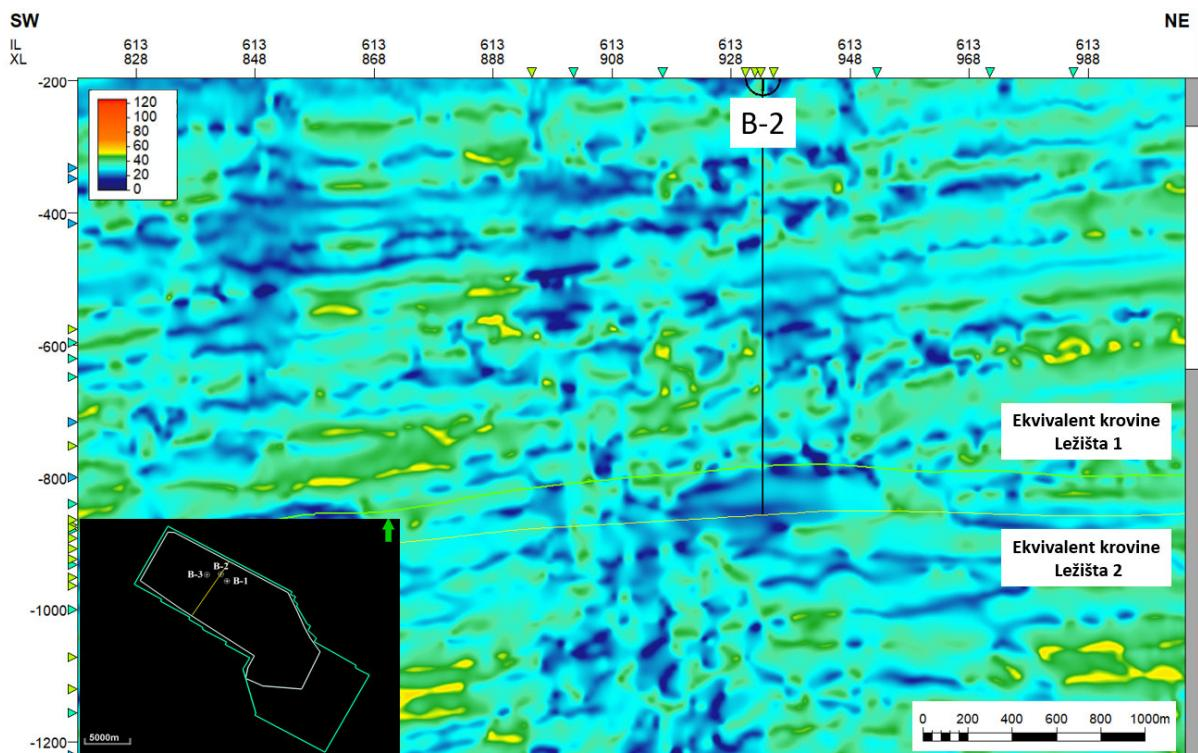
Slika 8.2.2.2: Atribut trenutne frekvencije – profil kroz bušotinu B-2 (plava boja prikazuje područja niskih frekvencija koja mogu ukazivati na razlomljene zone ili ili niskofrekveničku sjenu)
