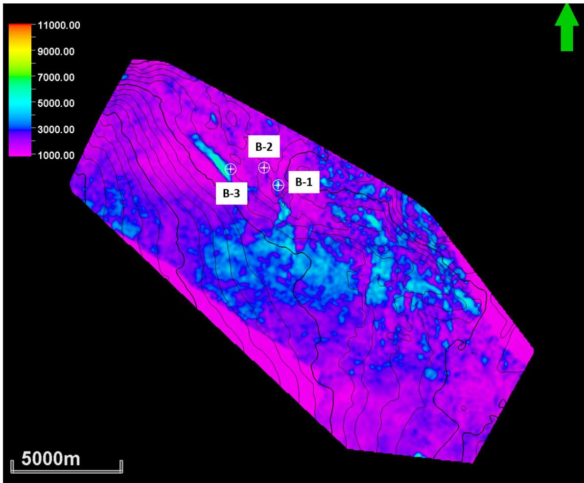
*Slika 8.2.3.1.: RMS amplituda po krovini Ležišta 1 odnosno njegovih litostratigrafskih ekvivalenata (povišene vrijednosti u svjetlo plavoj i zelenoj boji ukazuju na područja boljih rezervoarskih svojstava)*
