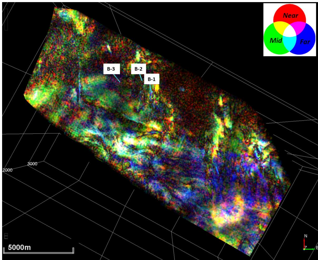
*Slika 8.3.3.3. Kombinirani atribut dobiven AVO RGB blending metodom duž horizonta krovine Ležišta 1 (preklapanje seizmičkih skupova podataka bližih offseta u crvenoj, srednjih u zelenoj i dalekih u plavoj boji jasnije ističe kontinuitet kanalnih tijela i razlomljene zone)*
