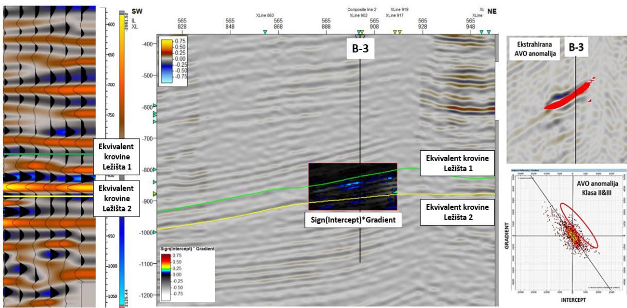
*Slika 8.4.3.1.: AVO analiza na bušotini B-3 (na gatheru lijevo vidljivo je povećanje amplitude s offsetom duž krovine Ležišta 2, a na prekloprenom volumenu  $Sign(intercept) * gradient$  u sredini povećane vrijednosti amplituda koje su na križnom dijagramu Intercept/Gradient desno dolje zaokružene kao AVO klasa II i III što ukazuje na zasićenje ugljikovodicima u ovom slučaju u malim postocima)*
