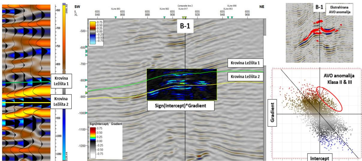
*Slika 8.4.1.1.: AVO analiza na bušotini B-1 (na gatheru lijevo vidljivo je povećanje amplitude s offsetom duž krovina Ležišta 1 i 2, a na preklopjenom volumenu  $\text{Sign}(\text{Intercept}) * \text{gradient}$  u sredini povećane vrijednosti amplituda koje su na križnom dijagramu Intercept/Gradient desno dolje zaokružene kao AVO klasa II i III što ukazuje na zasićenje ugljikovodicima)*
