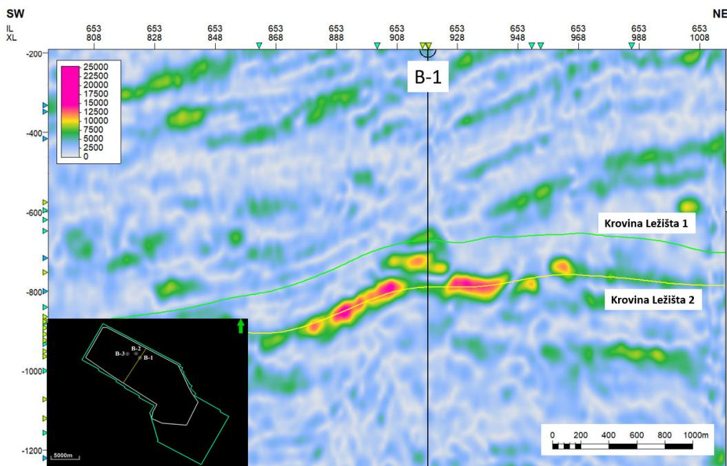
*Slika 8.2.1.1.: Atribut trenutne amplitute – profil kroz buštinu B-1 (žuta i ružičasta boja prikazuju područja visokih amplituda koja mogu ukazivati na zasićenje ugljikovodicima, ali i na litološke promjene)*
