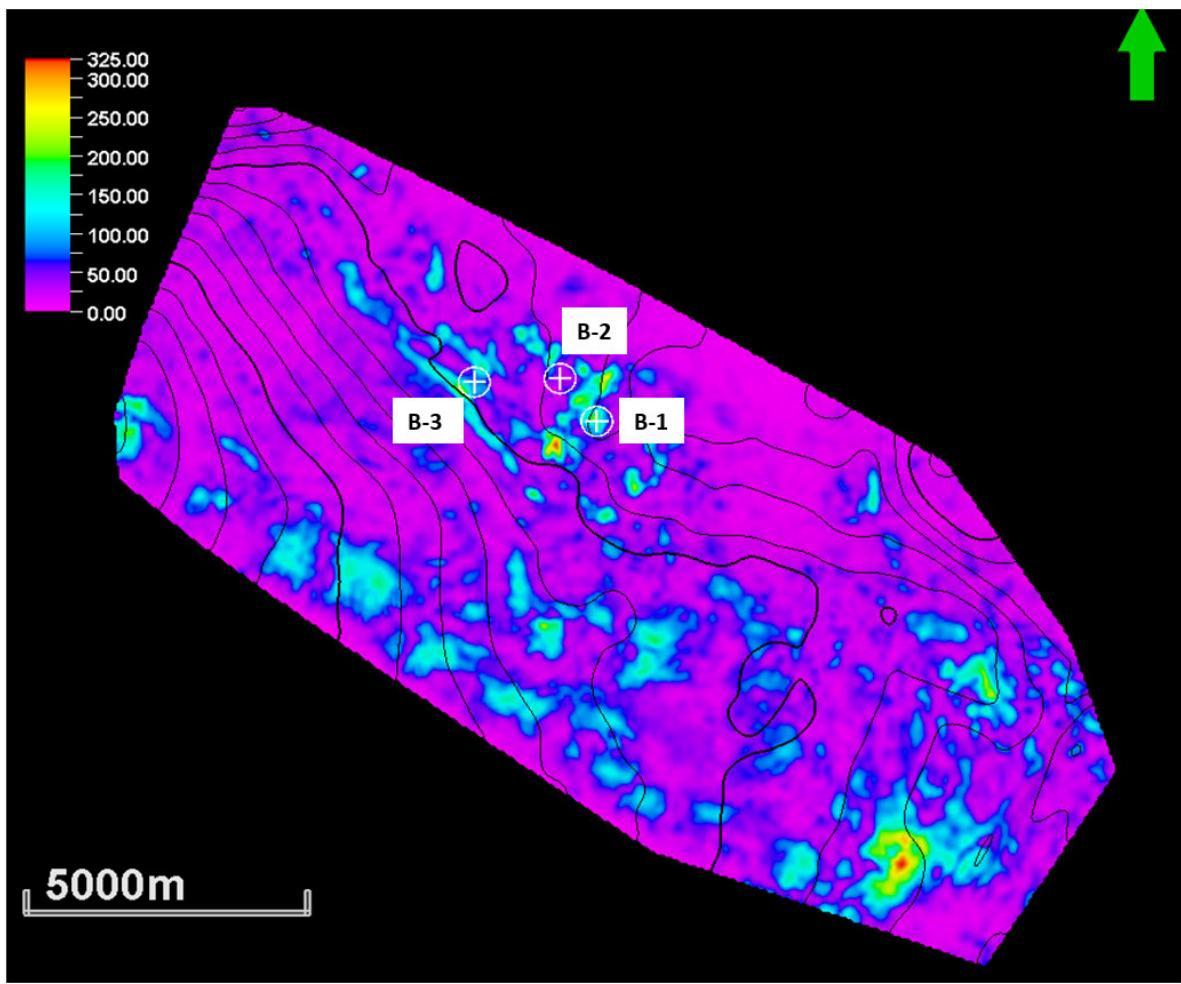
Slika 8.3.3.6. Ekstrahirana RMS amplituda duž horizonta krovine Ležišta 2 na volumenu dalekih offseta (područja povиšenih vrijednosti amplituda u rasponu od zelene do crvene boje na prikazanoj skali mogu ukazivati na eventualno isplativo zasićenje ugljikovodicima)
