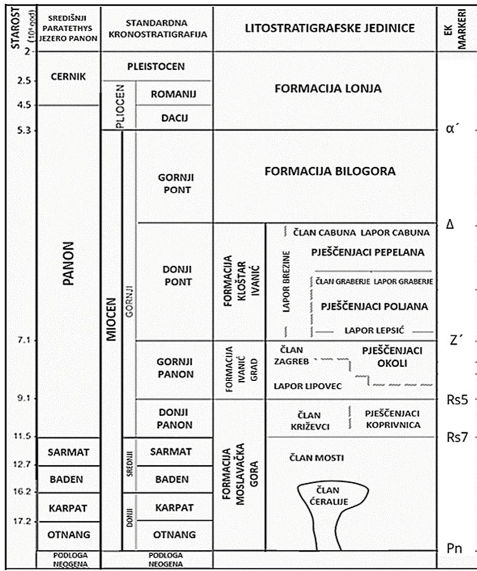
Slika 5.2.1.: Shematski stratigrafski stup zapadnog dijela Dravske depresije (modificirano prema Pavelić & Kovačić, 2018- dodana nova kronostratigrafija, Šimon, 1980 – litostatigradska podjela)
