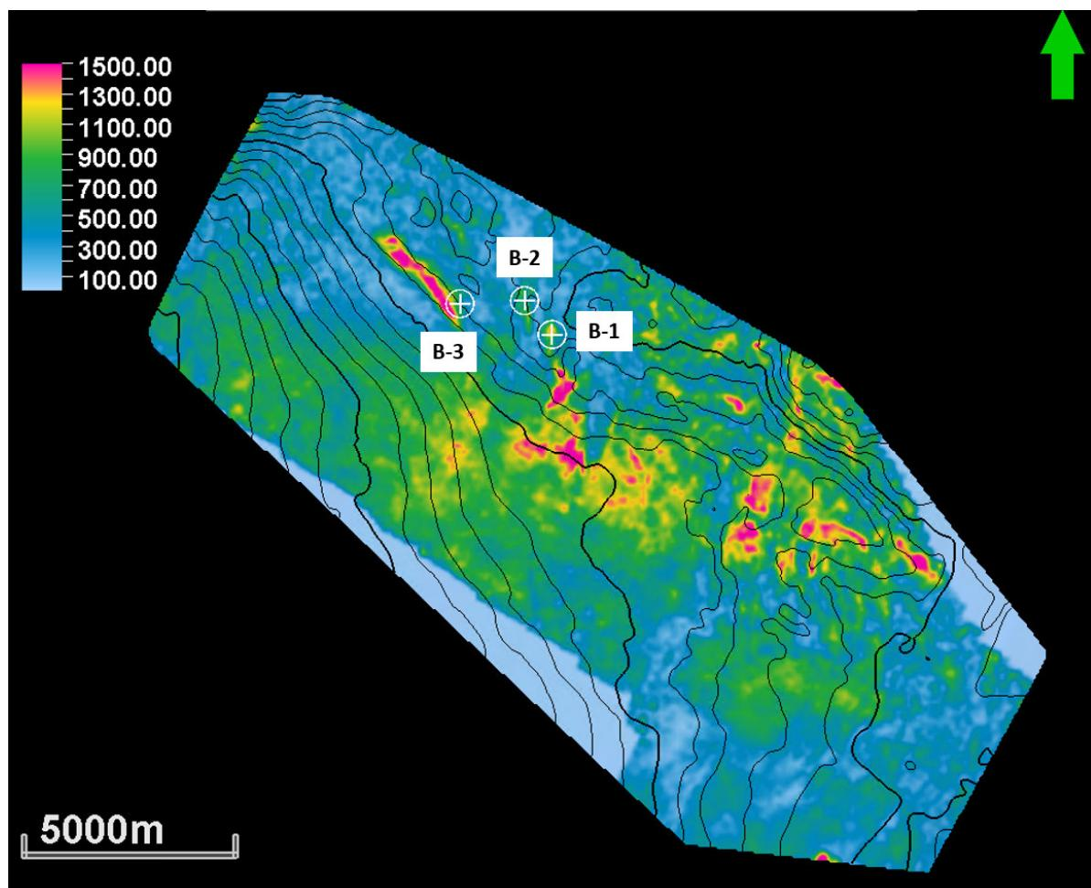
Slika 8.2.7.1.: Ekstrahirana RMS amplituda na seizmičkom volumenu atributa *Sweetness* po krovini Ležišta 1 (Povišene vrijednosti amplituda u žutoj i crvenoj boji prikazuju područja boljih rezervoarskih svojstava)
