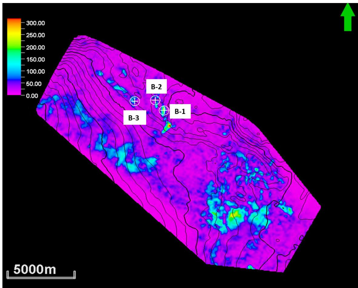
Slika 8.3.3.5. Ekstrahirana RMS amplituda duž horizonta krovine Ležišta 1 na volumenu dalekih offseta (područja povišenih vrijednosti amplituda u rasponu od zelene do crvene boje na prikazanoj skali mogu ukazivati na eventualno isplativo zasićenje ugljikovodicima)
