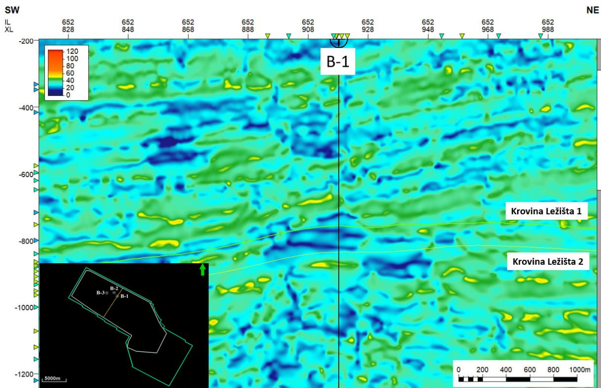
*Slika 8.2.2.1: Atribut trenutne frekvencije – profil kroz buštinu B-1 (plava boja prikazuje područja niskih frekvencija koja mogu ukazivati na razlomljene zone ili niskofrekvencijsku sjenu)*
