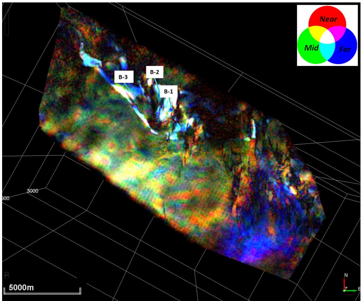
*Slika 8.3.3.4. Kombinirani atribut dobiven AVO RGB blending metodom duž horizonta krovine Ležišta 2 (preklapanje seizmičkih skupova podataka bližih offseta u crvenoj, srednjih u zelenoj i dalekih u plavoj boji jasnije ističe kontinuitet kanalnih tijela i razlomljene zone)*
