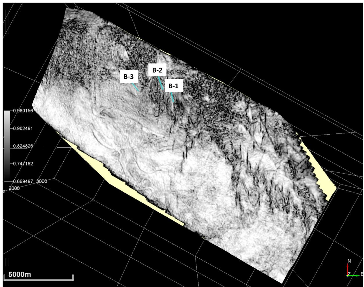
Slika 8.2.4.1.: Atribut koherencije po horizontu krovine Ležišta 1 i njihovih ekvivalenta (Visoka razina sličnosti u bijeloj i sivoj boji prikazuje značajke kao što su kanali, a niska razina u tamnim nijansama sive i crnoj boji razlomljene zone i rasjede).
