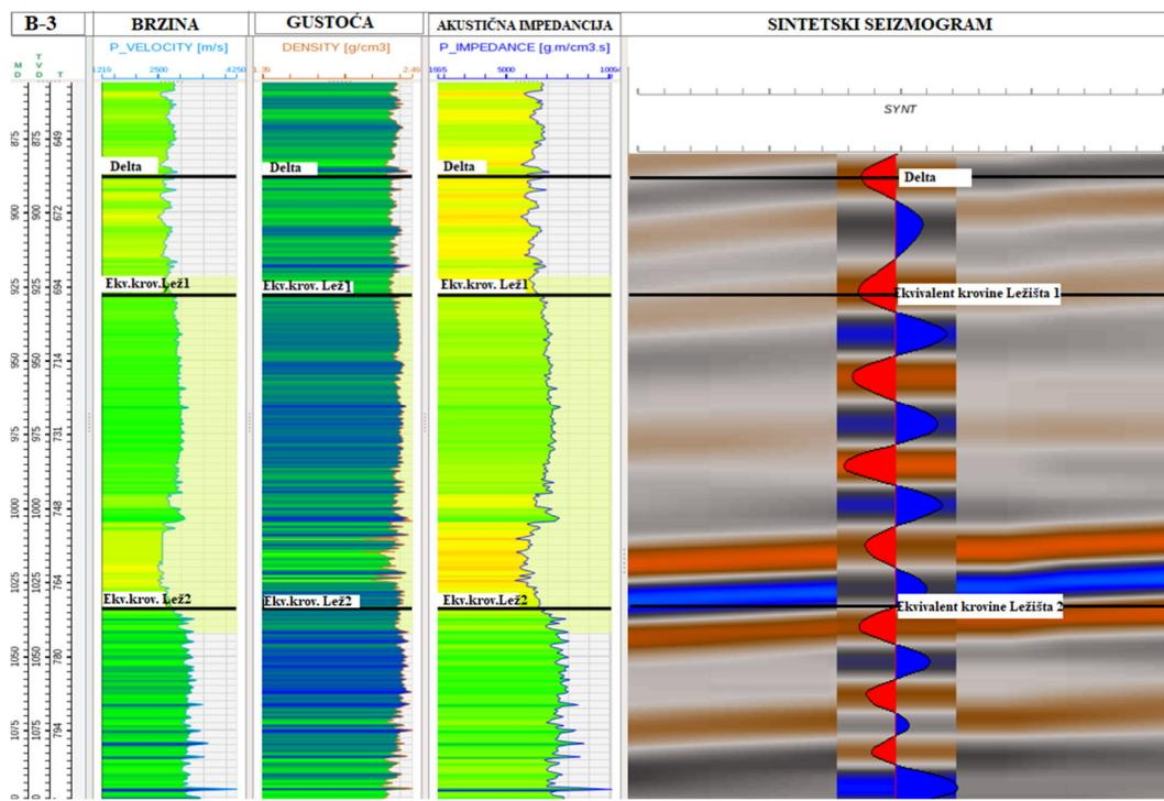
Slika 8.1.1.3.: Sintetski seizmogram za buštinu B-3
