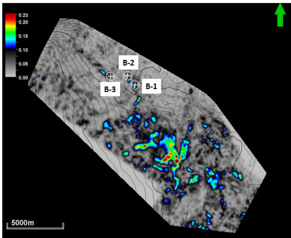
Slika 8.3.2.1.: RMS amplituda na volumenu Sign (intercept) \* gradient po krovini Ležišta 1 (područja povišenih vrijednosti amplituda u rasponu od zelene do crvene boje na prikazanoj skali mogu ukazivati na eventualno zasićenje ugljikovodicima)
