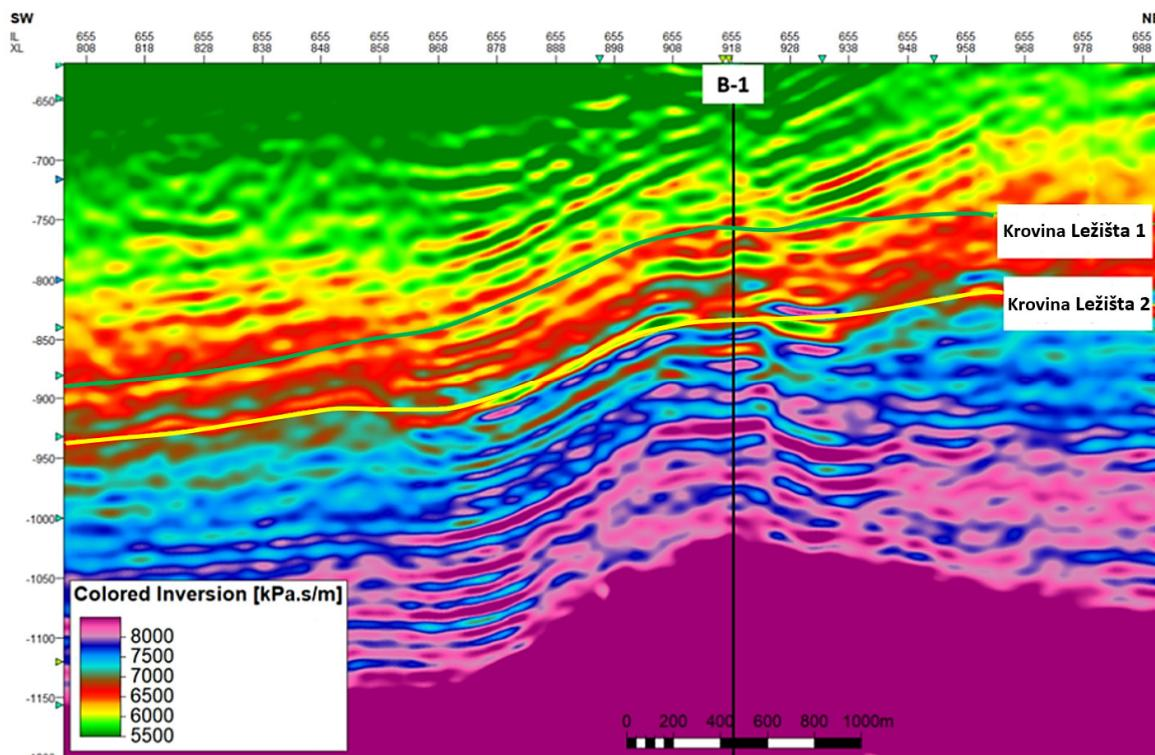
*Slika 8.6.1.: Inverzija u boji na seizmičkom profilu kroz bušotinu B-1 (vrijednosti na skali u ljubičastoj boji prikazuju područja visokih, a u zelenoj niskih akustičnih impedancija. Ugljikovodici smanjuju akustične impedancije, a plića područja se također odlikuju nižim akustičnim impedancijama).*
