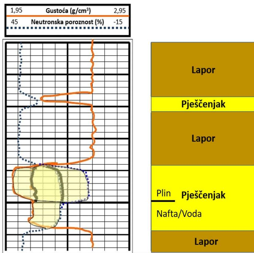
Slika 6.7.1.3.1.: Usporedni prikaz karotažne krivulje gustoće i neutronske poroznosti, te litološkog sastava (modificirano iz [http://rgn.hr/~joresko/nids\\_joresko/Prvi\\_dio/Uvod.pdf](http://rgn.hr/~joresko/nids_joresko/Prvi_dio/Uvod.pdf), 2012)
