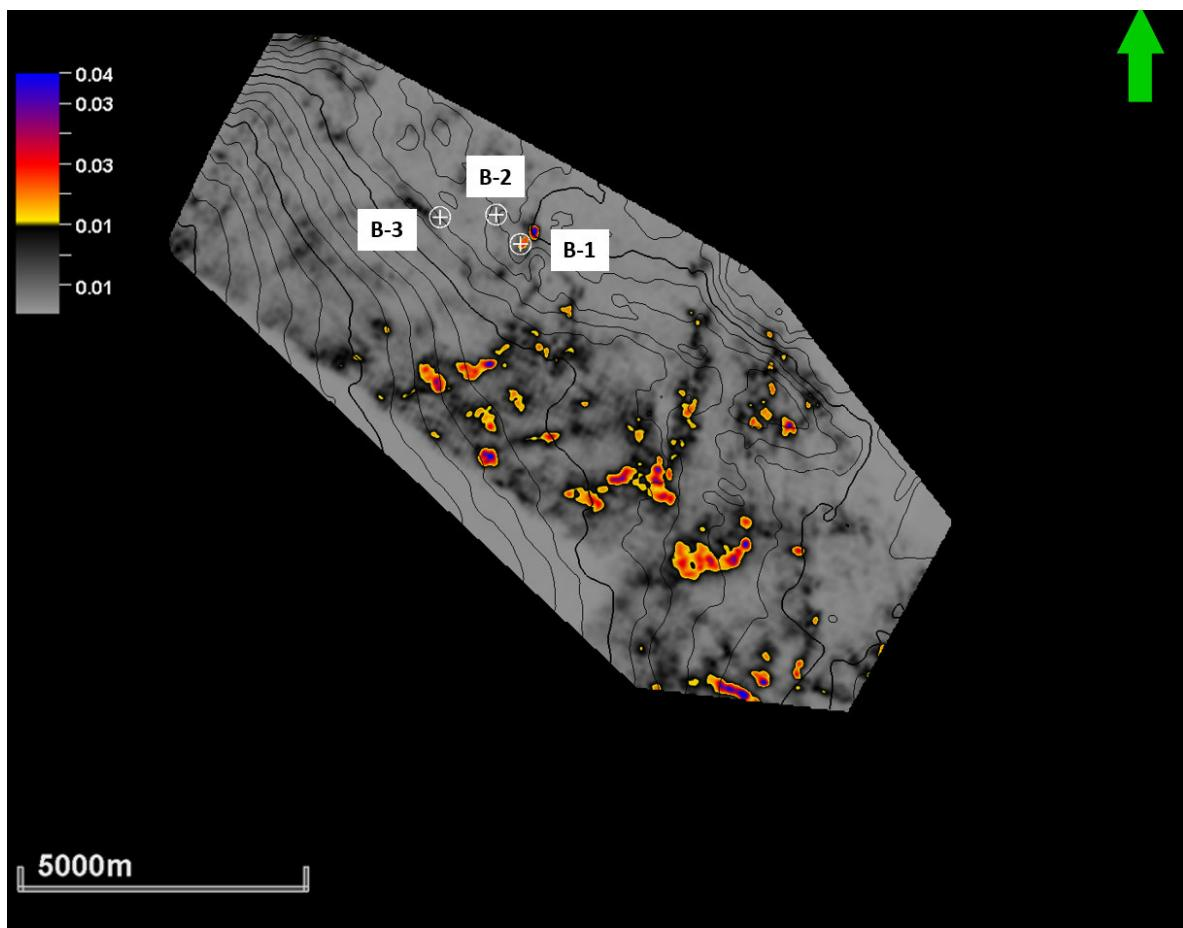
*Slika 8.3.2.3.: RMS amplituda na volumenu Intercept \* Gradient po krovini Ležišta 1 (područja povišenih vrijednosti amplituda u rasponu od crvene do plave boje na prikazanoj skali mogu ukazivati na eventualno zasićenje ugljikovodicima)*
