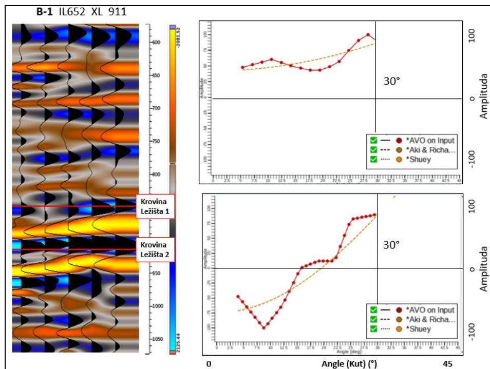
*Slika 8.4.4.1. Angle gather na bušotini B-1 te pripadajući dijagrami ponašanja amplitude u odnosu na kut od  $30^\circ$  za krovinu Ležišta 1 i Ležišta 2*
