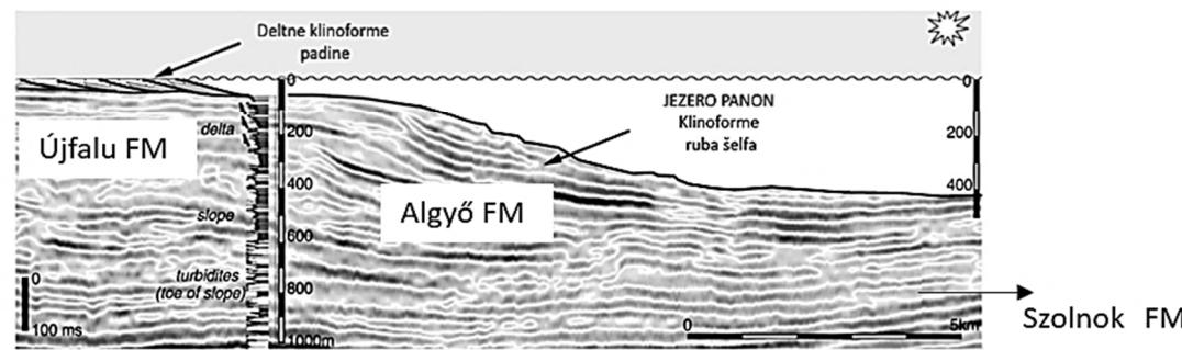
Slika 9.2.1.: Taložni model agradičkih i progradičkih klinoformi turbiditnih sustava Formacije Algyő Mako depresije u Mađarskoj, klinoforme ruba šelfa Formacije Algyő i kombinirani atribut spektralne dekompozicije usporedno s interpretacijom aluvijalne i delte ravnice (preuzeto i modificirano iz Sztanó et.al., 2013).
