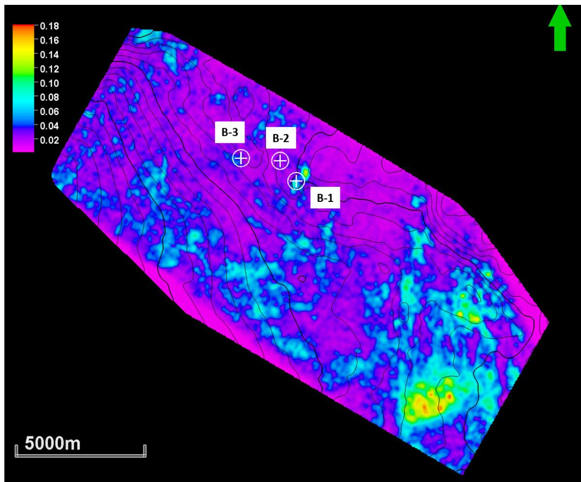
Slika 8.3.1.1.: RMS amplituda na volumenu gradijenta po krovini Ležišta I (područja povišenih vrijednosti amplituda u žutoj, narančastoj i crvenoj boji mogu ukazivati na eventualno zasićenje ugljikovodicima)
