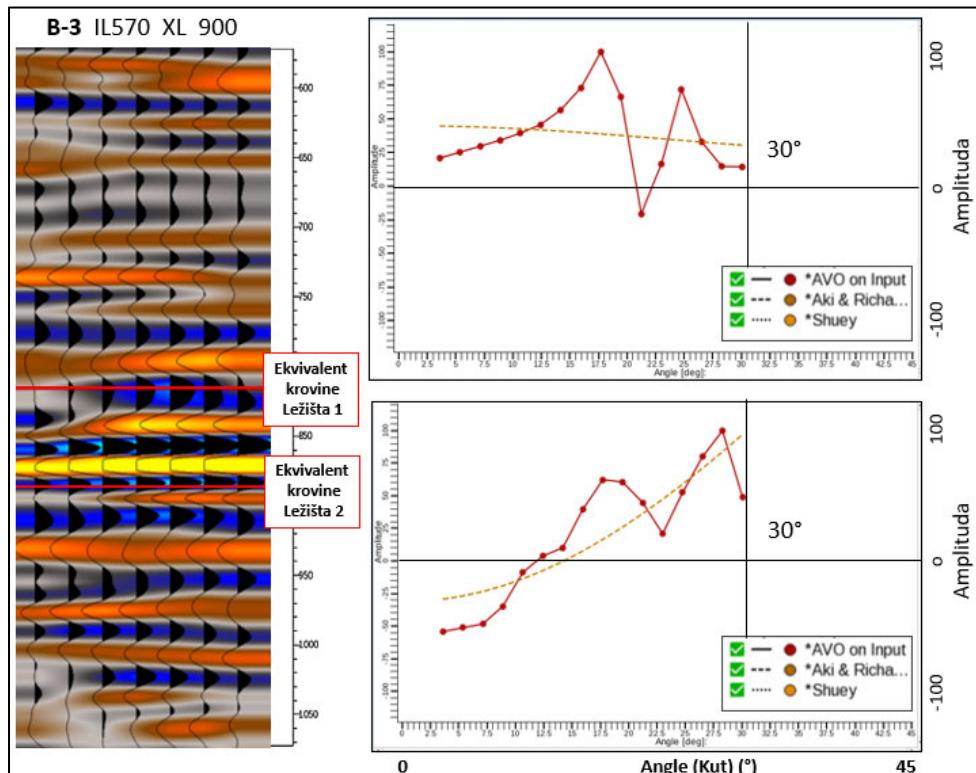
Slika 8.4.4.3.. Angle gather na bušotini B-3 te pripadajući dijagrami ponašanja amplitude u odnosu na kut od  $30^\circ$  za ekvivalente krovina Ležišta 1 i Ležišta 2
