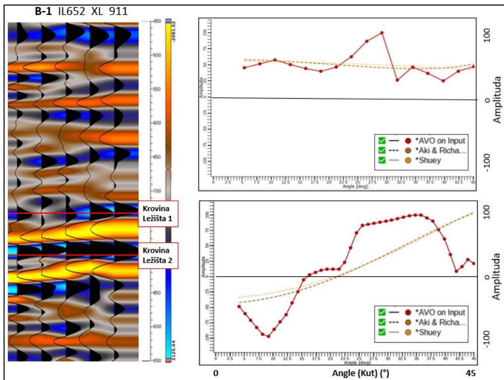
*Slika 8.4.4.4.. Angle gather na bušotini B-1 te pripadajući dijagrami ponašanja amplitude u odnosu na kut od 45° za krovine Ležišta 1 i Ležišta 2*
