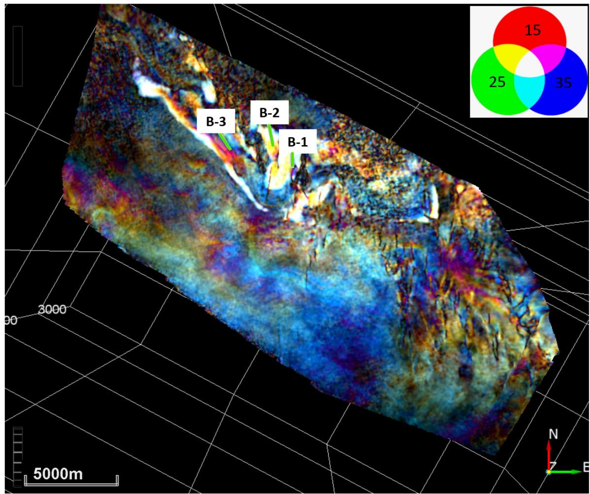
Slika 8.3.5.2.: Spektralna dekompozicija po horizontu krovine Ležišta 2 (preklapanja boja prikazana su kao najniži frekvencijski raspon u seizmičkom skupu podataka u crvenoj boji - 15 Hz, dominantna frekvencija u zelenoj boji - 25 Hz i najviše frekvencije u plavoj boji - 35 Hz, a predstavljaju bolju predodžbu kontinuiteta kanalnih tijela i moguću kvalitetu rezervoara).
