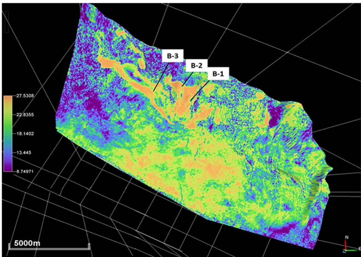
*Slika 8.5.2.2.1: Predviđanje karotažnih krivulja otpornosti (B-1, B-2, B-3) pomoću neuronskih mreža po nivou krovine Ležišta 2 i pripadajućih lithostratigrafskih ekvivalenata (niže vrijednosti u ljubičastoj boji prikazuju niže otpornosti, a više vrijednosti u narančastoj boji više otpornosti.*
