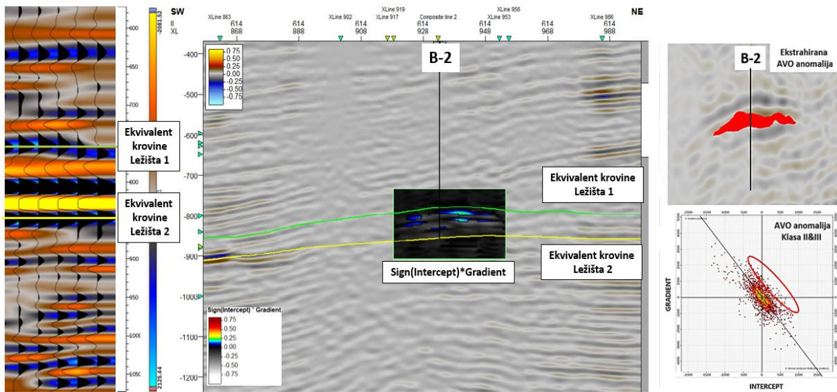
*Slika 8.4.2.2.: AVO analiza na bušotini B-2(na gatheru lijevo je povećanje amplitude s offsetom duž krovine Ležišta 2, a na preklopjenom volumenu  $\text{Sign}(\text{intercept})^*\text{gradient}$  u sredini povećane vrijednosti amplituda koje su na križnom dijagramu  $\text{Intercept}/\text{Gradient}$  desno dolje zaokružene kao AVO klasa II i III što ukazuje na zasićenje ugljikovodicima u ovom slučaju u malim postocima)*
