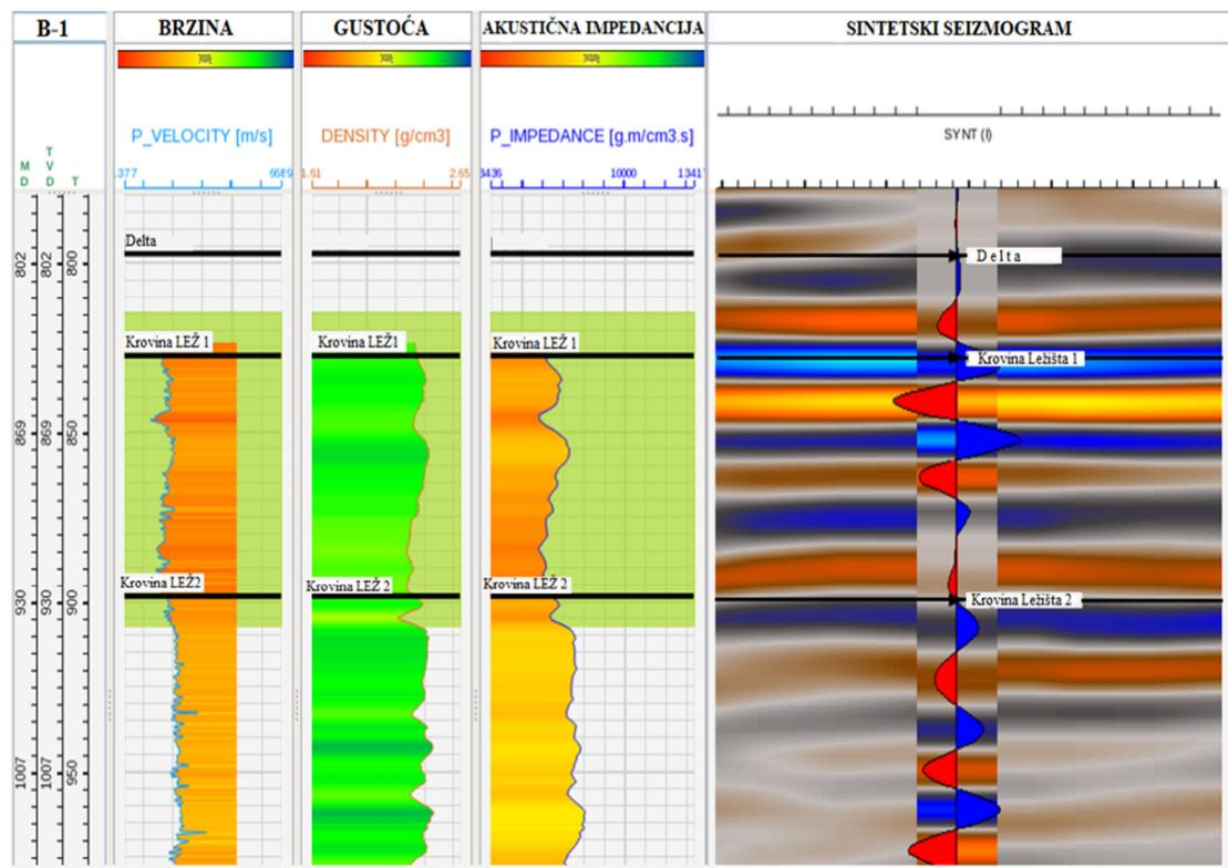
Slika 8.1.1.1.: Sintetski seizmogram za bušotinu B-1
