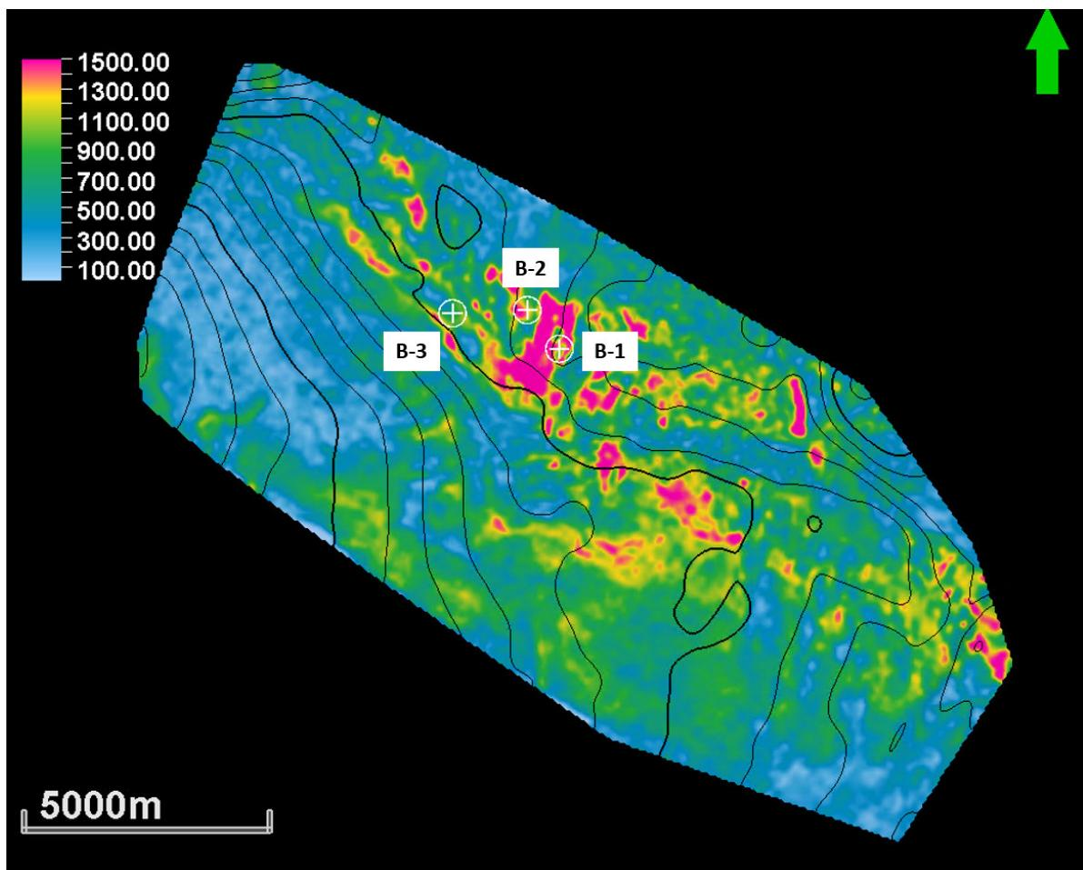
*Slika 8.2.7.2.: Ekstrahirana RMS amplituda na seizmičkom volumenu atributa Sweetness po krovini Ležišta 2 (Povišene vrijednosti amplituda u žutoj i crvenoj boji prikazuju područja boljih rezervoarskih svojstava)*
