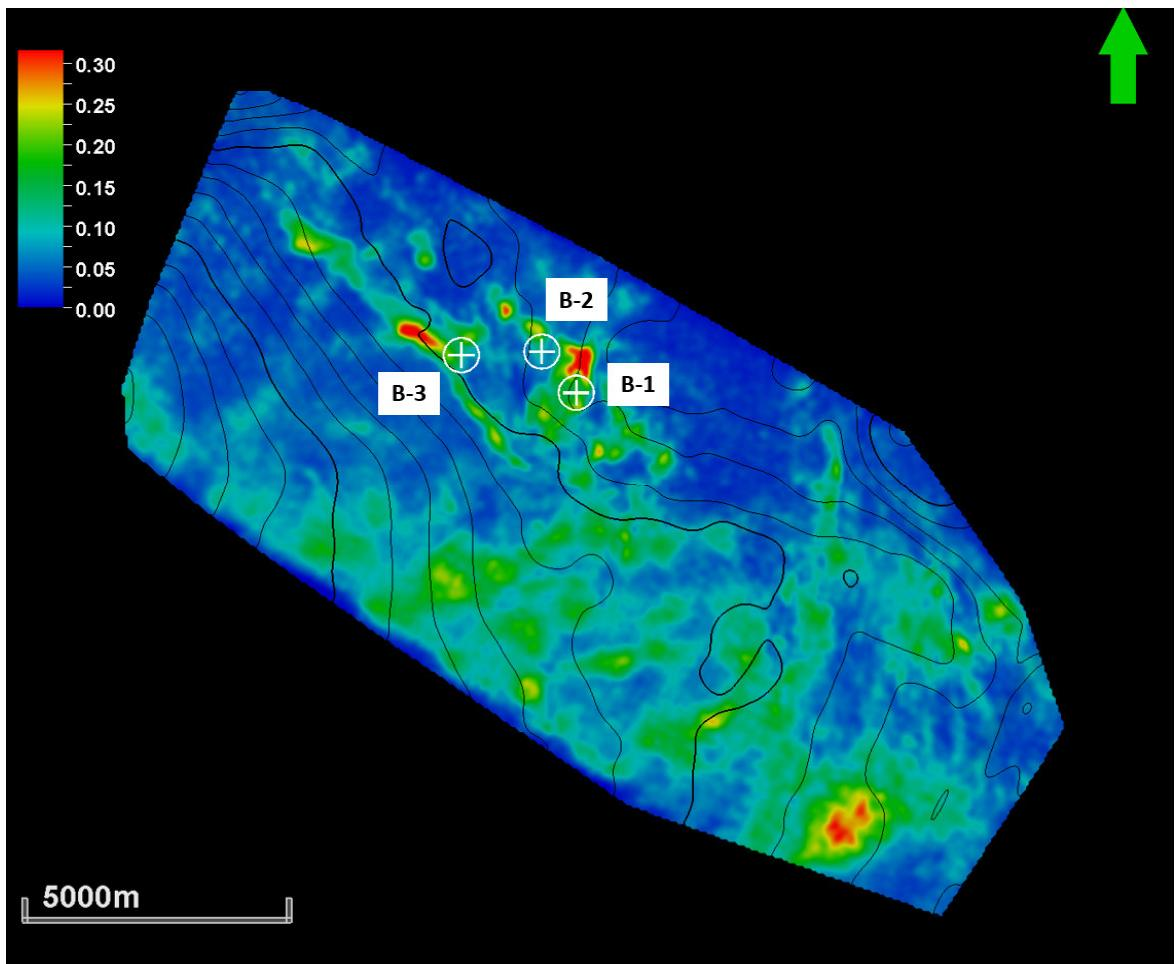
Slika 8.3.2.6.: RMS amplituda na volumenu atributa AVO snaga po krovini ekvivalent Ležišta 2 (područja povišenih vrijednosti amplituda u u zelenoj boji na prikazanoj skali mogu ukazivati na bolja rezervoarska svojstva i žutoj i crvenoj na eventualno zasićenje ugljikovodicima)
