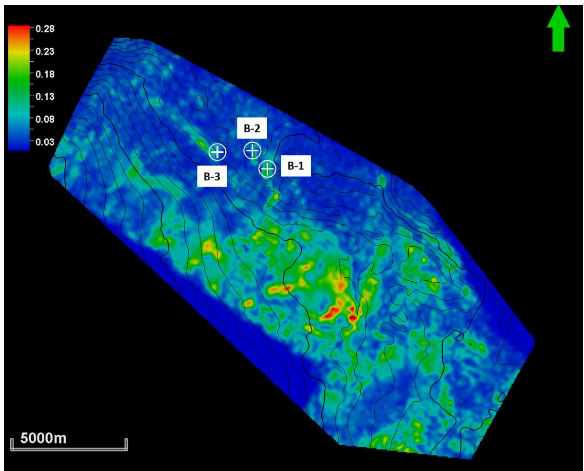
Slika 8.3.2.5.: RMS amplituda na volumenu atributa AVO snaga po krovini Ležišta 1 (područja povišenih vrijednosti amplituda u u zelenoj boji na prikazanoj skali mogu ukazivati na bolja rezervoarska svojstva i žutoj i crvenoj na eventualno zasićenje ugljikovodicima)
