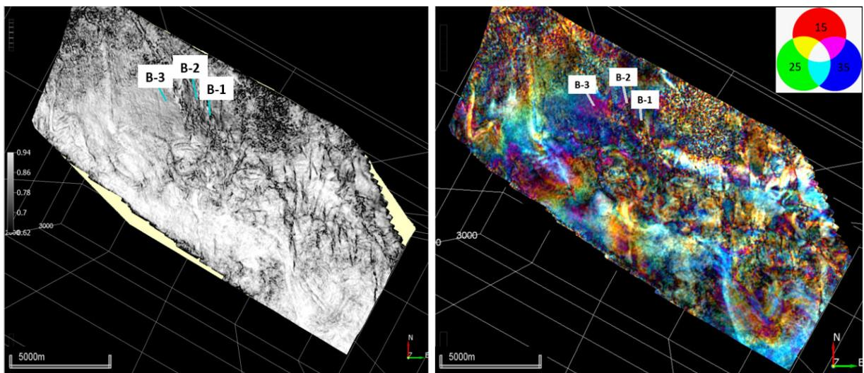
*Slika 8.2.6.1.: Spektralna dekompozicija usporedno s atributom koherencije Similarity po horizontu 40 ms iznad Ležišta I*
