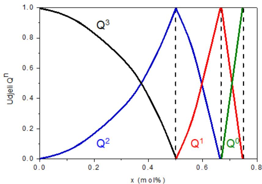
Slika 6. Udjeli  $Q^n$  za binarna fosfatna stakla serije  $xM_2O-(1-x)P_2O_5$ .<sup>15</sup>
