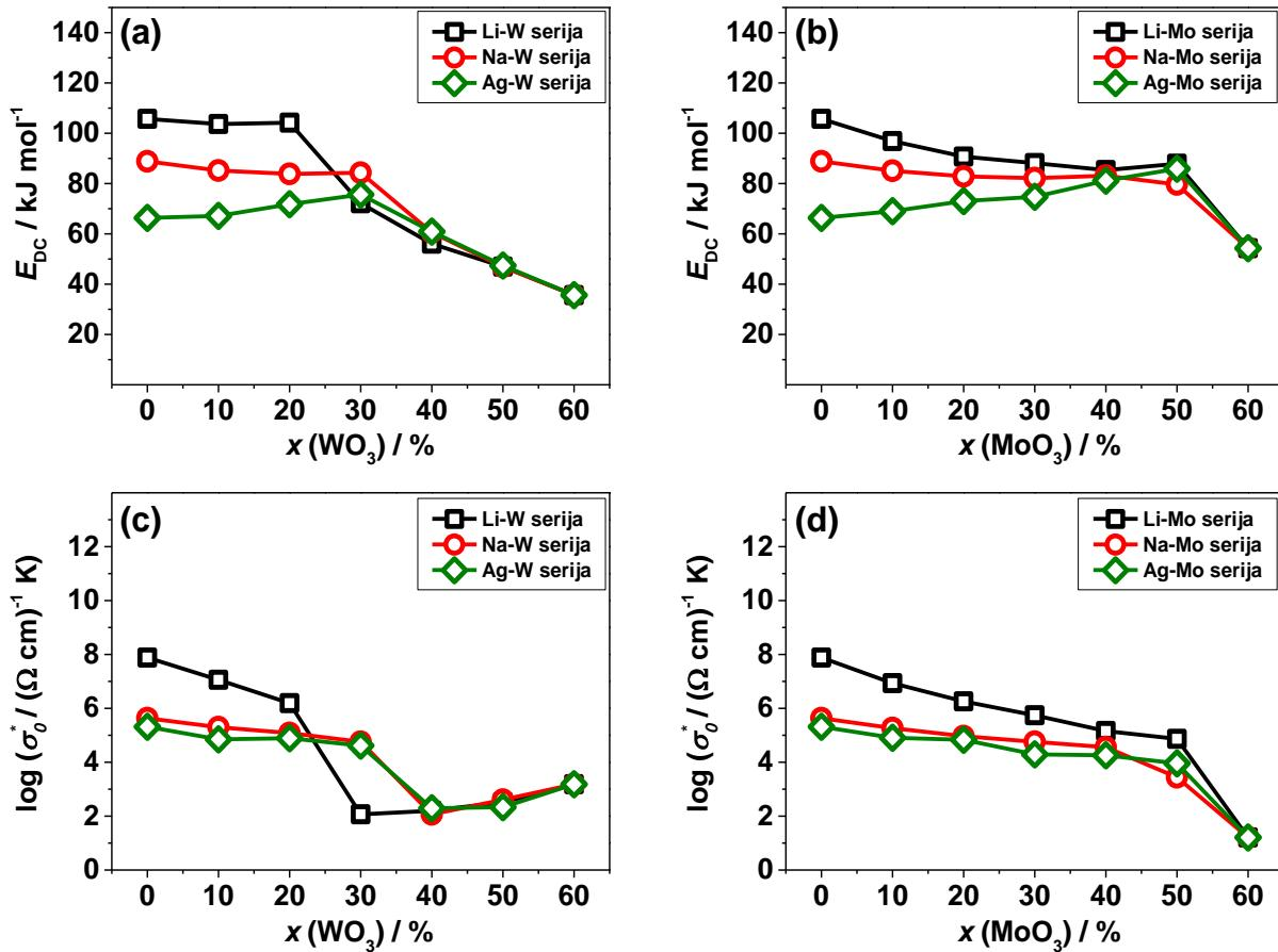
Slika 27. Ovisnosti (a, b) energije aktivacije istosmjerne provodnosti,  $E_{DC}$ , i (c, d) predeksponencijskog faktora,  $\log \sigma_0^*$ , o množinskom udjelu  $\text{WO}_3$  odnosno  $\text{MoO}_3$  u staklima.
