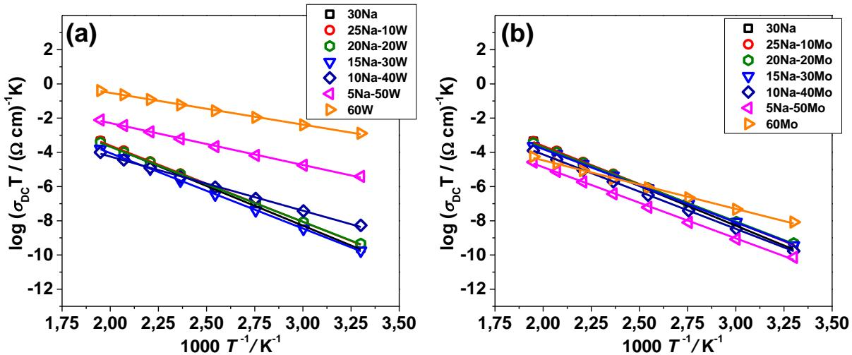
Slika D1. Arrheniusova ovisnost istosmjerne provodnosti za stakla iz (a) Na-W i (b) Na-Mo serije.
