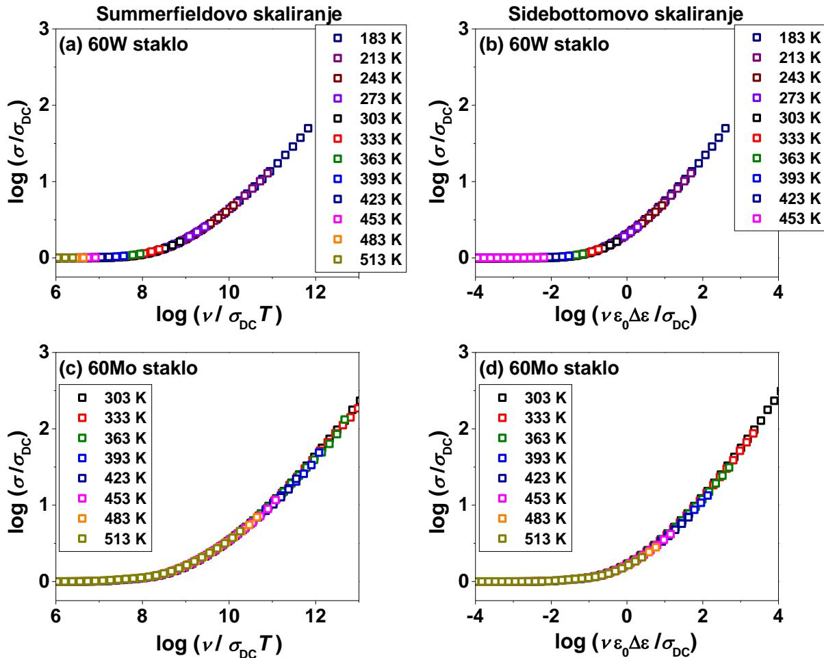
Slika 36. Spektri provodnosti čisto polaronskih stakala: (a, b) 60W i (c, d) 60Mo skalirani Summerfieldovim (a i c) i Sidebottomovim postupkom (b i d).
