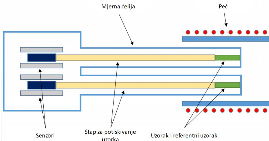
Slika 11. Shematski prikaz dilatometrijskog uređaja.<sup>82</sup>
