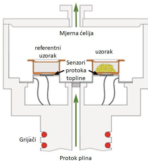
Slika 12. Shematski prikaz čelije DSC uređaja.<sup>83</sup>
