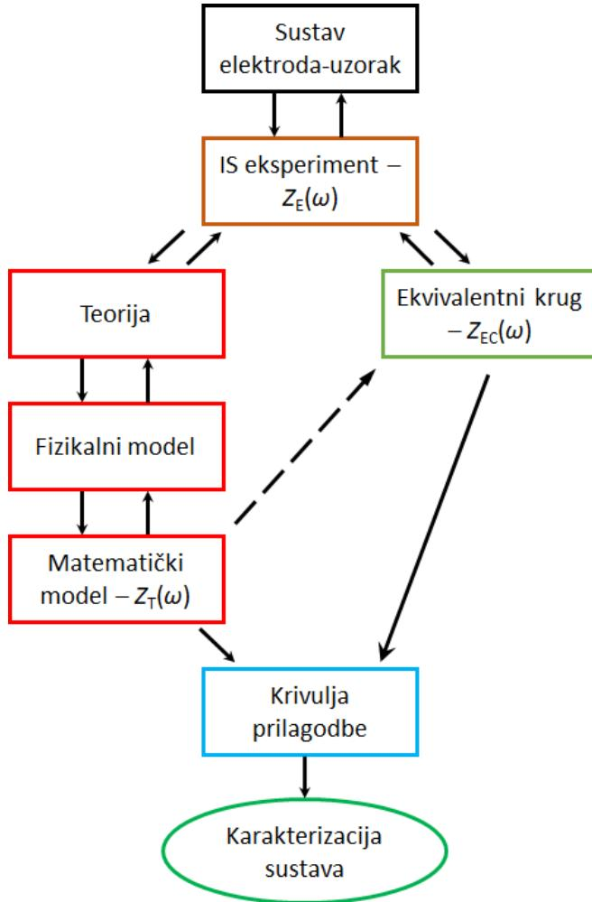
Slika 15. Shematski prikaz analize rezultata impedancijske spektroskopije.
