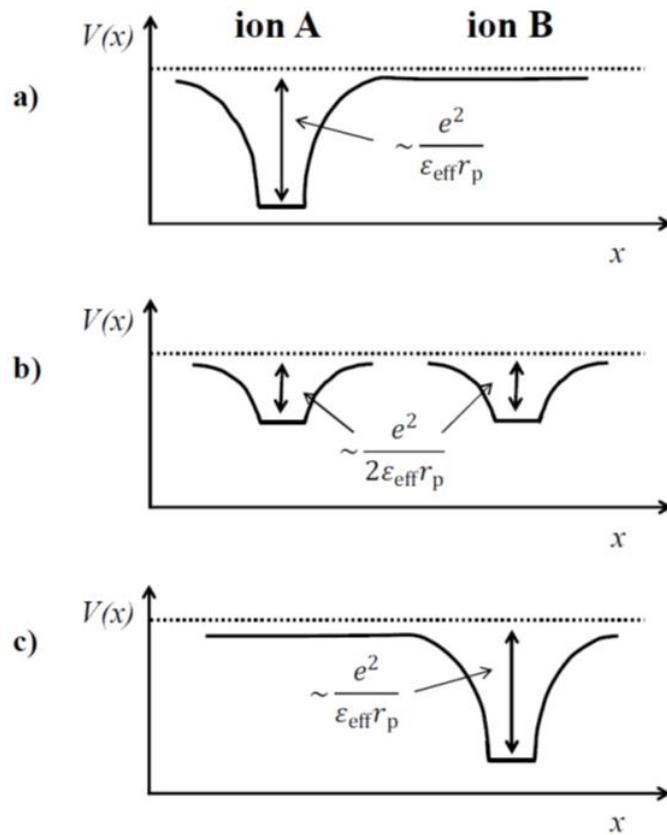
Slika 10. Proces gibanja malog polarona: a) elektron se nalazi na položaju iona A; b) izjednačene energije na položaju iona A i novog položaja B na koje elektron „slučajnim događajem“ može prijeći; c) elektron na novom položaju iona B.
