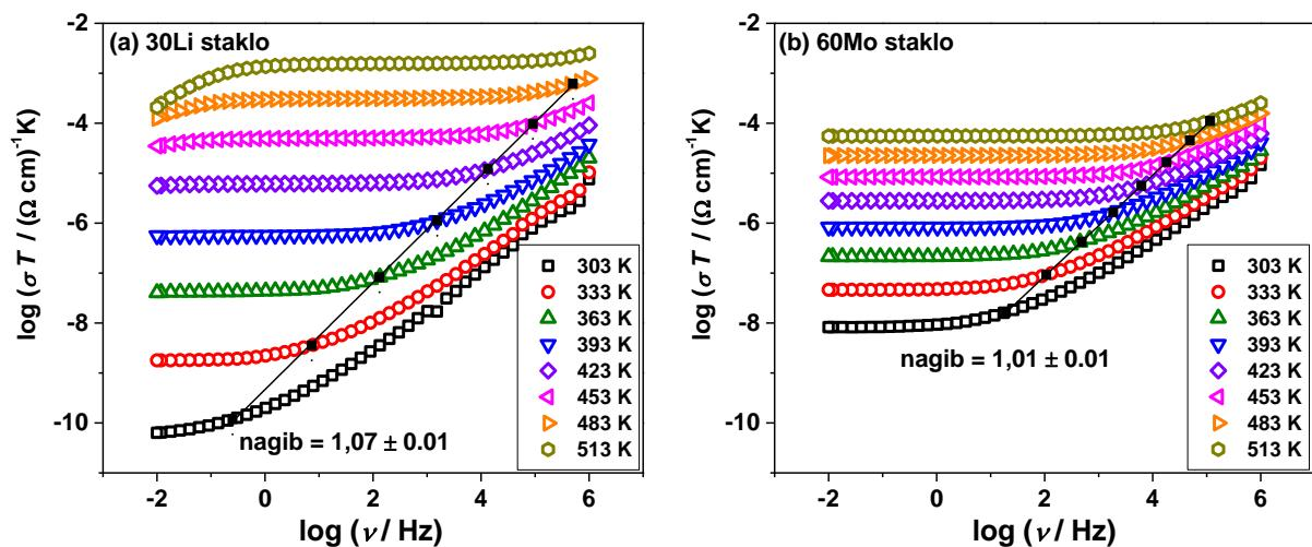
Slika 34. Spektri provodnosti s označenom ovisnosti umnoška  $\sigma_{DC}$  i temperature o frekvenciji  $f_0$  na  $2\sigma_{DC}$  u log-log skali za (a) čisto ionsko staklo, 30Li, i (b) čisto polaronsko staklo, 60Mo. Crne točke na grafu predstavljaju vrijednost frekvencije,  $f_0$ , dobivene prema jednadžbi  $\sigma'(f_0) = 2\sigma_{DC}$  dok je crna linija pravac dobiven linearizacijom ovisnosti  $\log(\sigma_{DC}T)$  vs  $\log f_0$ .
