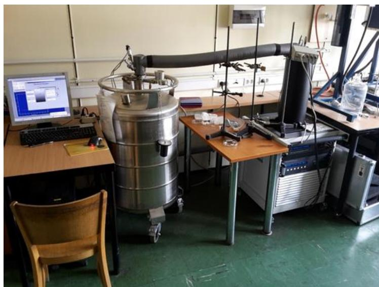
Slika 19. Fotografija sustava za impedancijsku spektroskopiju u Laboratoriju za funkcionalne materijale, IRB.
