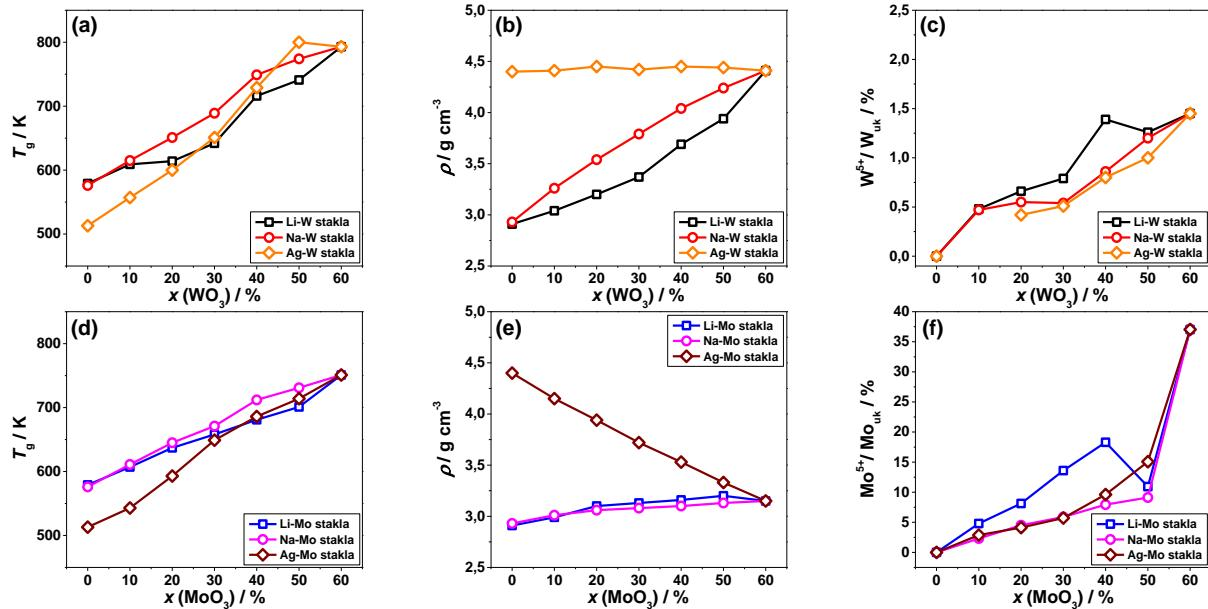
Slika 20. Ovisnost vrijednosti temperature staklišta,  $T_g$ , (a i d); gustoće,  $\rho$ , (b i e); i omjera  $W^{5+}/W_{\text{uk}}$  odnosno  $\text{Mo}^{5+}/\text{Mo}_{\text{uk}}$  (c i f) o množinskom udjelu  $\text{WO}_3$  i  $\text{MoO}_3$  za sva istraživana stakla.
