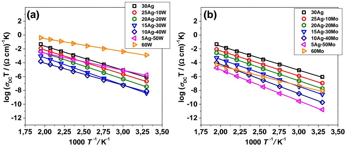
Slika D2. Arrheniusov ovisnost istosmjerne provodnosti za stakla iz (a) Ag-W i (b) Ag-Mo serije.
