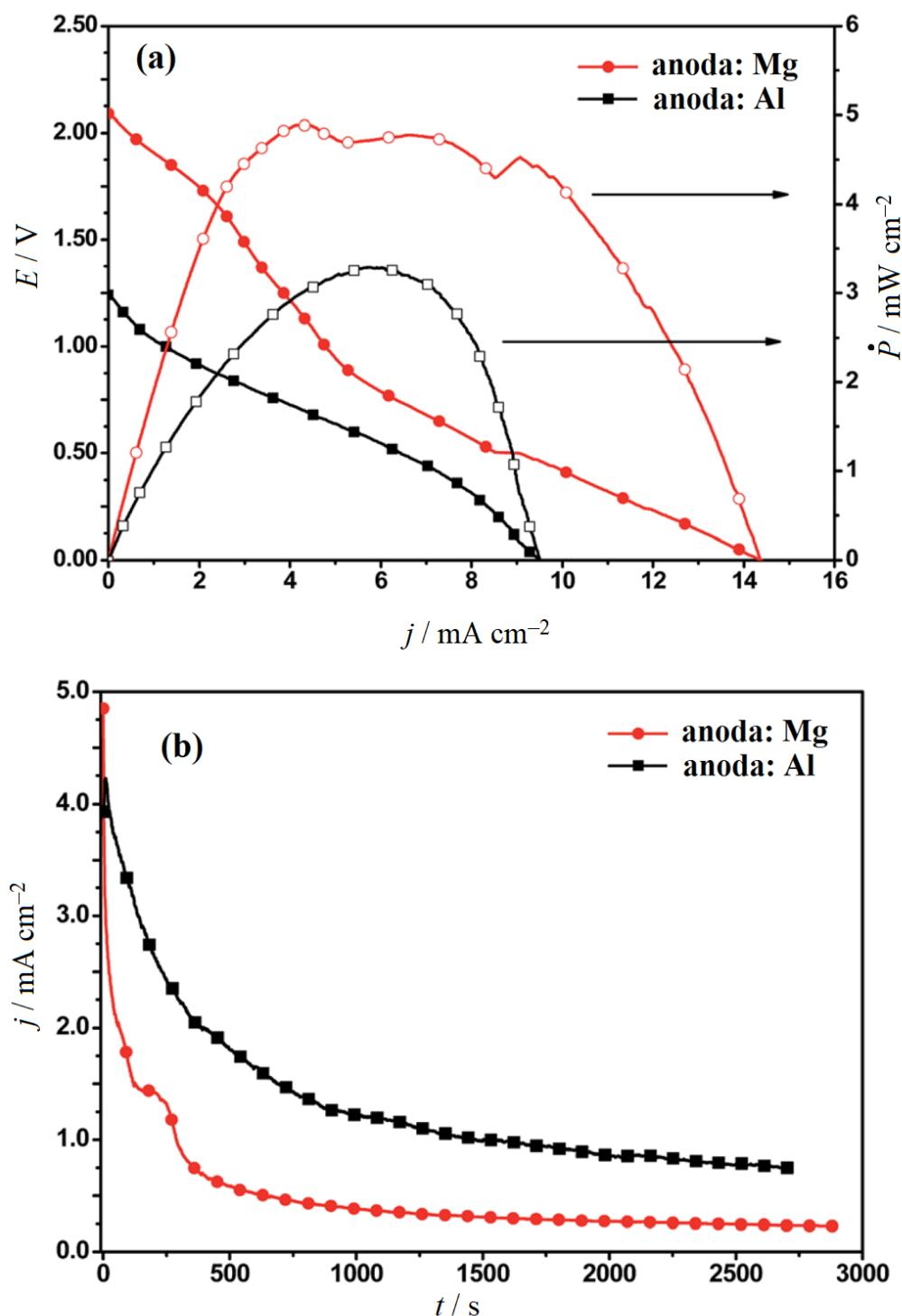
**Slika 2.17.** (a) Karakteristike gorivnog članka baziranog na vodikovom peroksidu koji kao katodu koristi berlinsko modrilo. (b) Kronoamperometrijske krivulje mjerene pri 1 V (u slučaju kada je Mg anoda) te 0,5 V (anoda je Al). Mjerenja su provedena u jednokomponentnoj celiji u kojoj je  $c(\text{H}_2\text{O}_2) = 0,5 \text{ mol dm}^{-3}$ , a  $c(\text{HCl}) = 0,1 \text{ mol dm}^{-3}$ .<sup>[62]</sup>
