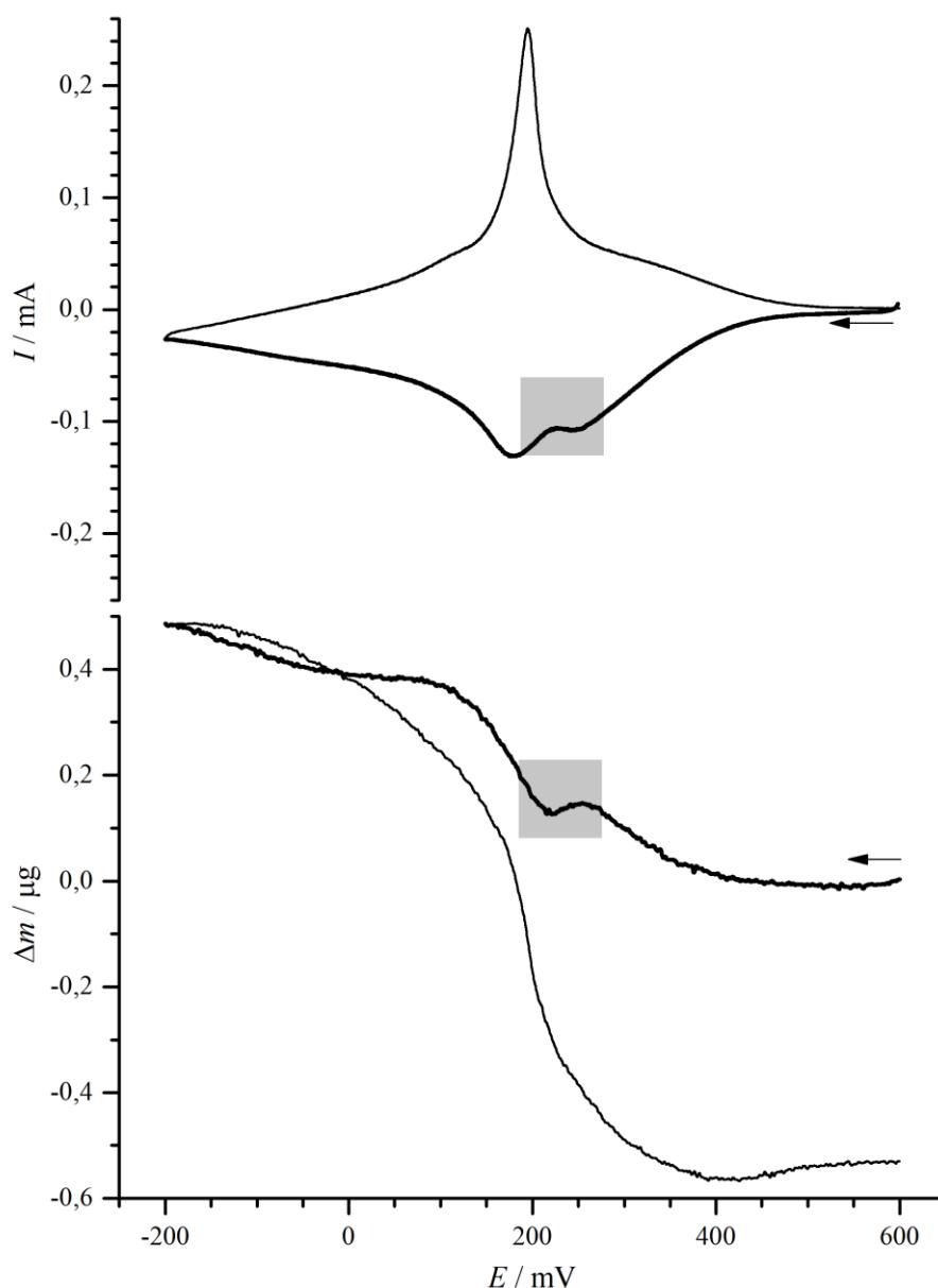
**Slika 4.30.** Ciklički voltamogram i elektrogravimetrijska krivulja (1. ciklus) filma berlinskog modrila deponiranog na Au elektrodu u otopini kalijeva klorida,  $c(\text{KCl}) = 0,1 \text{ mol dm}^{-3}$ ; pH = 4;  $v = 10 \text{ mV s}^{-1}$ ,  $\Gamma = 5,1 \text{ mC cm}^{-2}$ .
