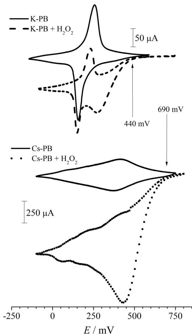
**Slika 4.40.** Ciklički voltamogrami (gore) K-PB filma deponiranog na GC elektrodu bez (—) i uz dodatak vodikova peroksida (----); (dolje) Cs-PB filma bez (—) i uz dodatak vodikova peroksida (···).  $c(\text{MCl}) = 0,1 \text{ mol dm}^{-3}$ ,  $c(\text{H}_2\text{O}_2) = 0,01 \text{ mol dm}^{-3}$ , pH = 1.
