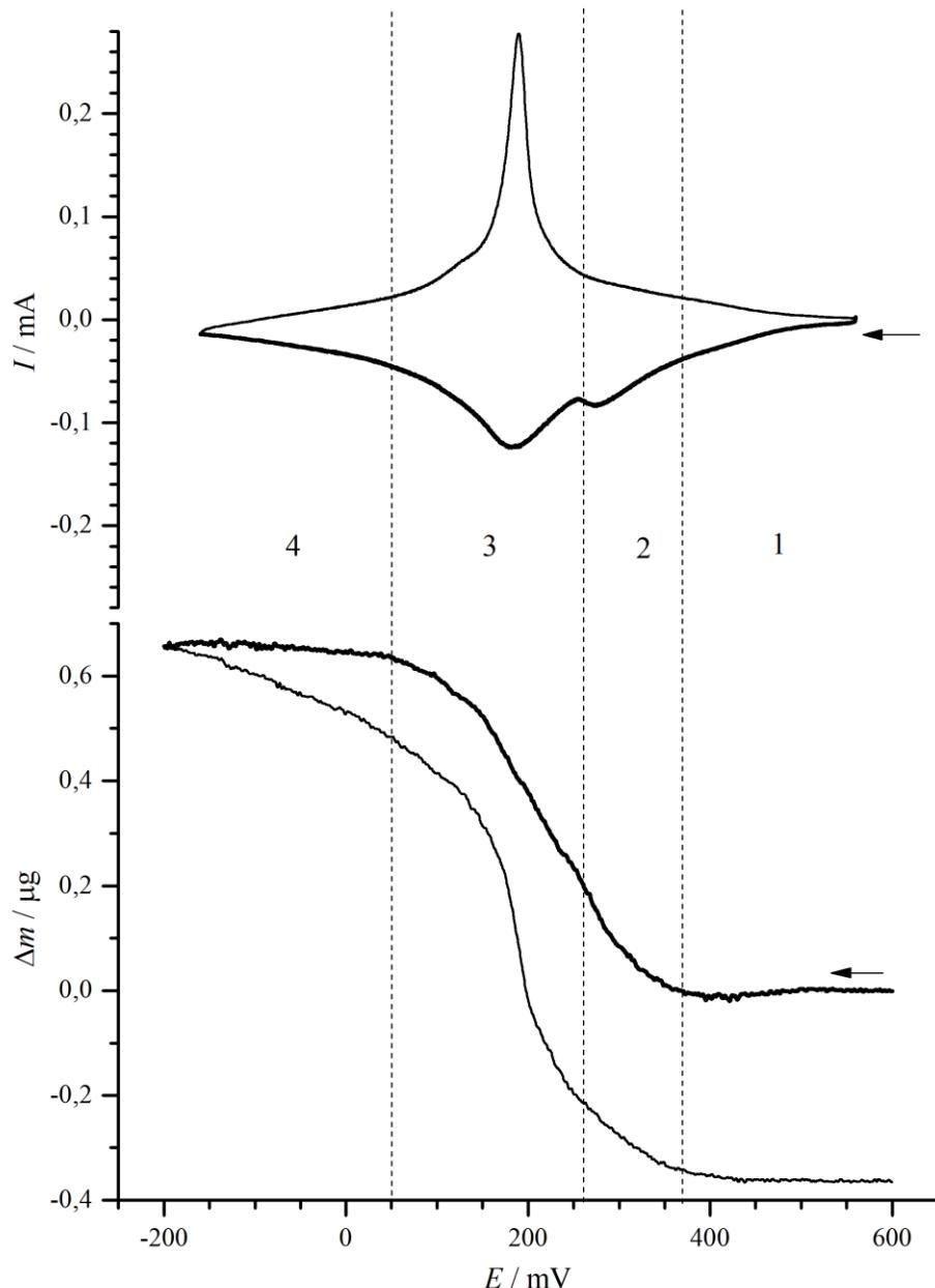
**Slika 4.29.** Ciklički voltamogram i elektrogravimetrijska krivulja (1. ciklus) filma berlinskog modrila deponiranog na Au elektrodu u otopini kalijeva klorida,  $c(\text{KCl}) = 0,1 \text{ mol dm}^{-3}$ ; pH = 2;  $v = 10 \text{ mV s}^{-1}$ ,  $\Gamma = 5,1 \text{ mC cm}^{-2}$ .
