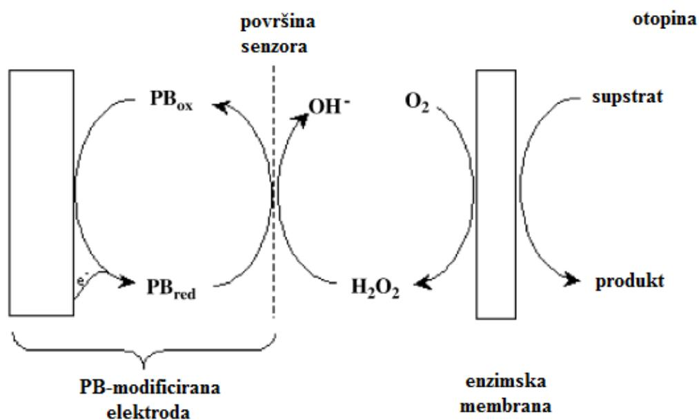
**Slika 2.16.** Općeniti prikaz biosenzora baziranog na berlinskom modrilu s enzimom oksidazom.<sup>[59]</sup>
