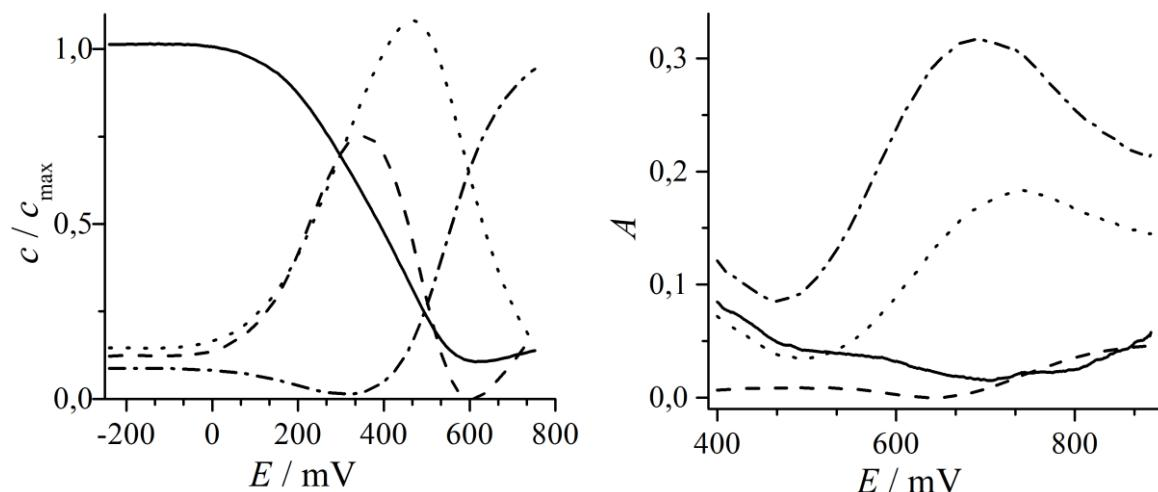
**Slika 4.35.** Rezultati razdvajanja spektara dobiveni evolucijskom faktorskom analizom u kombinaciji s iterativnom metodom na Cs-PB filmu pri pH = 2. (a) Koncentracijski profili; (b) spektralni profili.
