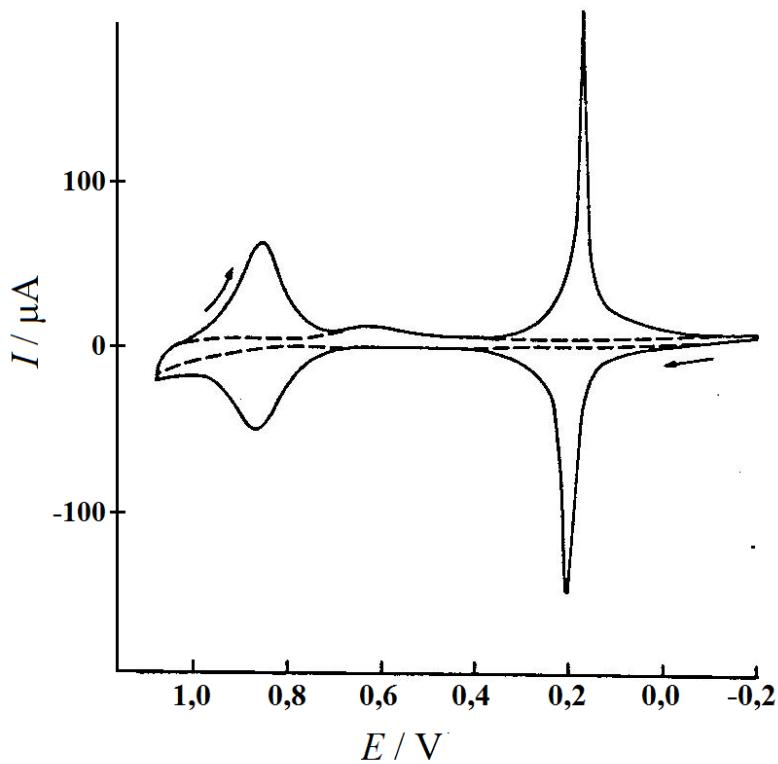
**Slika 2.7.** Ciklički voltamogram berlinskog modrila deponiranog na zlatnu elektrodu u otopini kalijevih iona;  $v = 1 \text{ mV s}^{-1}$ .<sup>[1]</sup>
