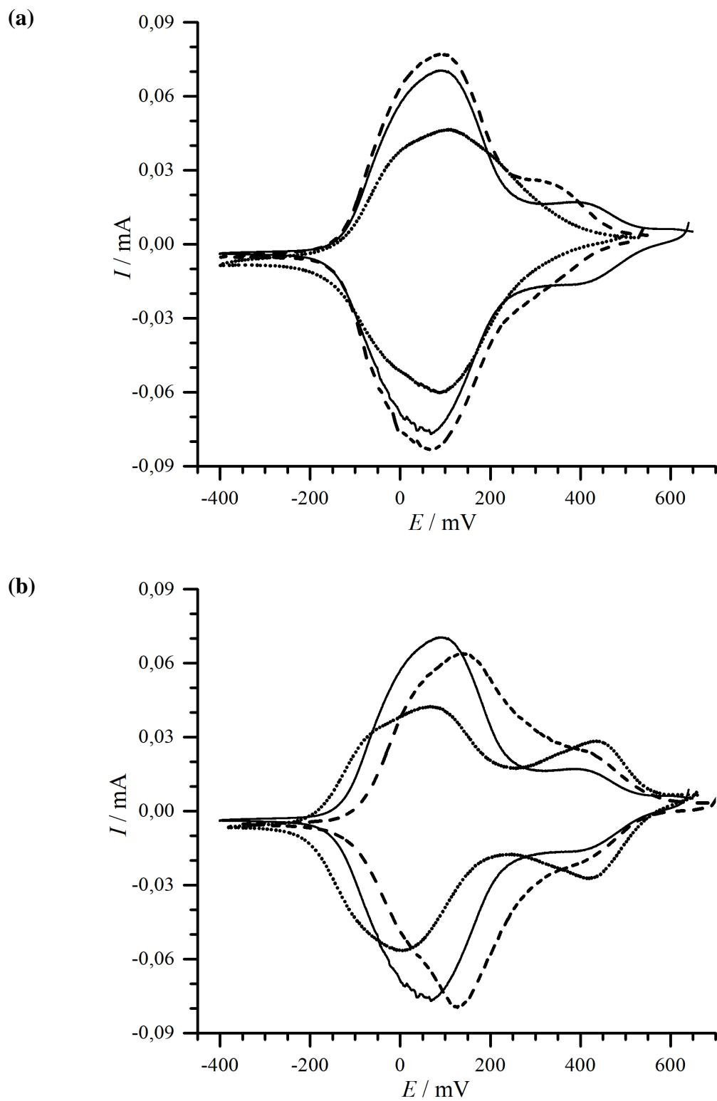
**Slika 4.19.** Ciklički voltamogrami konstantnog odziva Na-PB filma deponiranog na ITO elektrodu,  $\Gamma = 4,5 \text{ mC cm}^{-2}$ ,  $v = 10 \text{ mV s}^{-1}$ . (a) (—) pH 2; (----) pH 4; (···) pH 6;  $c(\text{NaCl}) = 0,1 \text{ mol dm}^{-3}$ . (b): (···)  $c(\text{NaCl}) = 0,01 \text{ mol dm}^{-3}$ ; (—)  $c(\text{NaCl}) = 0,1 \text{ mol dm}^{-3}$ , (----)  $c(\text{NaCl}) = 1 \text{ mol dm}^{-3}$ ; pH = 2.
