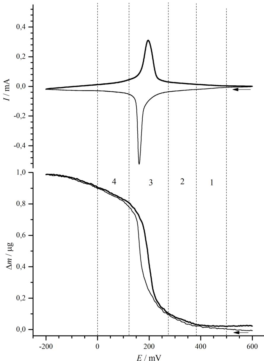
**Slika 4.31.** Ciklički voltamogram i elektrogravimetrijska krivulja (stabilni ciklus) K-PB filma deponiranog na Au elektrodu u otopini kalijeva klorida,  $c(\text{KCl}) = 0,1 \text{ mol dm}^{-3}$ ;  $\text{pH} = 2$ ;  $\nu = 10 \text{ mV s}^{-1}$ ,  $\Gamma = 5,1 \text{ mC cm}^{-2}$ .
