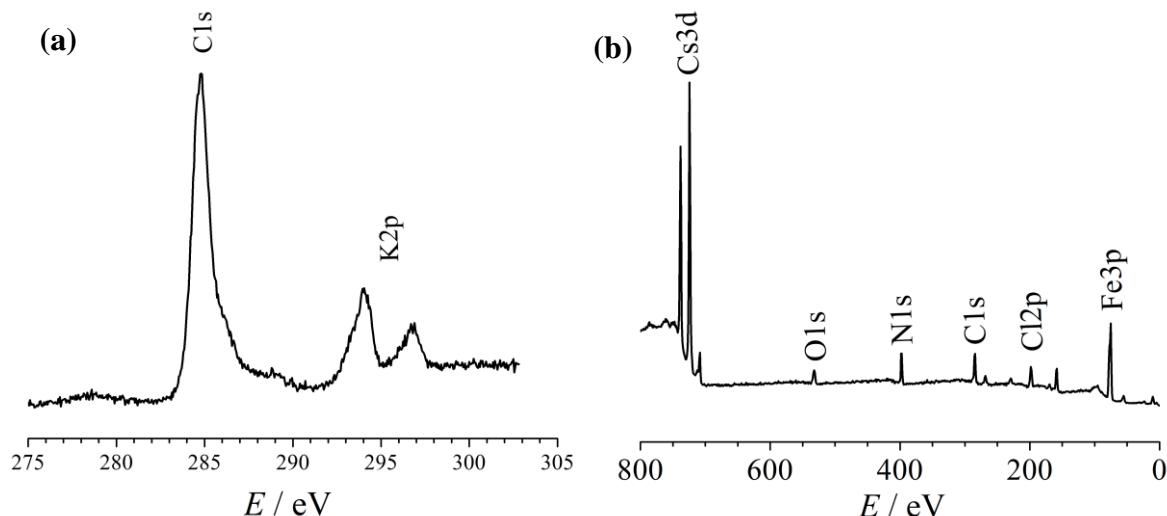
**Slika 4.10.** XPS spektri (a) K2p K-PB filma; (b) široki spektar Cs-PB filma.  $j = 25 \mu\text{A cm}^{-2}$ ,  $\Gamma = 5,3 \text{ mC cm}^{-2}$ , ciklički polarizirani u otopini  $\text{MCl}$ , pH 2).
