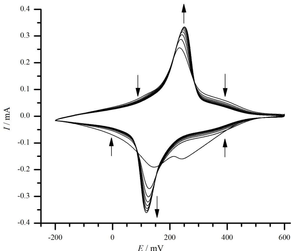
**Slika 4.6.** Ciklički voltamogram i-PB filma deponiranog na ITO elektrodu u otopini kalijeva klorida koncentracije  $c(\text{KCl}) = 0,1 \text{ mol dm}^{-3}$ ;  $\text{pH} = 3$ ,  $v = 10 \text{ mV s}^{-1}$ ;  $\Gamma(\text{PB}) = 4,5 \text{ mC cm}^{-2}$ .
