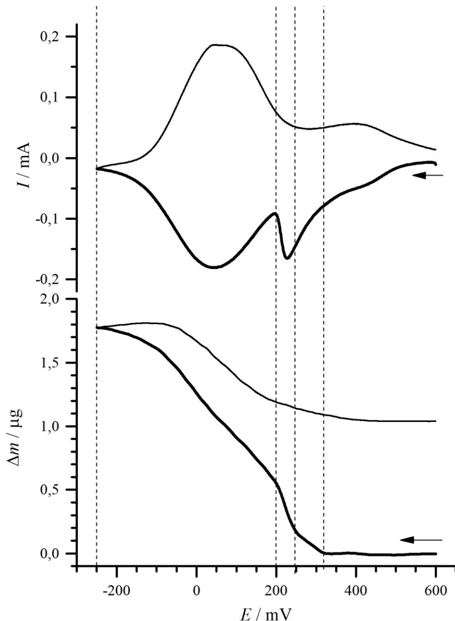
**Slika 4.22.** Ciklički voltamogram i elektrogravimetrijska krivulja (1. ciklus) filma berlinskog modrila deponiranog na Au elektrodu u otopini natrijeva klorida,  $c(\text{NaCl}) = 0,1 \text{ mol dm}^{-3}$ ;  $\text{pH} = 2$ ;  $v = 10 \text{ mV s}^{-1}$ ,  $\Gamma = 5,1 \text{ mC cm}^{-2}$ .
