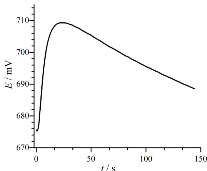
**Slika 4.1.** Kronopotenciometrijska krivulja snimljena tijekom galvanostatske depozicije netopljivog berlinskog modrila na GC elektrodu iz otopine sastava:  $c(FeCl_3) = c(K_3[Fe(CN)_6]) = 5 \text{ mmol dm}^{-3}$ ,  $c(HCl) = 10 \text{ mmol dm}^{-3}$ ;  $j = 25 \mu\text{A cm}^{-2}$ .
