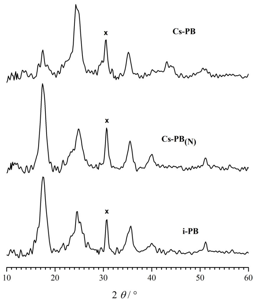
**Slika 4.15.** Rentgenski difraktogrami filmova berlinskog modrila. X označava refleks ITO elektrode. Cs-PB – film berlinskog modrila cikliziran u otopini CsCl, pH = 2; Cs-PB<sub>(N)</sub> – film i-PB namakan 10 min u otopini CsCl, pH = 2; i-PB – film berlinskog modrila nakon depozicije ( $j = 30 \mu\text{A cm}^{-2}$ ,  $\Gamma = 4,5 \text{ mC cm}^{-2}$ ).
