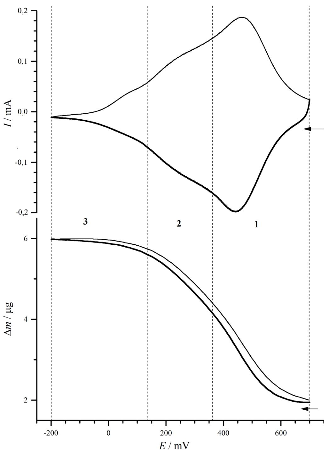
**Slika 4.25.** Ciklički voltamogram i elektrogravimetrijska krivulja (5. ciklus) Cs-PB filma deponiranog na Au elektrodu,  $c(\text{CsCl}) = 0,1 \text{ mol dm}^{-3}$ ;  $\text{pH} = 2$ ;  $v = 10 \text{ mV s}^{-1}$ ,  $\Gamma = 5,1 \text{ mC cm}^{-2}$ .
