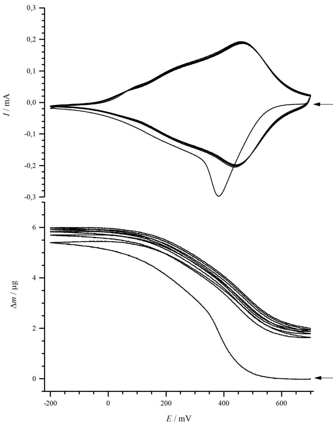
**Slika 4.28.** Ciklički voltamogram i elektrogravimetrijska krivulja filma berlinskog modrila deponiranog na Au elektrodu dobiveni tijekom cikličke polarizacije elektrode u otopini cezijeva klorida,  $c(\text{CsCl}) = 0,1 \text{ mol dm}^{-3}$ ;  $\text{pH} = 2$ ;  $v = 10 \text{ mV s}^{-1}$ ,  $I = 5,1 \text{ mC cm}^{-2}$ .
