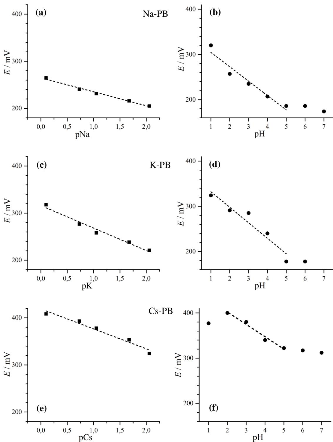
**Slika 4.17.** Ovisnost potencijala na vrhu voltametrijskog maksimuma prvog reduksijskog poluciklusa o (a)  $\text{pNa}$  pri  $\text{pH} 2$ ; (b)  $\text{pH}$  pri  $c(\text{NaCl}) = 0,1 \text{ mol dm}^{-3}$ ; (c)  $\text{pK}$  pri  $\text{pH} 2$ ; (d)  $\text{pH}$  pri  $c(\text{KCl}) = 0,1 \text{ mol dm}^{-3}$ ; (e)  $\text{pCs}$  pri  $\text{pH} 2$ ; (f)  $\text{pH}$  pri  $c(\text{CsCl}) = 0,1 \text{ mol dm}^{-3}$ .
