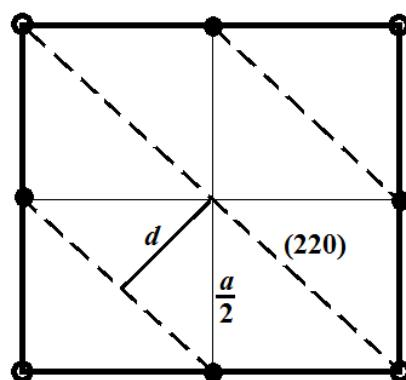
**Slika 4.14.** Projekcija jedinične ćelije Cs-PB s označenim (220) ravninama. Na slici su, radi preglednosti, prikazani samo ioni Fe:  $\text{O}$   $\text{Fe}^{2+}$ ;  $\bullet$   $\text{Fe}^{3+}$  ion.
