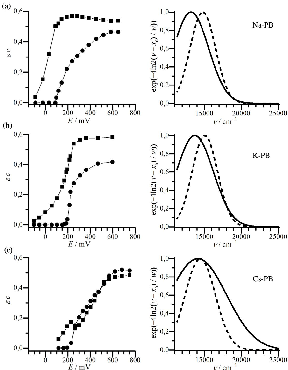
**Slika 4.39.** Prikaz izračunatih „koncentracijskih“ ( $\varepsilon \cdot c$ ) (lijevo) i spektralnih (desno) jediničnih profila elektronskih prijelaza u filmovima berlinskog modrila između orbitala  $\text{FeN}_6$  (■, —), odnosno  $\text{FeN}_{6-x}\text{O}_x$  (●, ----) koordiniranih centara; (a) Na-PB, (b) K-PB i (c) Cs-PB; pH = 2.
