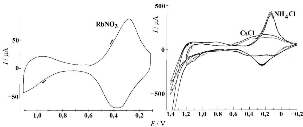
**Slika 2.14.** Ciklički voltamogram berlinskog modrila u vodenoj otopini rubidijevih iona ( $\text{pH} = 4$ );  $v = 10 \text{ mV s}^{-1}$ , radna elektroda: kvarcni kristal;<sup>[24]</sup> (lijevo) te amonijevih, odnosno cezijevih ( $\text{pH} = 2,5$ );  $v = 50 \text{ mV s}^{-1}$ ; radna elektroda: ITO<sup>[28]</sup> (desno).  $c(\text{M}^+) = 0,5 \text{ mol dm}^{-3}$ .
