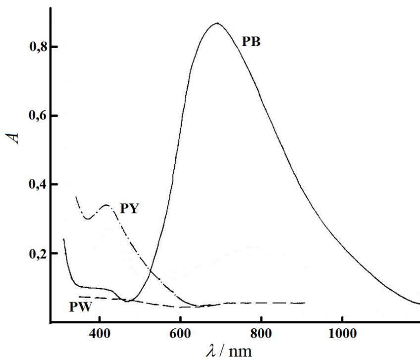
**Slika 2.4.** UV-VIS-NIR spektar berlinskog modrila (PB) te njegove reducirane (PW) i oksidirane forme (PY).<sup>[15]</sup>
