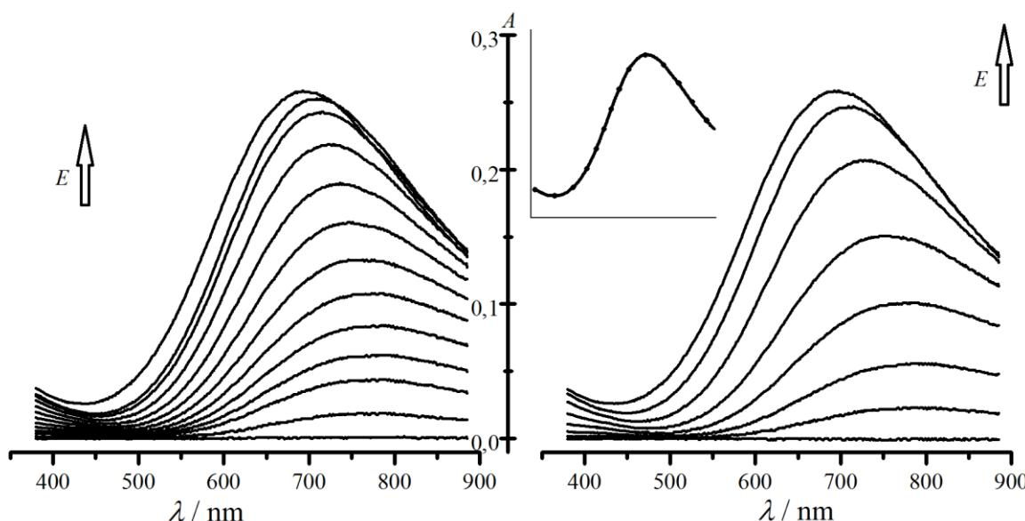
**Slika 4.33.** Spektri Cs-PB filma snimljeni na različitim potencijalima (od 600 do  $-200\text{ mV}$ ) tijekom redukcije (lijevo) i reoksidacije (desno) filma konstantnog voltametrijskog odziva u otopini cezijeva klorida,  $c(\text{CsCl}) = 0,1\text{ mol dm}^{-3}$ ,  $\text{pH} = 2$ ,  $\Gamma = 4,5\text{ mC cm}^{-2}$ . Umetnuta skica prikazuje prvi spektar snimljen u katodnom poluciklusu (—) i posljednji spektar snimljen u anodnom poluciklusu (----).
