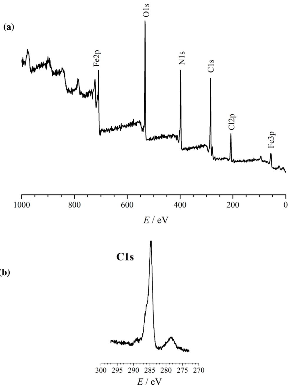
**Slika 4.4.** XPS spektri filma berlinskog modrila ( $j = 25 \mu\text{A cm}^{-2}$ ,  $\Gamma = 5,3 \text{ mC cm}^{-2}$ ) (a) u širokom području energija vezanja; (b) visokorezolucijski spektri snimljeni u području koje odgovara C1s signalu.
