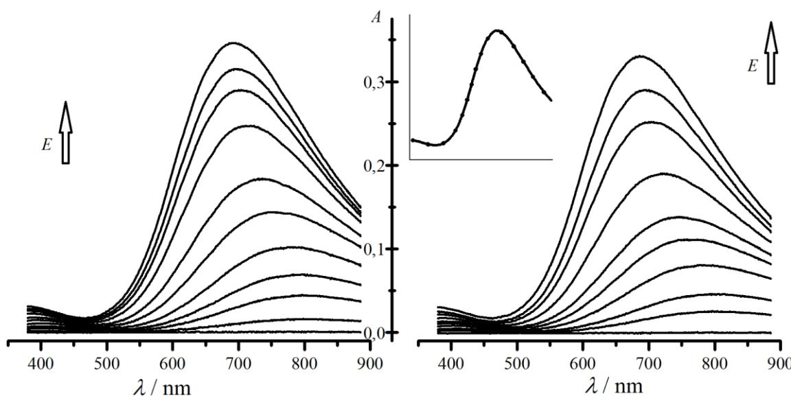
**Slika 4.32.** Spektri K-PB filma snimljeni na različitim potencijalima (od 600 do  $-200\text{ mV}$ ) tijekom redukcije (lijevo) i reoksidacije (desno) filma u otopini kalijeva klorida,  $c(\text{KCl}) = 0,1\text{ mol dm}^{-3}$ ,  $\text{pH} = 2$ ,  $\Gamma = 4,5\text{ mC cm}^{-2}$ . Umetnuta skica prikazuje prvi spektar snimljen u katodnom poluciklusu (—) i posljednji spektar snimljen u anodnom poluciklusu (----).
