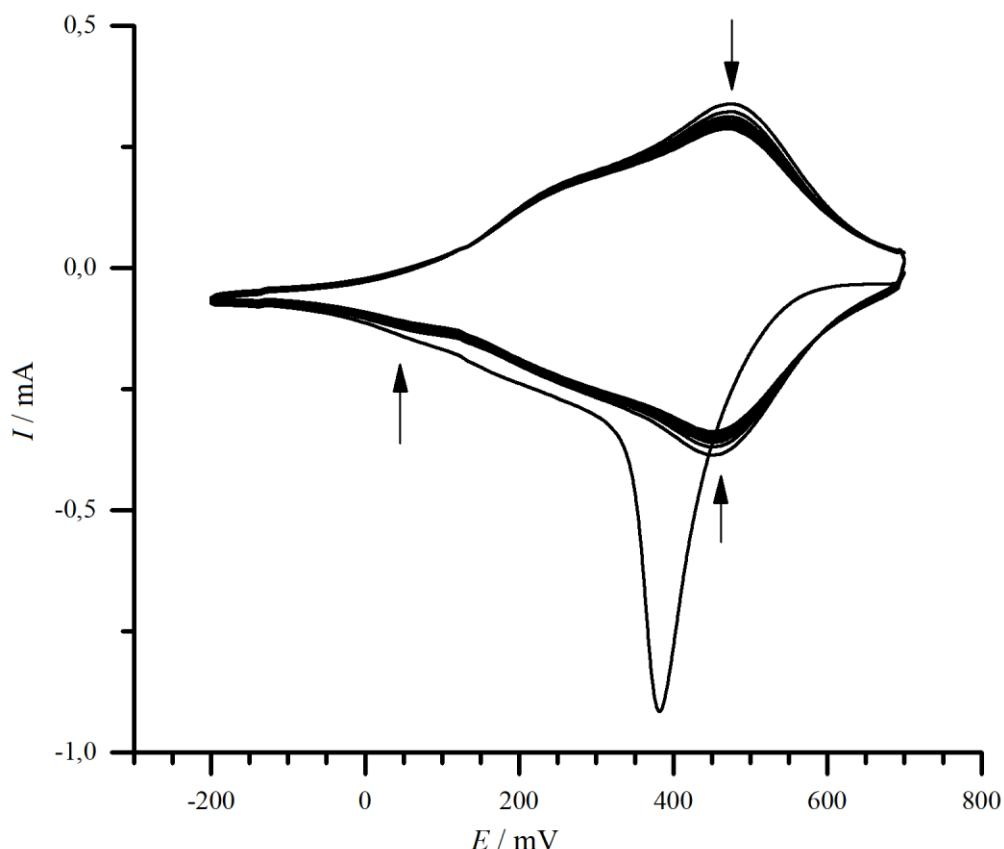
**Slika 4.7.** Ciklički voltamogram i-PB filma deponiranog na GC elektrodu u otopini cezijeva klorida množinske koncentracije  $c(\text{CsCl}) = 0,1 \text{ mol dm}^{-3}$ ;  $\text{pH} = 3$ ,  $v = 10 \text{ mV s}^{-1}$ ;  $I(\text{PB}) = 3,6 \text{ mC cm}^{-2}$ .
