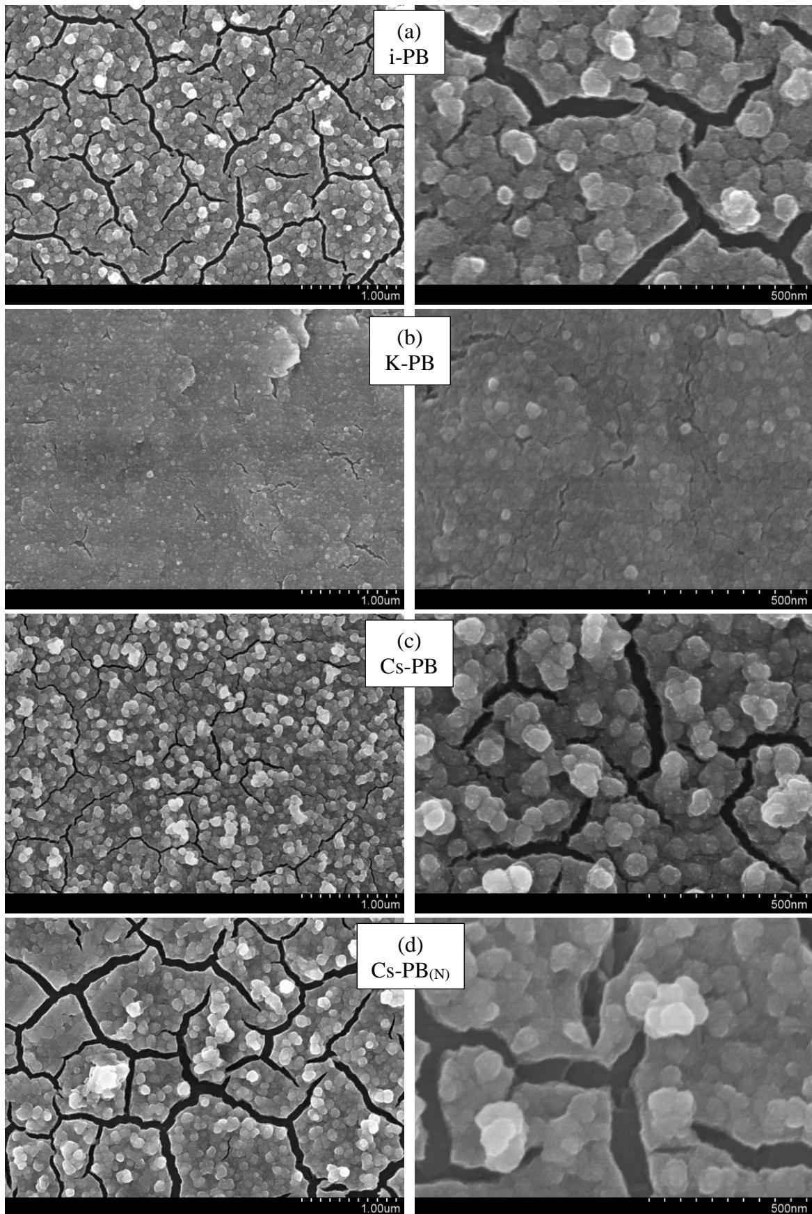
**Slika 4.11.** SEM mikroografi filmova berlinskog modrila (a)–(d) pri manjem (lijevo) i većem (desno) povećanju ( $j = 25 \mu\text{A cm}^{-2}$ ,  $\Gamma = 5,3 \text{ mC cm}^{-2}$ ).
