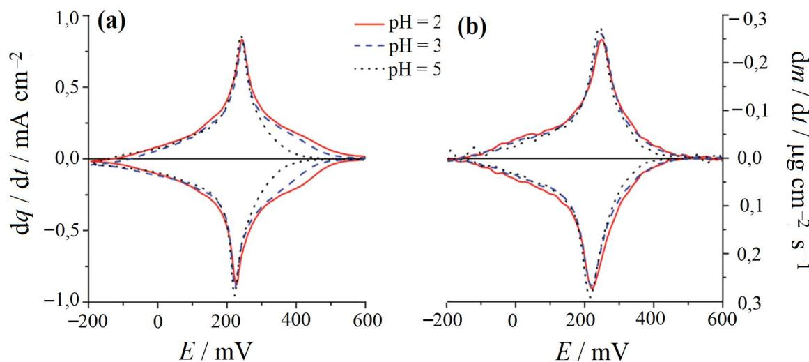
**Slika 2.13.** (A) Ciklički voltamogram berlinskog modrila deponiranog na zlatnu elektrodu snimljen u otopini KCl koncentracije  $c(\text{KCl}) = 0,5 \text{ mol dm}^{-3}$  pri različitim pH. (B) Derivirana krivulja promjene mase tijekom cikličke promjene potencijala na filmu berlinskog modrila pri različitim pH.  $v = 20 \text{ mV s}^{-1}$ .<sup>[30]</sup>
