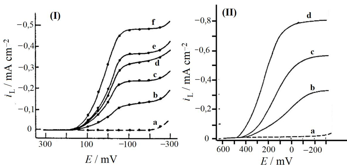
**Slika 2.15.** Redukcija kisika (I) te vodikova peroksida (II) koncentracije  $0,4 \text{ mmol dm}^{-3}$  u otopini kalijeva klorida ( $c(\text{KCl}) = 1 \text{ mol dm}^{-3}$ ),  $\text{pH} = 3$  (a) nemodificiranoj GC elektrodi te na PB-modificiranim GC elektrodama pri sljedećom količinama naboja: (Ib) 2; (Ic) 2,8; (Id) 4,2; (Ie) 4,8; (If) 6; (IIb) 0,8; (IIc) 1,3 i (IId)  $6,9 \cdot \text{mC cm}^{-2}$ .<sup>[42]</sup>
