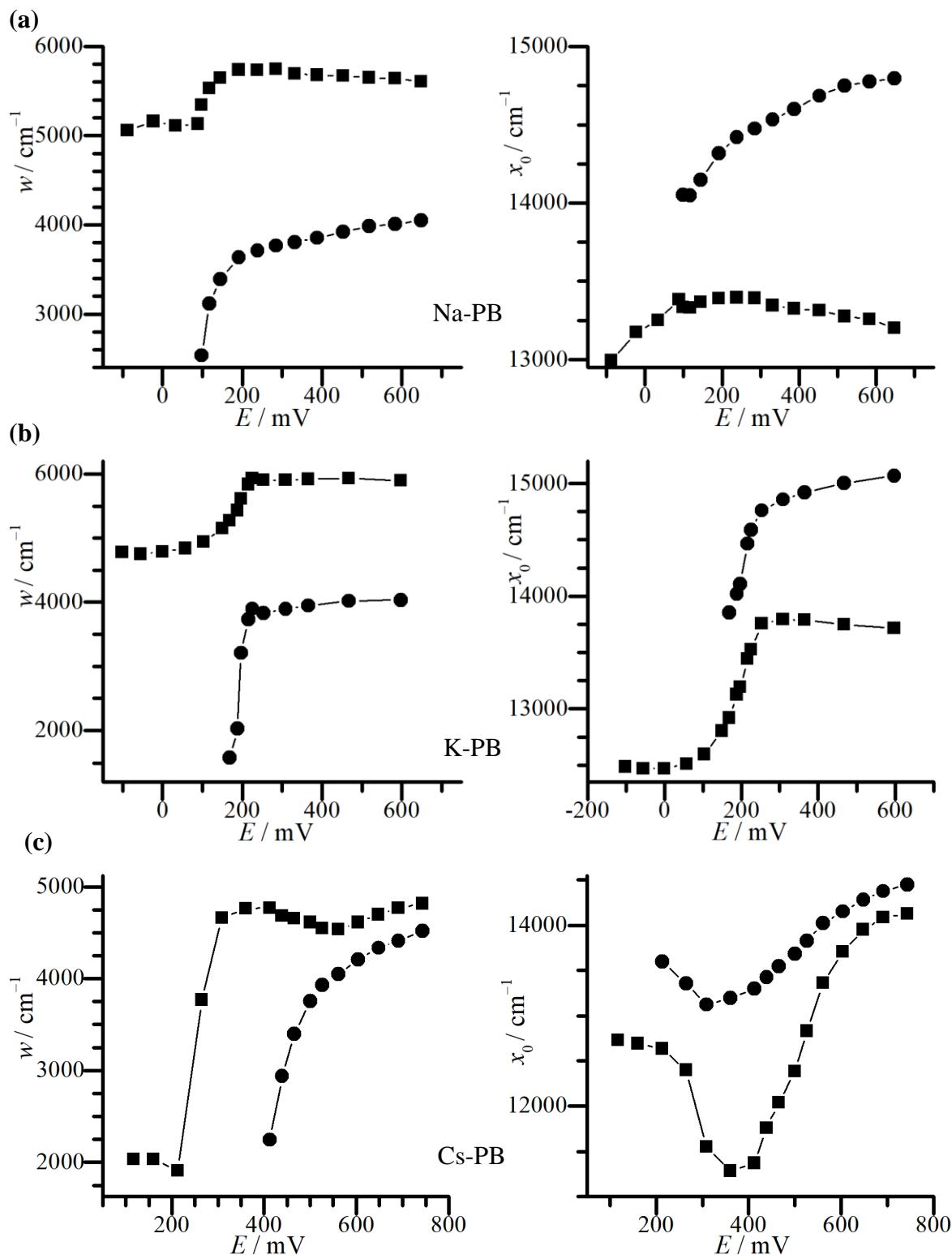
**Slika 4.38.** Prikaz promjene vrijednosti izračunatih parametara  $w$  (širina Gaussove krivulje na polovici njezine visine) i  $x_0$  (valni broj pri kojem je maksimum apsorbancije prijelaza koji uzrokuje apsorpciju) u filmovima berlinskog modrila između orbitala  $\text{FeN}_6$  (■), odnosno  $\text{FeN}_{6-x}\text{O}_x$  (●) koordiniranih centara; (a) Na-PB, (b) K-PB i (c) Cs-PB pri pH = 2.
