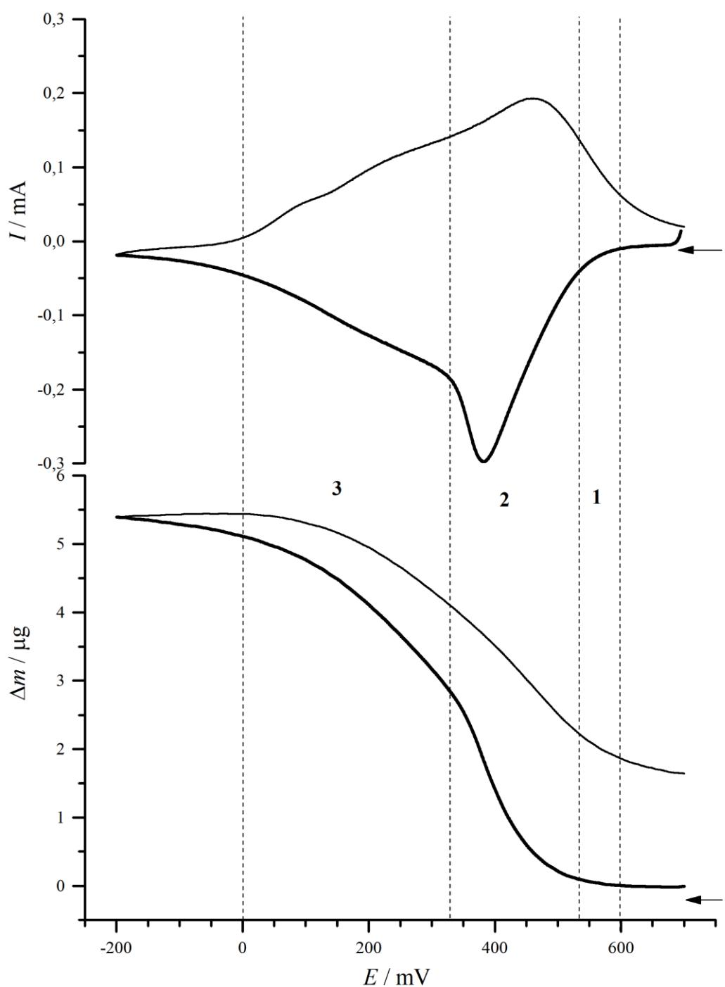
**Slika 4.24.** Ciklički voltamogram i elektrogravimetrijska krivulja (1. ciklus) filma berlinskog modrila deponiranog na Au elektrodu u otopini cezijeva klorida,  $c(\text{CsCl}) = 0,1 \text{ mol dm}^{-3}$ ;  $\text{pH} = 2$ ;  $v = 10 \text{ mV s}^{-1}$ ,  $\Gamma = 5,1 \text{ mC cm}^{-2}$ .
