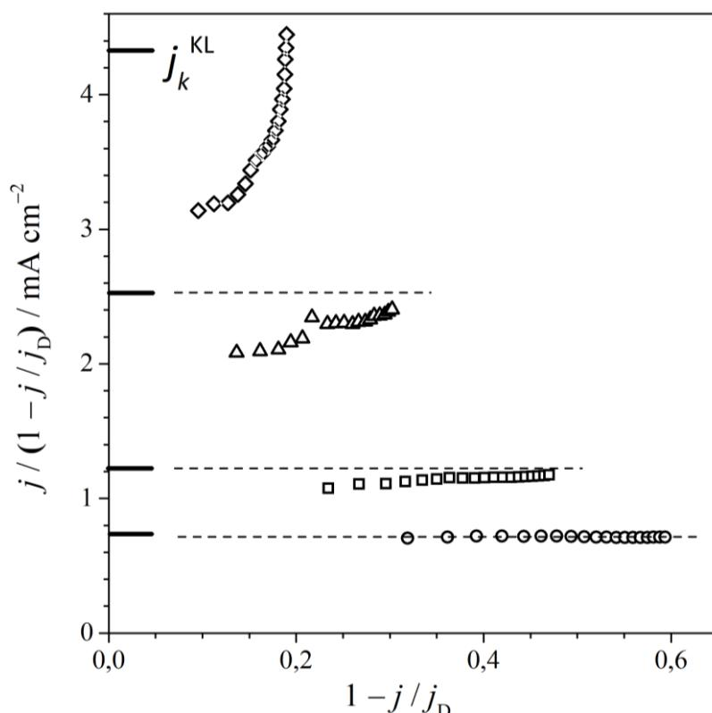
**Slika 4.43.** Analiza kinetičkih podataka sa slike 4.42. prema Andrieuxovom i Saveantovom modelu. Crtkane linije označavaju vrijednosti Koutecky-Levichevih odsječaka dobivenih na slici 4.42.(b); debljine Cs-PB filmova: (○) 7.5 nm; (□) 14.3 nm; (Δ) 28.5 nm; (◊) 56.8 nm.
