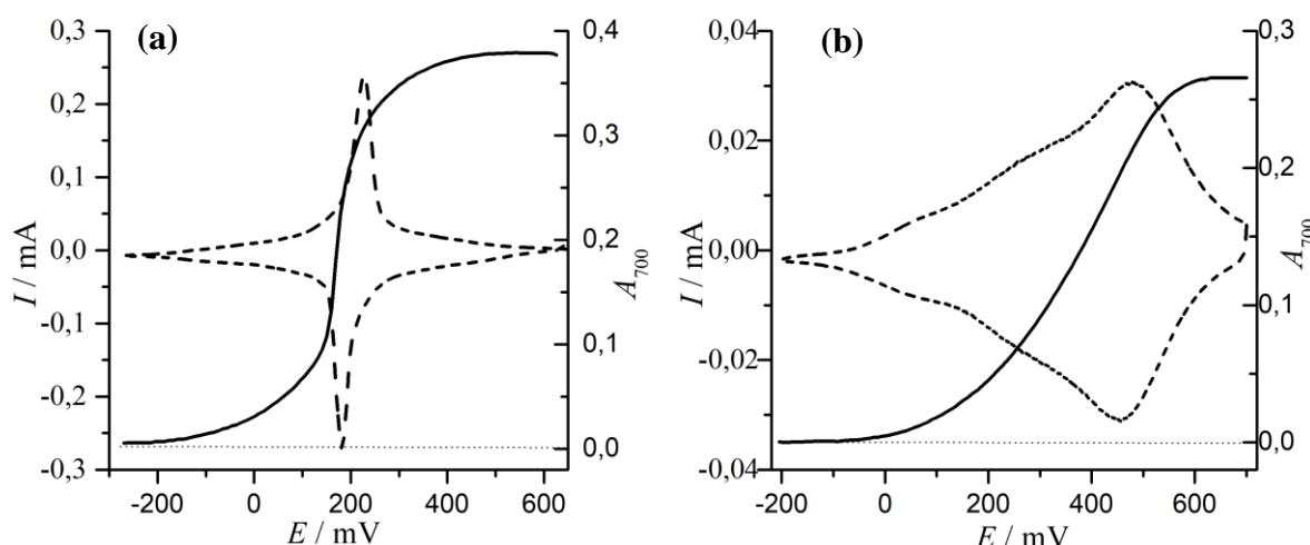
**Slika 4.34.** Ciklički voltamogrami (----) i voltapsorptogrami (—) na  $\lambda = 700$  nm snimljeni na različitim potencijalima tijekom redukcije filmova (a) K-PB i (b) Cs-PB.  $v = 10 \text{ mV s}^{-1}$ ,  $c(\text{MCl}) = 0,1 \text{ mol dm}^{-3}$ ,  $\text{pH} = 2$ ,  $\Gamma = 4,5 \text{ mC cm}^{-2}$ .
