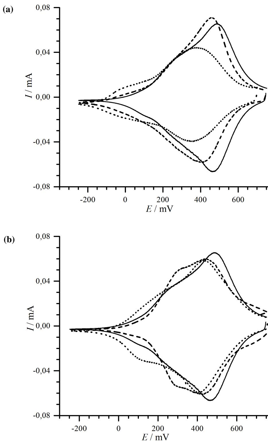
**Slika 4.21.** Ciklički voltamogrami konstantnog odziva Cs-PB filma deponiranog na ITO elektrodu,  $\Gamma = 4,5 \text{ mC cm}^{-2}$ ,  $v = 10 \text{ mV s}^{-1}$ . (a) (—) pH 2; (----) pH 4; (....) pH 6;  $c(\text{CsCl}) = 0,1 \text{ mol dm}^{-3}$ . (b): (....)  $c(\text{CsCl}) = 0,01 \text{ mol dm}^{-3}$ ; (—)  $c(\text{CsCl}) = 0,1 \text{ mol dm}^{-3}$ , (----)  $c(\text{CsCl}) = 1 \text{ mol dm}^{-3}$ ; pH = 2.
