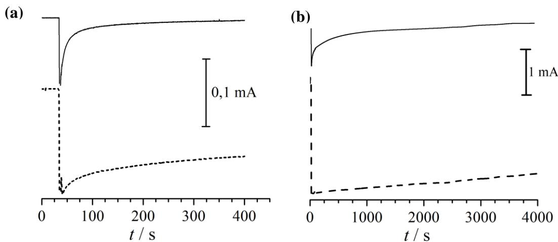
**Slika 4.44.** Kronoamperometrijske krivulje dobivene prilikom redukcije vodikova peroksida na K-PB (—) i Cs-PB (----) filmovima deponiranim na GC elektrode,  $c(\text{MCl}) = 0,1 \text{ mol dm}^{-3}$   $\text{M} = \text{K}^+, \text{Cs}^+$ . (a)  $c(\text{H}_2\text{O}_2) = 1 \text{ mmol dm}^{-3}$ ,  $\text{pH} = 9$ ; (b)  $c(\text{H}_2\text{O}_2) = 0,1 \text{ mol dm}^{-3}$ ,  $\text{pH} = 1$ . Brzina rotacije elektrode = 25 Hz.
