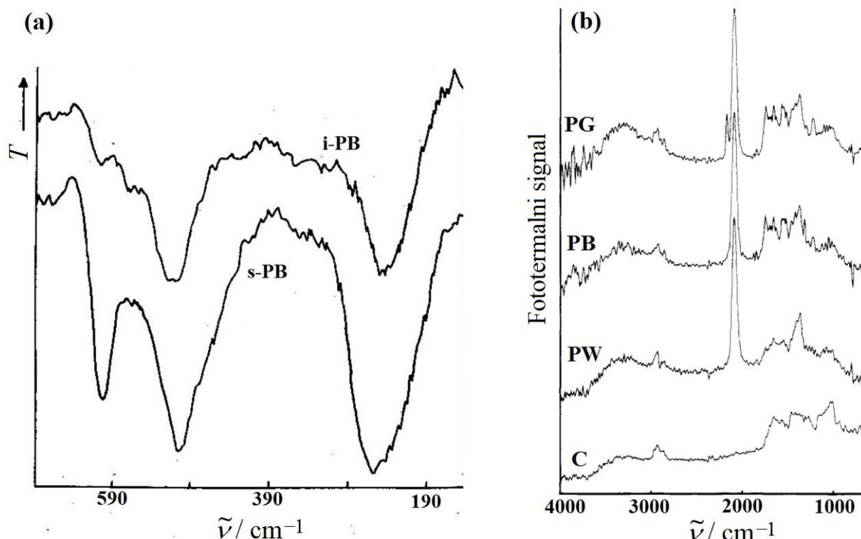
**Slika 2.5.** (a) Spektre kemijski sintetiziranog topljivog (s-PB) i netopljivog (i-PB) berlinskog modrila u dalekom infracrvenom području; (b) FTIR spektri filmova topljivog berlinskog modrila (PB) te njegove reducirane (PW) i oksidirane (PG) forme. Oznakon C obilježen je FTIR spektar grafitne elektrode.
