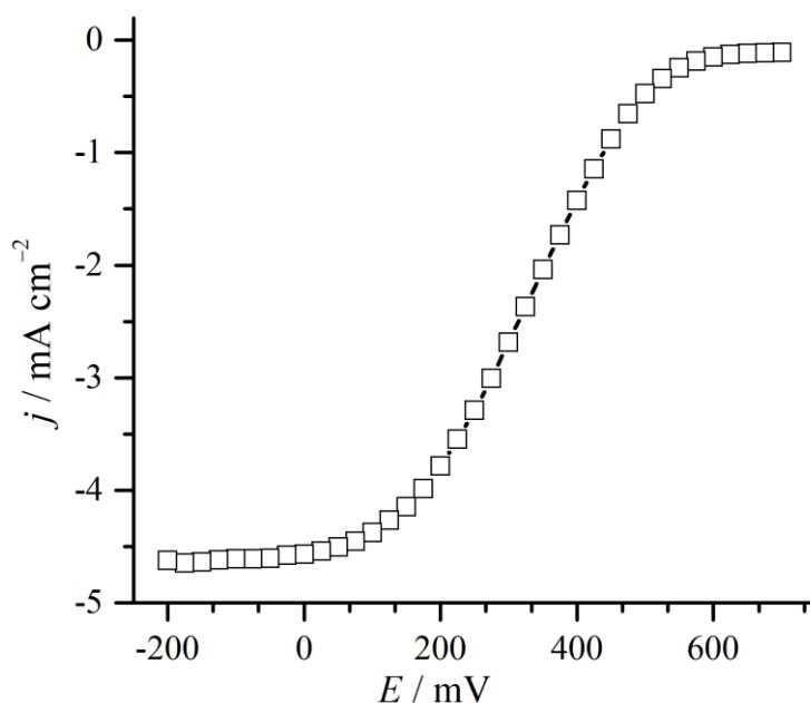
**Slika 4.41.** Hidrodinamički voltamogram redukcije vodikova peroksida na Cs-PB filmu deponiranom na GC elektrodu.  $c(\text{CsCl}) = 0,1 \text{ mol dm}^{-3}$ ,  $c(\text{H}_2\text{O}_2) = 2,75 \text{ mmol dm}^{-3}$ ,  $\text{pH} = 2$ ; brzina rotacije elektrode: 25 Hz.
