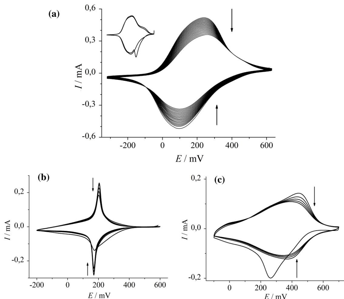
**Slika 4.18.** Ciklički voltamogrami pri pH 6,5 snimljeni u otopinama (a) natrijeva klorida, Au elektroda,  $\Gamma = 3,7 \text{ mC cm}^{-2}$ ; (b) kalijeva klorida, ITO elektroda,  $\Gamma = 4,5 \text{ mC cm}^{-2}$ ; (c) cezijeva klorida, GC elektroda,  $\Gamma = 1,7 \text{ mC cm}^{-2}$ ,  $v = 50 \text{ mV s}^{-1}$ ;  $c (\text{MCl}) = 0,1 \text{ mol dm}^{-3}$ ,  $v = 50 \text{ mV s}^{-1}$ .
