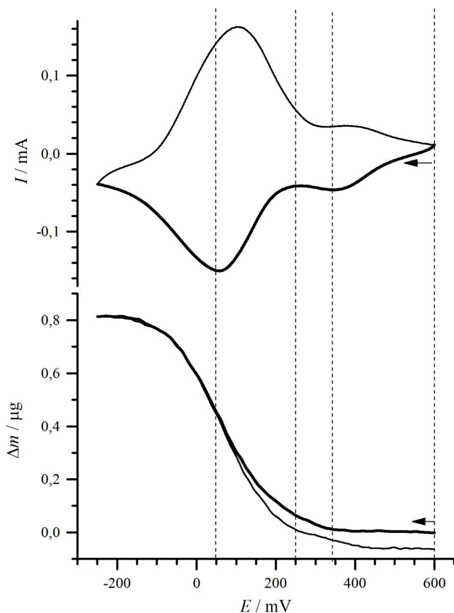
**Slika 4.23.** Ciklički voltamogram i elektrogravimetrijska krivulja (3. ciklus) Na-PB filma deponiranog na Au elektrodu,  $c(\text{NaCl}) = 0,1 \text{ mol dm}^{-3}$ ;  $\text{pH} = 2$ ;  $v = 10 \text{ mV s}^{-1}$ ,  $\Gamma = 5,1 \text{ mC cm}^{-2}$ .
