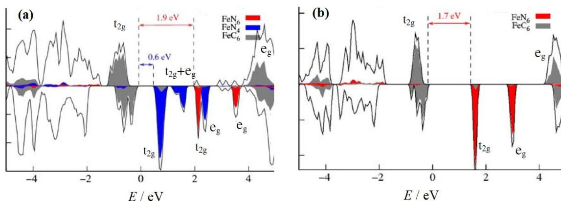
Slika 4.37. Gustoće stanja (DOS) za (a) berlinsko modrilo koje sadrži FeN<sub>6</sub> i FeN<sub>4</sub>O<sub>2</sub> koordinirane ione željeza(III); (b) samo FeN<sub>6</sub> koordinirane ione željeza(III).<sup>[80]</sup>
