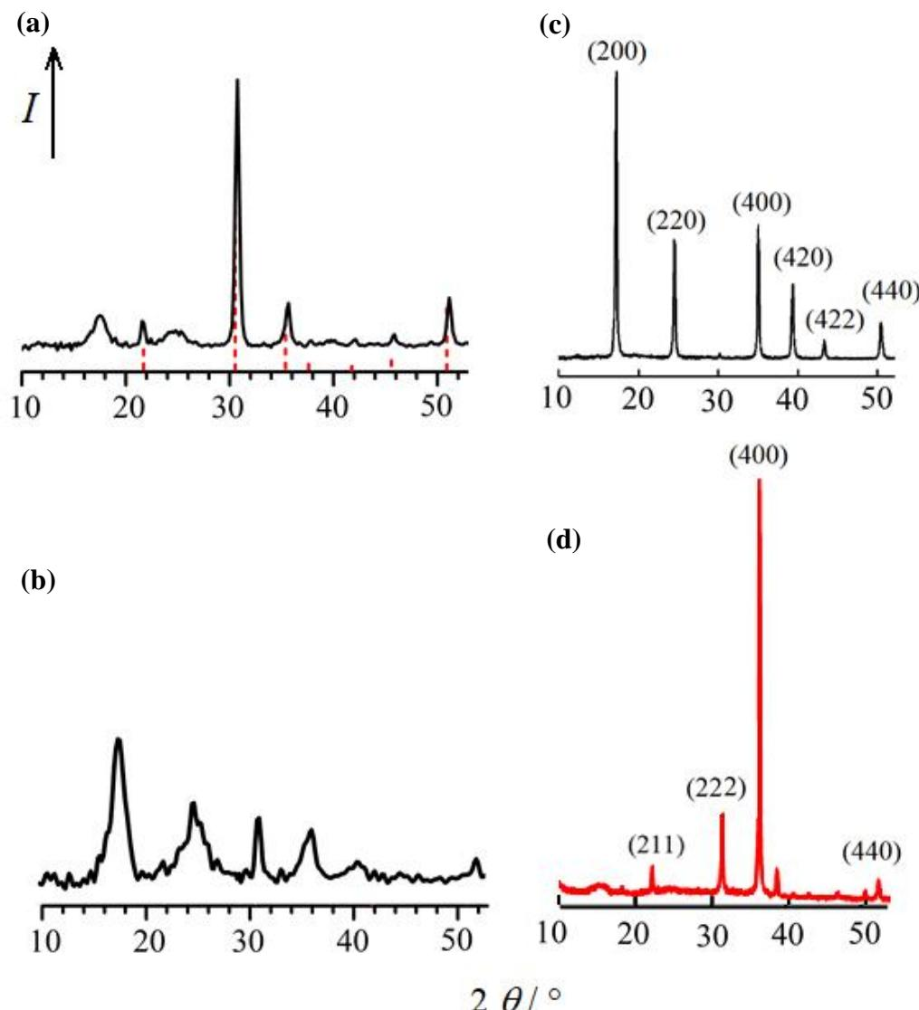
**Slika 4.2.** Difraktogrami sintetiziranog filma berlinskog modrila ( $j = 30 \mu\text{A cm}^{-2}$ ,  $\Gamma = 4,5 \text{ mC cm}^{-2}$ ) (a) snimljenog pod velikim kutem; (b) snimljenog pod malim kutem; (c) netopljivog berlinskog modrila;<sup>[9,67]</sup> (d) ITO nanožice.<sup>[66]</sup>
