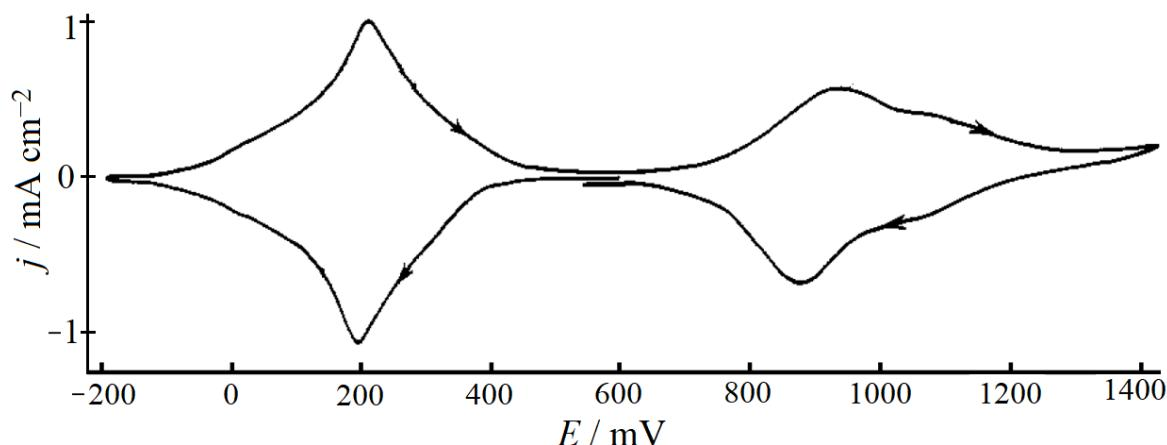
**Slika 2.9.** Ciklički voltamogram potencijostatski sintetiziranog berlinskog modrila na  $\text{SnO}_2$  elektrodi ( $j = 10 \mu\text{A cm}^{-2}$ ) snimljen u otopini kalijevih iona ( $c(\text{K}^+) = 1 \text{ mol dm}^{-3}$ ) pri pH = 4. Referentna elektroda: SCE,  $v = 20 \text{ mV s}^{-1}$ .<sup>[15]</sup>
