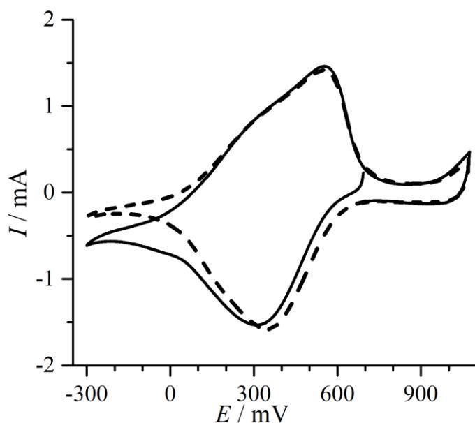
**Slika 4.26.** Ciklički voltamogram filma berlinskog modrila snimljen nakon 2 h stajanja filma grafitne electrode modificirane filmom i-PB u neutralnoj otopini cezijeva klorida,  $c(\text{CsCl}) = 0,1 \text{ mol dm}^{-3}$ . Pri cikličkoj polarizaciji filma pH otopine iznosio je 2; Prvi ciklus (—); drugi ciklus (----);  $v = 10 \text{ mV s}^{-1}$ ,  $\Gamma = 102 \text{ mC cm}^{-2}$ .
