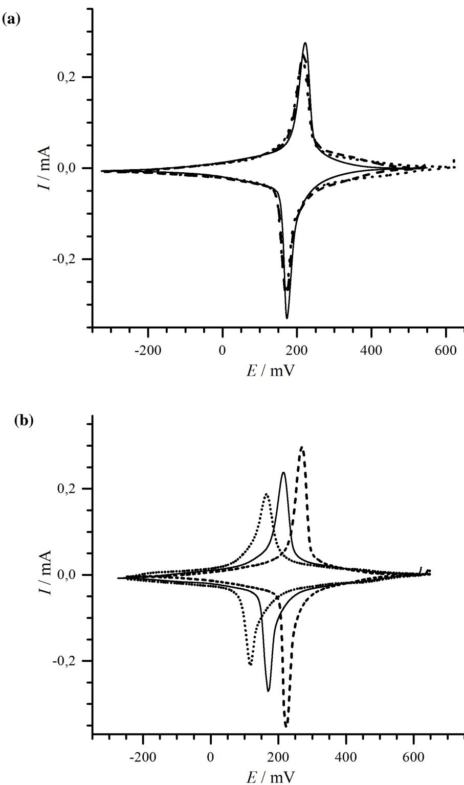
**Slika 4.20.** Ciklički voltamogrami konstantnog odziva filma K-PB deponiranog na ITO elektrodu,  $\Gamma = 4,5 \text{ mC cm}^{-2}$ ,  $v = 10 \text{ mV s}^{-1}$ . (a) (—) pH 2; (----) pH 4; (···) pH 6;  $c(\text{KCl}) = 0,1 \text{ mol dm}^{-3}$ . (b): (···)  $c(\text{KCl}) = 0,01 \text{ mol dm}^{-3}$ ; (—)  $c(\text{KCl}) = 0,1 \text{ mol dm}^{-3}$ , (----)  $c(\text{KCl}) = 1 \text{ mol dm}^{-3}$ ; pH = 2.
