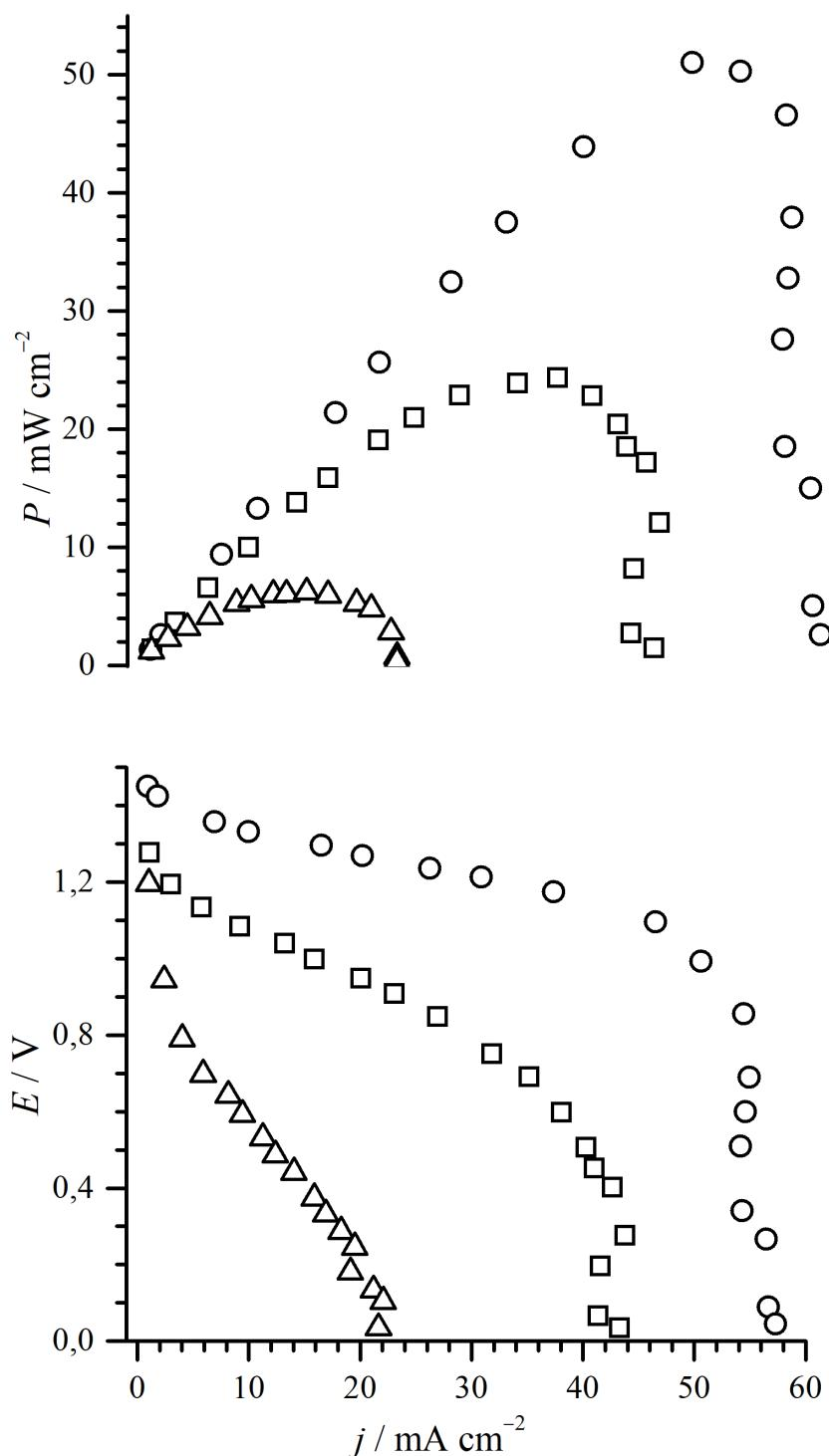
**Slika 4.46.** Karakteristike gorivnog članka koji kao oksidans koristi vodikov peroksid, a kao katodu i-PB ( $\Delta$ ), K-PB ( $\square$ ); odnosno Cs-PB ( $\circ$ ) film deponiran na grafitnu elektrodu.  $I = 20,1 \text{ mC cm}^{-2}$ .  $c(\text{H}_2\text{O}_2) = 0,5 \text{ mol dm}^{-3}$ ,  $c(\text{HCl}) = 1 \text{ mol dm}^{-3}$ , za slučaj K-PB i Cs-PB  $c(\text{MCl}) = 0,1 \text{ mol dm}^{-3}$  ( $M = \text{K}, \text{Cs}$ ).
