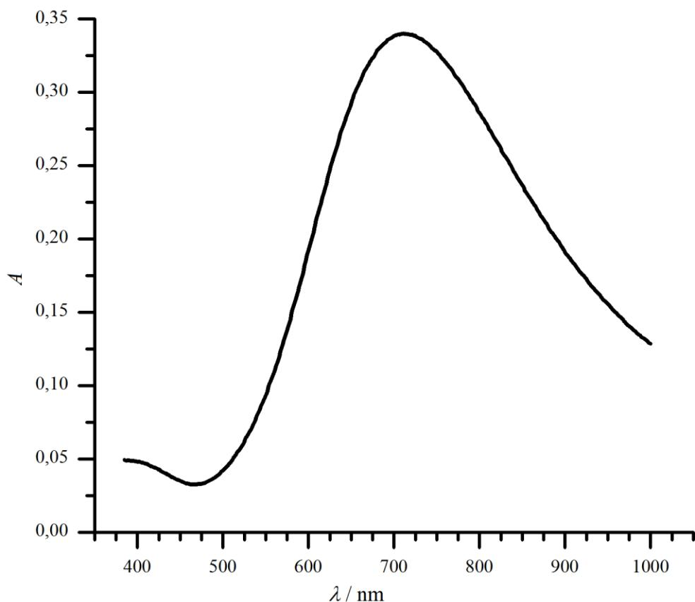
**Slika 4.5.** Apsorpcijski spektar filma berlinskog modrila ( $j = 30 \mu\text{A cm}^{-2}$ ), debljine oko 100 nm, deponiranog na transparentnu ITO elektrodu. Spektar pri kraćim valnim duljinama nije prikazan zbog intenzivne apsorpcije materijala elektrode u tom području.
