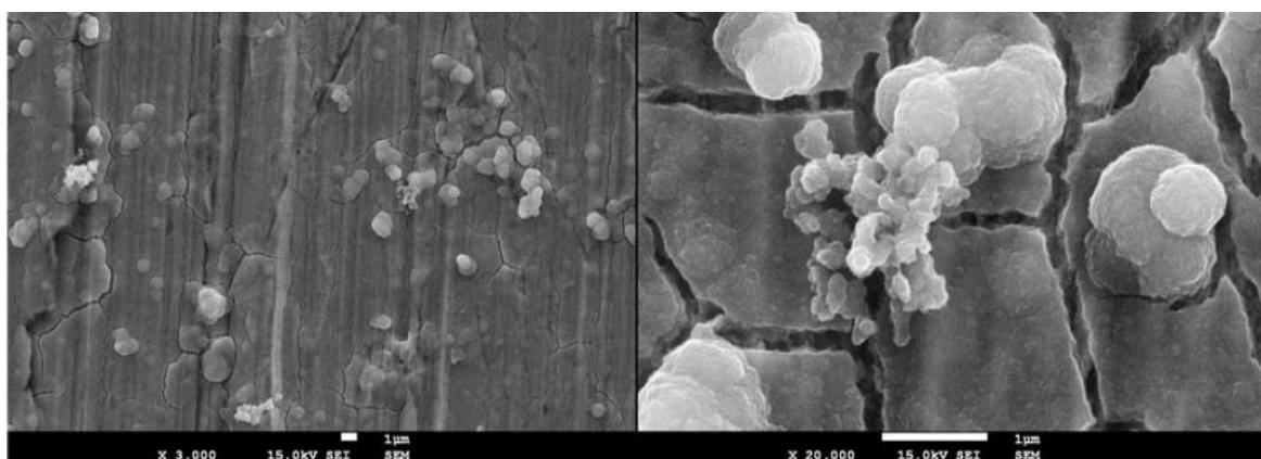
**Slika 2.6.** Fotografije berlinskog modrila deponiranog na platinsku elektrodu snimljena pomoću pretražnog elektronskog mikroskopa.<sup>[19]</sup>
