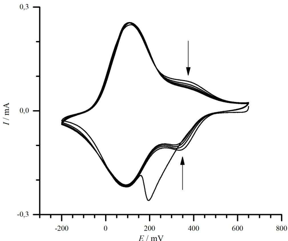
**Slika 4.8.** Ciklički voltamogram i-PB filma deponiranog na GC elektrodu u otopini natrijeva klorida množinske koncentracije  $c(\text{NaCl}) = 0,1 \text{ mol dm}^{-3}$ ;  $\text{pH} = 3$ ,  $v = 50 \text{ mV s}^{-1}$ ;  $\Gamma = 1,7 \text{ mC cm}^{-2}$ .
