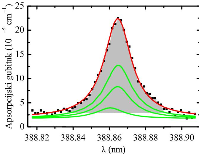
**Slika 5.13:** Izmjereni apsorpcijski profil na helijevim metastabilima; zelene linije predstavljaju funkcije prilagodbe za pojedinačne prijelaze, a crvena linija njihovu sumu. Sivom bojom označena je površina ispod crvene krivulje iz koje se određuje koncentracija čestica
