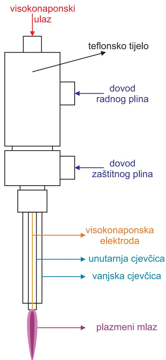
**Slika 4.1:** 2D shema plazmenog reaktora
