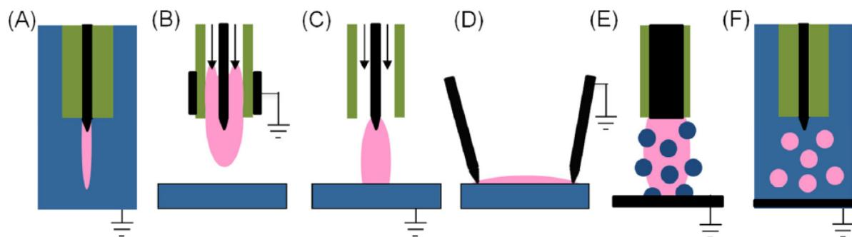
**Slika 2.4:** Sheme različitih vrsta izboja korištenih u interakciji plazme i tekućine: a) direktni izboj u tekucini, b-d) izboji u plinskoj fazi, e-f) višefazni izboji. Preuzeto iz [125]
