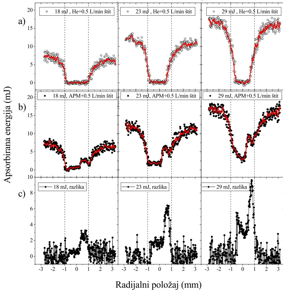
**Slika 5.38:** Apsorbirana energija lasera ovisno o položaju fokusa lasera u odnosu na os kapilare, za  $E=18, 23, 29 \text{ mJ}$ , u slučaju dodatnog štita helija s protokom  $0.5 \text{ L/min}$  za a) neutralnu metu, b) predioniziranu metu (maksimum izboja), i c) razlika apsorbiranih energija. Puna linija predstavlja zaglađene vrijednosti.
