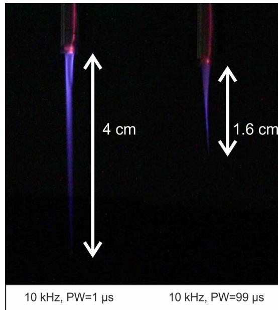
**Slika 5.9:** Fotografije plazmenog mlaza u slučaju pulsa trajanja  $1 \mu\text{s}$  (lijevo) i  $99 \mu\text{s}$  na repeticiji  $10 \text{ kHz}$ , protok helija  $2 \text{ slpm}$ , amplituda napona  $4 \text{ kV}$
