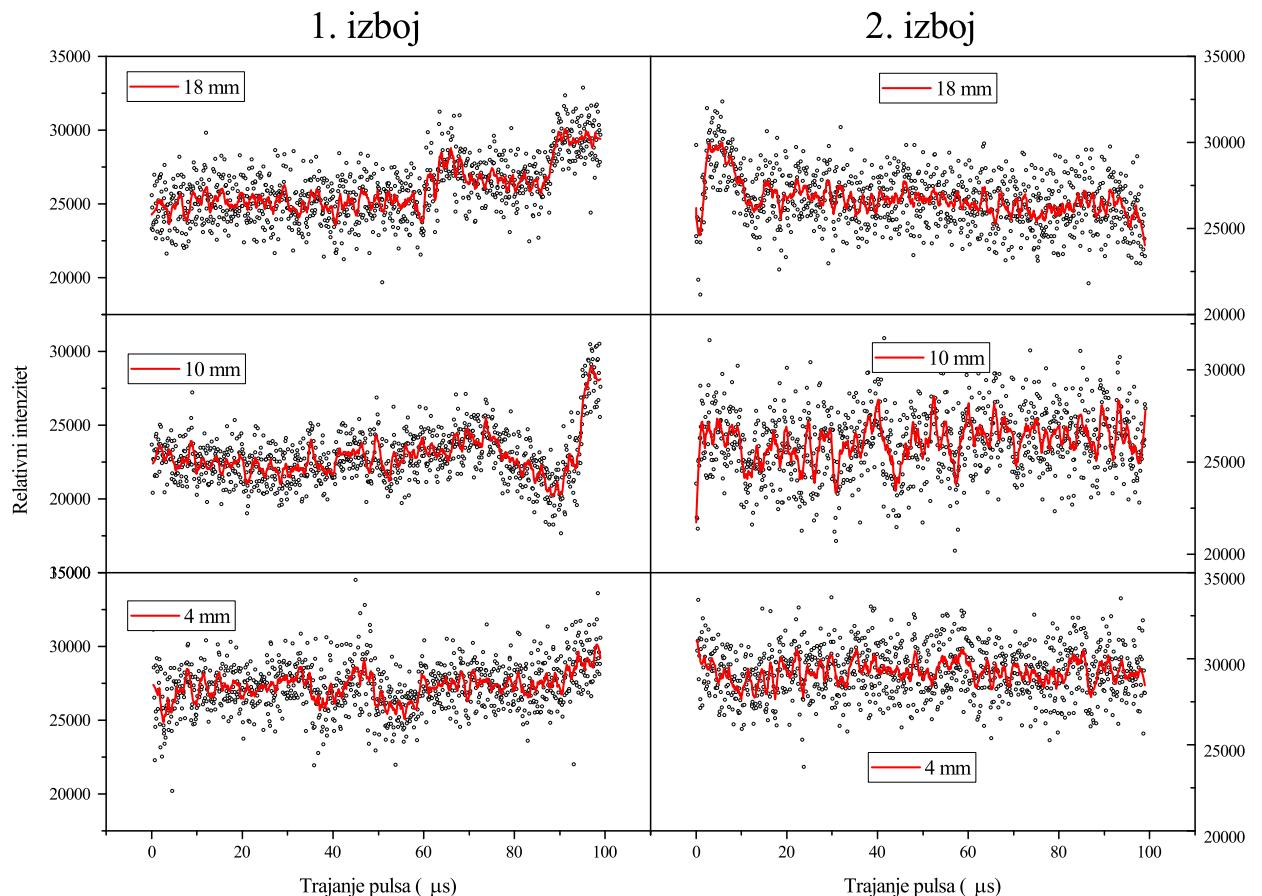
**Slika 5.51:** Ovisnost emisijskog intenziteta (He 588 nm) o širini naponskog pulsa kad je laserski puls fiksiran u vremenu na primarni izboj (lijevo) i sekundarni izboj (desno) kada je plazmeni mlaz u kontaktu s vodom na udaljenostima od 18, 10 i 4 mm, energija lasera 45 mJ,  $V=4$  kV
