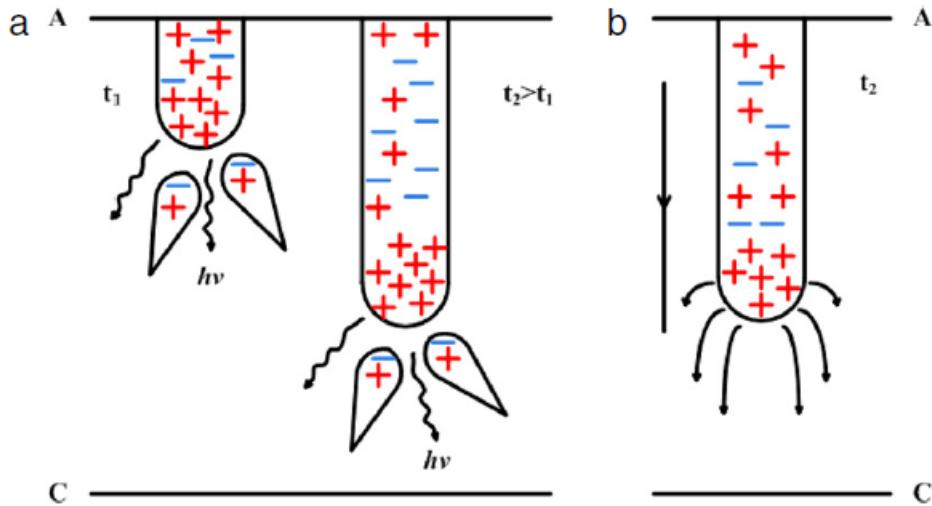
**Slika 2.1:** Strimer usmjeren prema katodi. a) Strimer u dva bliska trenutka, sa sekundarnom lavinom elektrona koji se kreću prema pozitivnoj glavi strimera. b) Silnice električnog polja blizu glave strimera. Preuzeto iz [65]
