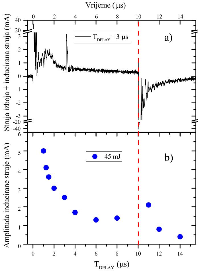
**Slika 5.33:** a) Struja izboja zajedno sa strujom induciranoj laserom za  $T_{DELAY} = 3 \mu s$  i b) amplituda struje inducirane laserom za različiti  $T_{DELAY}$ . Energija lasera 45 mJ.
