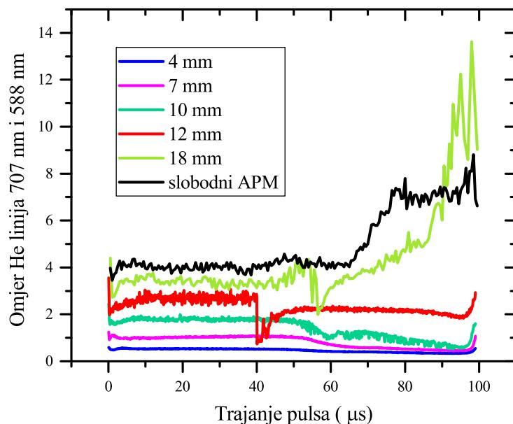
**Slika 5.59:** Omjer relativnih intenziteta helijevih linija na 707 nm i 588 nm, ovisno o trajanju naponskog pulsa, za slobodni plazmeni mlaz i vodu na udaljenosti od 18, 12, 10, 7 i 4 mm, amplituda napona 4 kV
