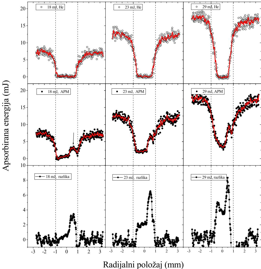
**Slika 5.37:** Apsorbirana energija lasera ovisno o položaju fokusa lasera u odnosu na os kapilare, za  $E=18, 23, 29 \text{ mJ}$ , za a) neutralnu metu (protok helija  $2 \text{ L/min}$ ), b) predioniziranu metu (maksimum izboja), i c) razlika apsorbiranih energija. Puna linija predstavlja zaglađene vrijednosti.
