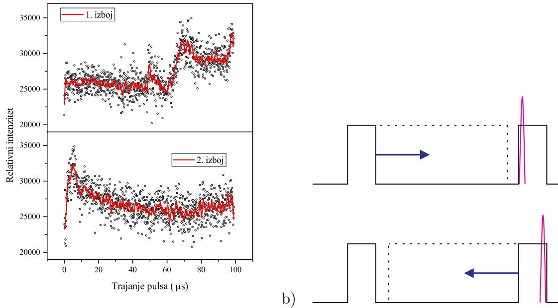
**Slika 5.50:** a) Ovisnost emisijskog intenziteta vrha helijeve linije na 588 nm o širini naponskog pulsa kada je laserski puls fiksiran u vremenu na primarni izboj (lijevo gore) i sekundarni izboj (lijevo dolje) i b) shema promjene širine pulsa dok je laser fiksiran u vremenu u odnosu na napon, energija lasera je 45 mJ,  $V=4$  kV
