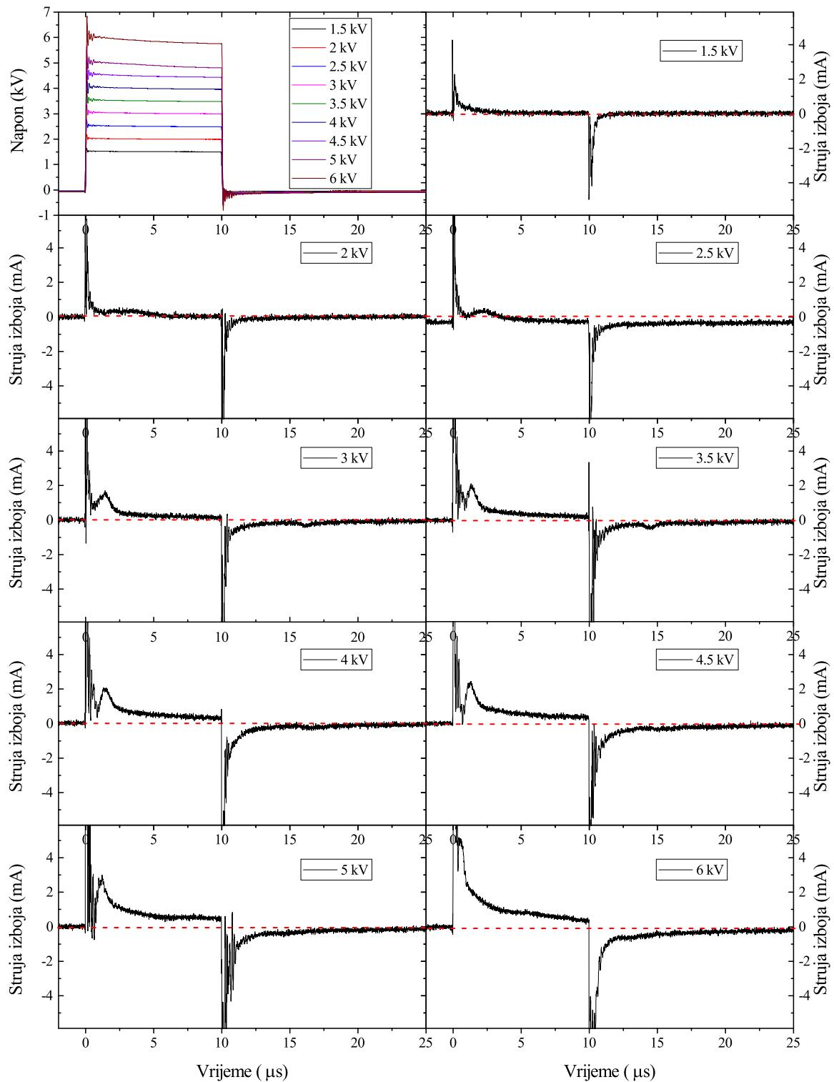
**Slika 5.4:** Valne forme napona i struja izboja za amplitude napona 1.5, 2, 2.5, 3, 3.5, 4, 4.5, 5 i 6 kV, za pulseve širine  $10 \mu\text{s}$  i repeticije 10 kHz, za  $R_{S1} = 0.8 \text{ k}\Omega$
