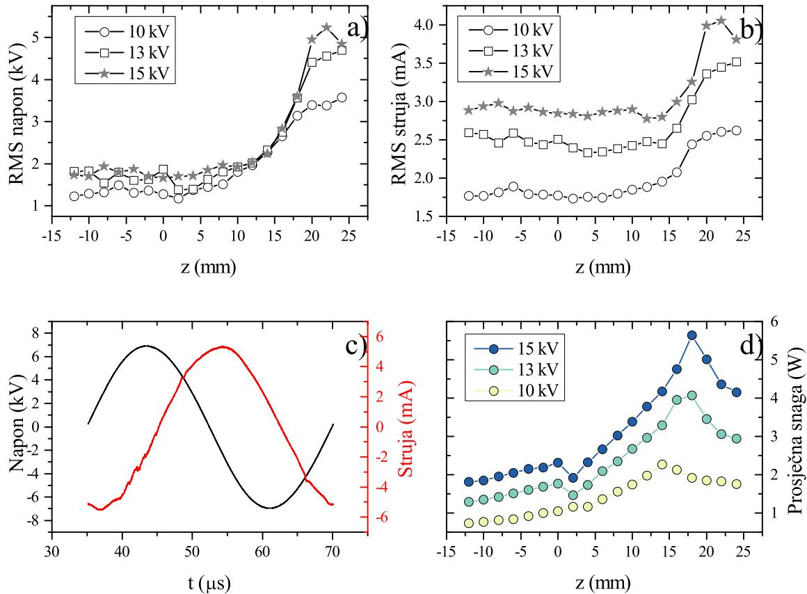
**Slika 5.53:** a) RMS vrijednost napona za različite udaljenosti vode i kapilare, b) RMS vrijednost struje za različite udaljenosti vode i kapilare, c) napon i struja u vremenu, d) ovisnost prosječne snage o udaljenosti vode i kapilare za napone amplitude 10, 13 i 15 kV
