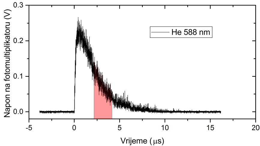
**Slika 5.25:** Primjer signala na fotomultiplikatoru za optičku rešetku monokromatora namještenu na vrh linije He 588 nm, te primjer vremenskog prozora u kojem se signal integrira
