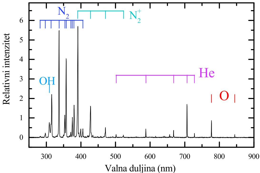
**Slika 5.1:** Emisijski spektar atmosferskog plazmenog mlaza helija za napon amplitude 4 kV, puls širine  $10 \mu\text{s}$ , repeticije 10 kHz, vrijeme integracije 1 s.
