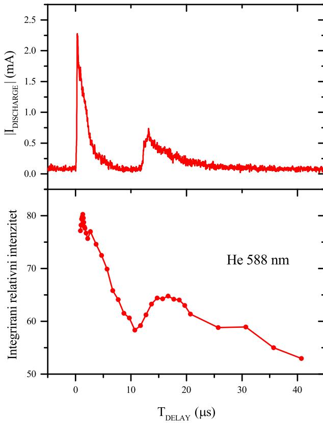
**Slika 5.27:** Usporedba ukupnog integriranog optičkog emisijskog intenziteta helijeve linije na 588 nm (dolje) sa strujom izboja (gore), za puls napona brzog porasta i sporog pada, amplitude napona 3 kV
