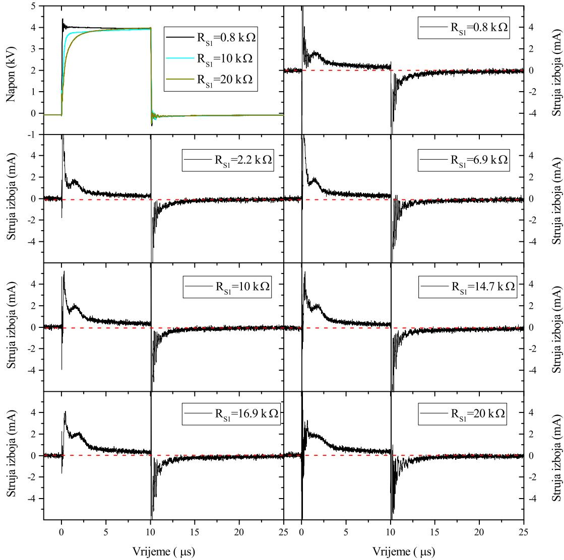
**Slika 5.7:** Struja izboja za različite vrijednosti otpora  $R_{S1}$ . Valna forma napona prikazana je za  $R_{S1} = 0.8, 10$  i  $20\text{ k}\Omega$ .
