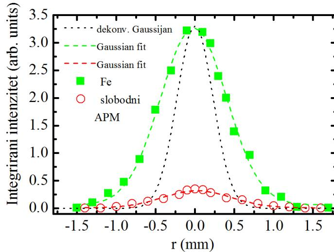
**Slika 5.18:** Radijalna raspodjela integriranog intenziteta 1 mm od vrha kapilare za slobodni plazmeni mlaz i za APM u kontaktu s željeznom metom udaljenom 3 mm od kapilare. Zelene i crvene točke su izmjerene vrijednosti, iscrtkane linije su prilagodbe Gaussijana na mjerene vrijednosti, a točkaste linije su dekonvolucija laserskog profila i Gaussijana prilagodenog na mjerenu vrijednost u slučaju željezne mete
