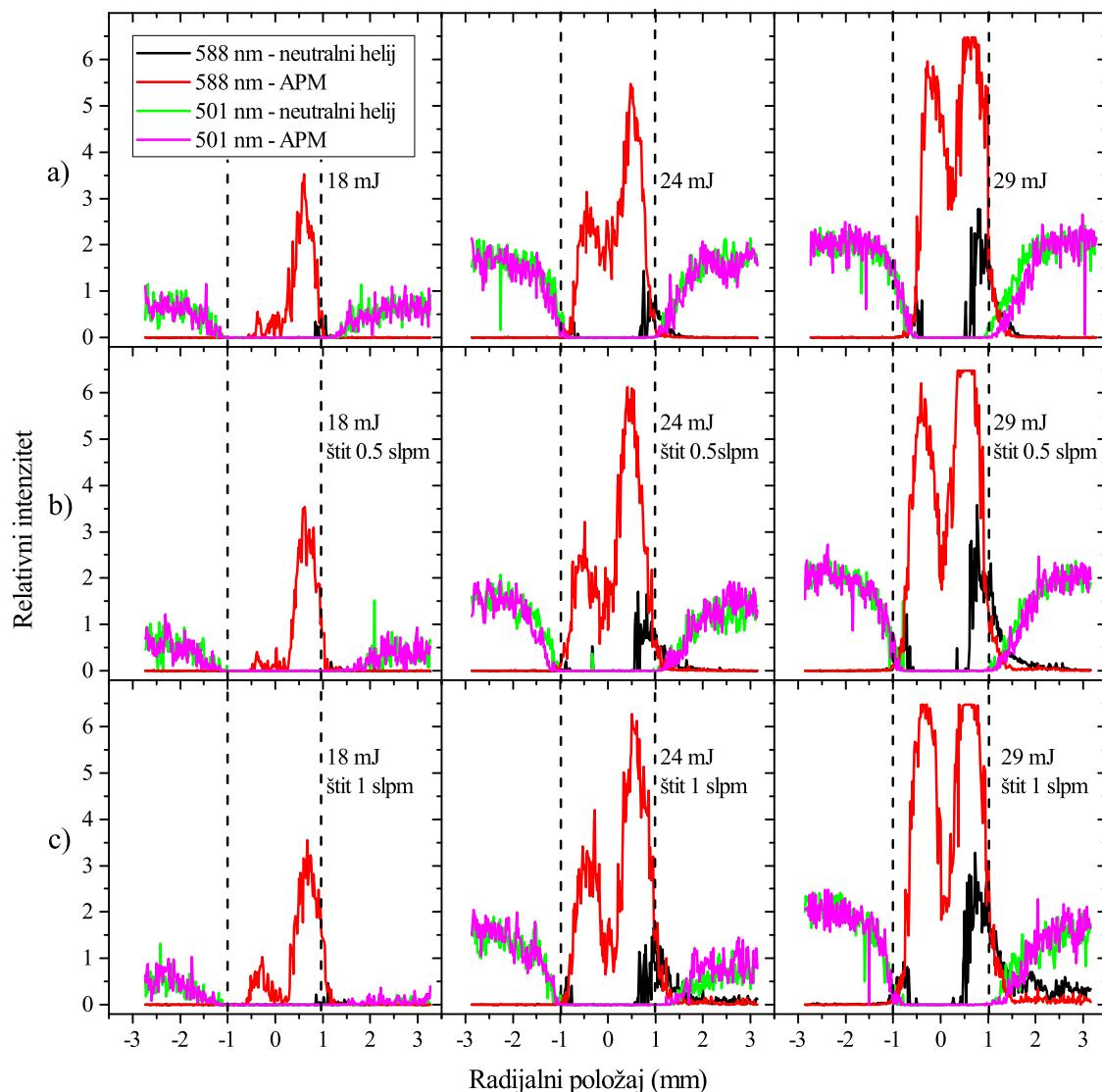
**Slika 5.40:** Emisijski intenziteti helijeve atomske linije na 588 nm i dušikove ionske linije na 501 nm, ovisno o položaju fokusa lasera u odnosu na os kapilare, za  $E=18, 24, 29 \text{ mJ}$ , u slučaju neutralne i predionizirane mete (maksimum izboja), za protok helija od a) 2 slpm, b) 2slpm i štitom 0.5 slpm, c) 2 slpm i štitom 1 slpm
