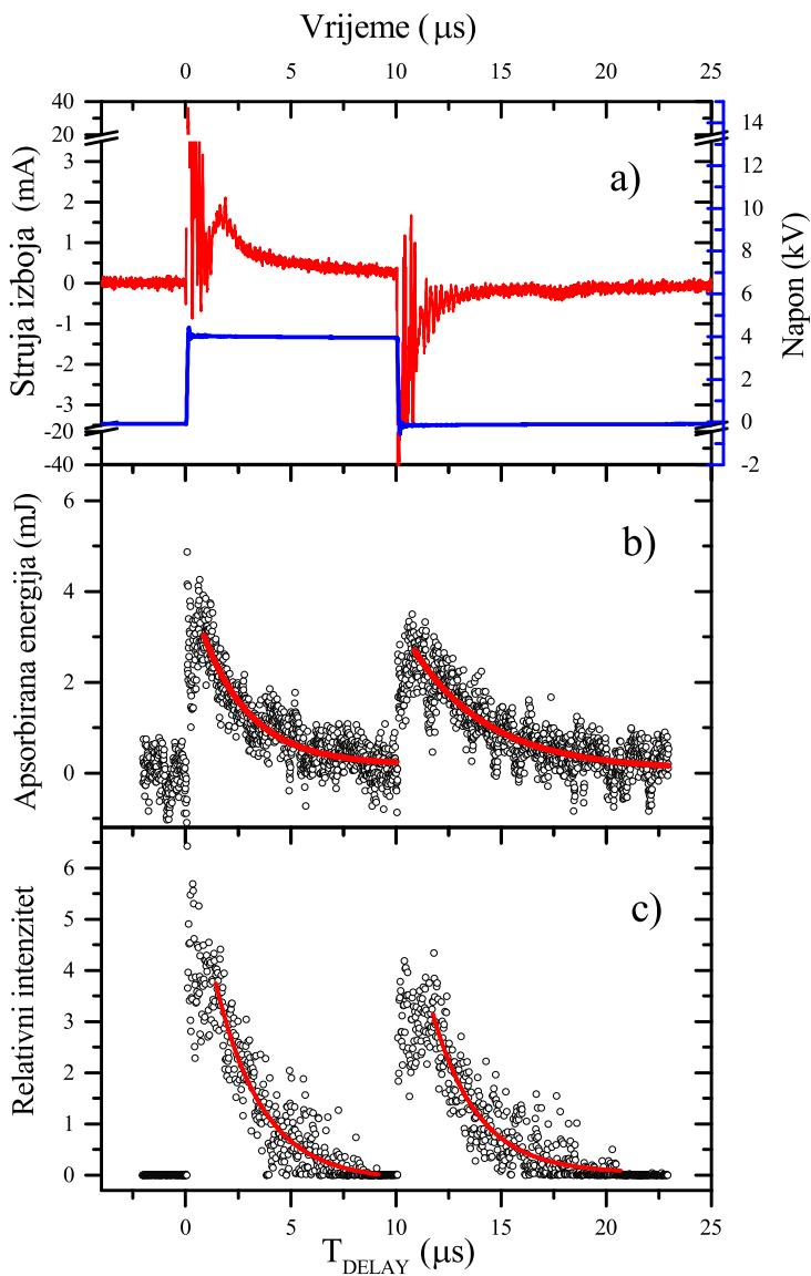
**Slika 5.32:** a) Vremenska ovisnost struje izboja (crveno) i napona (plavo), b) apsorbirana energija lasera ovisno o kašnjenju između naponskog i laserskog pulsa i c) emisijski intenzitet laserske plazme na 588 nm ovisno o kašnjenju između naponskog i laserskog pulsa, za energiju lasera 29 mJ. Crvene krivulje na grafu pod b) i c) su prilagodba eksponencijalne funkcije na podatke.
