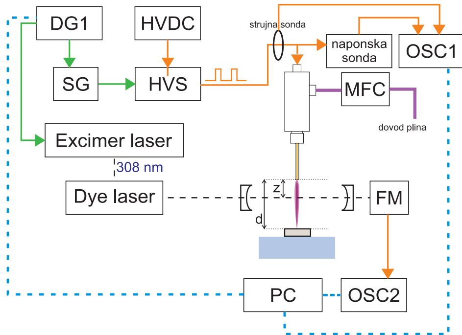
**Slika 4.11:** Eksperimentalni postav korišten za CRDS mjerjenja. DG1 - generator kašnjenja signala, HVDC - izvor visokog (DC) napona, SG - generator signala, HVS - visokonaponska sklopka, OSC - osciloskop, FM - fotomultiplikator, MFC - mjerač protoka plina, PC - računalo. Plavim crtkanim linijama označena je digitalna komunikacija, narančastom analogni signal, a punim zelenim signal okidanja.
