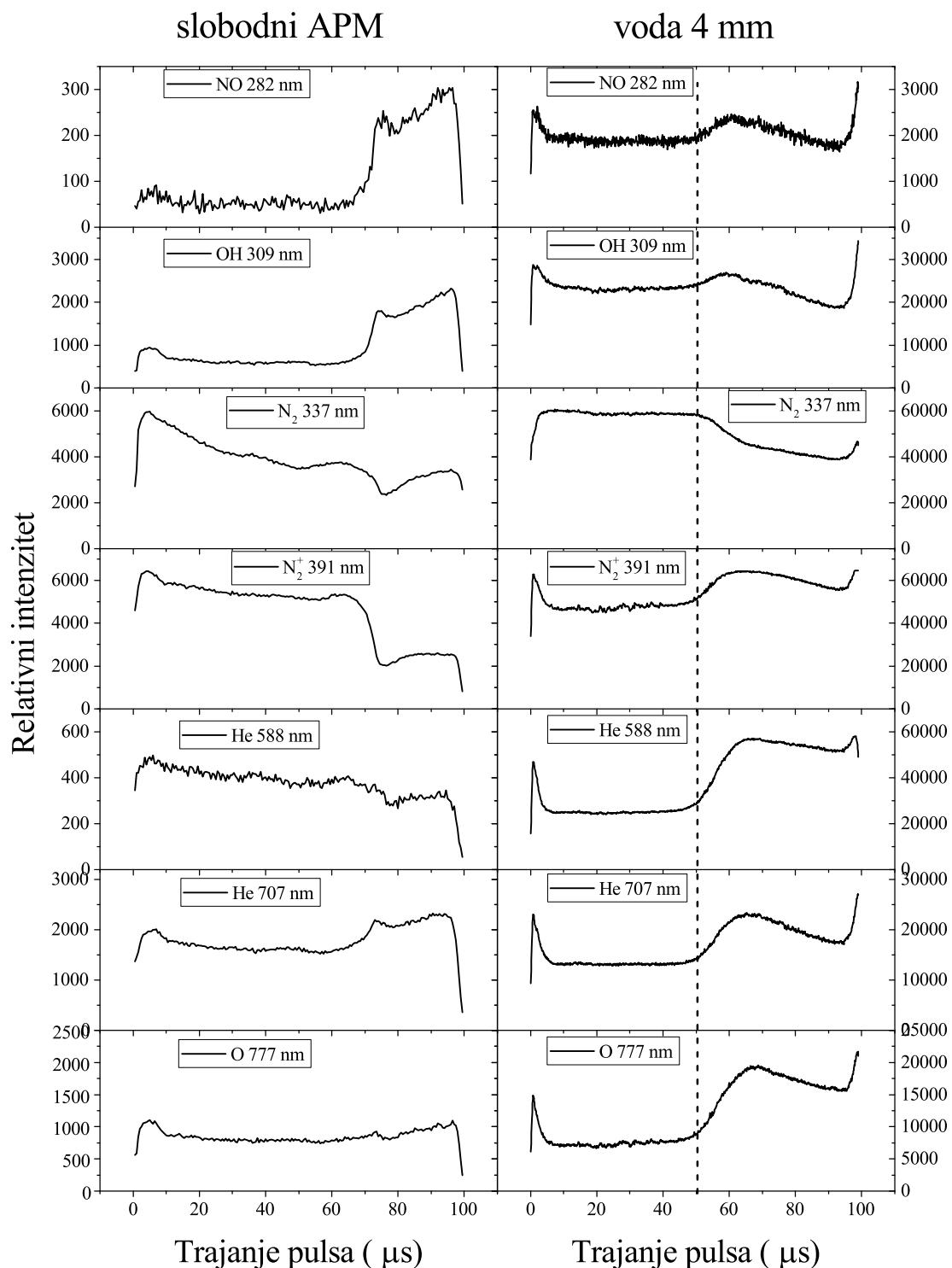
**Slika 5.58:** Relativni emisijski intenziteti za različite vrste, ovisno o trajanju naponskog pulsa, u slučaju slobodnog plazmenog mlaza (lijevo) i s vodom na udaljenosti 4 mm (desno), amplituda napona 4 kV
