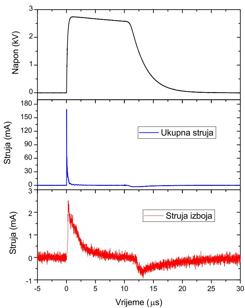
**Slika 4.5:** Valne forme a) napona, b) ukupne struje i c) struje izboja za napon amplitude 3 kV, puls širine 10  $\mu$ s, za sklopku Behlke HTS 151-02
