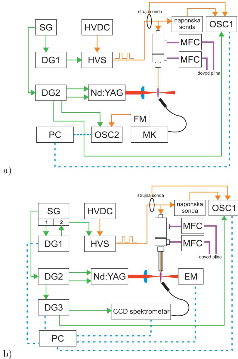
**Slika 4.7:** Shema eksperimentalnog postava za vremenski razlučivu optičku emisiju spektroskopiju s a) fotomultiplikatorom i b) CCD spektrometrom. SG - generator signala, DG - generator kašnjenja signala, HVDC - izvor visokog (DC) napona, HVS - visokonaponska sklopka, Nd:YAG - nanosekundni laser, FM - fotomultiplikator, MK - monokromator, MFC - mjerač protoka plina, OSC - osciloskop, PC - računalo, EM - detektor za mjerjenje energije laserskog pulsa.
