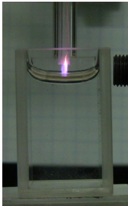
**Slika 5.56:** Fotografija plazmenog mlaza u kontaktu s vodom. Širina pulsa 99  $\mu$ s, repeticija 10 kHz, protok helija 2 slpm.
