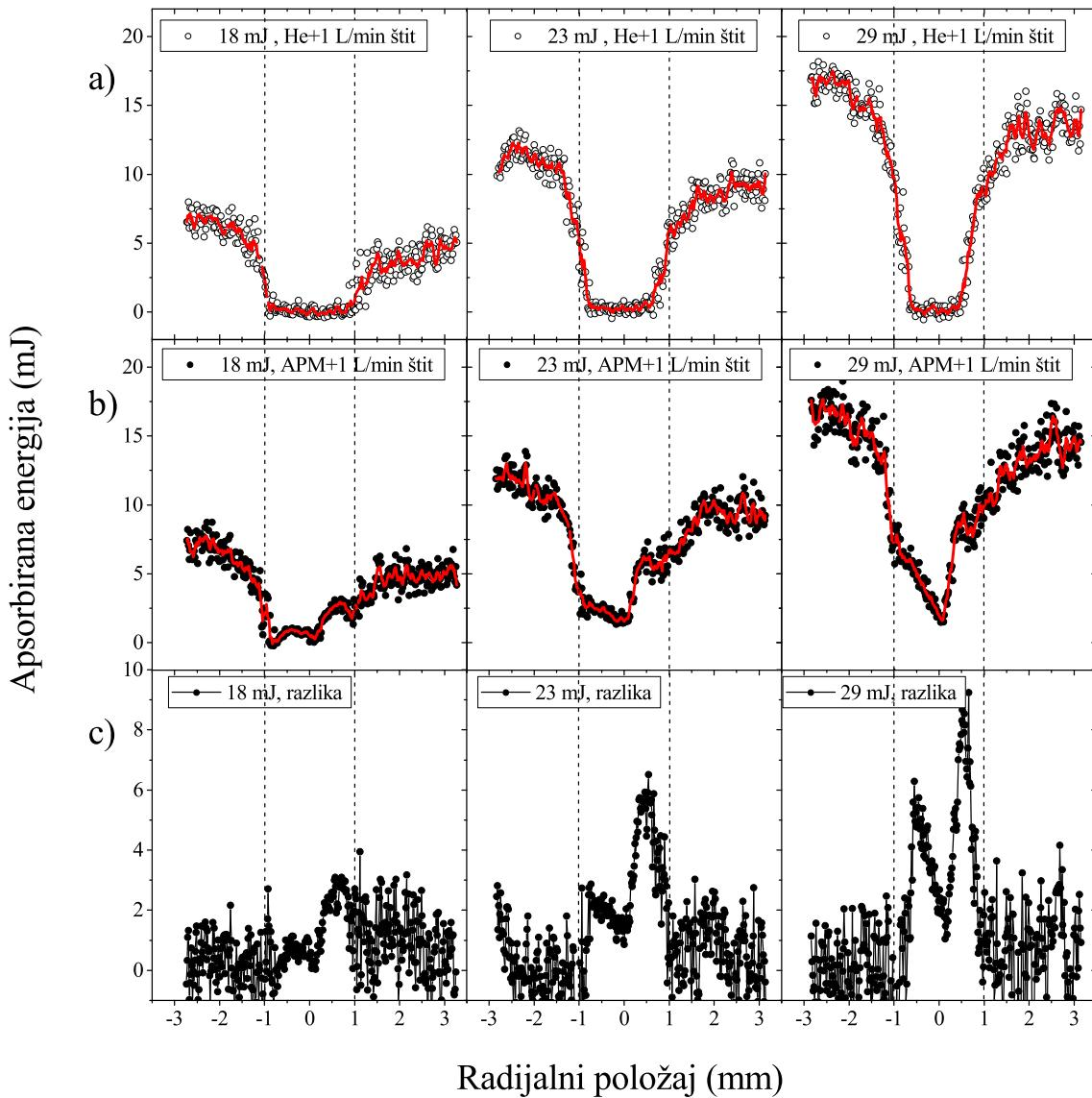
**Slika 5.39:** Apsorbirana energija lasera ovisno o položaju fokusa lasera u odnosu na os kapilare, za  $E=18, 23, 29 \text{ mJ}$ , u slučaju dodatnog štita helija s protokom 1 L/min za a) neutralnu metu, b) predioniziranu metu (maksimum izboja), i c) razlika apsorbiranih energija. Puna linija predstavlja zaglađene vrijednosti.
