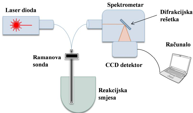
Slika 2.11. Shematski prikaz mjerjenja disperzivnom Ramanovom spektroskopijom *in-line*.
