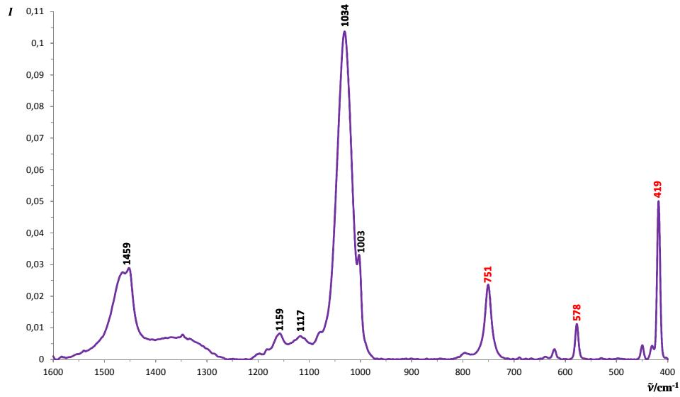
Slika 8.3. Obrađeni Ramanov spektar *off-line* metanola u području valnih brojeva od 1600 cm<sup>-1</sup> do 400 cm<sup>-1</sup>.
