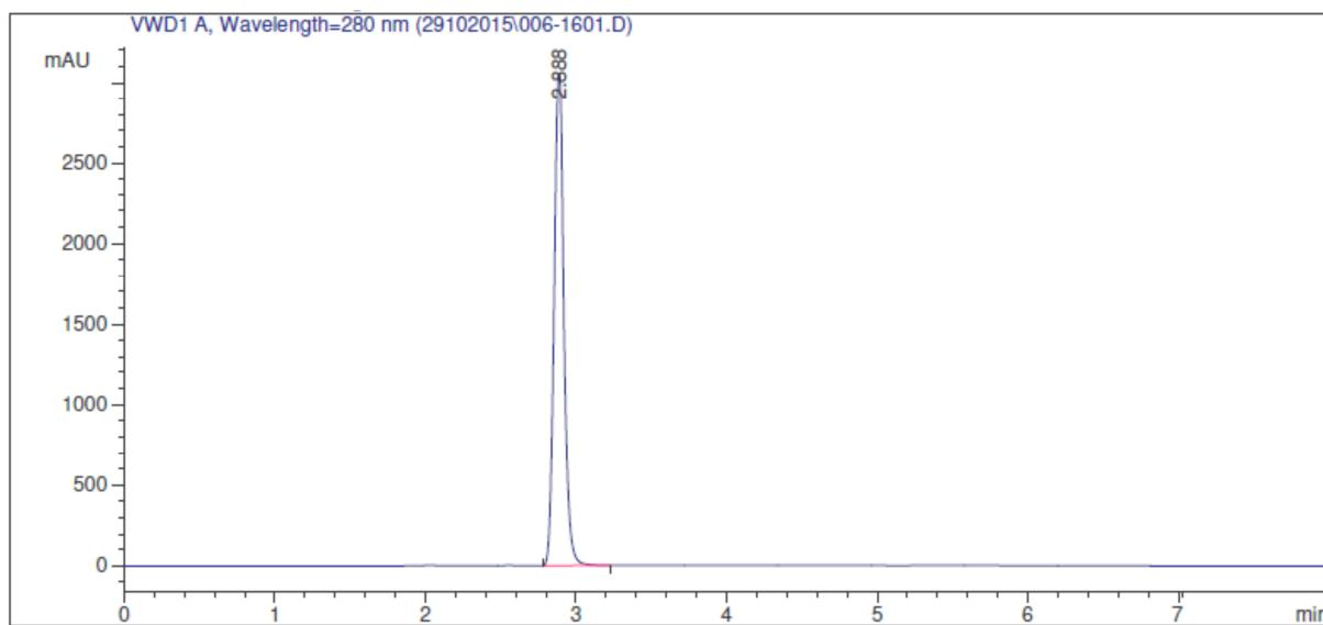
Slika 8.13. Kromatogram prekristaliziranog spoja **2**. Retencijsko vrijeme: 2,89 min.
