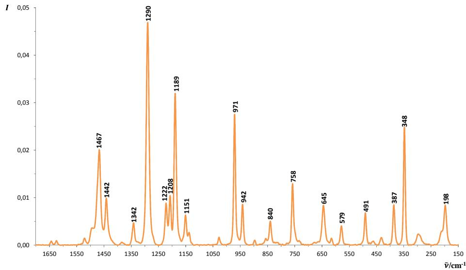
Slika 8.1. Obrađeni Ramanov spektar *off-line* spoja MTX u čvrstom stanju u području valnih brojeva od  $1700 \text{ cm}^{-1}$  do  $150 \text{ cm}^{-1}$ . Snaga lasera pri mjerenu iznosila je  $100 \text{ mW}$ .
