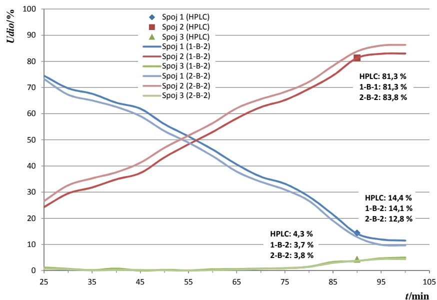
Slika 4.73. Tijek reakcije tijekom probnog eksperimenta u 7 L mjerilu.
