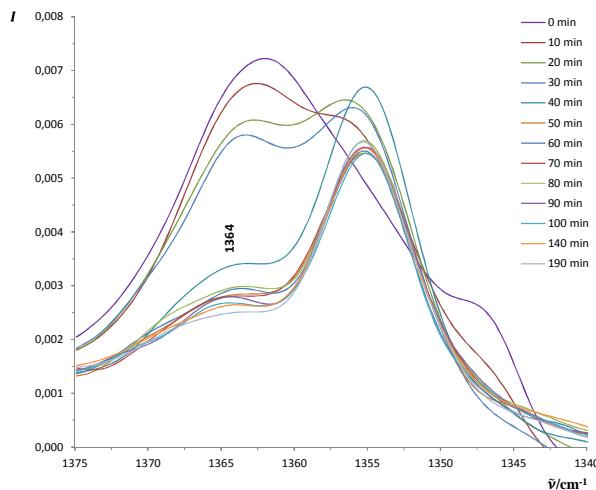
Slika 4.75. Normirani Ramanovi spektri *in-line* izmjereni tijekom kristalizacije produkta u kalibracijskom eksperimentu 6 u području od  $1600 \text{ cm}^{-1}$  do  $400 \text{ cm}^{-1}$  uz korekciju bazne linije i višestrukog raspršenja.
