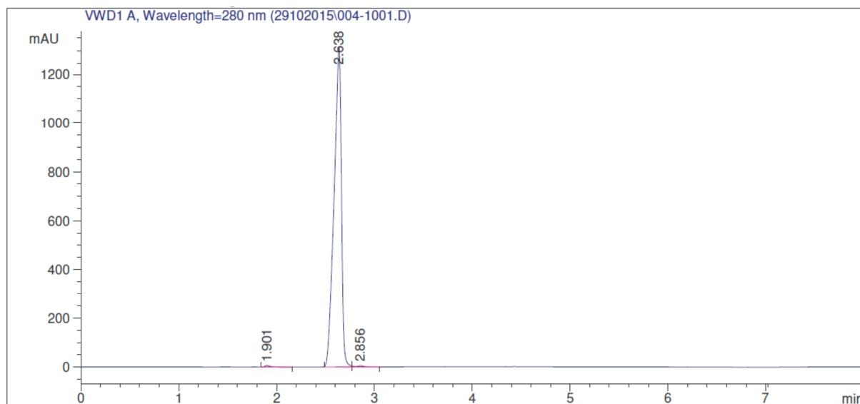
Slika 8.13. Kromatogram prekristaliziranog spoja **3**. Retencijsko vrijeme: 2,64 min.
