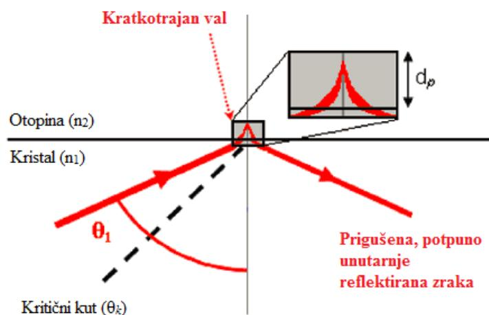
Slika 2.17. Shematski prikaz refleksije unutar ATR kristala.<sup>46</sup>
