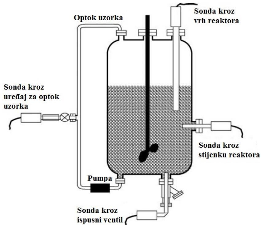
Slika 2.3. Shematski prikaz principa *in-line* i *on-line*.<sup>9</sup>
