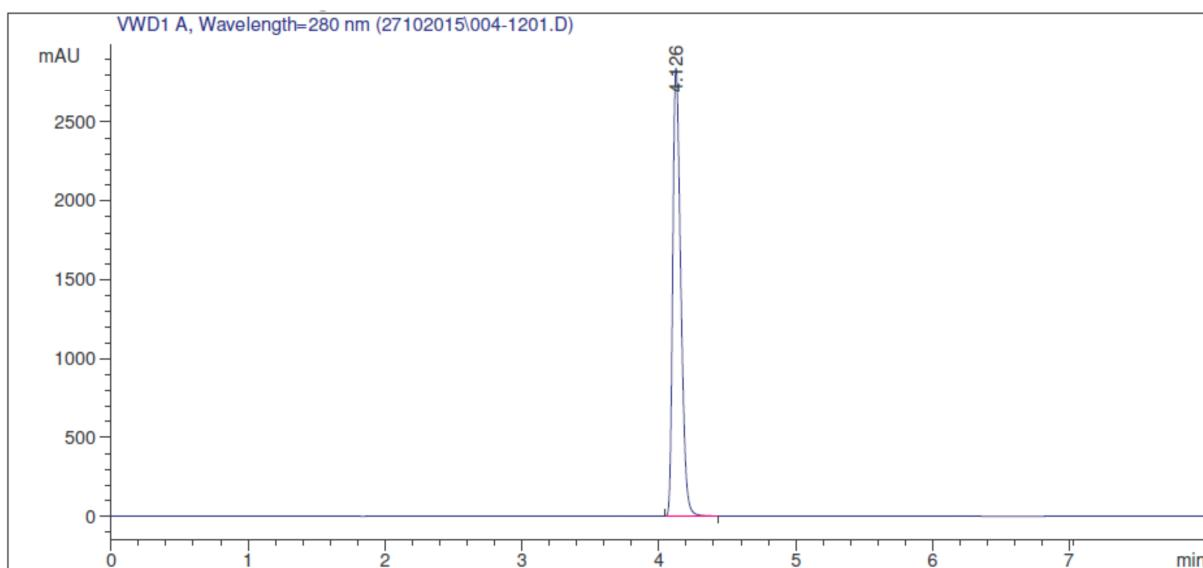
Slika 8.13. Kromatogram spoja 1. Retencijsko vrijeme: 4,13 min. Kromatografska čistoća: 100,0 %.
