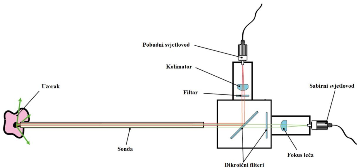
Slika 2.12. Shematski prikaz sonde i glave sonde s putevima laserskog i raspršenog zračenja.<sup>16</sup>
