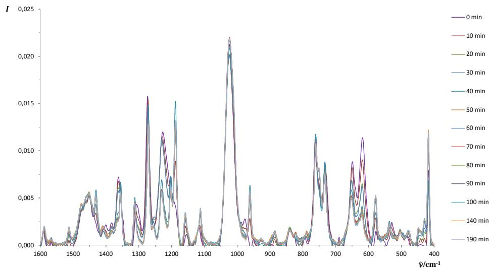
Slika 4.74. Normirani Ramanovi spektri *in-line* izmjereni tijekom kristalizacije produkta u kalibracijskom eksperimentu 6 u području od  $1600\text{ cm}^{-1}$  do  $400\text{ cm}^{-1}$  uz korekciju bazne linije i višestrukog raspršenja.
