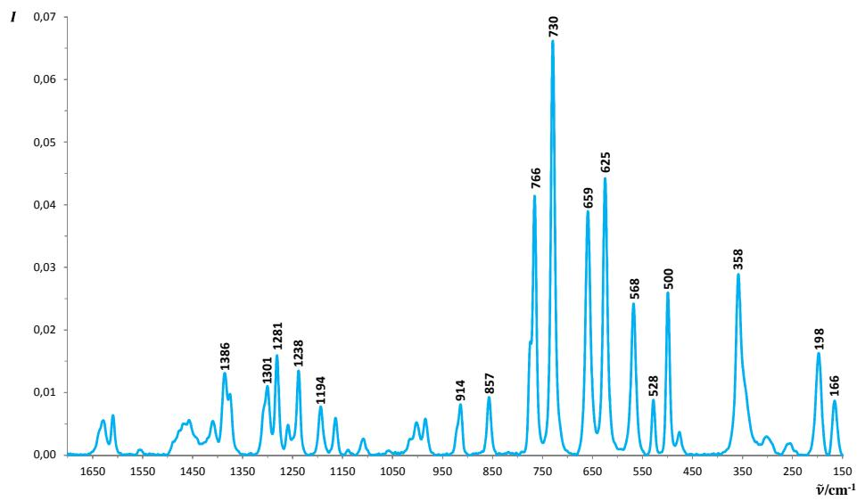
Slika 8.2. Obrađeni Ramanov spektar *off-line* spoja OMP-Cl x HCl u čvrstom stanju u području valnih brojeva od  $1700 \text{ cm}^{-1}$  do  $150 \text{ cm}^{-1}$ . Snaga lasera pri mjerenu iznosila je  $100 \text{ mW}$ .
