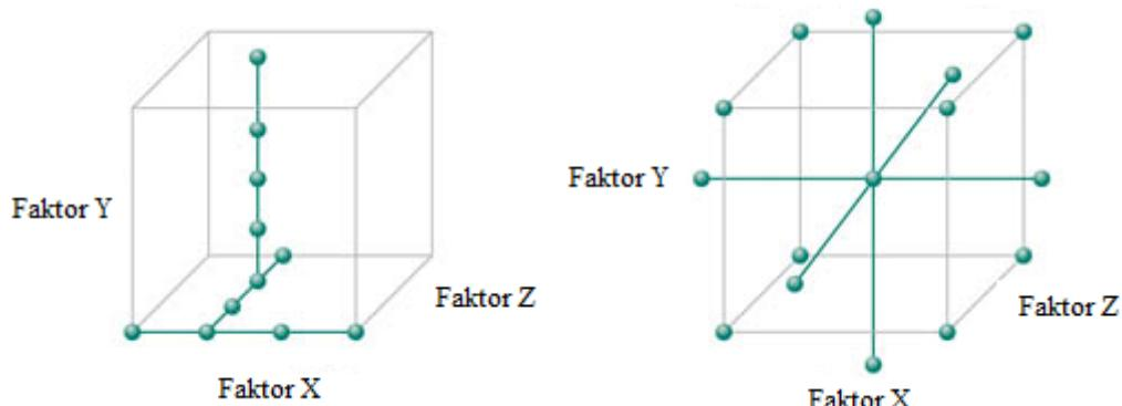
Slika 2.1. Shematski prikaz OVAT (lijevo) i DoE pristupa (desno) definiranju prostora dizajna za tri ispitivana parametra.<sup>8</sup>
