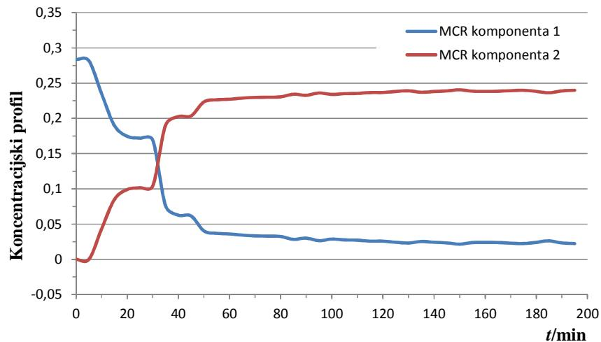
Slika 4.78. Rezultat MCR-ALS analize Ramanovih spektara *in-line* izmjerениh tijekom kristalizacije spoja **2** nakon reakcije oksidacije, prikazan kao vremenski trend koncentracijskog profila za MCR komponente 1 i 2.
