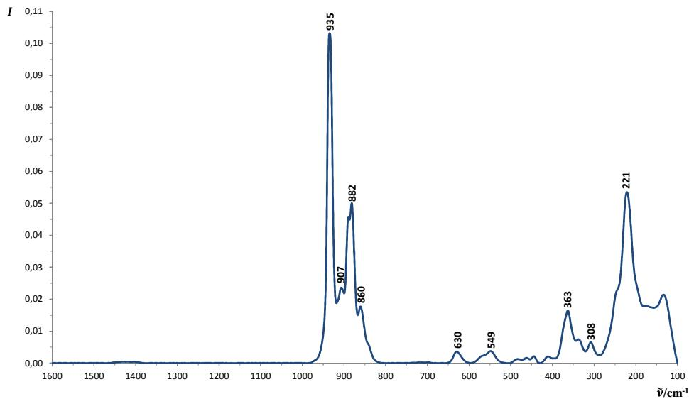
Slika 8.4. Obrađeni Ramanov spektar *off-line* spoja AHM u čvrstom stanju u području valnih brojeva od 1600 cm<sup>-1</sup> do 100 cm<sup>-1</sup>.
