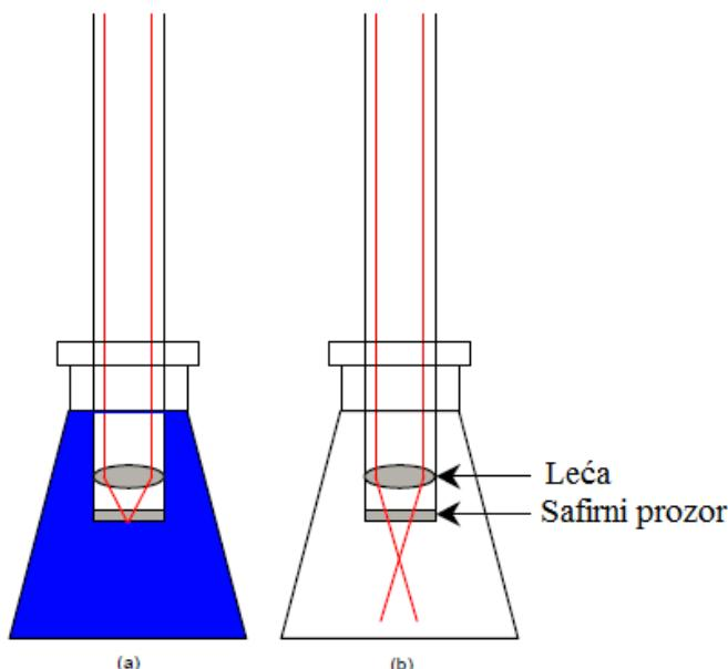
Slika 2.13. Shematski prikaz vrha Ramanove sonde s a) kratkim i b) dugim fokusom.<sup>17</sup>
